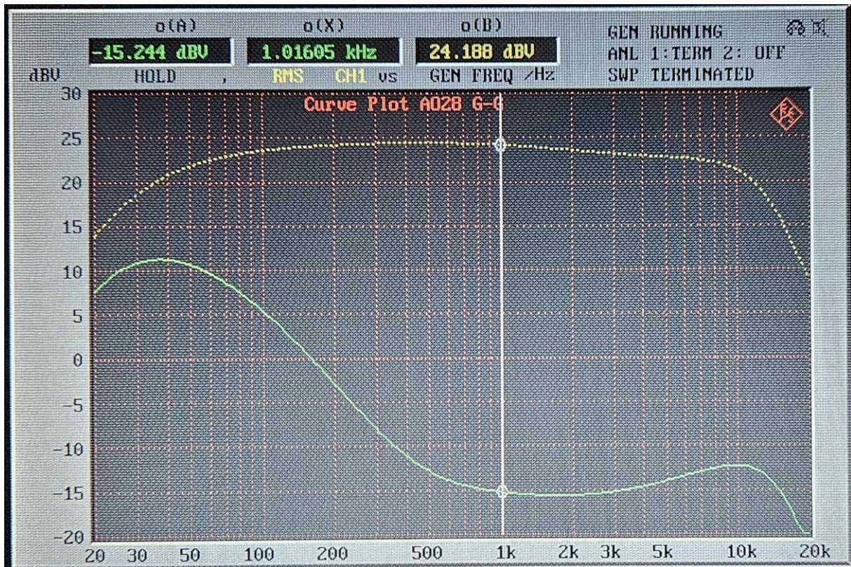
Abbildung 174: Frequenzgang A->G mit Schweller max (gelb) und min (grün)
