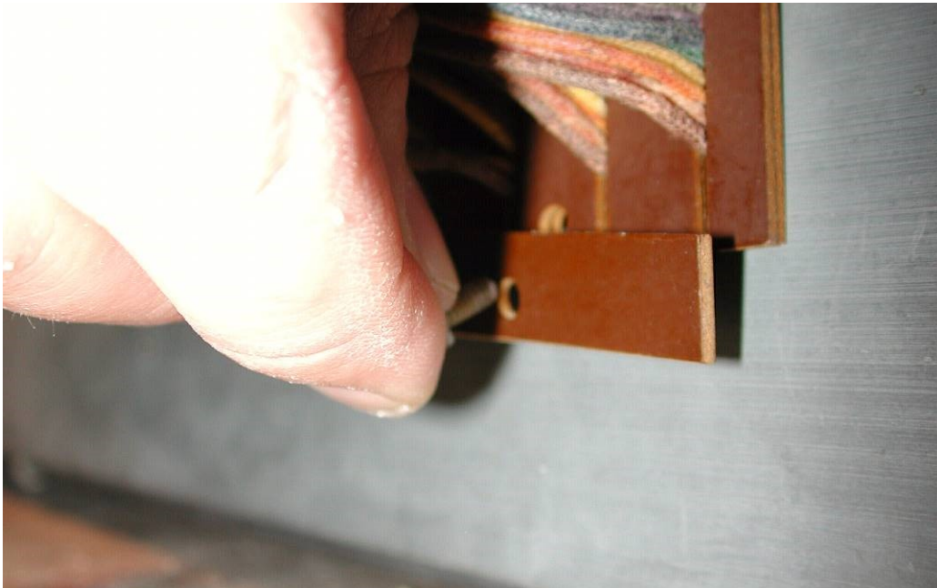
Abbildung 50: Schraube von hinten einsetzen (1)
