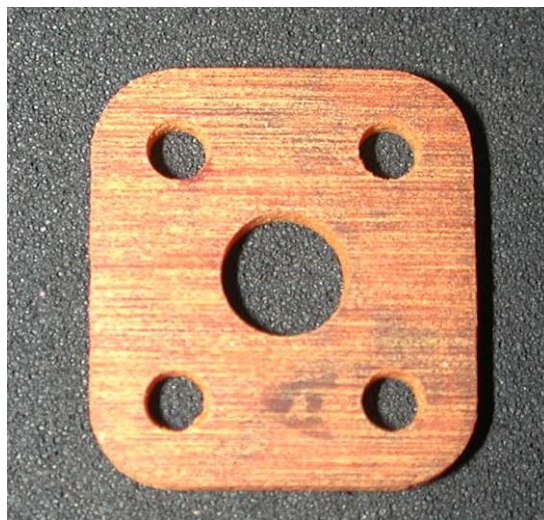
Abbildung 120: nachher: Isolierplättchen gereinigt
