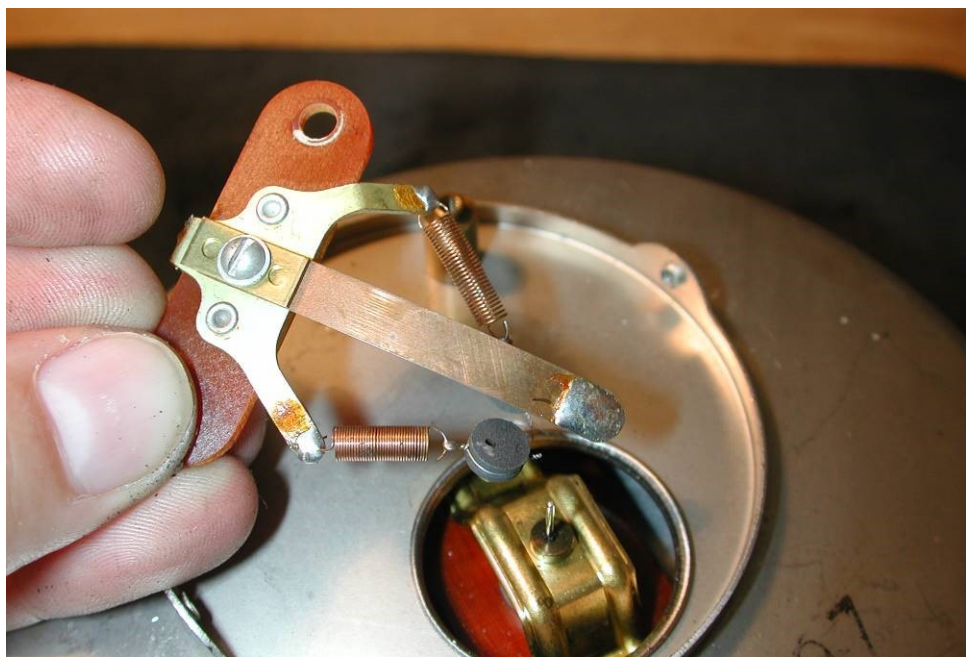
Abbildung 108: Kontaktschleifer ist nun frei
