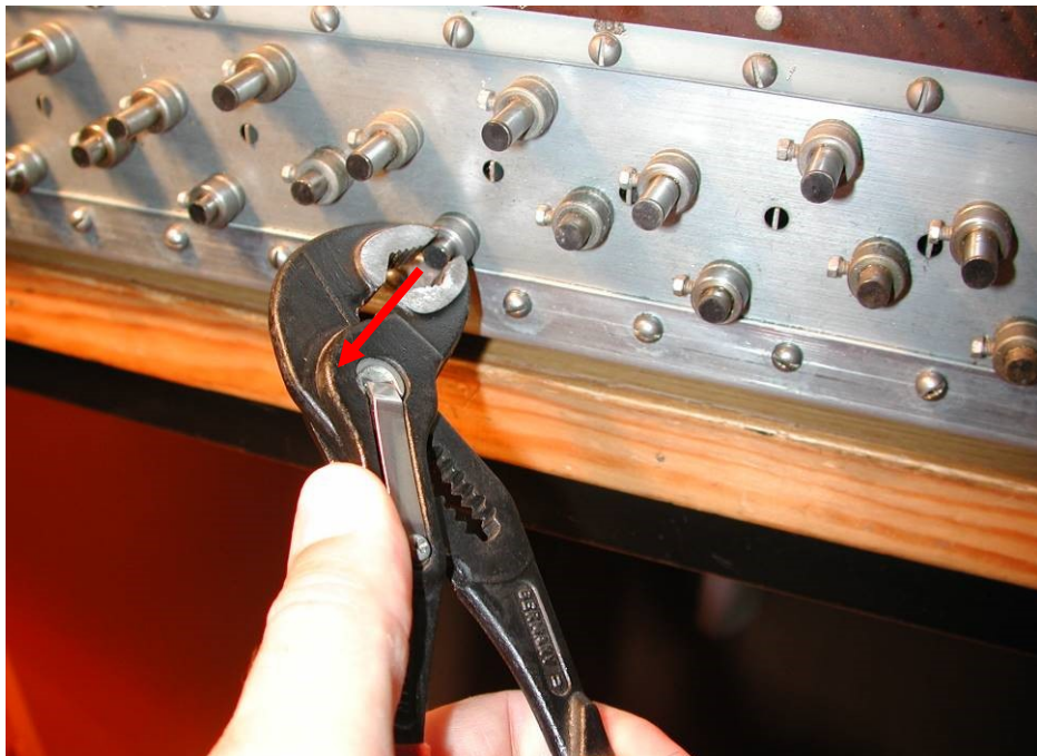
Abbildung 76: Rohrzange in Längsrichtung ansetzen
