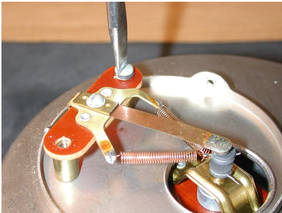
Abbildung 106: Schrauben für Kontaktschleifer lösen
