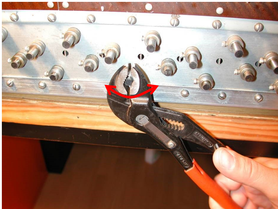
Abbildung 77: Rohrzange in Querrichtung ansetzen und leicht wackeln
