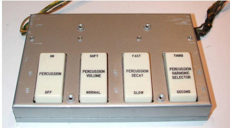
Abbildung 158: mittels dieser Tasten kann man den Klang der Percussion verändern
