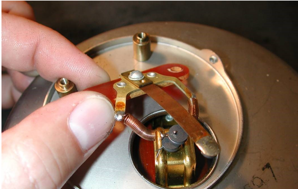
Abbildung 107: Kontaktschleifer abheben, Ringkohlen abnehmen
