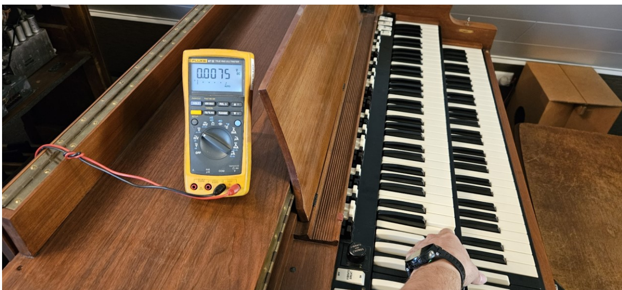
Abbildung 187: Spannung bei gedrückter Taste
