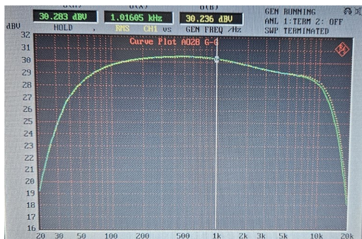
Abbildung 169: Unterschied zwischen angelötetem und abgelötetem Anschlusskabel an Klemme A
