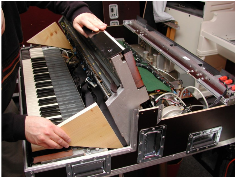
Abbildung 3: hin und wieder erleichtern ein paar einfache, selbstgebaute Hilfsmittel die Arbeit- wie hier beispielsweise zwei einfache mit der Stichsäge zugeschnittenen Holzdreiecke als Unterlage
