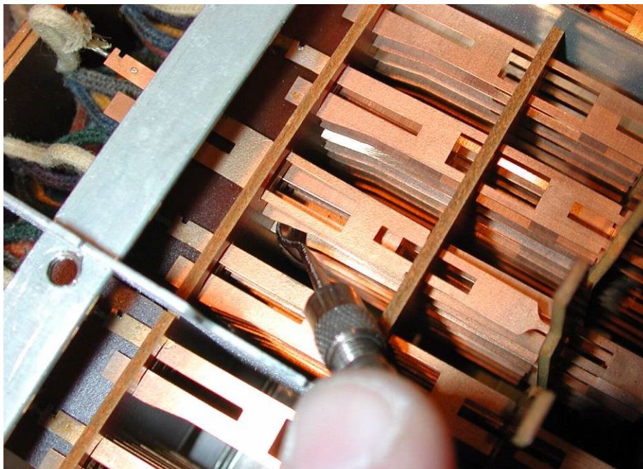
Abbildung 15: eine weitere Kontaktzunge entriegeln
