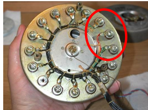
Abbildung 125: Kabel rot/blau führt zum Scanner
