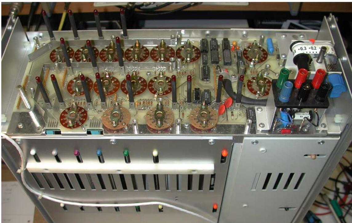
Danach gilt es nur noch, die Lächerlichkeit von Netzteil auszubauen, damit man an die von hinten liegenden Schrauben für die Skalenband-Einheit kommt, die kurz ablupft und „schon“ kann man durch geschicktes Hebeln mit einem Holzkeil die gesteckte Leiterplatte A3 abziehen. Ein Klacks, wenn man genügend Zeit hat....
