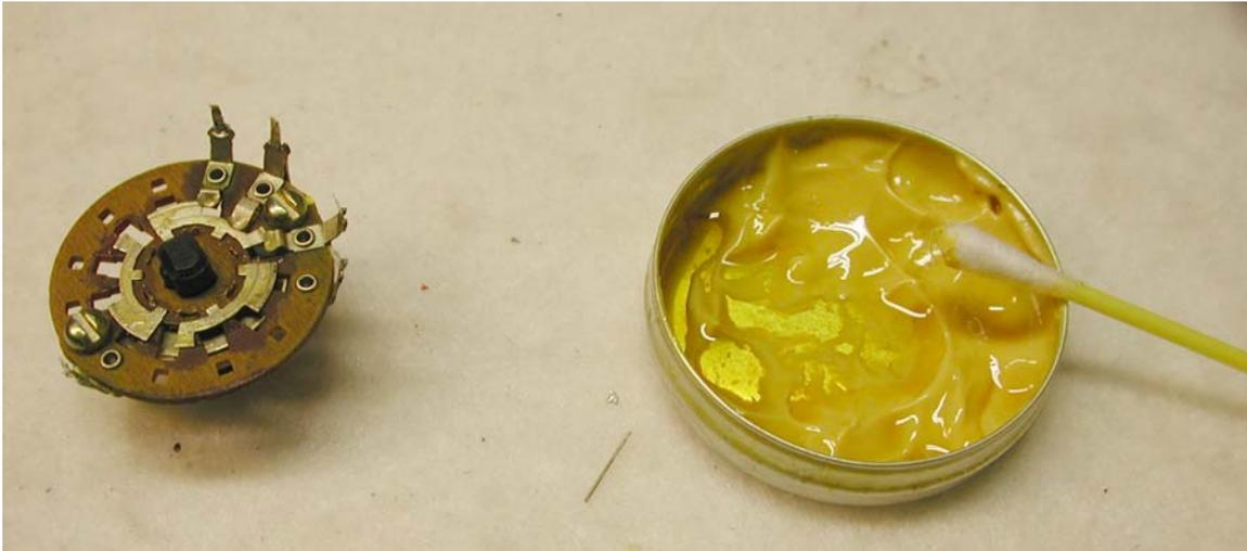
Bild: Nach dem Reinigen vorsichtig etwas Kontaktfett auf die Schleiferflächen auftragen
