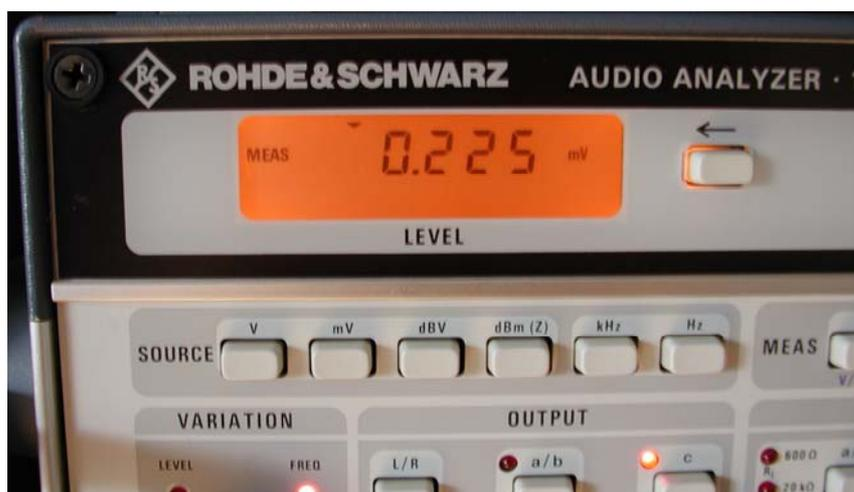
Abbildung 30: Ausgangsspannung des Schallwandlers bei 94dB(A) in den Einsprechkorb
