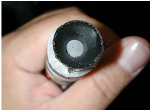
**Abbildung 37: Schalltrichter mit Schaumstoffresten auf dem Rand**
