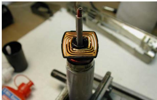
**Abbildung 26: Schwingelement auf den Schallwandler gesteckt**
