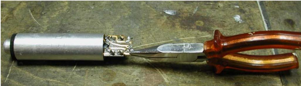
**Abbildung 12: Reste der Elektronik herausziehen**
