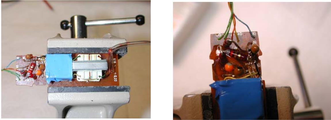
**Abbildung 15: Elektronikplatine- geklebt mit Epoxydharz**
