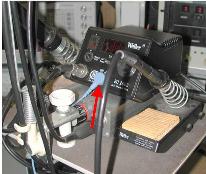
**Abbildung 4: LötKolben ESD-sicher machen**
