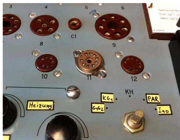
Abbildung 57: neue Fassung Nr.11 eingebaut
