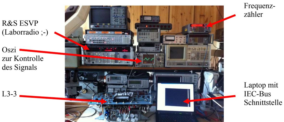
Abbildung 36: Messaufbau Langzeitmessung Oszillatorstabilität
