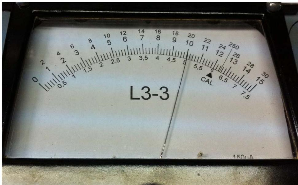
Abbildung 130: Isolationsmessung mit  $100\mu\text{A}$  Teststrom
