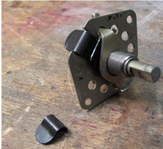
**Abbildung 18: Drehschalter mit "halbiertem" Federblech**
