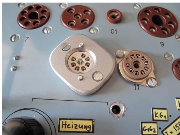
**Abbildung 145: Pico7-Fassung fertig ausgewechselt**
