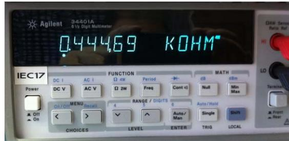
Abbildung 99: R57 gemessen mit 4Draht-Messung
