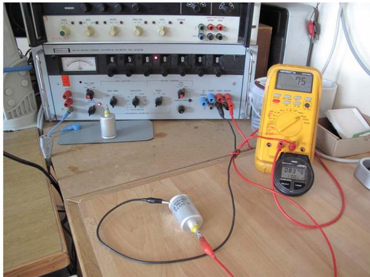
**Abbildung 25: Hochspannungstest von C35 am Kalibrator**
