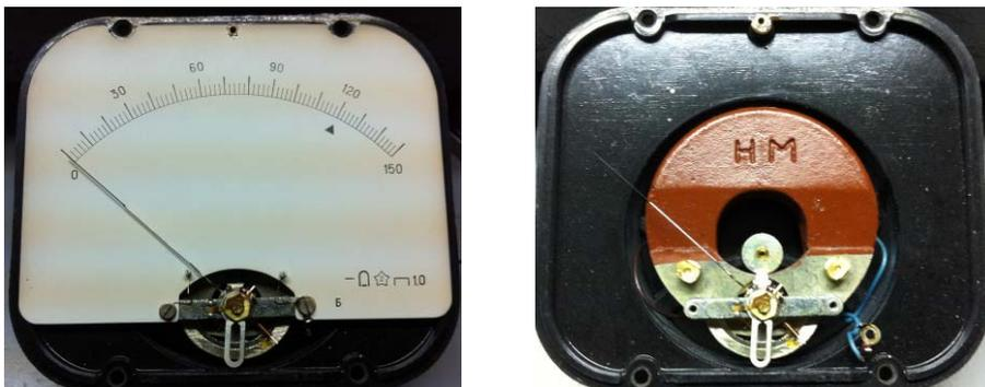
Abbildung 7: Messinstrument des L3-3 mit und ohne Skala
