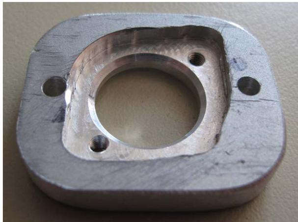
Abbildung 142: Adapterplatte (Frästeil)
