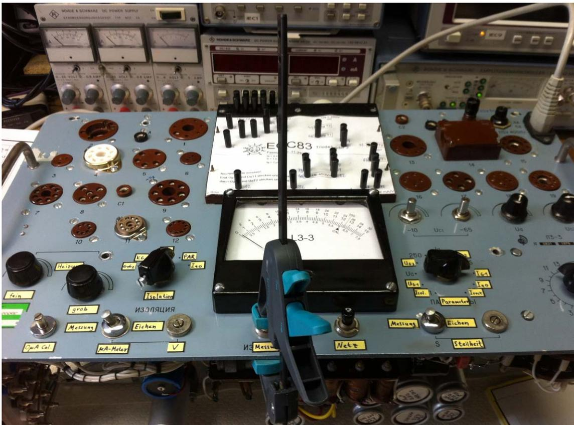
Abbildung 131: L3 bereit zur Gitterstrom-Messung
