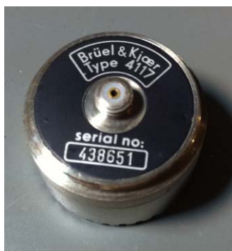
Abbildung 4: Mikrofonkapsel (Typ 4117) einzeln (links) sowie im 94dB-Kalibrator (rechts)
