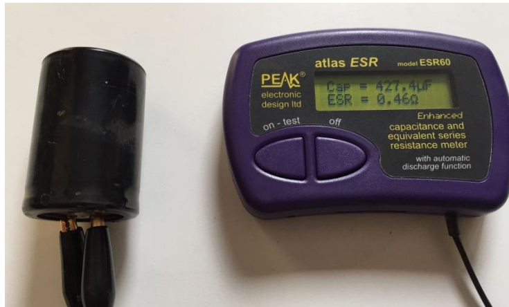
Abbildung 52: trotz Auslauf noch immer 430µF und 0,46Ohm!
