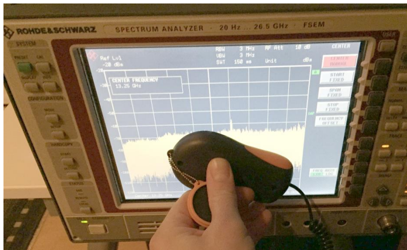
Abbildung 57: Referenzmessung auf "gelber Noisefloor-Kurve"
