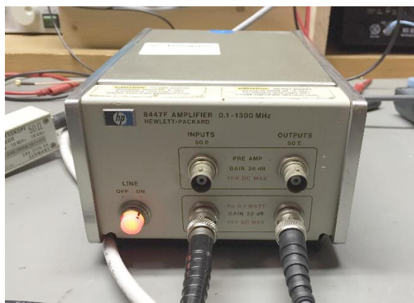
Abbildung 9: nützliches Teil im Labor: HP8447F Breitbandverstärker
