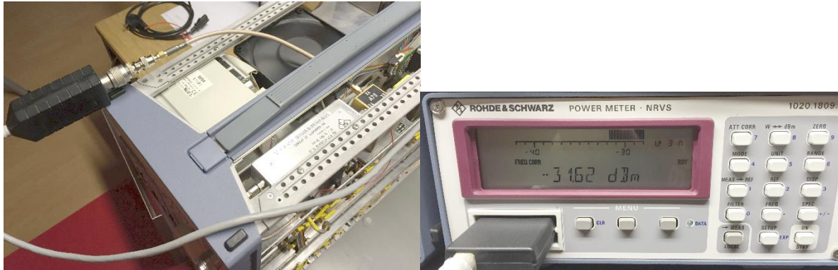
Abbildung 67: Messung mit NRV-Z5 und NRVS
