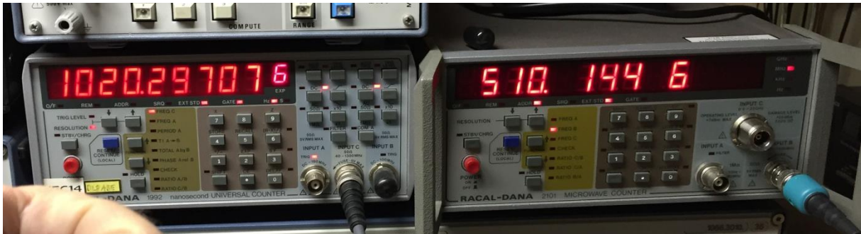
Abbildung 32: selbst im Fehlerfall funktioniert der Vorteiler /2 noch!
