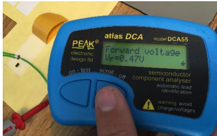
Abbildung 36: auf Verdacht ausgelötet- scheint aber heile zu sein
