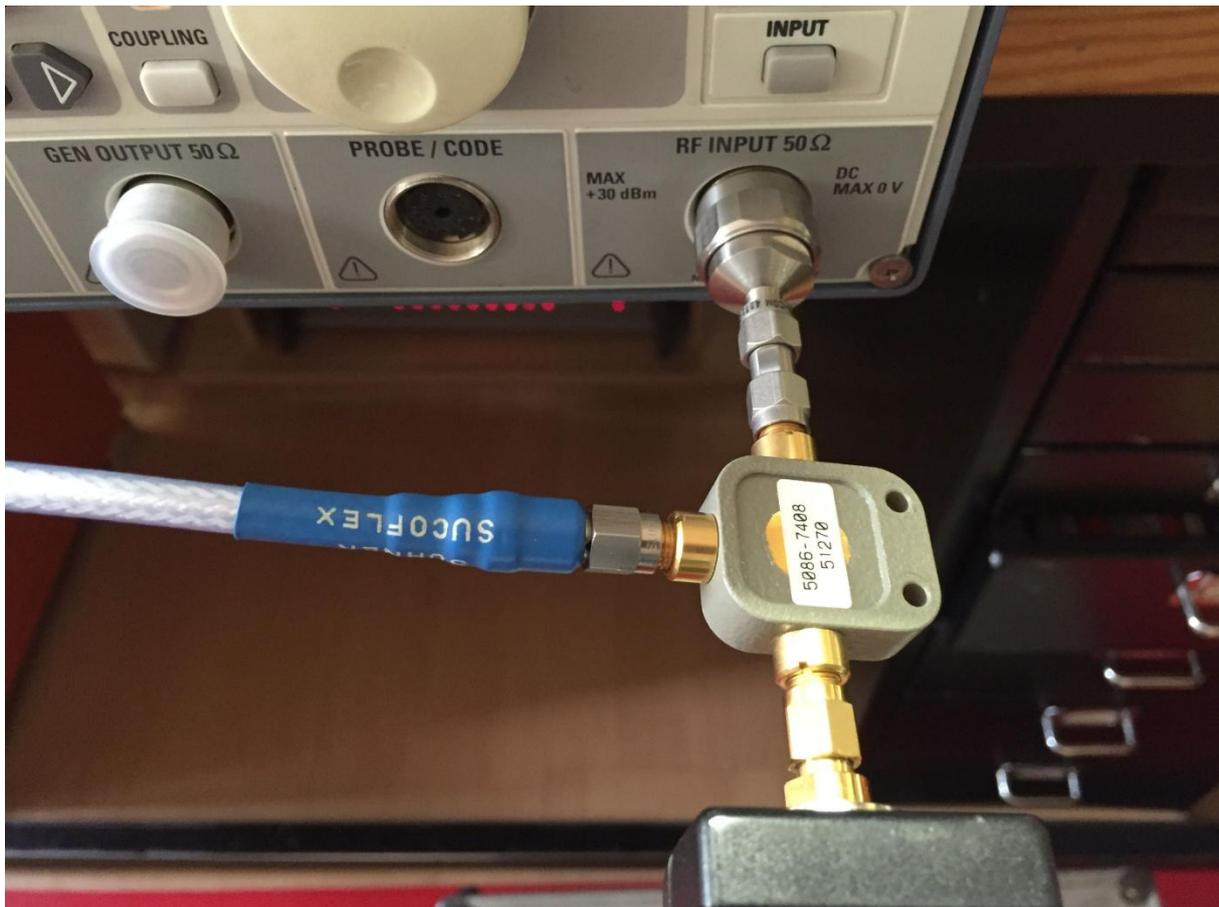
Abbildung 14: Herz des Aufbaus: der HP11667B Powersplitter
