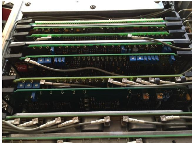
**Abbildung 19: nettes Detail: überall Drahtschlaufen als Messpunkte**
