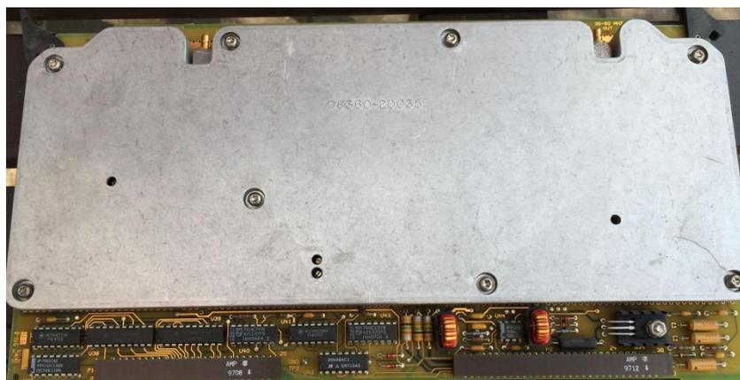
Abbildung 26: so sehen bei HP die geschirmten HF-Baugruppen aus
