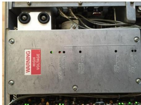
**Abbildung 20: gut gemacht, liebe Entwickler: das Netzteil im Diecast-Gehäuse und überall Status-LEDs**
