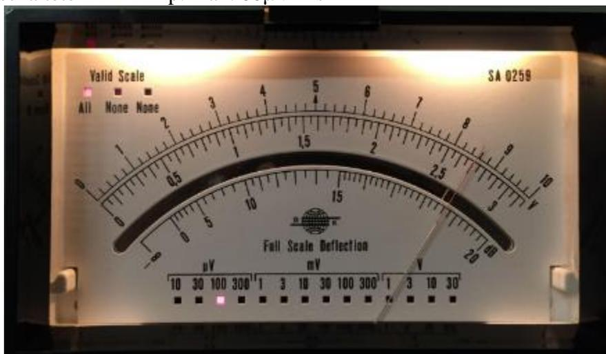
Abbildung 66: der Low-Noise-NF-Amp liefert nur knappe  $88\mu\text{Vrms}$  Rauschen
