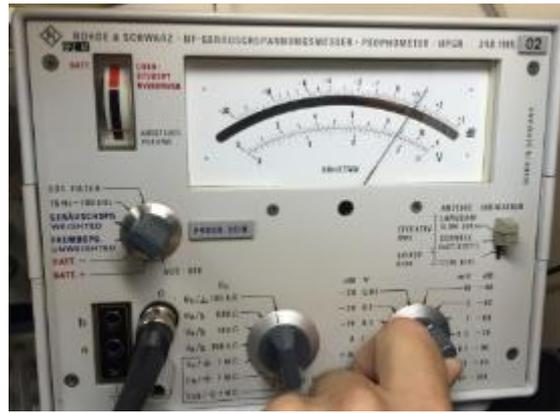
Abbildung 4: im Versuch vorerst noch breitbandig messen: die Phasenoise-NF
