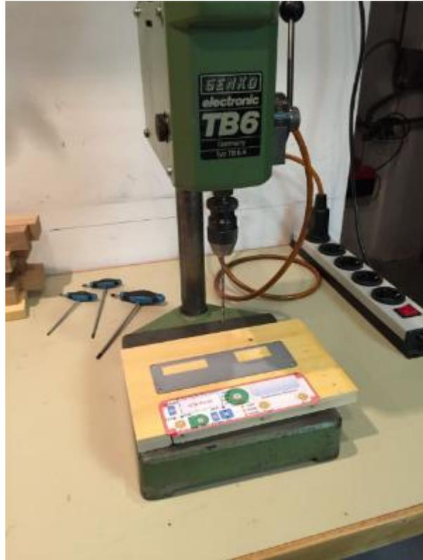
**Abbildung 26: Löcher in die Frontplatte bohren**
