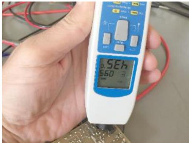
**Abbildung 19: nochmalige Überprüfung mit dem IR-Thermometer**
