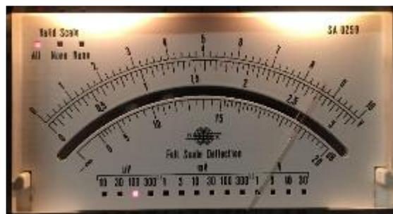
Abbildung 58: Rauschniveau am "PM"-Ausgang
