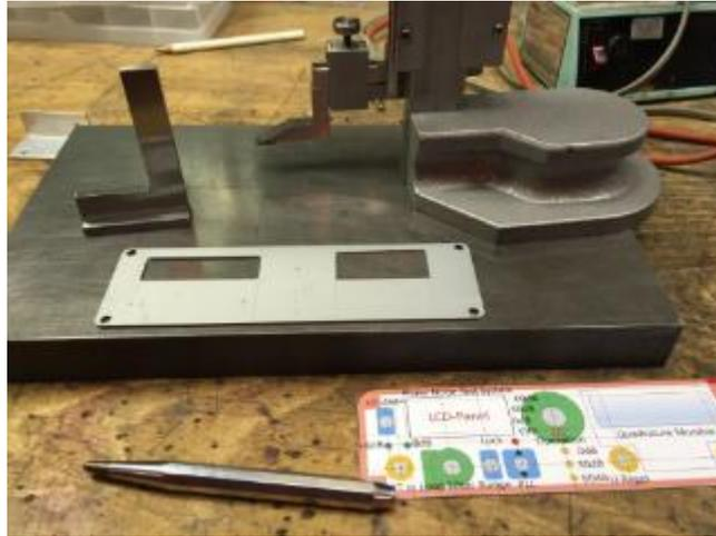
Abbildung 24: Frontplattendruck auf Papier als Vorlage
