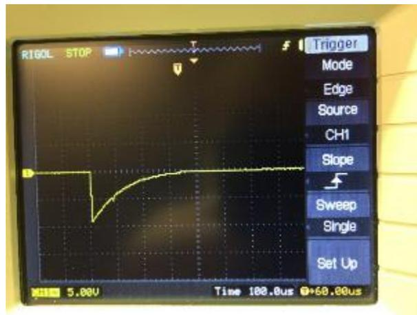
**Abbildung 104: Stromspitze im positiven +12V-Netz**
