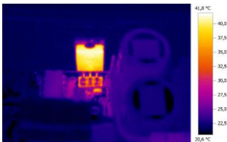
Abbildung 110: PNP-Längstransistor im PNTS Netzteil
