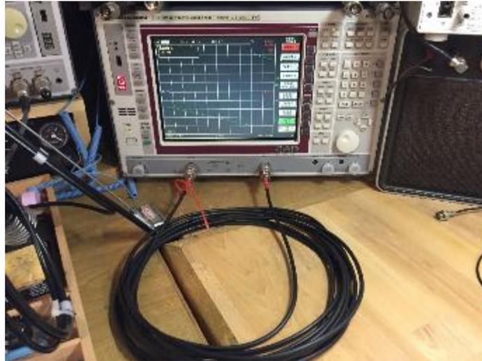
Abbildung 82: Messung der Phasenverschiebung am NWA
