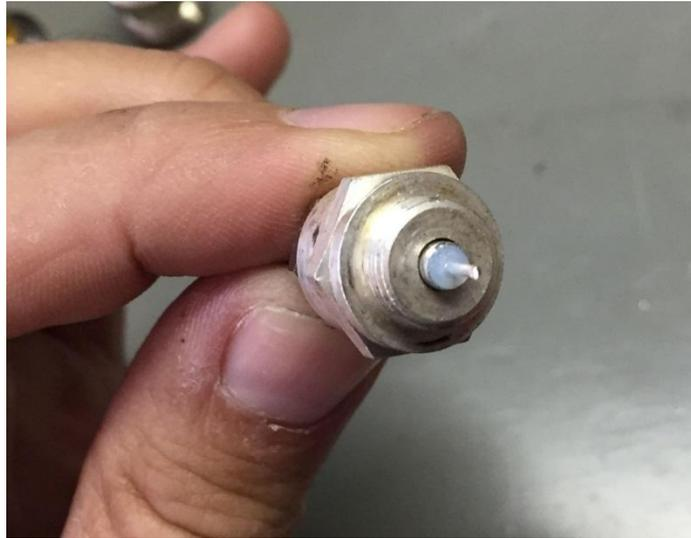
**Abbildung 14: Semi-Rigid in der Stopfbuchse eingespannt**
