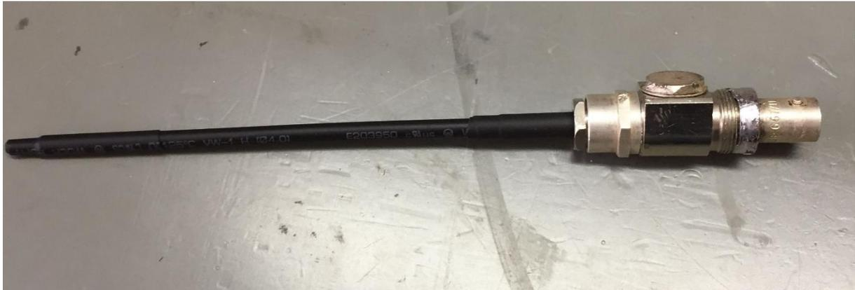
**Abbildung 25: Fertige E-Feldsonde!**
