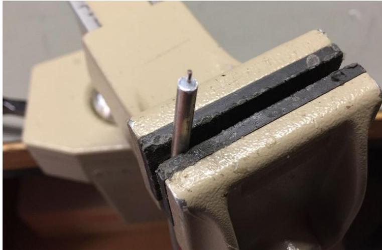
**Abbildung 3: Semi-Rigid-Kabel abisoliert**
