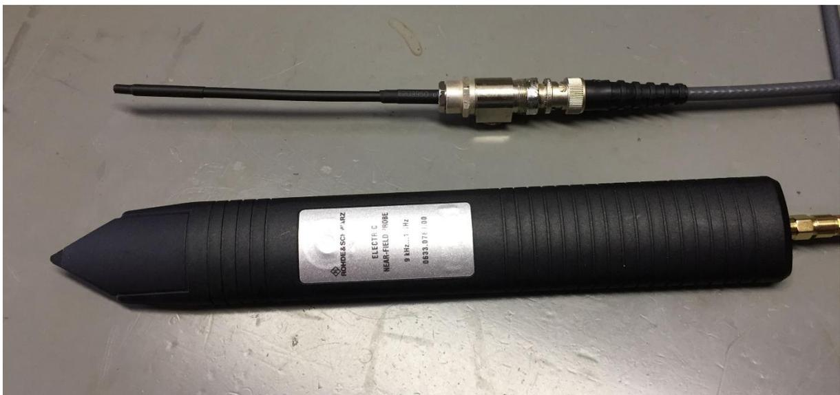
**Abbildung 26: Eigenbausonde (oben) und Rohde&Schwarz HZ-14 (unten)**
