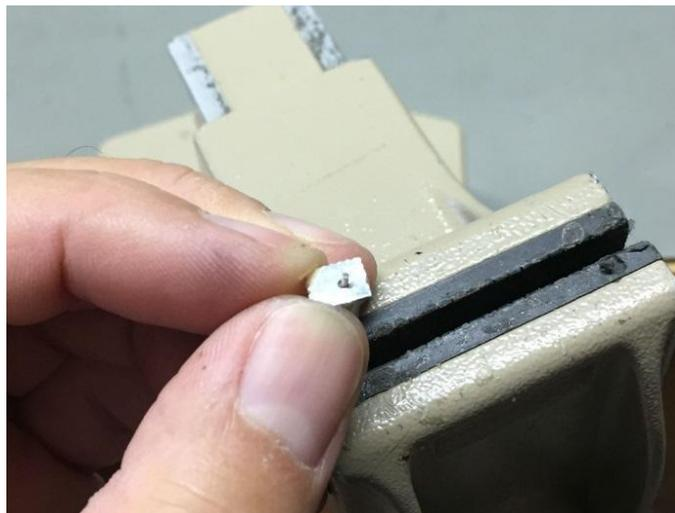
**Abbildung 4: ein kleines Stück Weißblech sorgt für einen HF-mäßig guten Kurzschluss**
