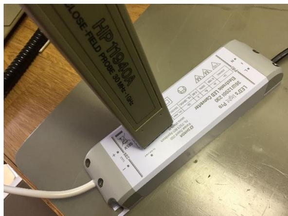
Abbildung 19: Abtasten mit einer Magnetfeld Referenz-Sonde (HP11940A)
