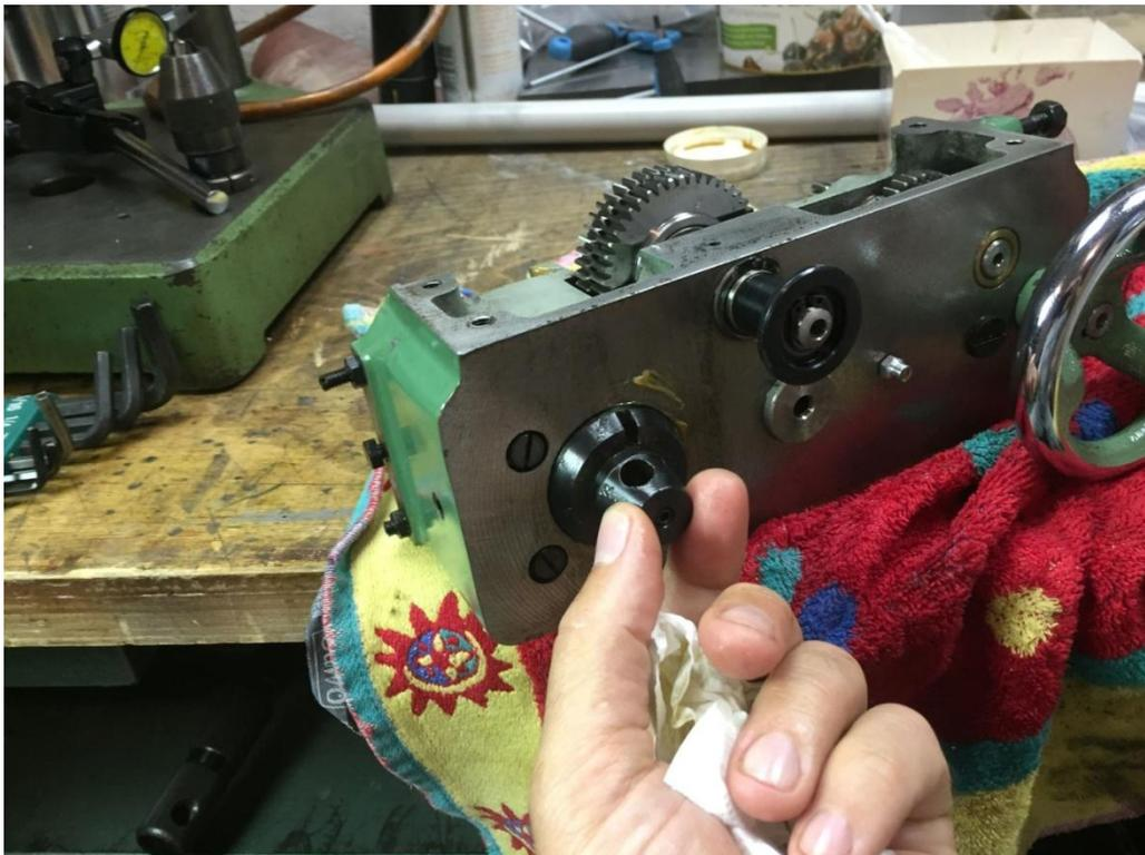
**Abbildung 32: der Exzenter zum Betätigen der Schlossmutter-Nocken**
