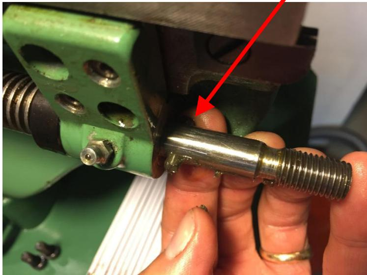
**Abbildung 21:** der kleine Querstift kann mit einer einfachen Kombizange herausgezogen werden
