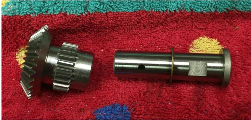
**Abbildung 42: das zweite Kegelrad**
