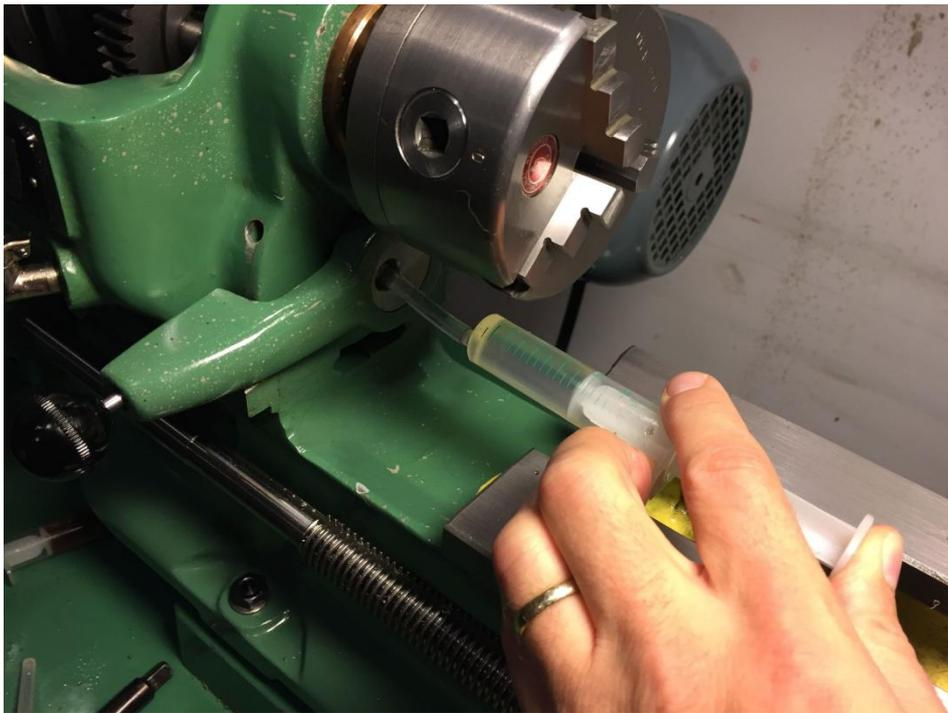
Abbildung 5: auch ein "Update": ein Öl-Update am Schmiernippel einer Drehbank! :-)
