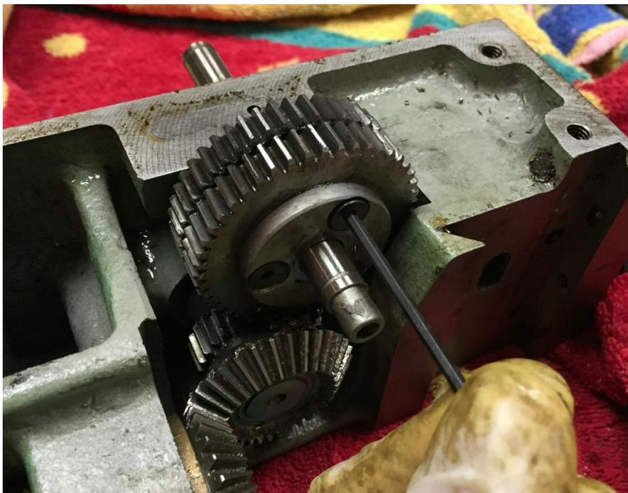
**Abbildung 41: Antrieb für Powerfeed des Oberschlittens**
