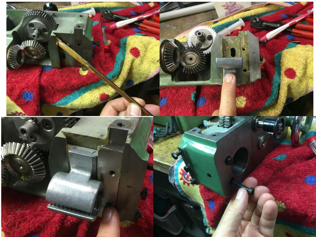
Abbildung 36: Schlossmutter-Mechanik zusammenbauen
