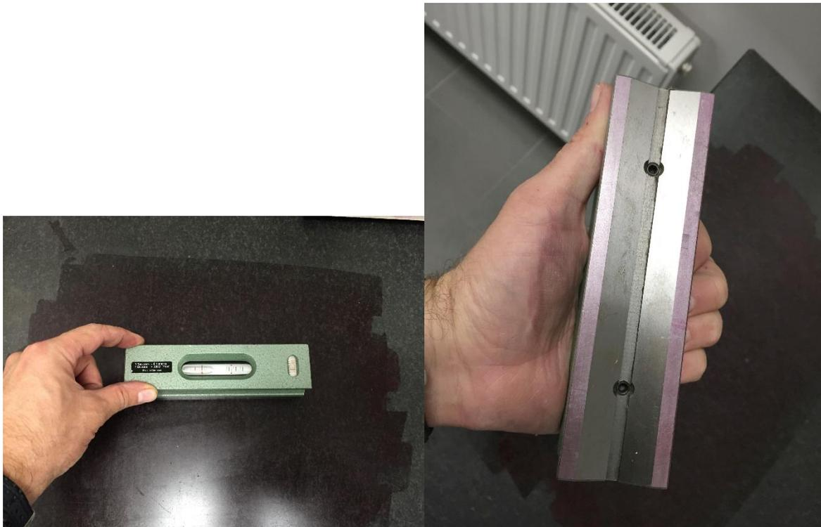
**Abbildung 88: Benchmark: Tuschierbild meiner Maschinenwasserwaage**
