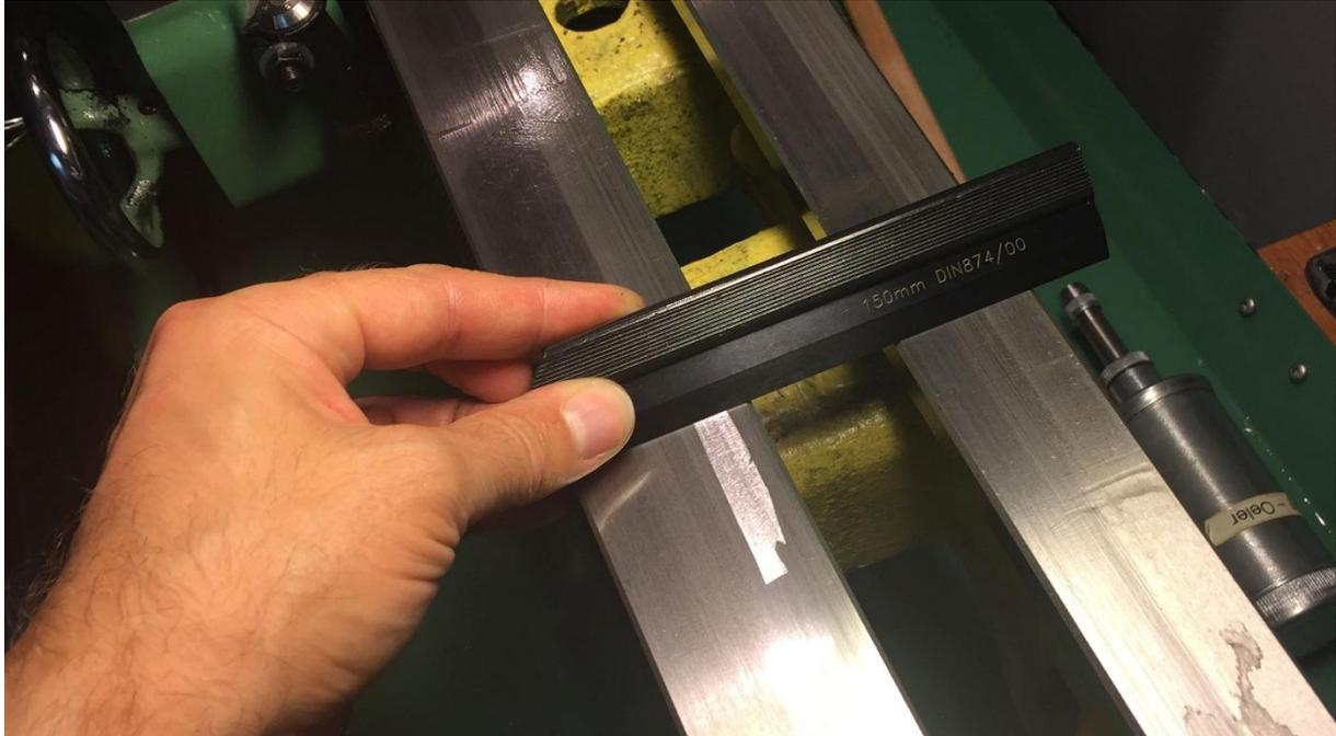
**Abbildung 77: dünner Sreifen Aluminiumfolie als Messmittel**
