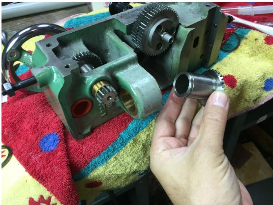
Abbildung 39: eines der beiden Kegelräder für den "Crossfeed" des Querschlittens
