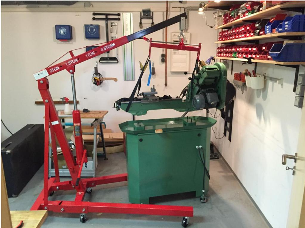
**Abbildung 15: das punktgenaue Absetzen gelingt -Dank Balancer- ohne Probleme**
