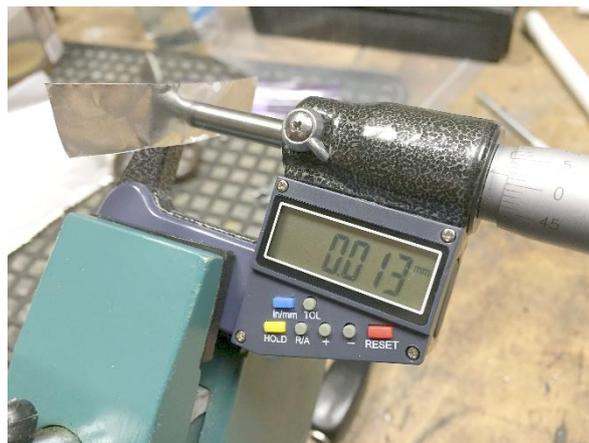
Abbildung 72: Messung der Dicke von Aluminiumfolie
