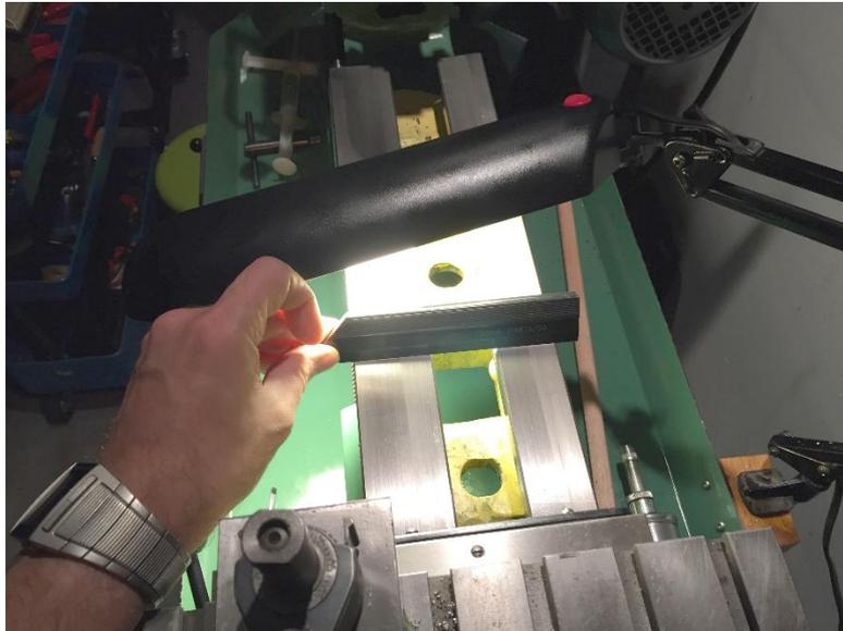
Abbildung 73: Messung mit Haarlineal und Lampe
