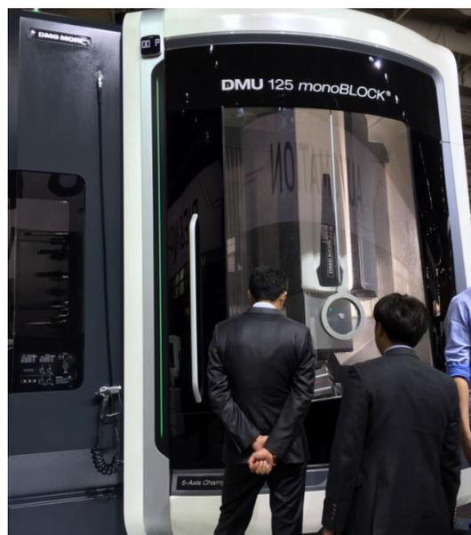
**Abbildung 53: nein, das ist kein neuer Stadtbus, sondern eine moderne 5-Achsen Metallbearbeitungsmaschine von DMG MORI!**
