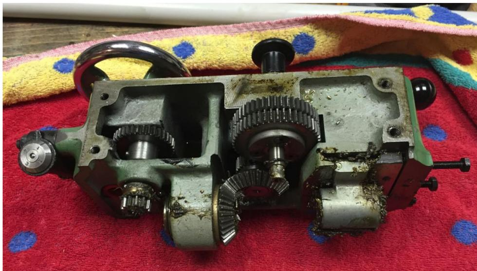
**Abbildung 28: so sieht der Schlosskasten von hinten aus**
