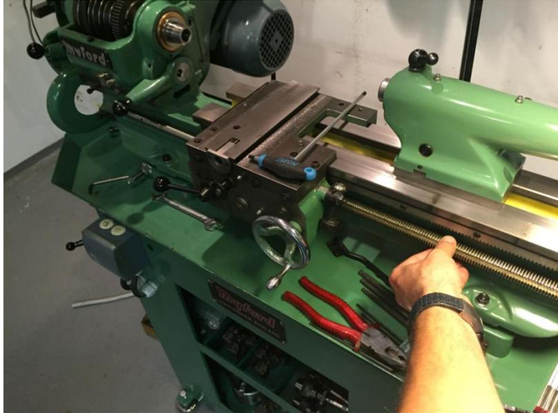
**Abbildung 25: Spindel schließlich nach rechts herausziehen**
