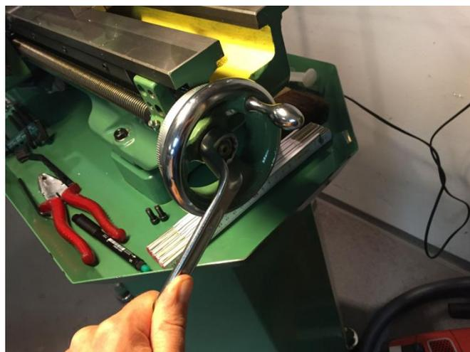
**Abbildung 20: Handrad der Leitspindel abnehmen**
