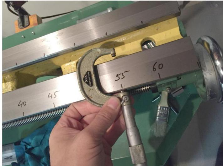
Abbildung 60: Messung der Breite mit Mikrometerschraube
