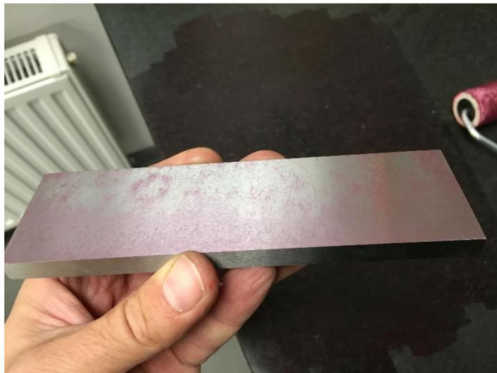
**Abbildung 87: Tuschiebild einer Parallelunterlage**
