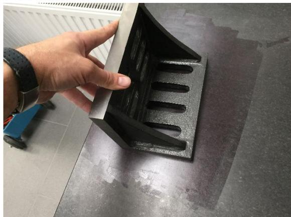
Abbildung 82: Tuschieren eines Werkstücks (Aufspannwinkel)
