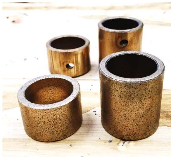
**Abbildung 121: hier sieht man sehr gut die poröse Oberfläche der Sinterbronze**
