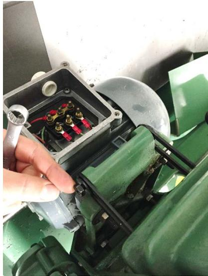
**Abbildung 128: Spannvorrichtung lösen**
