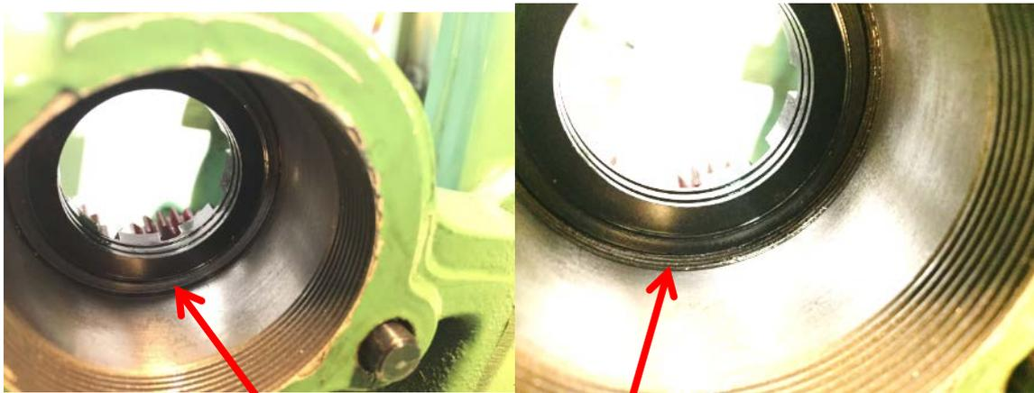
Abbildung 78: die eine Wellenmutter lässt sich bis zum Anschlag einschrauben (links), die andere nicht (rechts)!
