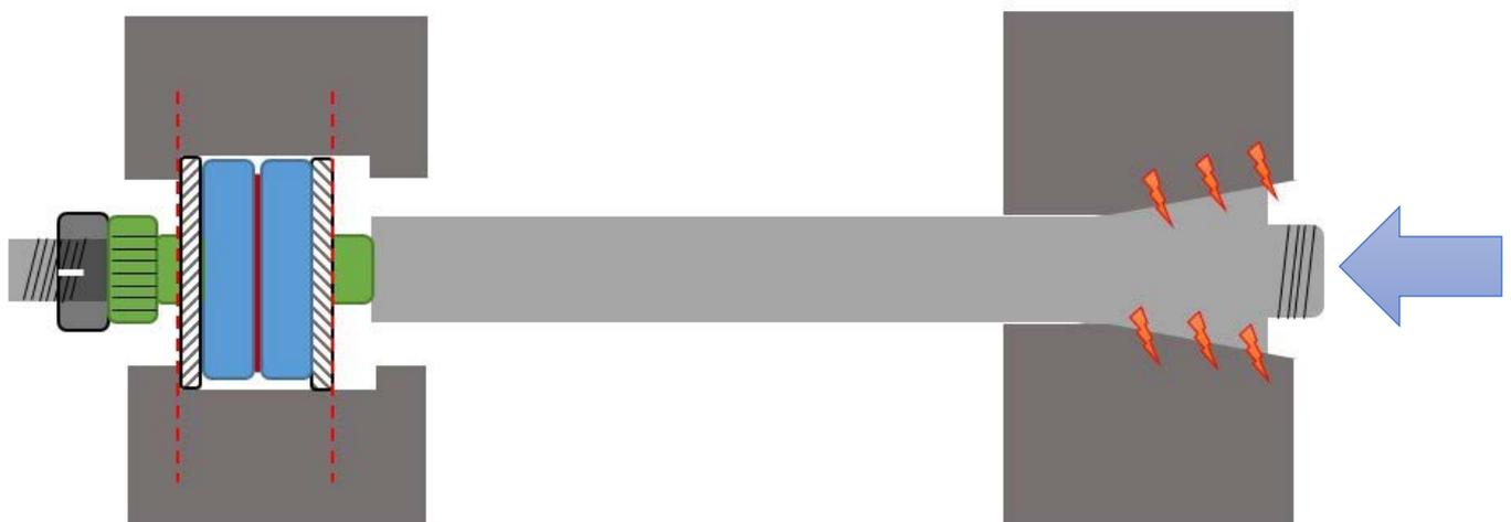
**Abbildung 71: Spindel bis zum Anschlag einschieben (z.B. durch Druck mit Tailstock (blauer Pfeil))**
