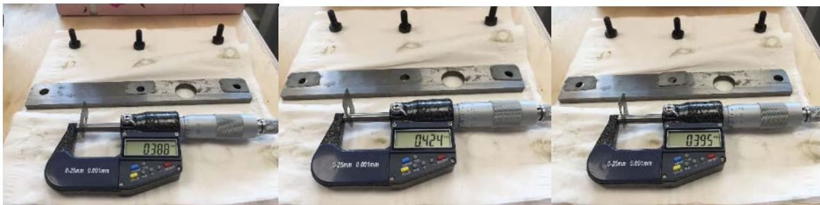
**Abbildung 25: Messung der Dicke der Shims**
