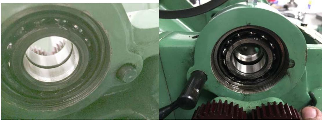
**Abbildung 59: die beiden Spindellager von links und von rechts**
