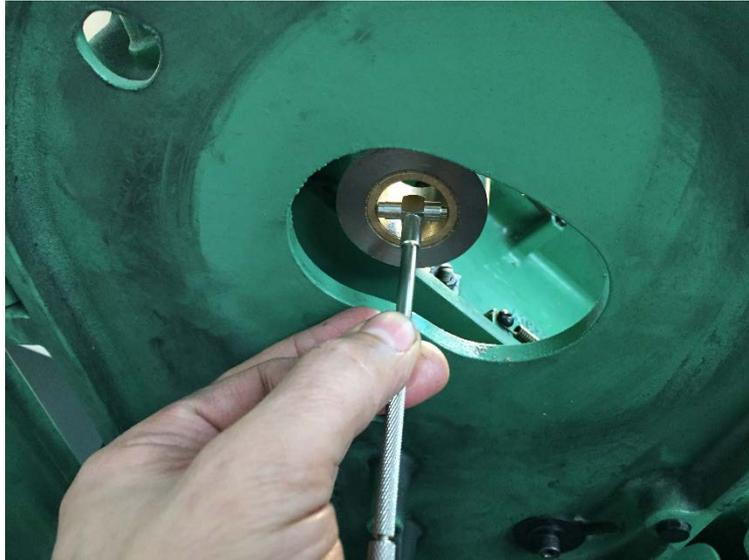
**Abbildung 118: Abnahme des Innenmaßes für die Messung mit Mikrometerschraube**
