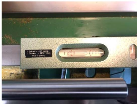
**Abbildung 19: Prüfung auf dem hinteren Shear**
