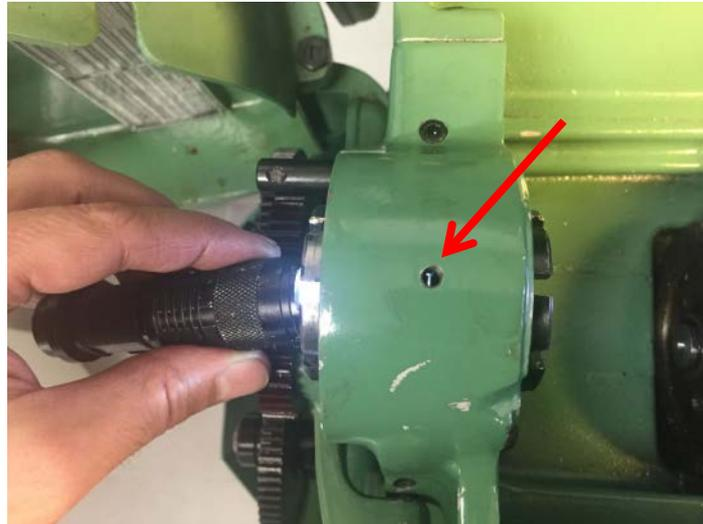
**Abbildung 70: wichtig: das geöffnete Ende des C-Rings muss immer nach oben zeigen!**
