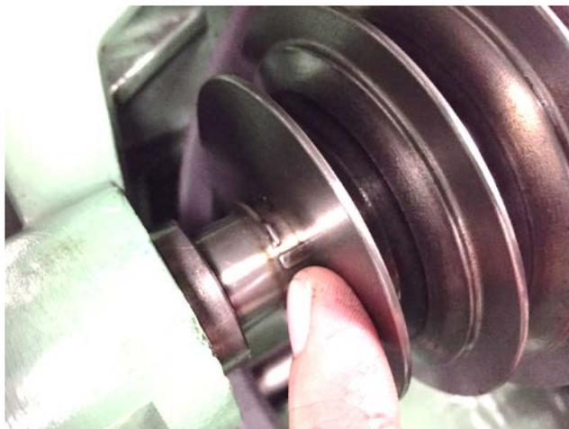
**Abbildung 90: Sprengring lösen und nach rechts gegen das Riemenscheibenpaket schieben**
