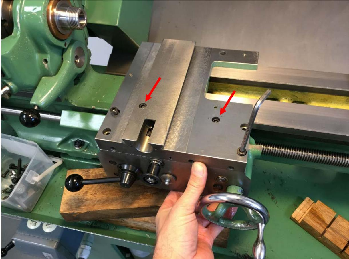
**Abbildung 26: Schlosskasten ablassen (1)**
