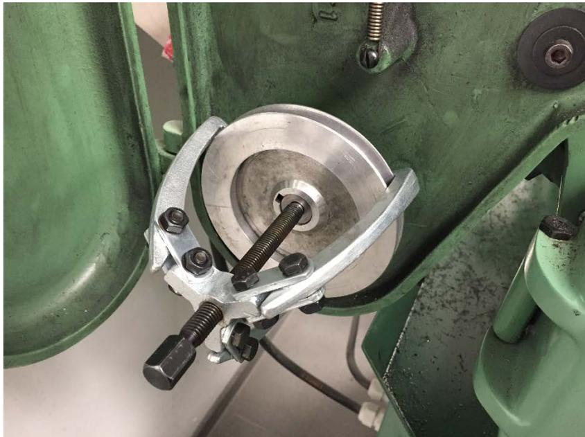
Abbildung 124: das Abbauen des Motors beginnt mit dem Abziehen des Pulleys
