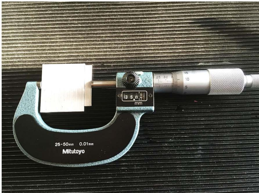
Abbildung 42: Endmaßblock mit 35,075mm
