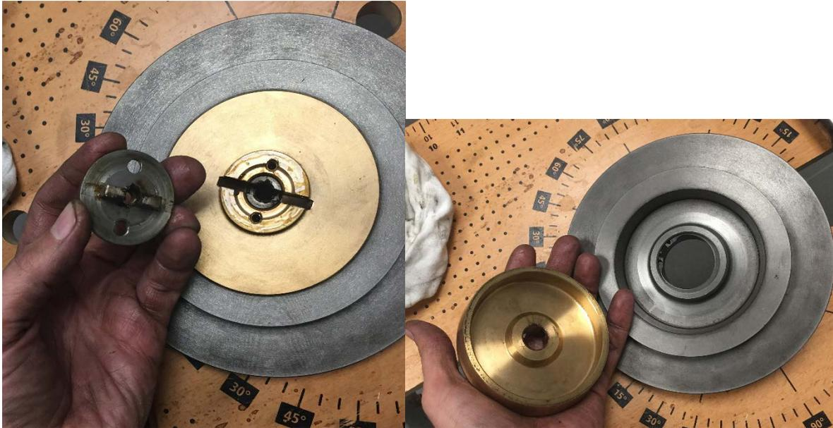
Abbildung 107: Mitnehmerscheibe lösen und Kupplung abnehmen
