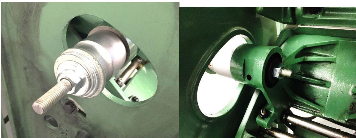
Abbildung 114: Zugstange zum Ausziehen der Lagerhülse
