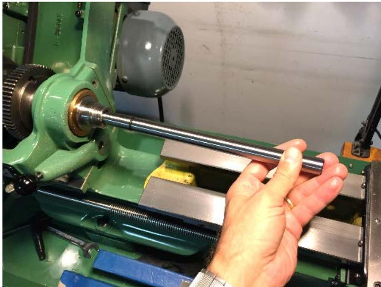
Abbildung 15: Einsetzen eines MK2 Prüfdorns für RDM-Messung
