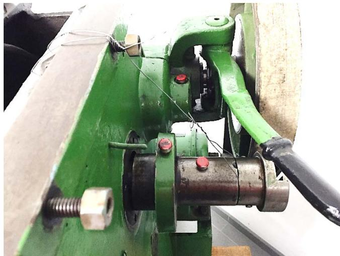
**Abbildung 7: Ausbau der Kurbelwelle**
