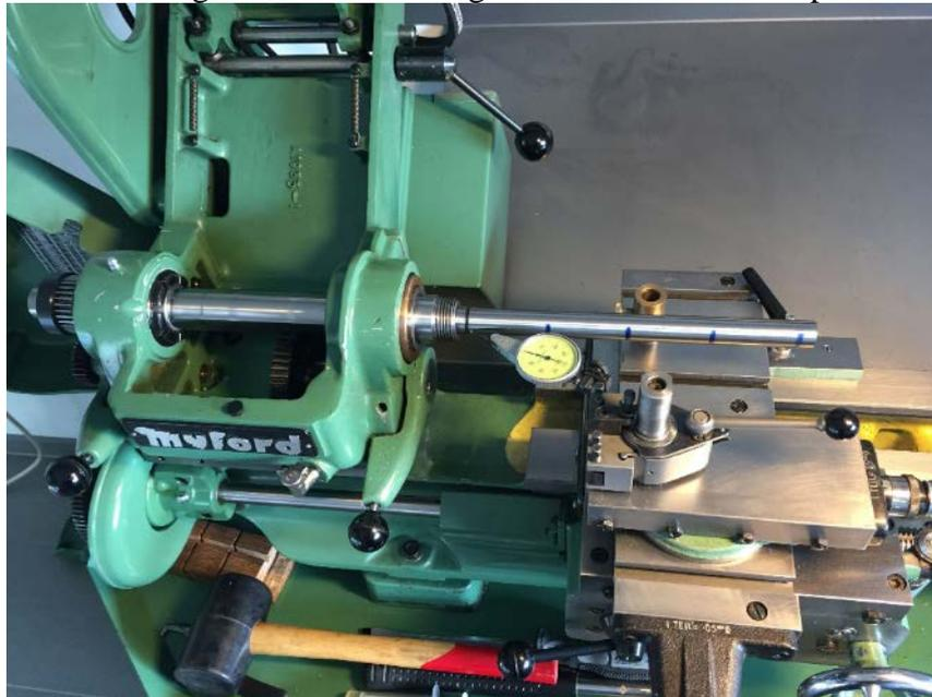
Abbildung 12: Prüfstab für RDM-Messung (hier schon mit tlw. ausgebautem Spindelstock)
