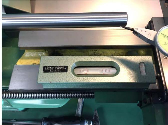
**Abbildung 18: Prüfung auf dem vorderen Shear**
