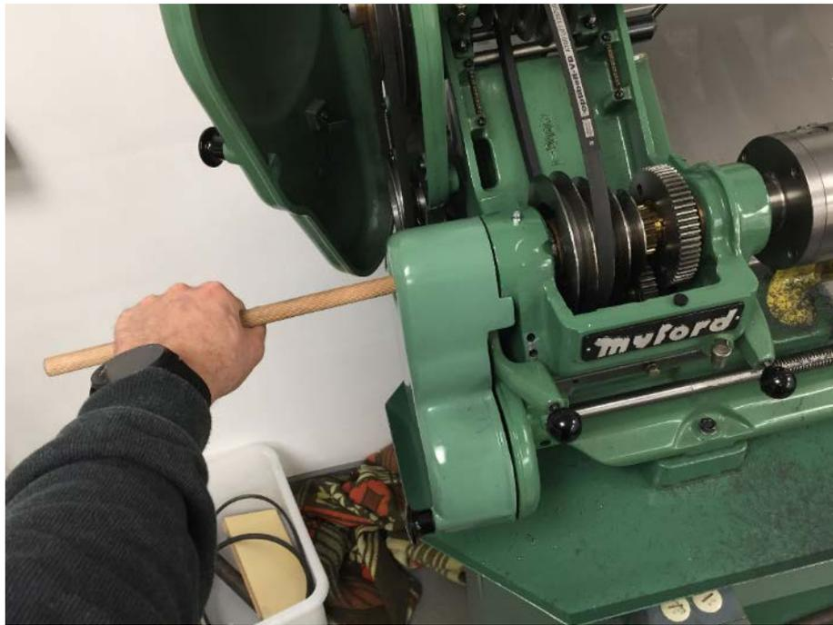
Abbildung 88: Spindelstock ausrichten
