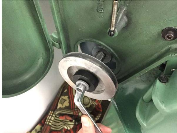
**Abbildung 138: Pulley mit Gewindestange und Druckstück aufziehen**
