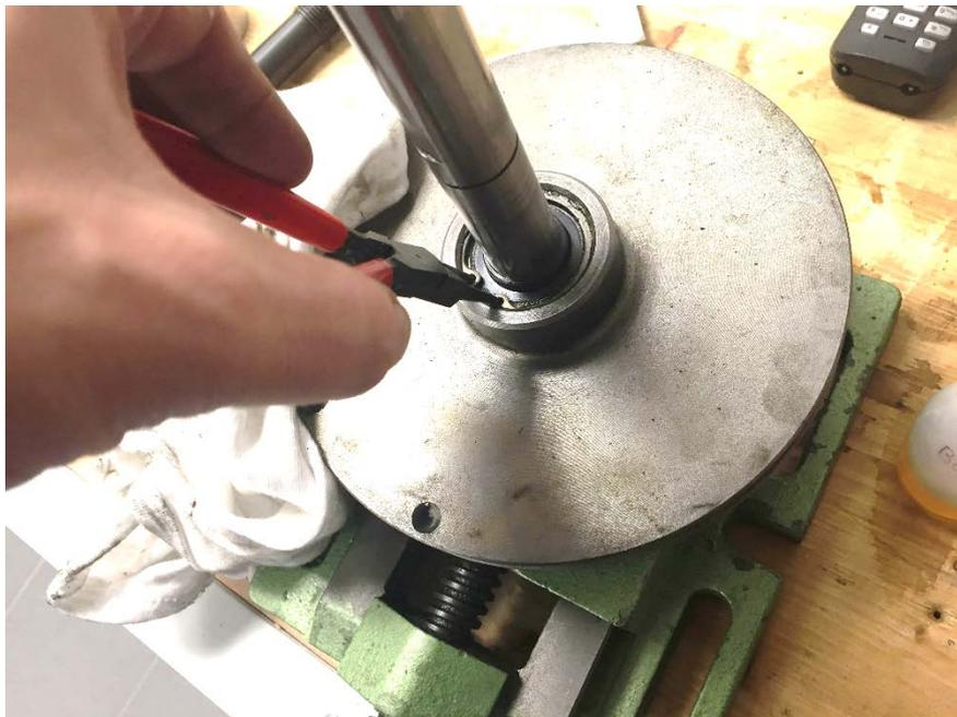
Dadurch kann nun die äußere Kupplungsscheibe von der Welle abgezogen werden. Es kommen zwei weitere Kugellager (und ein Distanzring) zum Vorschein.
