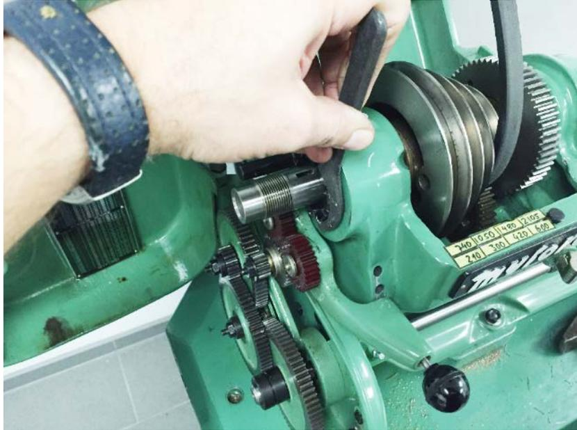
**Abbildung 53: linke Wellenmutter lösen (normales Rechtsgewinde)**
