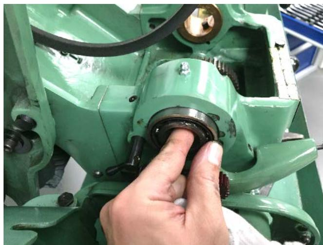
**Abbildung 60: Spindellager herausrucken**
