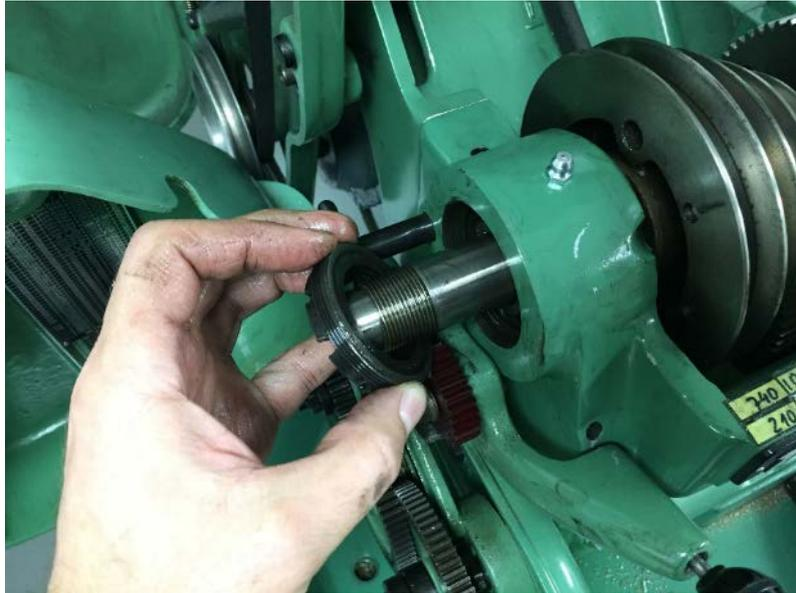
Abbildung 55: die linke Wellenmutter abschrauben
