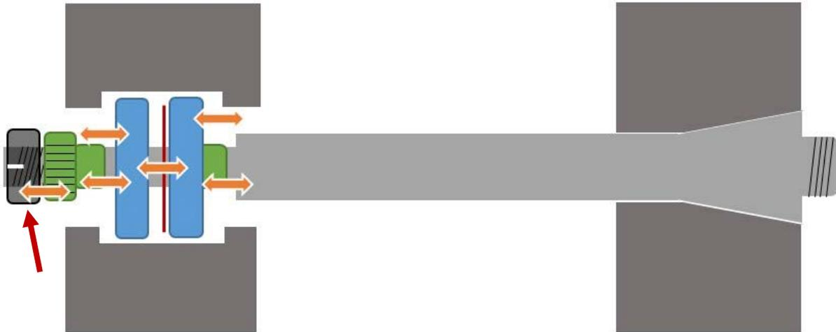
Abbildung 68: mit losem Collar (roter Pfeil) ist alles noch lose und auf der Achse verschiebbar
