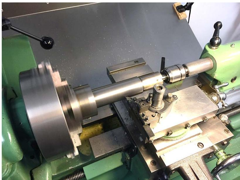
**Abbildung 9: Abdrehen der alten Welle aus dem Metallhobel auf der Drehmaschine: leider nicht ganz exakt parallel!**
