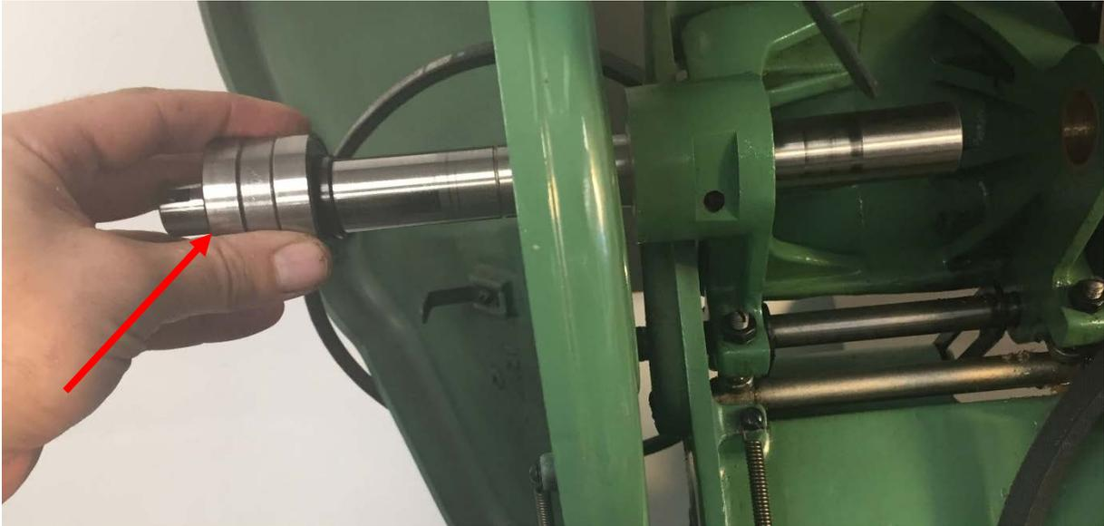
**Abbildung 108: Kugellager und Distanzring auf der Vorlegewelle (Pfeil)**
