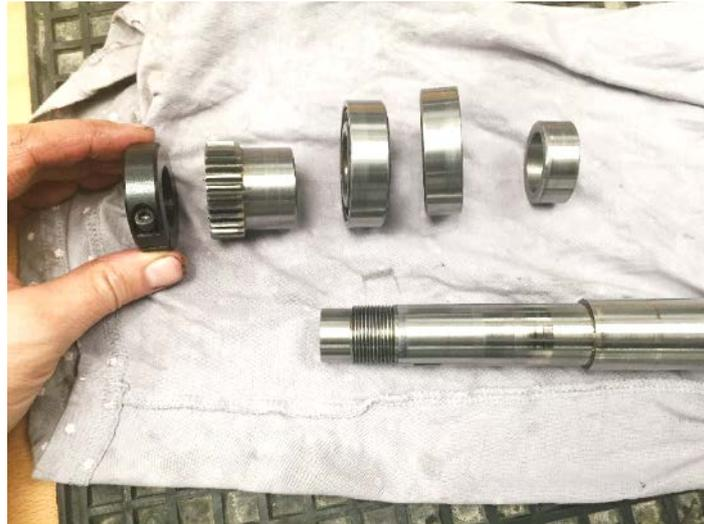
**Abbildung 75: Diese Teile gehören alle zum linken Spindellager!**
