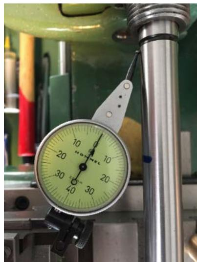
**Abbildung 48: RDM-Messung mit Prüfdorn bei  $l=0\text{cm}$**
