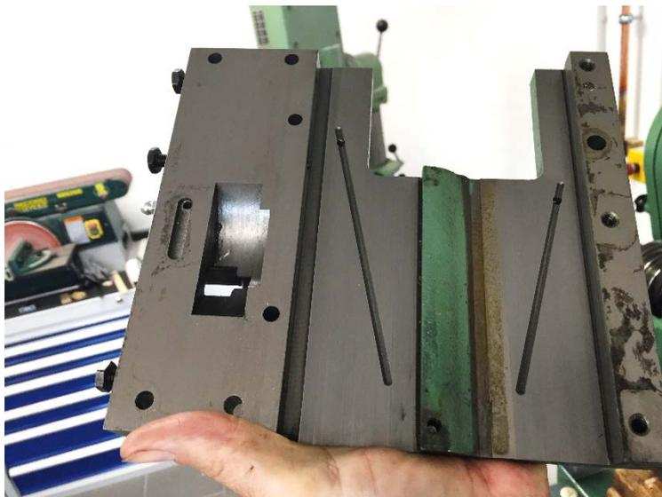
**Abbildung 29: die Grundplatte mit nur sehr geringen Abnutzungsspuren!**
