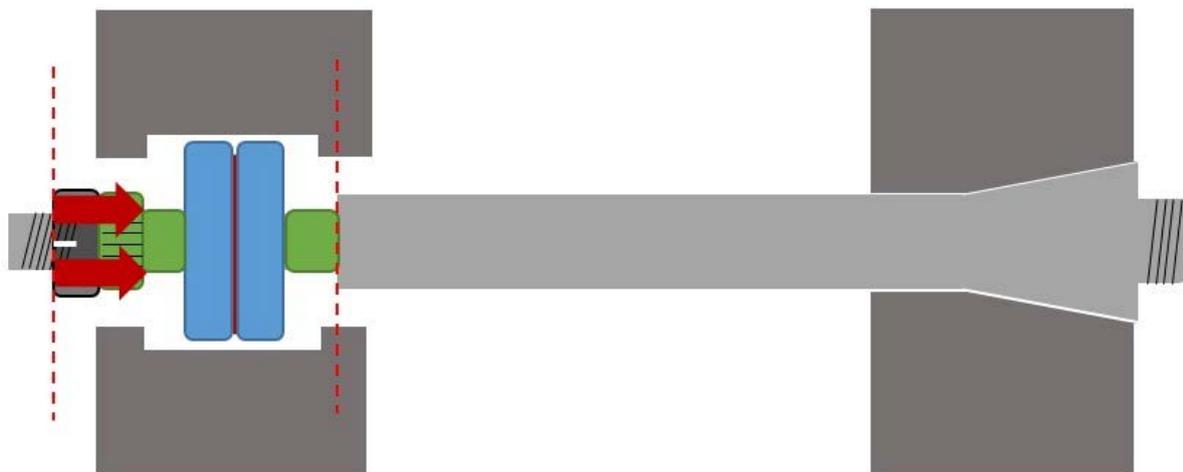
Abbildung 69: mit dem Anziehen des "Collars" spannt man alle Teile auf der Welle zu einem starren Paket zusammen
