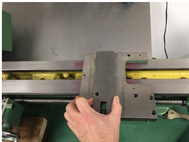
Abbildung 141: dann den Schlitten drauf hin- und herschubbern
