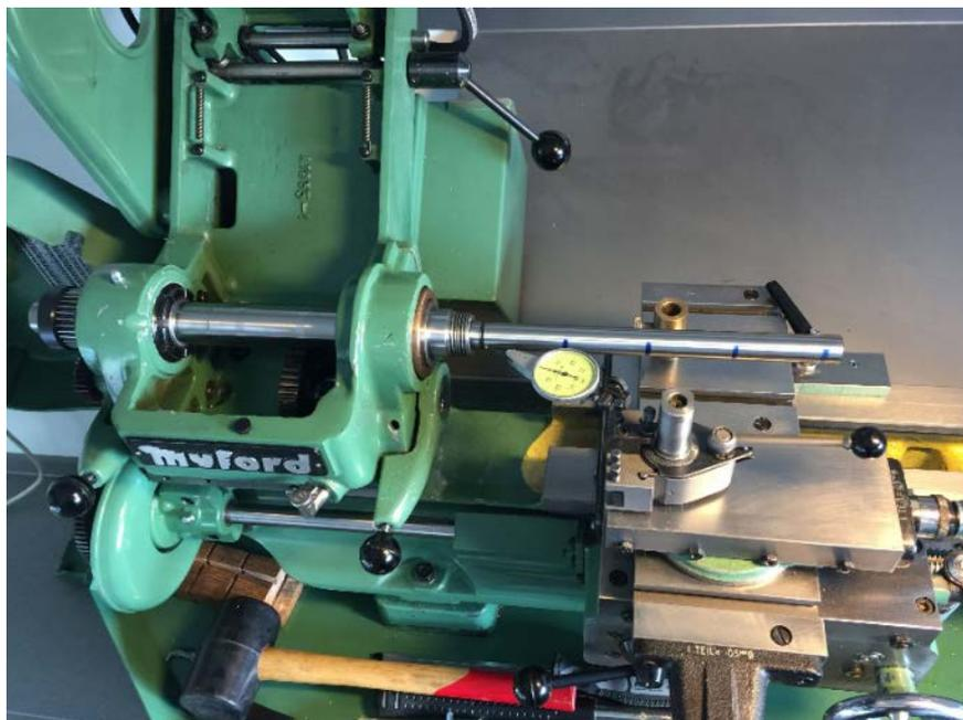
Abbildung 81: RDM-Messung mit MK2 Prüfstab
