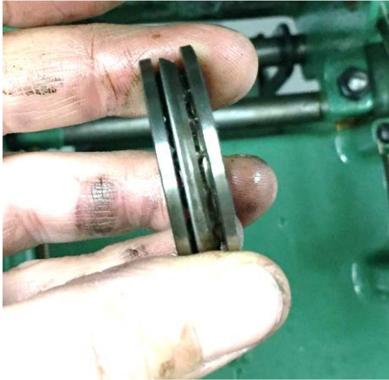
**Abbildung 103:** hier sieht man nochmal die 3 Teile des Drucklagers Q99
