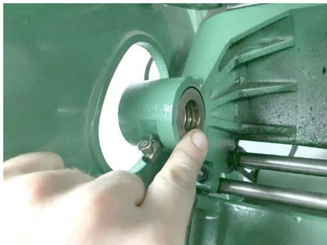
**Abbildung 98: das Drucklager muss noch raus**
