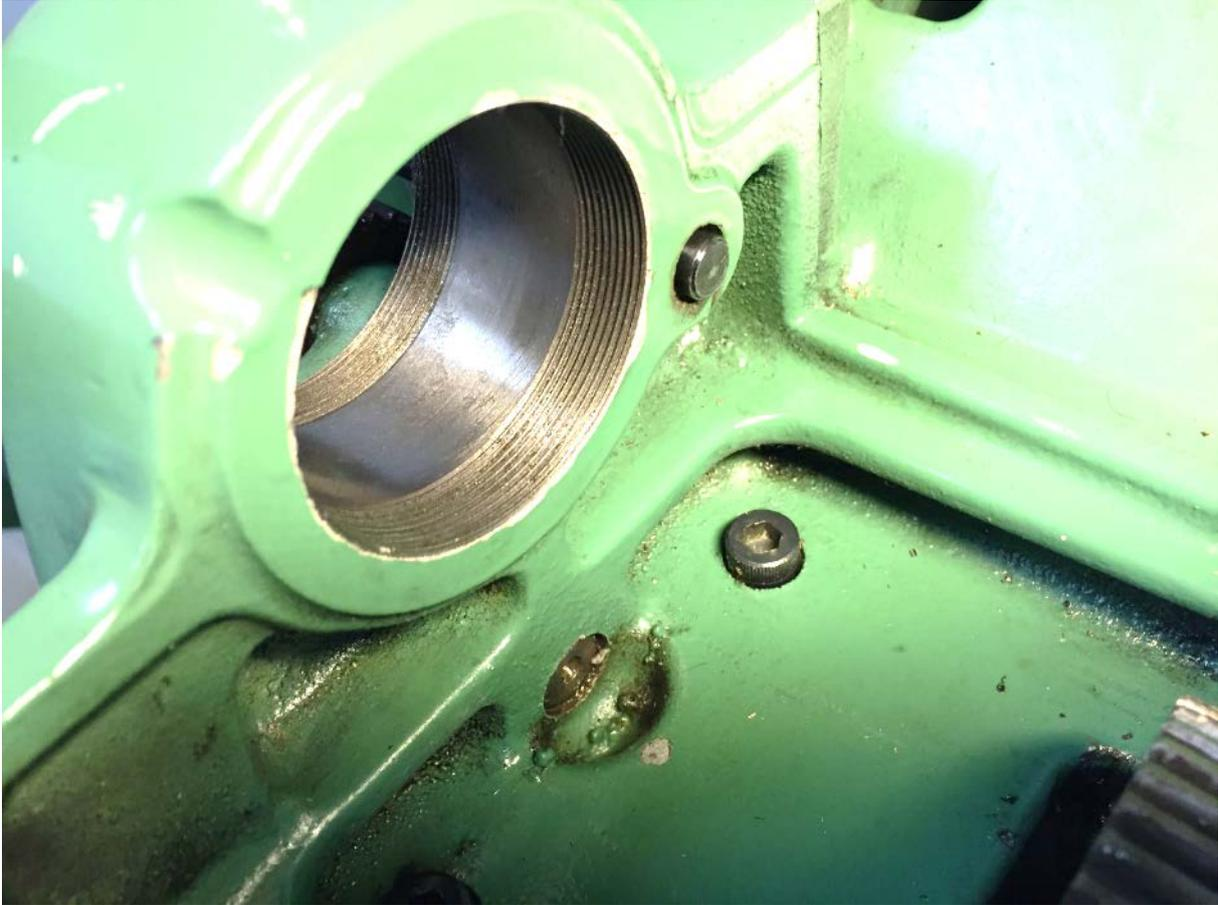
**Abbildung 62: alles leer! Man sieht gut die beiden Gewinde für die Wellenmuttern**
