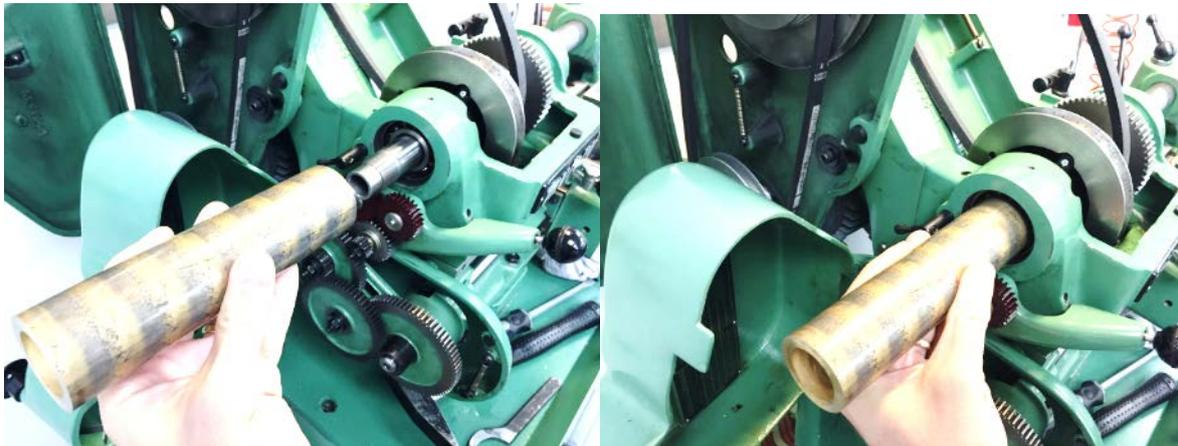
**Abbildung 76: ein Messingrohr dient als "Schlagholz"**
