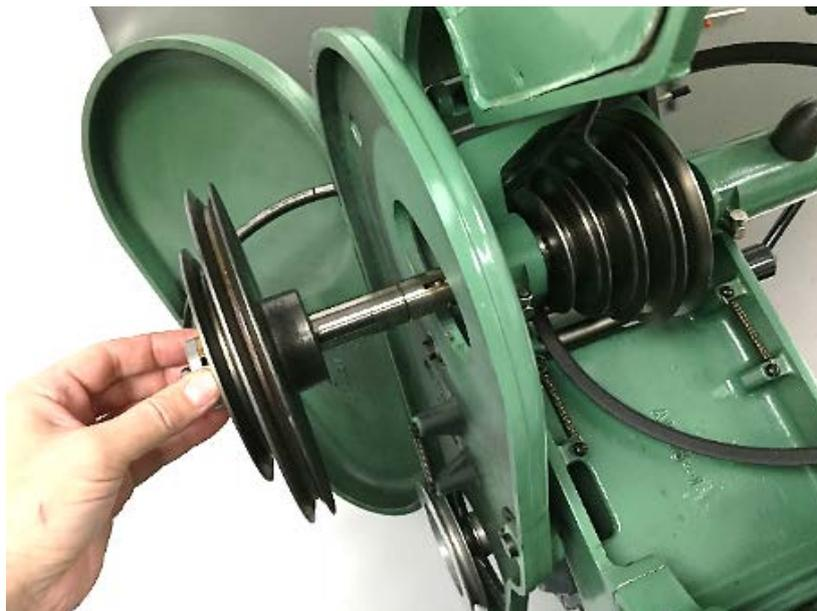
**Abbildung 92: die gesamte Welle kann nach links herausgezogen werden**
