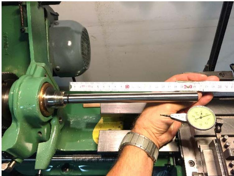
**Abbildung 47: der MK2 Prüfstab wird mit Filzstift in Abschnitte eingeteilt und so alle 5cm mit der Messuhr vermessen**
