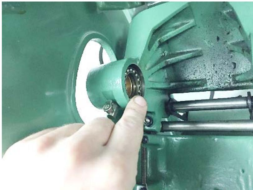
**Abbildung 100: Teil2: die Kugellagerscheibe des Drucklagers**
