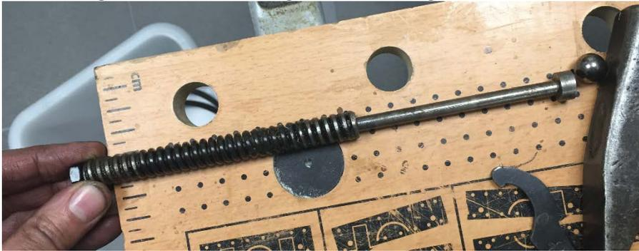
Abbildung 105: das ist da drin: lange Schraube, Feder, Kugel
