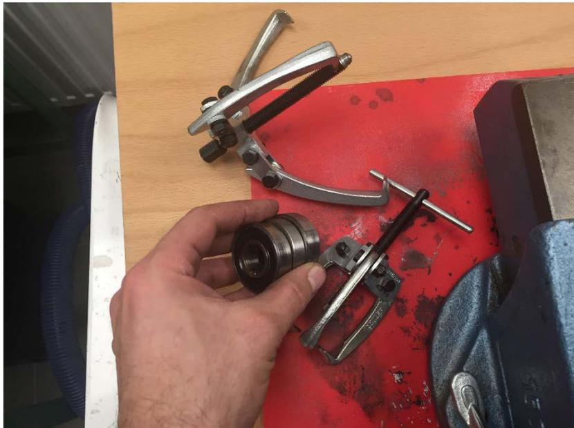
**Abbildung 109: mit einem Abzieher gehen die Lager schnell runter**
