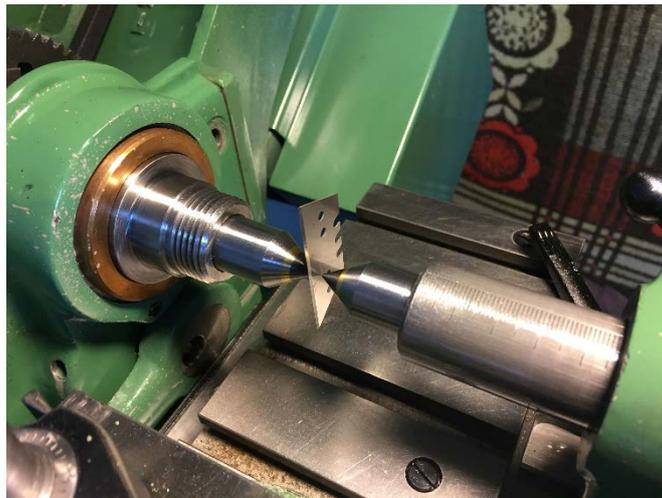
Abbildung 123: schneller Test auf korrekte Ausrichtung mit Rasierklinge
