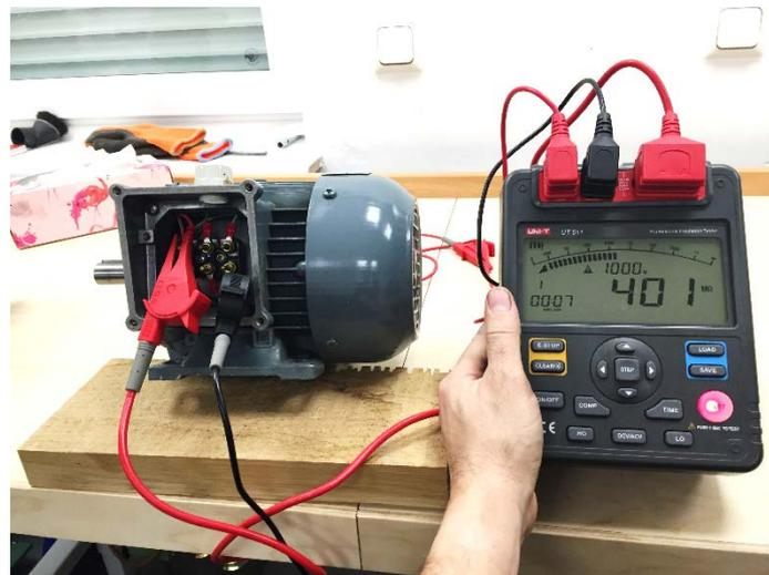
Abbildung 131: Isolationsprüfung des Motors
