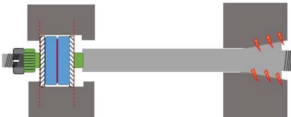
Abbildung 65: Spindel zu weit links: sie klemmt!
