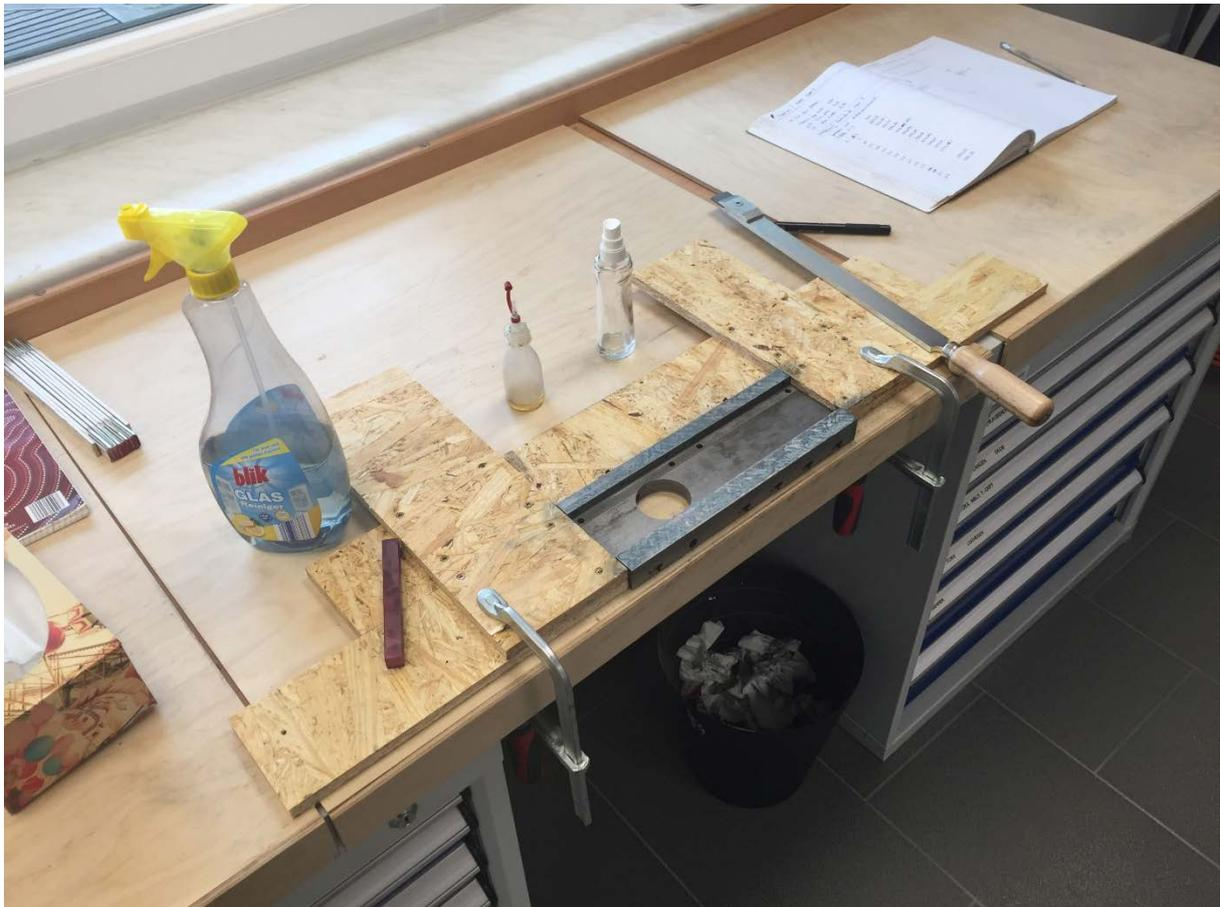
Abbildung 145: Querschlittenführungen werden geschabt
