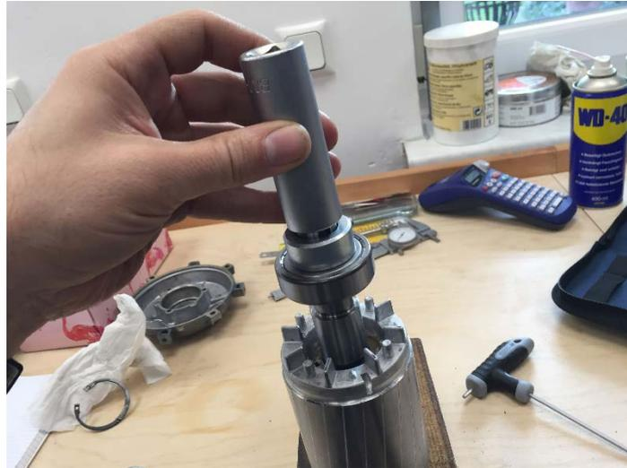
**Abbildung 137: der Motor kriegt neue Lager**
