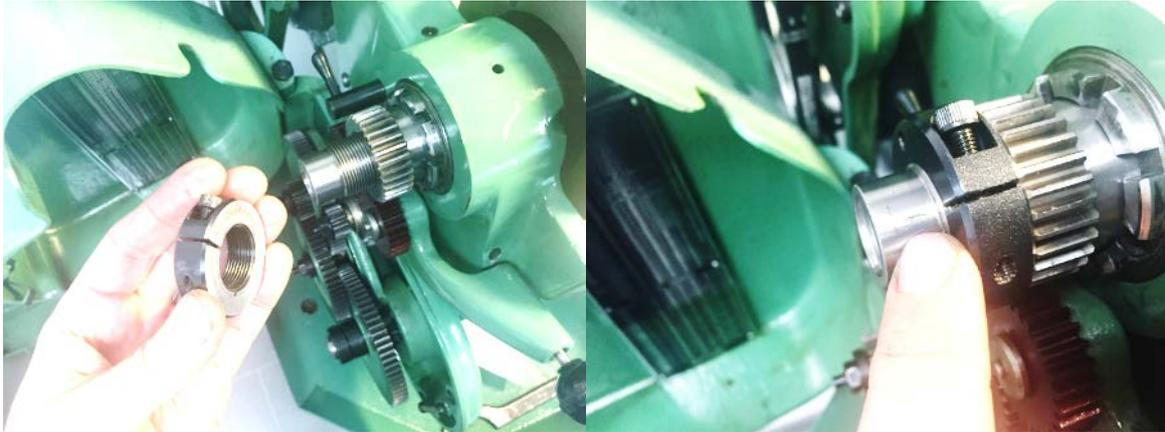
**Abbildung 74: Collar aufschrauben; rechts die Markierung des Herstellers**
