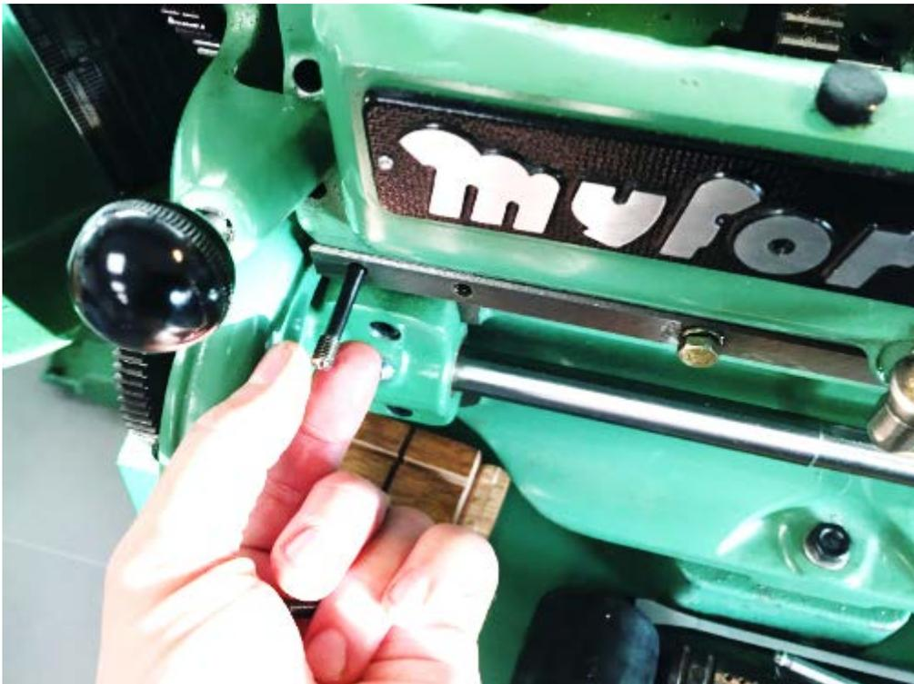
**Abbildung 85: eine der beiden Klemmschrauben**
