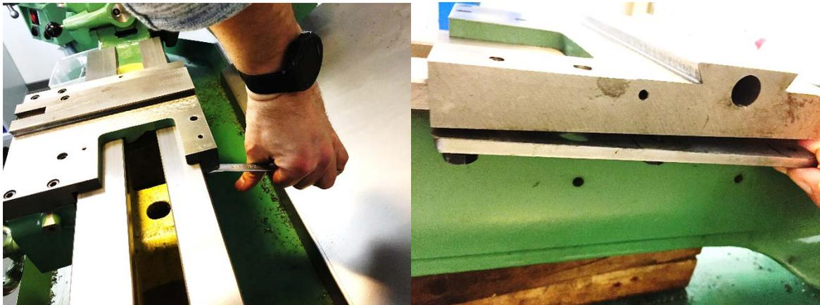
**Abbildung 23: hintere Klemmleiste abschrauben**
