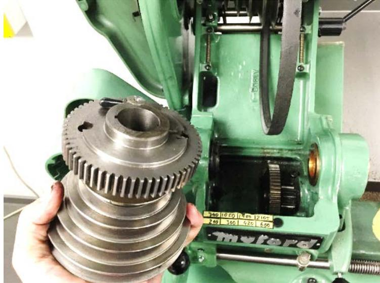
**Abbildung 57: Riemenscheibenpaket mit Bullgear**
