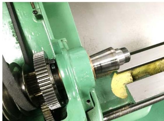
**Abbildung 52: Spindel herausdrücken**
