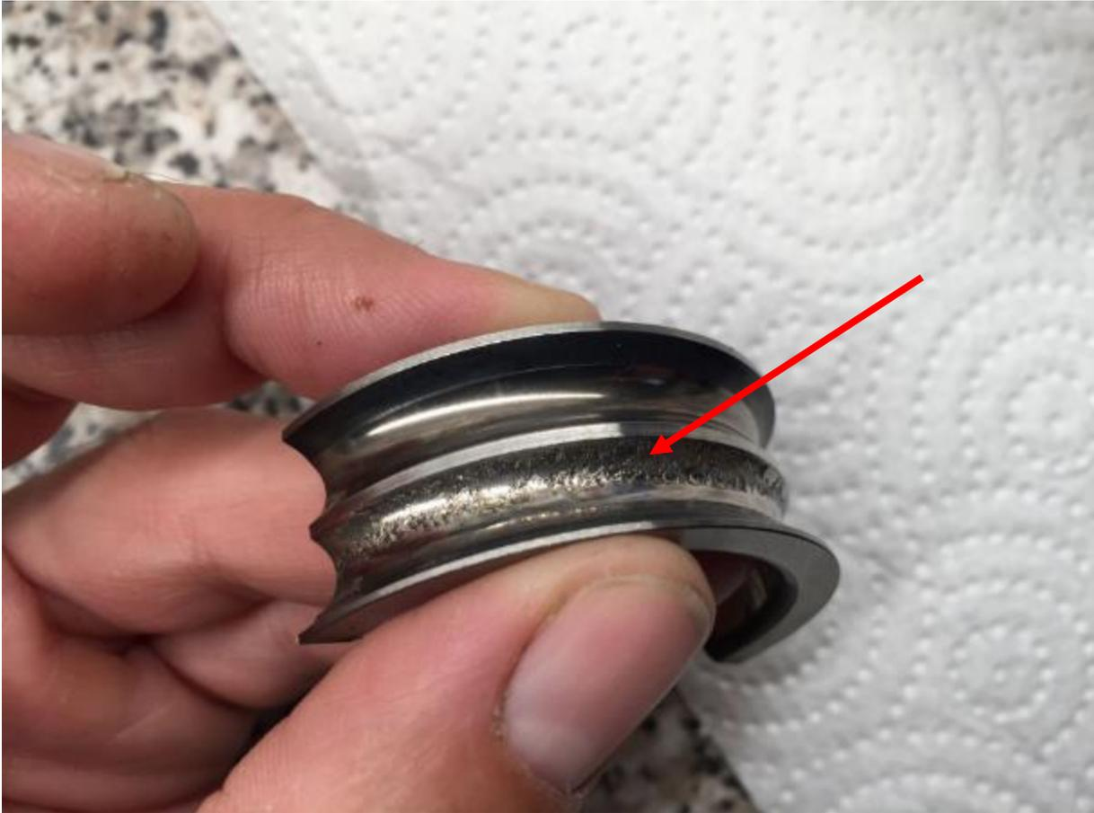
**Abbildung 67: aufgetrenntes Spindellager- ist das wirklich noch "Verschleiß"?**
