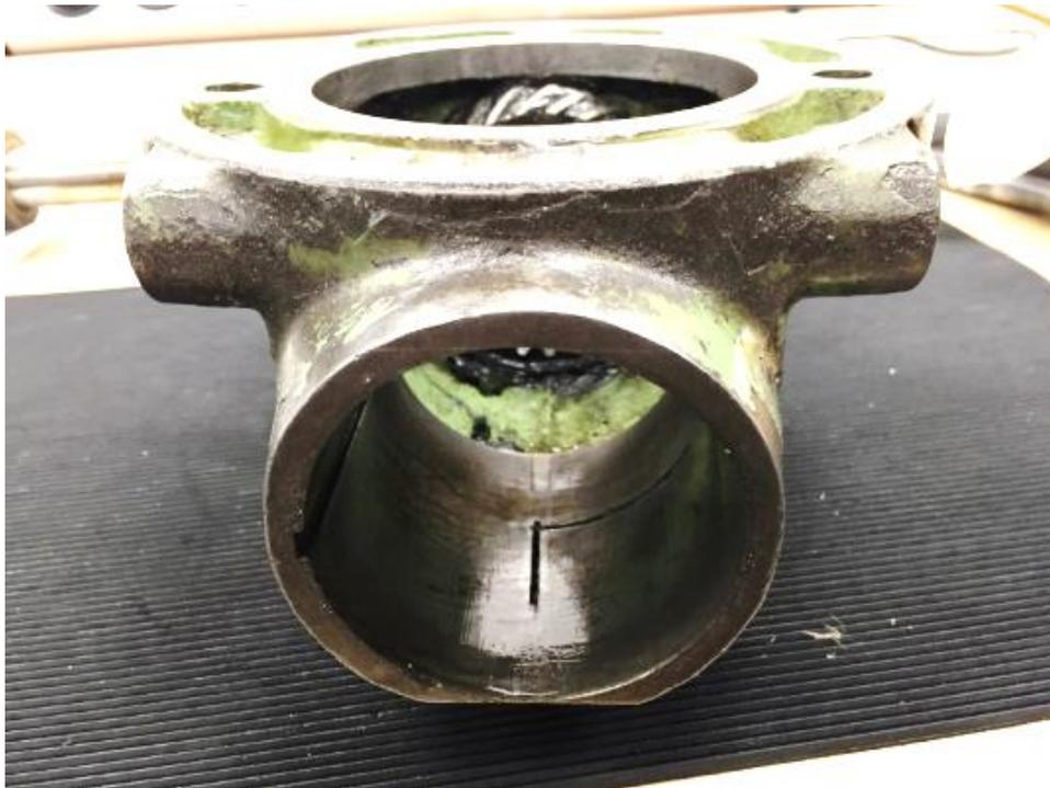
Abbildung 34: Blick auf das Fräskopfgehäuse
