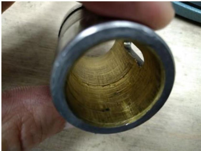
**Abbildung 78: das Gleitlager- Fläche und Geometrie inakzeptabel!**
