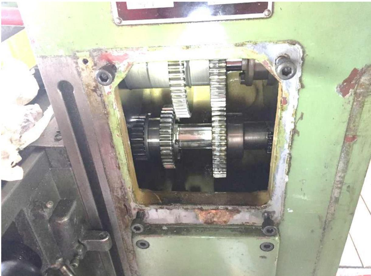
**Abbildung 88: Blick in das Fräsgetriebe**
