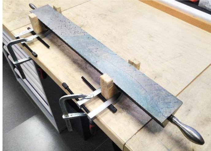
**Abbildung 237: meinTuschierlineal für Schwalbenschwanzführungen - braucht auch eine Auffrischung!**
