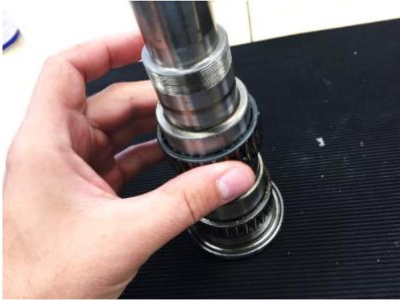
Abbildung 49: die Frässpindel
