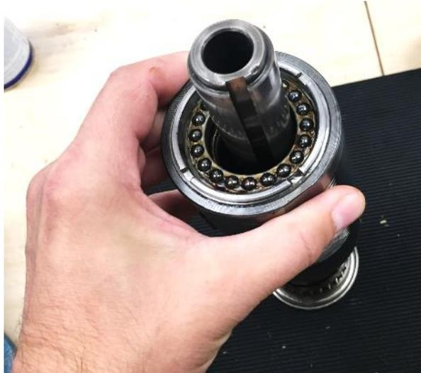
**Abbildung 41: oberes Drucklager**
