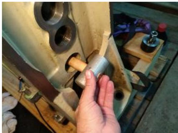
**Abbildung 190:** das vordere Lager kann z.B. mit einem Hammerstiel herausgeklopft werden
