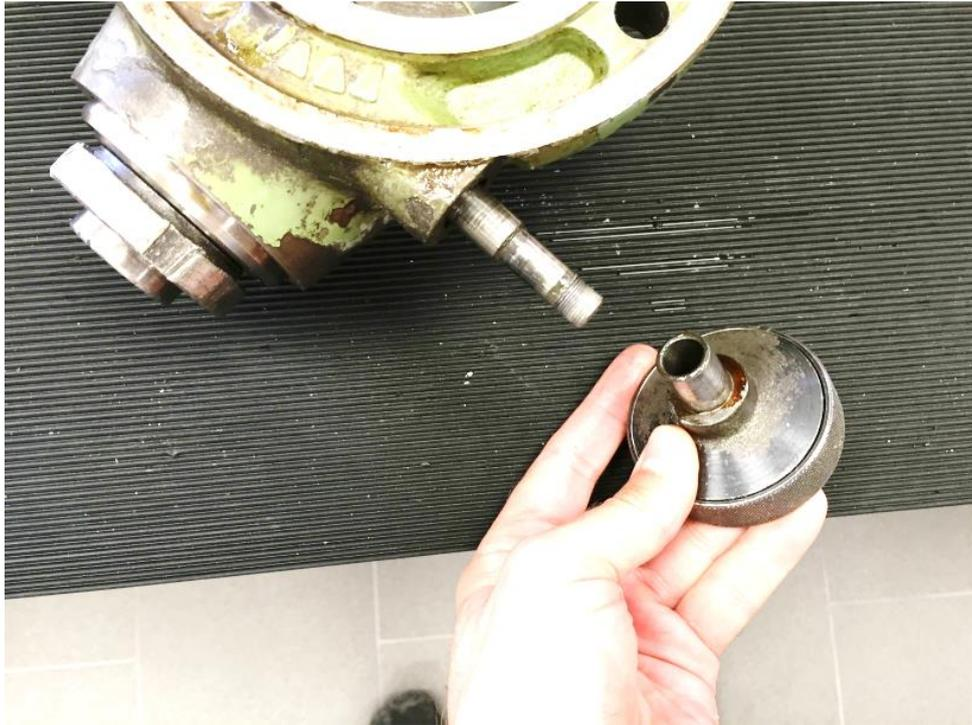
**Abbildung 23: Schließlich geht der Federkasten ab.**
