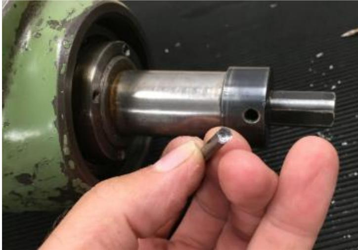
**Abbildung 29: das geht mir jetzt mit fast allen Kegelstiften so: alle muss ich ausbohren!**
