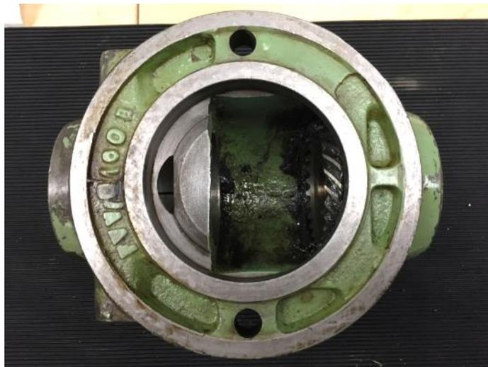
**Abbildung 33: Patrone ist raus- leeres Fräskopfgehäuse :-)**
