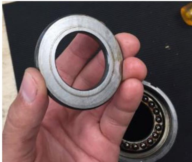
**Abbildung 45:---und noch ein Drucklager.**
