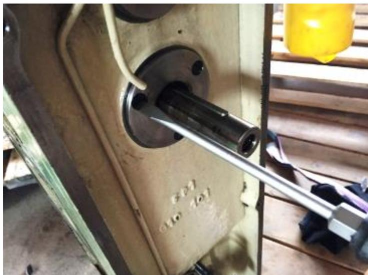
**Abbildung 113: Nun die Flanschplatte abschrauben.**
