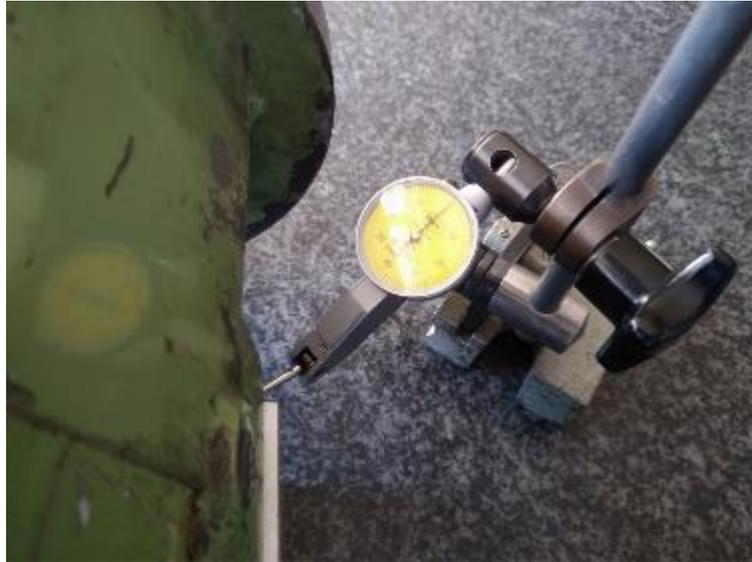
**Abbildung 226: also dann mal mit der Messuhr prüfen! Erste diese Ecke hier...**
