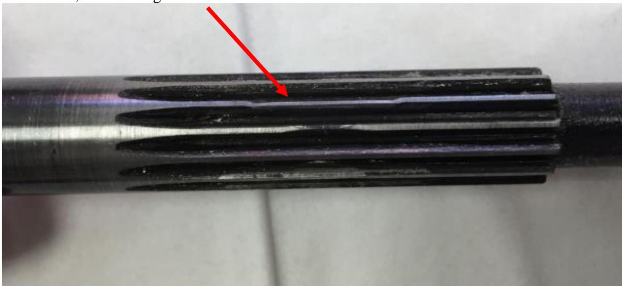
Abbildung 26: Spuren von Gewalteinwirkung an der Zahnwelle
