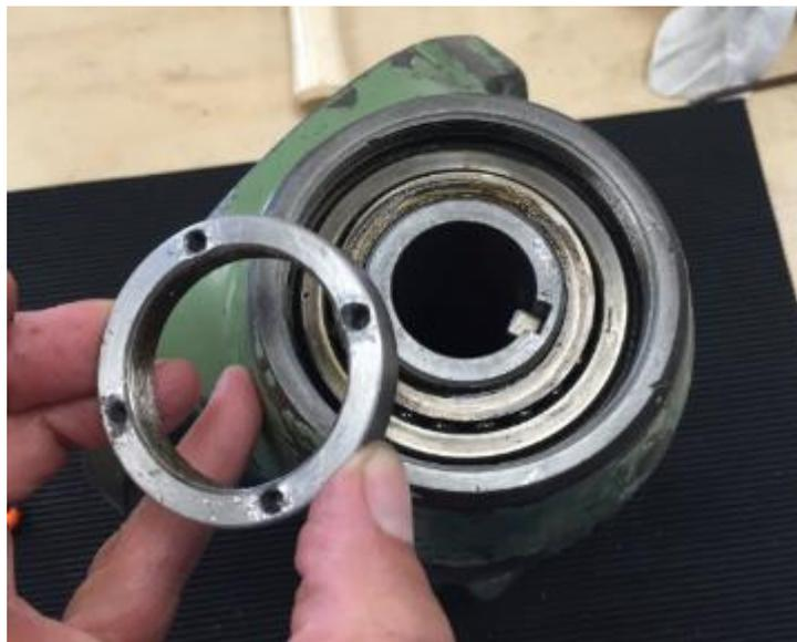
Abbildung 56: Achtung: diese Stirnlochmutter hat ein Linksgewinde!
