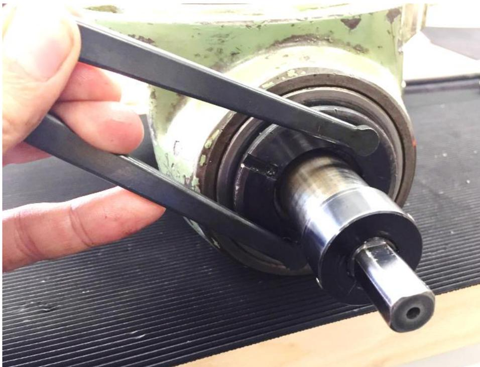
**Abbildung 17: Also zerlegen! Zuerst diese Stirnlochmutter...**
