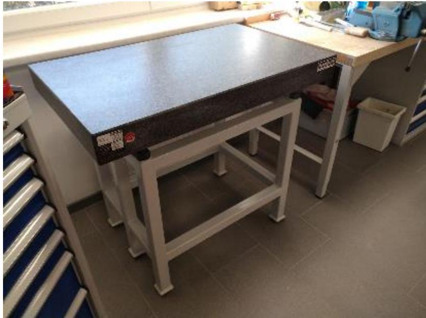
Abbildung 199: meine neue Messplatte- 1000x630mm von Planolith
