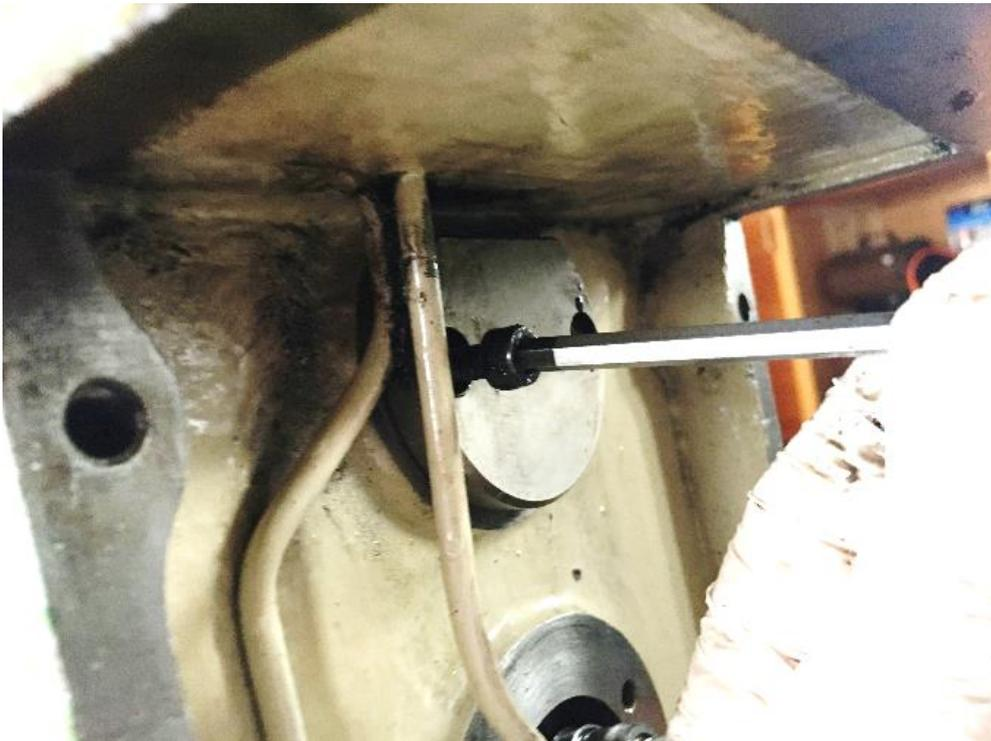
**Abbildung 99: erstmal diese beiden Schrauben lösen**
