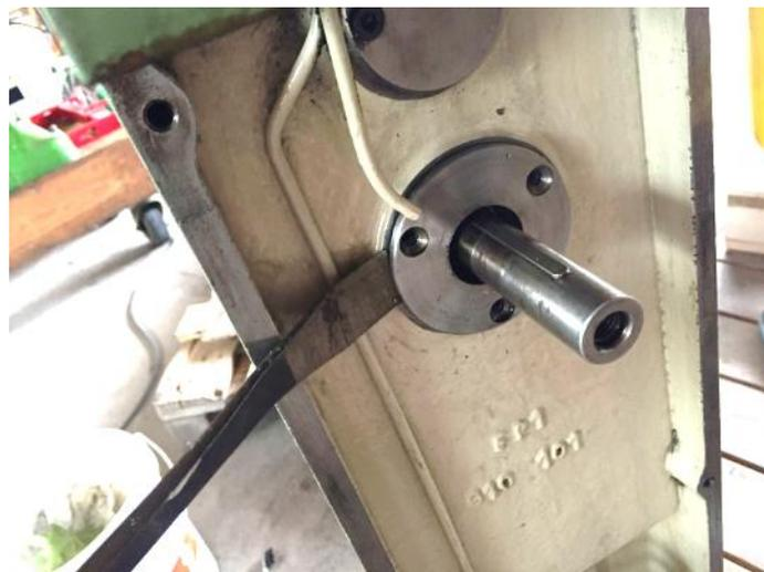
**Abbildung 115: Spargelstecher als Montier-/Hebeleisen**
