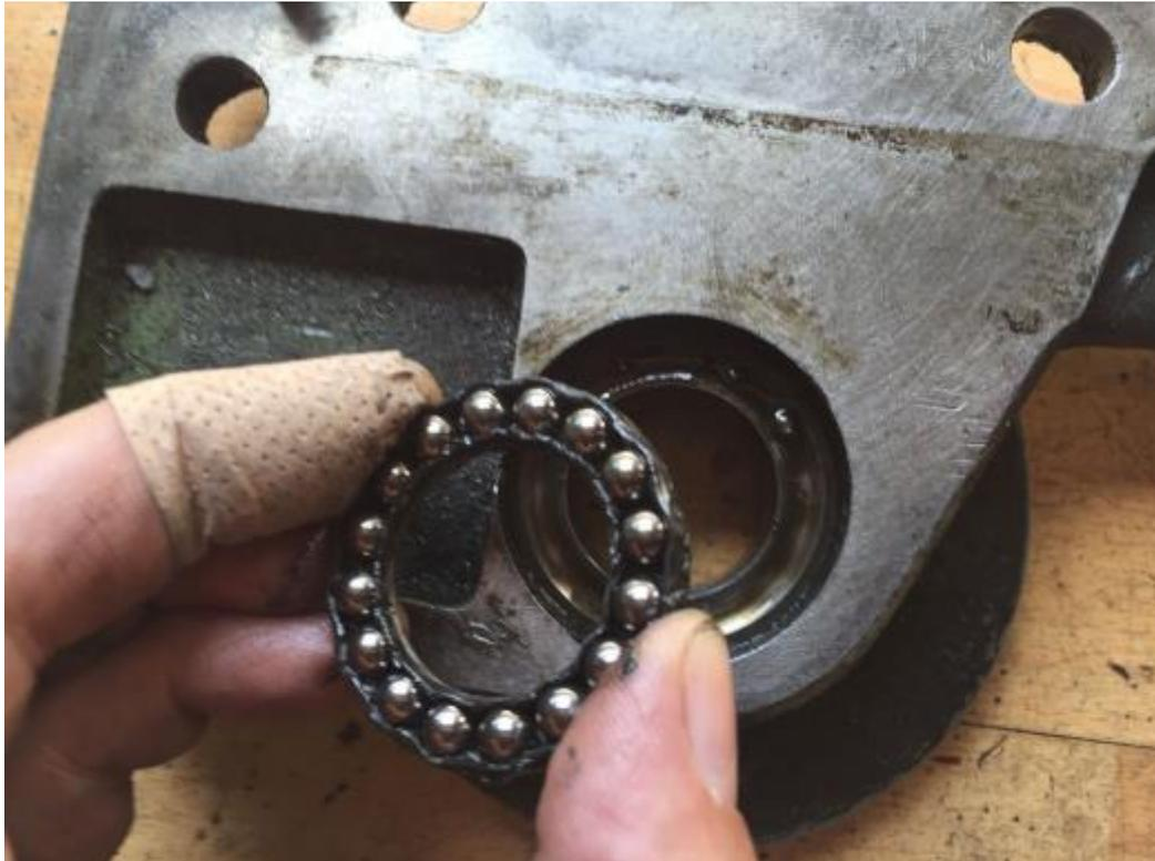
Damit später alles in richtiger Reihenfolge zusammgebaut werden kann, binde ich die Lagerteile mit Draht zusammen.
