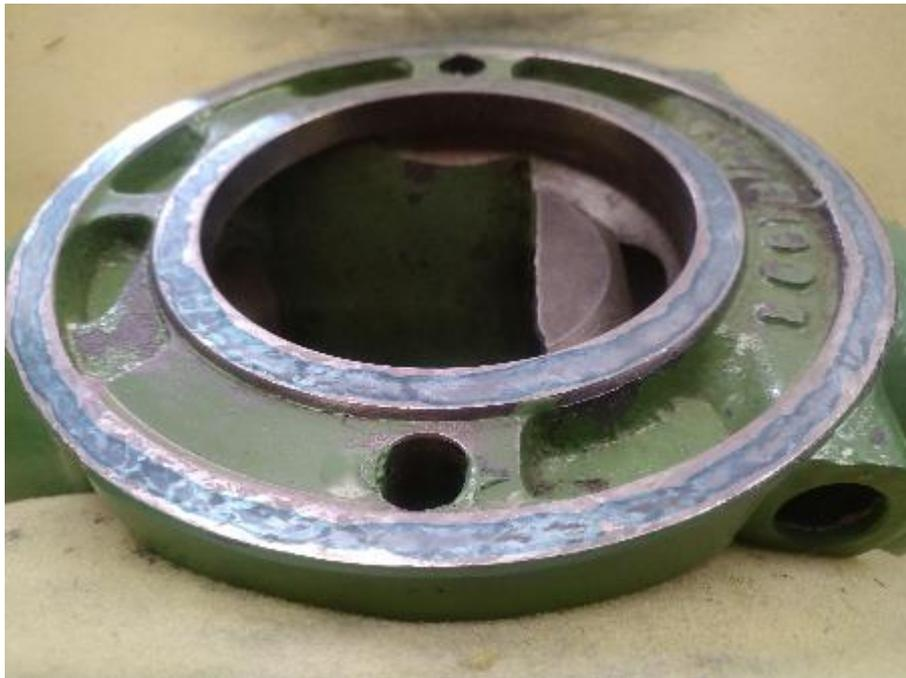
**Abbildung 206: zwar kein "Checkerboard"-Muster, wie es Richard King gefallen würde, aber für einen statischen "fit" sicher ausreichend**
