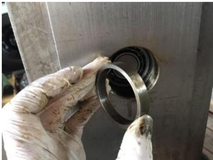
**Abbildung 127: mit etwas Wackeln kann man es herausnehmen**
