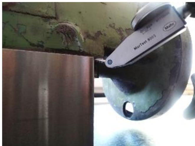
**Abbildung 227: so greift der Fühltaster unter die Referenzfläche**
