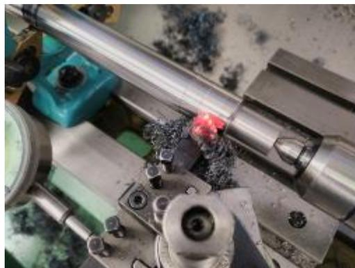
**Abbildung 81: die bestellte Präzisionswelle ist so hart, dass die Späne beim Drehen glühen!**
