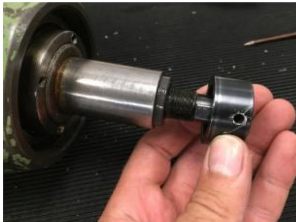
**Abbildung 30: Hülse der Zugstange abschrauben**
