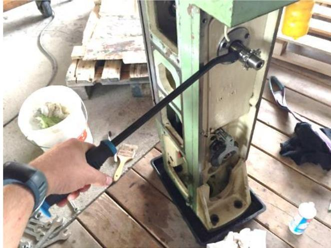
**Abbildung 111: Montiereisen als Hebelwerkzeug**
