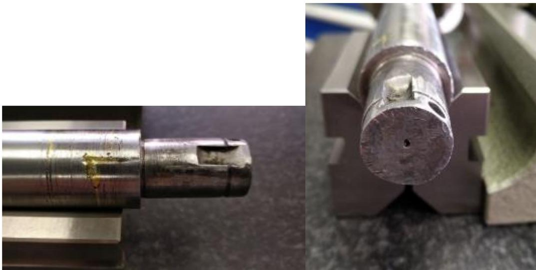
Abbildung 74: so sehen keine originalen Deckel-Teile aus!
