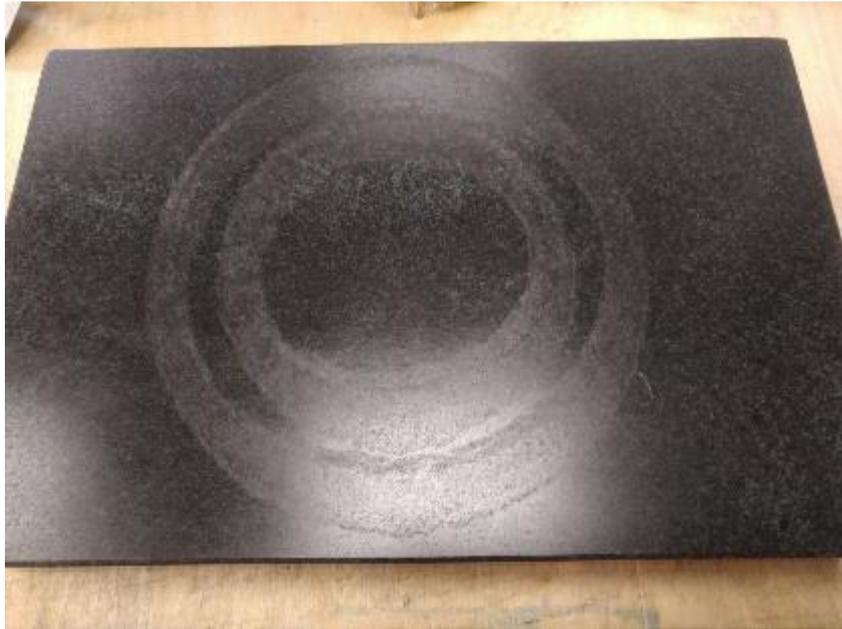
**Abbildung 205: deutlicher Abdruck im Tuschierfilm: scheint überall anzuliegen**
