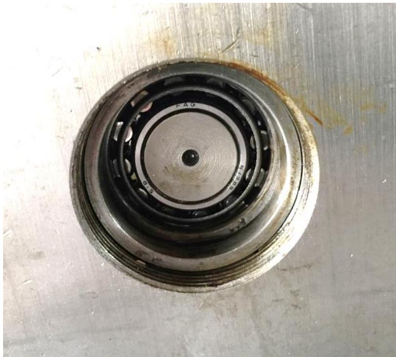
**Abbildung 125: Rollenlager NJ205**
