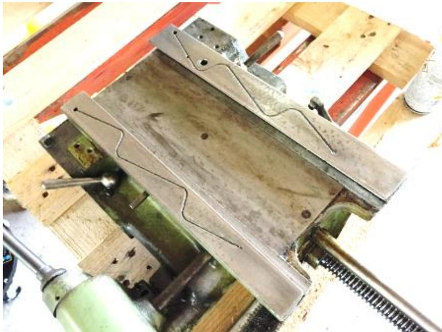
Noch ein Tipp: vor dem Herausgeben mit dem Kran kann man dem Z-Support etwas mehr Freiheit (=Spiel) geben, indem man die Keilleiste herausnimmt. Damit das geht, muss man diesen einen Schraubnippel entnehmen, denn der hält die Keilleiste fest, so dass sie nicht herausfallen kann. Die Deckel-Ingenieure haben auch wirklich an alles gedacht!
