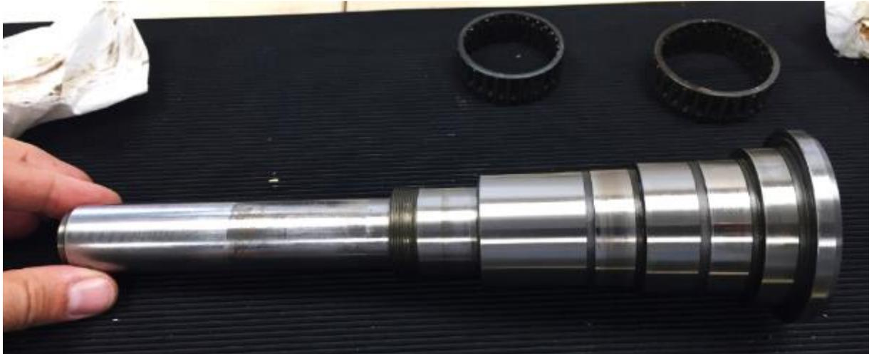
Abbildung 51: die Frässpindel
