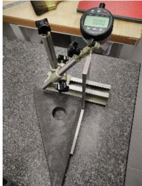
Abbildung 220: Ob Überprüfung auf Rechtwinkligkeit....
