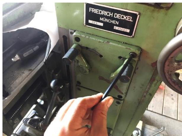
Abbildung 84: obere Revisionsklappe (Fräsgetriebe)
