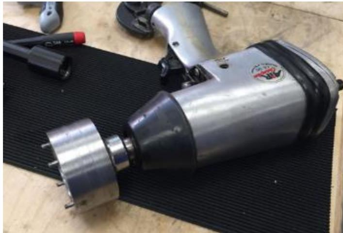
Abbildung 55: der Schlagschrauber leistet beim Lösen oft wertvolle Hilfe!
