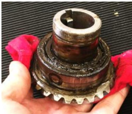
**Abbildung 61: das erste obere Spindellager**
