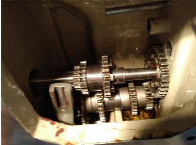
**Abbildung 167: die Welle wird nach links (in Richtung Schwalbenschwanz) herausgezogen**
