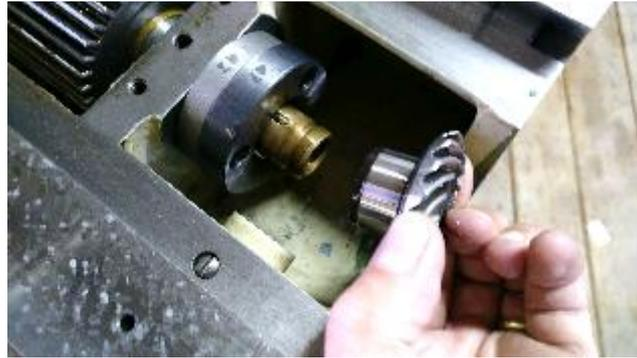
**Abbildung 91: dann das Kegelrad.**
