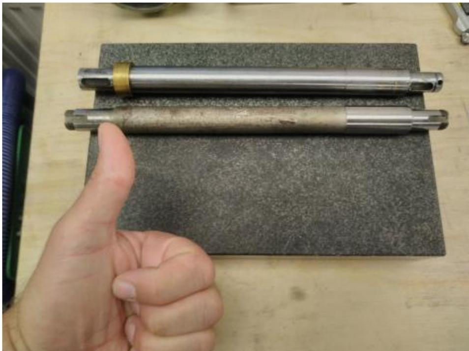
**Abbildung 82: Original (unten) und Nachbau (oben). Noch nichtmal die Länge der Nachbauwelle stimmt!**
