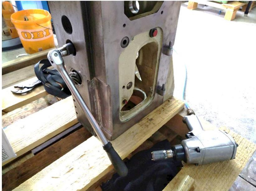
**Abbildung 174: Stirnlochmuttern lösen mit Spezialwerkzeug**
