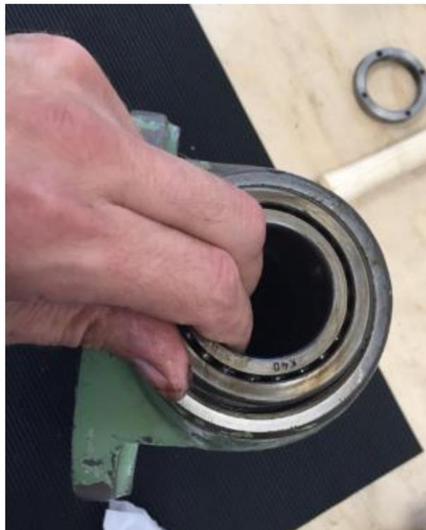
**Abbildung 62: das zweite obere Spindellager**
