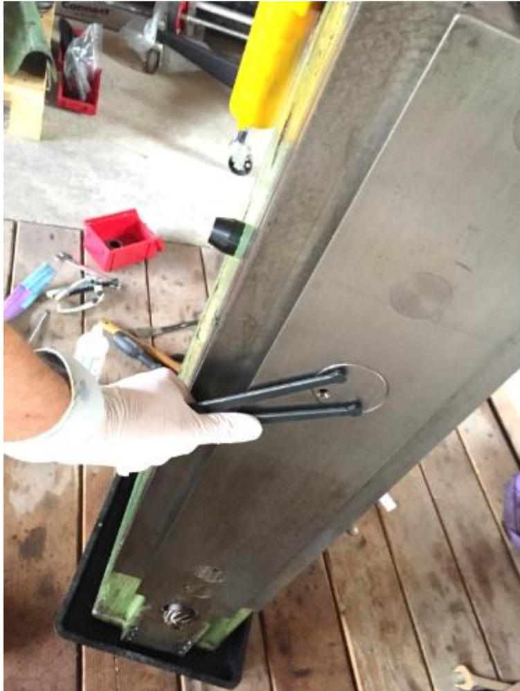
**Abbildung 121: ein verstellbarer Stirnlochschlüssel ist hier sehr hilfreich**
