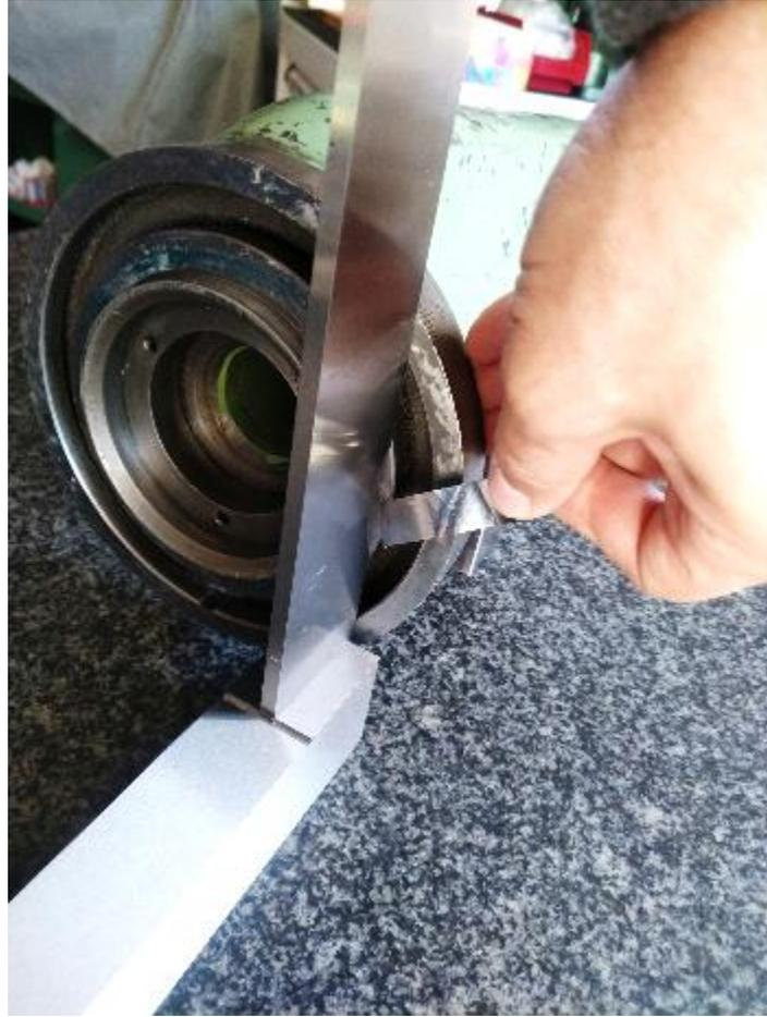
**Abbildung 231: Prüfung mit Fühlerlehrenband**
