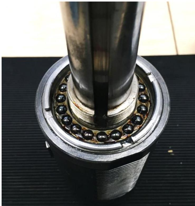
**Abbildung 40: eines der beiden Drucklager**
