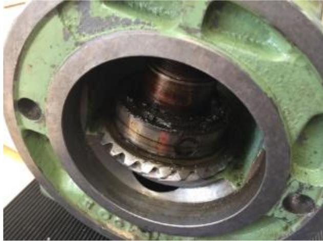
**Abbildung 57: das Kegelrad ist nun lose und fällt nach unten**
