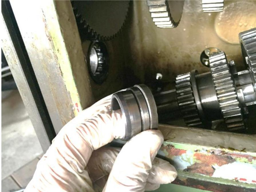
**Abbildung 132: die innere Lagerhülse des NJ205 und ein Distanzring**
