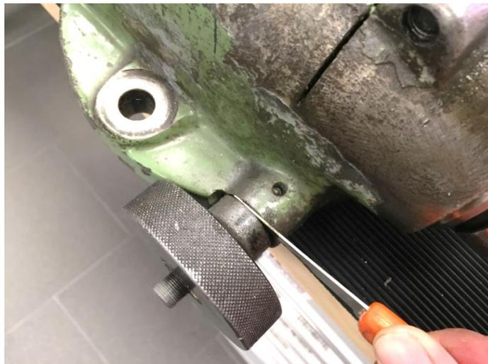
**Abbildung 21: ... dann mit einem Messer den Federkasten abhebeln.**
