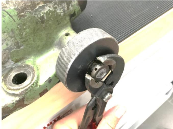
**Abbildung 20: Aber für einen weiteren Ausbau muss zuerst die Zahnwelle raus. Dazu diese Mutter runter...**
