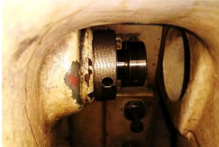
**Abbildung 186: ...und schon schiebt sich die Welle heraus (vorher Stift entfernen!)**
