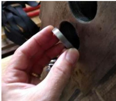
**Abbildung 173: Vorsicht: der Distanzring auf dieser Seite hat eine andere Dicke als auf der Motorseite!**
