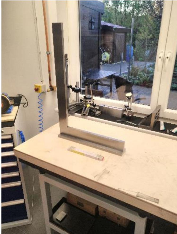
**Abbildung 240: ein echter Leckerbissen: 700mm Kontrollwinkel von Hahn&Kolb!**
