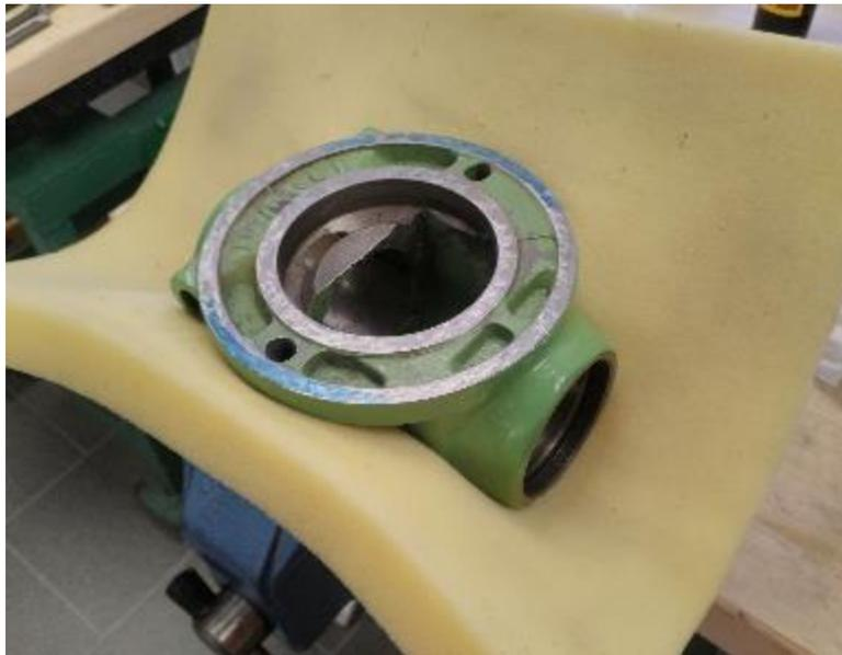
**Abbildung 204: Fräskopf im Schraubstock. Deutlich ist das Blau (nur!) in der Nähe der Schraublöcher zu sehen**
