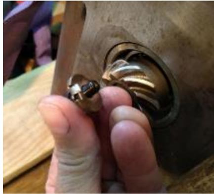
**Abbildung 183: so kann man die Schraube leicht entfernen**
