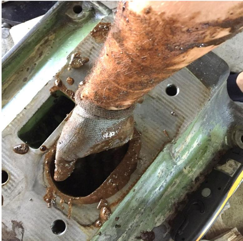
Der Fuß ist ja auch gleichzeitig der Kühlmittel-tank. Somit hat sich hier innerhalb von 60 Jahren eine etwa 3cm dicke Schicht aus altem Öl, Metallspänen und Kühlmittelrückständen gebildet. Nur noch mit einem kleinen Spachtel kann man das Zeug abschichten- so ähnlich wie bei einem Tortenboden aus einer industriellen Großbäckerei. Es sieht auch so aus:
