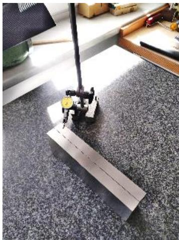
Abbildung 221:...oder Check der Parallelität von Fräsunterlagen- auf einmal passt alles zusammen!
