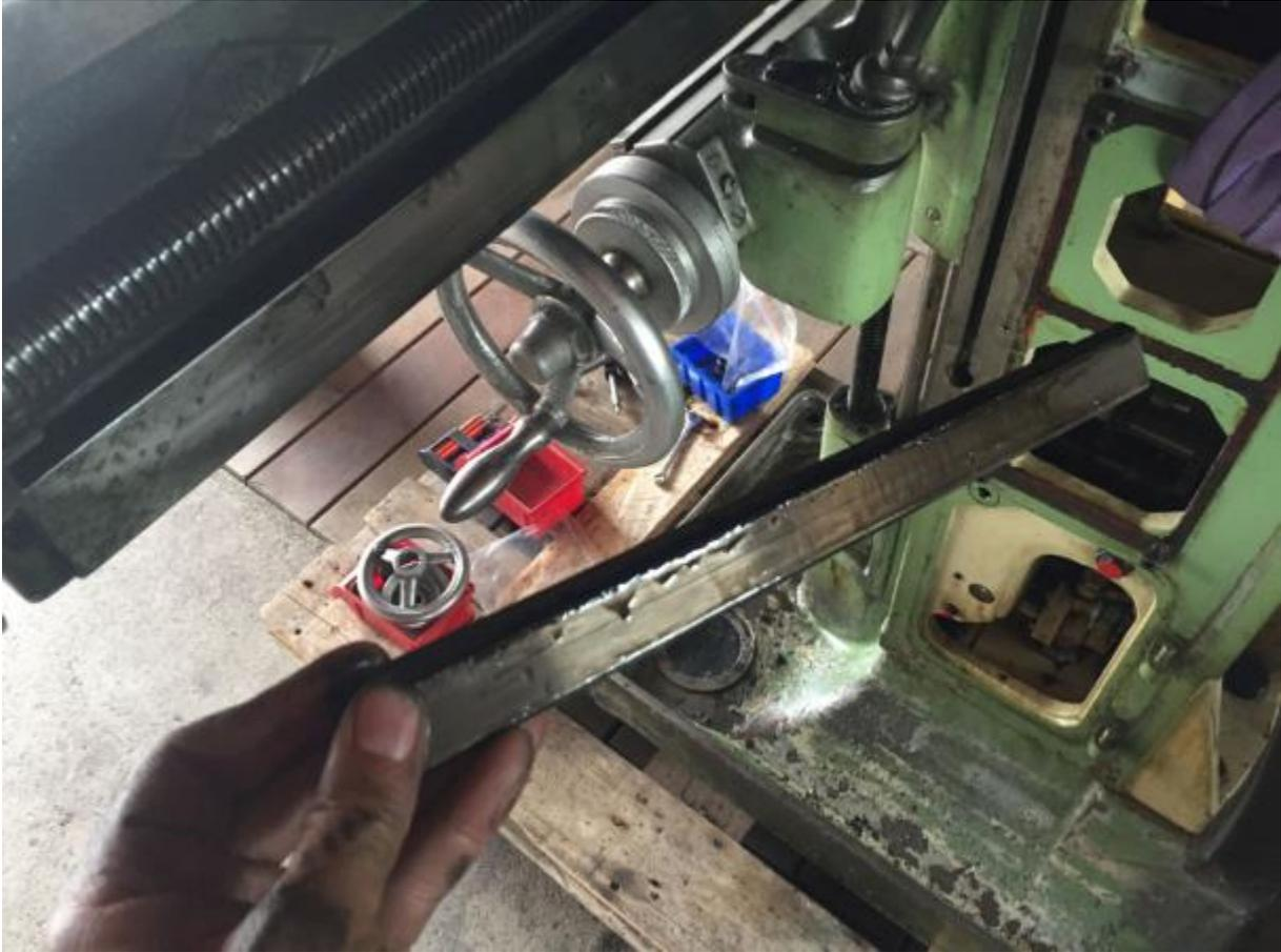
Und jetzt Vorsicht: mit Entnahme der Keilleiste wippt der X-Support rechts nach unten. Weil die Spindel aber noch drinnen steckt, könnte sie nun verbogen werden, wenn man den X-Support nun nicht abstützt auf auffängt!
