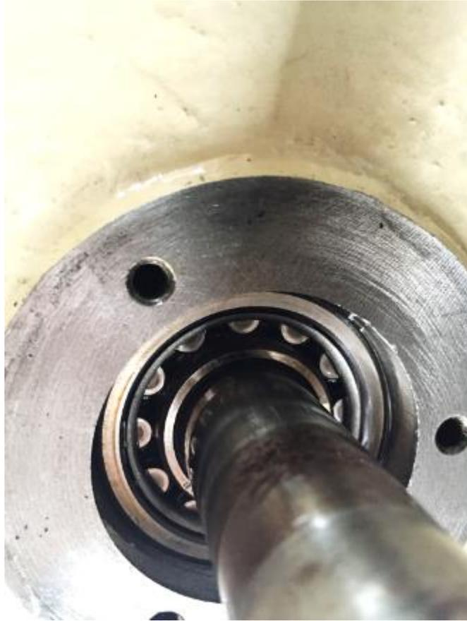
**Abbildung 118: ein Zylinderrollenlager des Typs NJ205**
