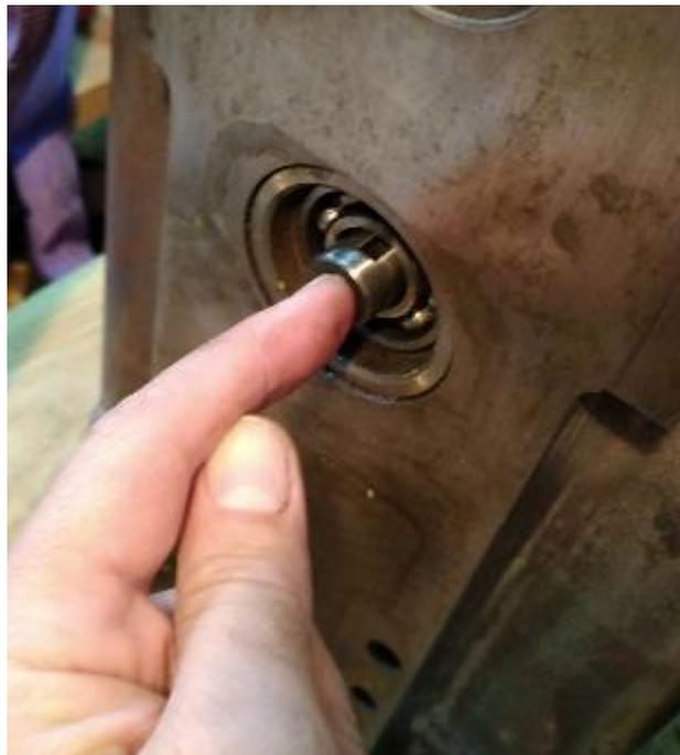
**Abbildung 185: nachdem die Passfeder entfernt wurde, reicht auch hier ein einfacher Fingerdruck...**
