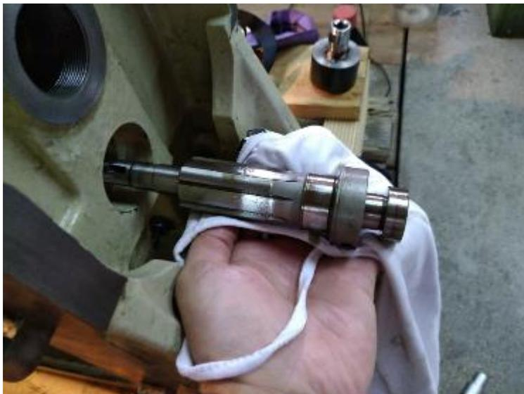
**Abbildung 187: durch das hintere Loch kann die Welle entnommen werden**
