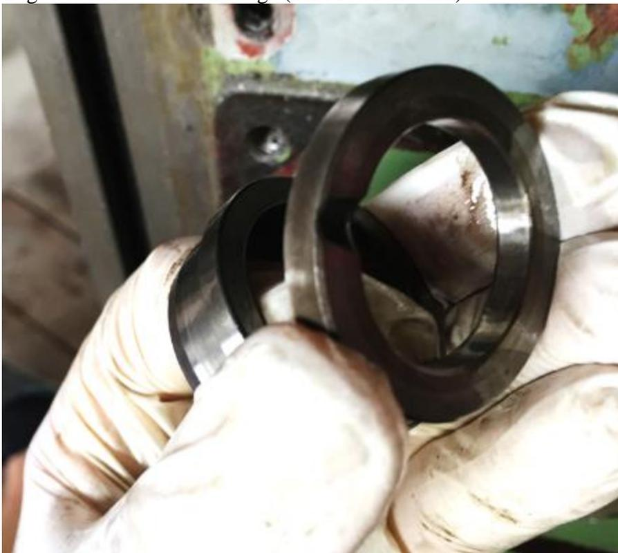
**Abbildung 133: die Kerbe dient sicherlich der Einleitung von Öl**
