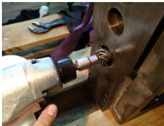
**Abbildung 181: die Stirnschraube lockert man am besten mit einem Schlagschrauber**
