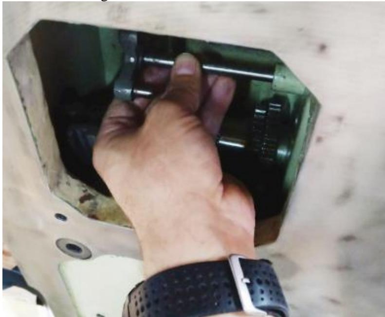
**Abbildung 149: Schubstange nach innen herausziehen**
