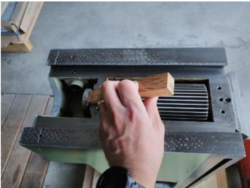
**Abbildung 95: dann mit einem Holzstab und leichten Hammerschlägen die Welle austreiben**
