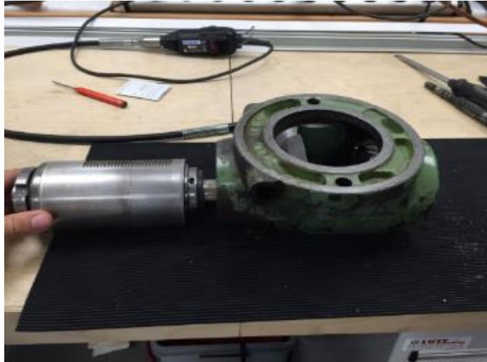
**Abbildung 32: die Patrone gleitet aus dem Fräskopfgehäuse**
