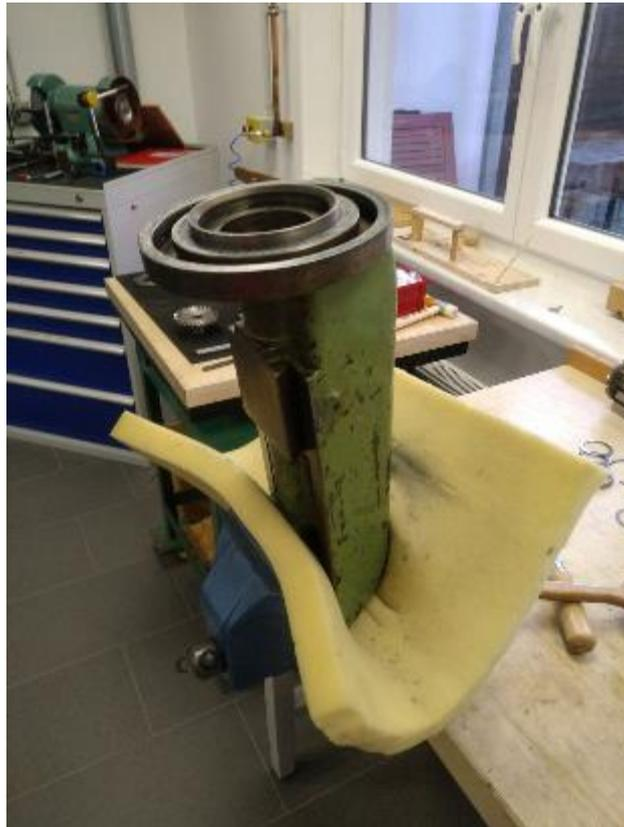
Abbildung 207: so sieht der Ausleger aus, an den der Fräskopf geflanscht wird
