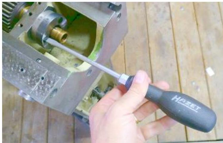
**Abbildung 92: Schlitz-Schrauben herausdrehen,...**
