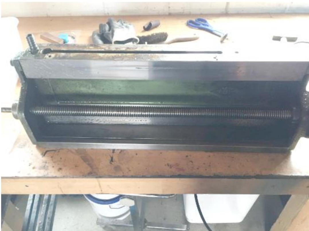
Alternativ hätte man auch die Spindel erst entnehmen können, indem man die beiden seitlichen Platten mit den 10er Inbus-Schrauben gelöst und die Spindel herausgekurbelt hätte. Danach hätte man den X-Support dann OHNE die Gefahr des Verbiegens der X-Spindel abnehmen können.
