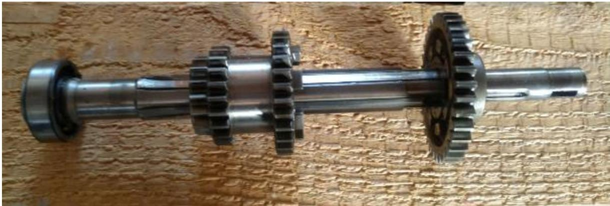
**Abbildung 168: Welle Nr.3 ist ausgebaut**
