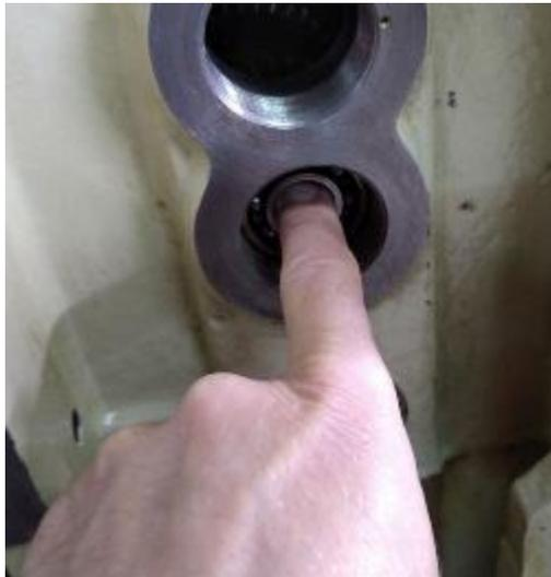
**Abbildung 177: die Welle kriegen wir dann mit einem einfachen Fingertipp heraus**
