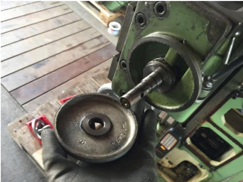
Versuch, die Kontermuttern mit zwei Hakenschlüsseln zu lösen.
