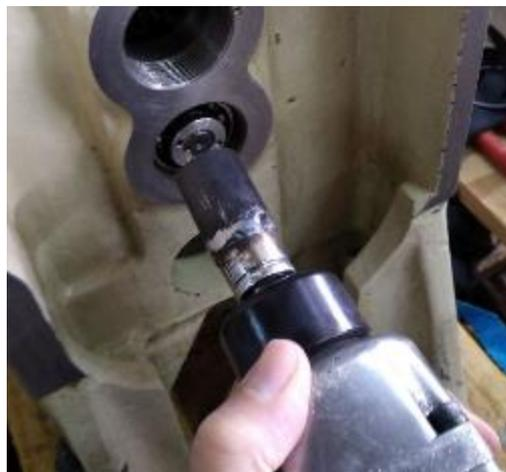
**Abbildung 175: eine der beiden Stirnlochmuttern**
