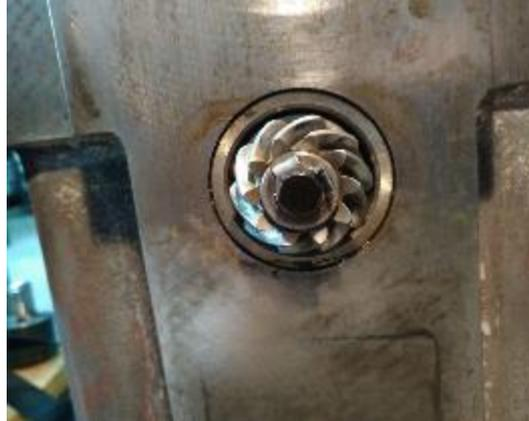
**Abbildung 180: Welle Nr.5 treibt die Bewegungsachsen des Frästisches an**
