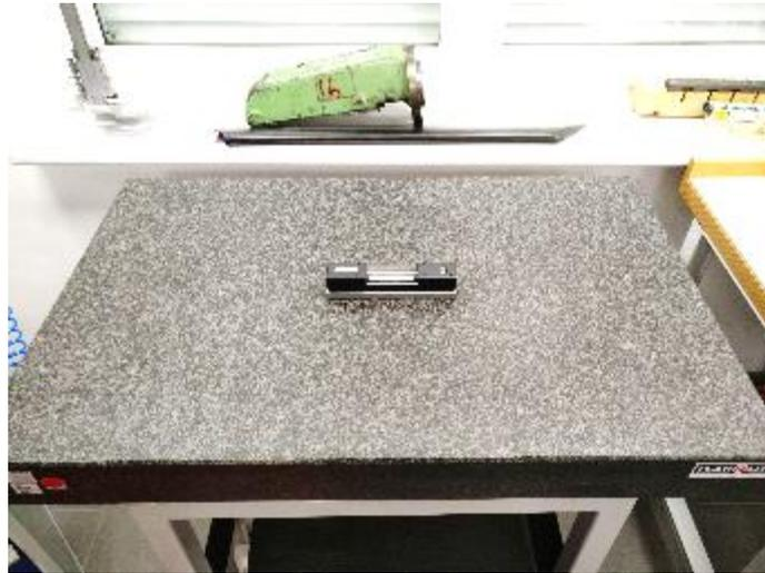
Abbildung 214: Messplatte nivellieren
