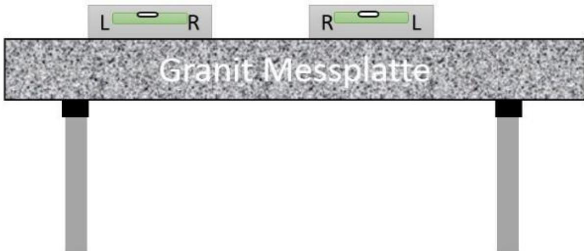
Abbildung 218: Untergrund gerade, Wasserwaage korrekt justiert
