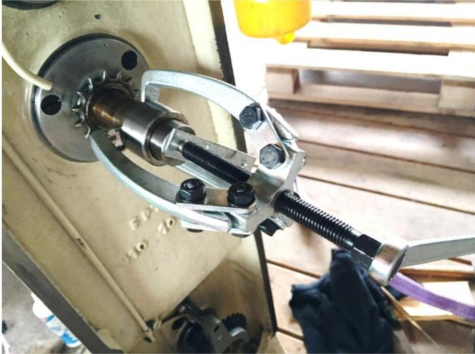
**Abbildung 109: Kugellager-Abziehwerkzeug**
