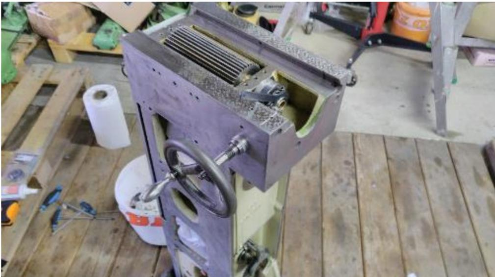
Abbildung 89: mit Zapfenschlüssel 30..32 lösen, mit Handrad gegenhalten
