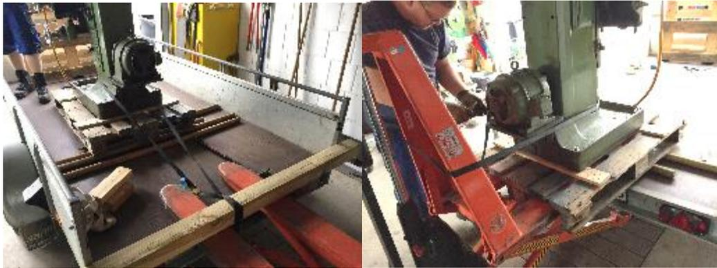
**Abbildung 10: per Spanngurt auf den Hubwagen ziehen**
