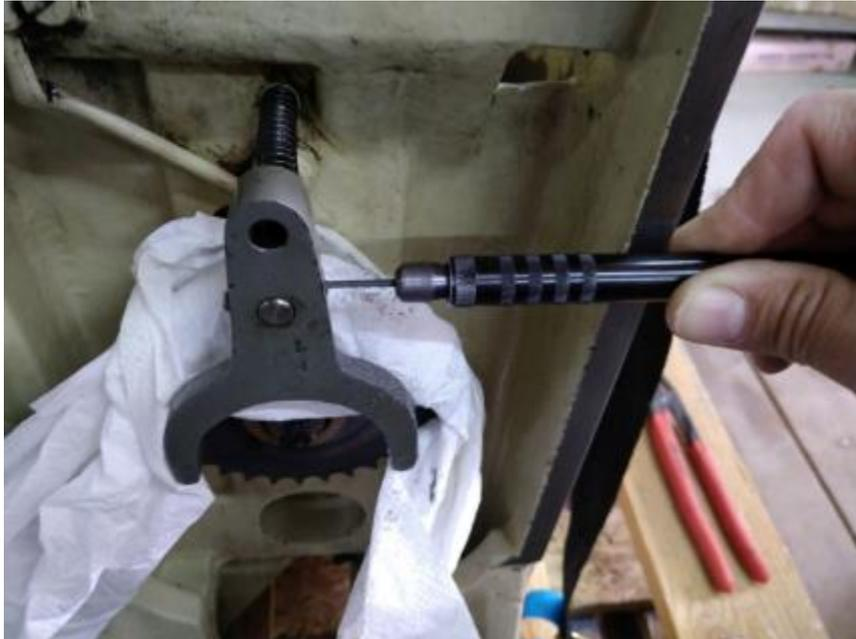
Abbildung 147: Kegelstift ausbohren
