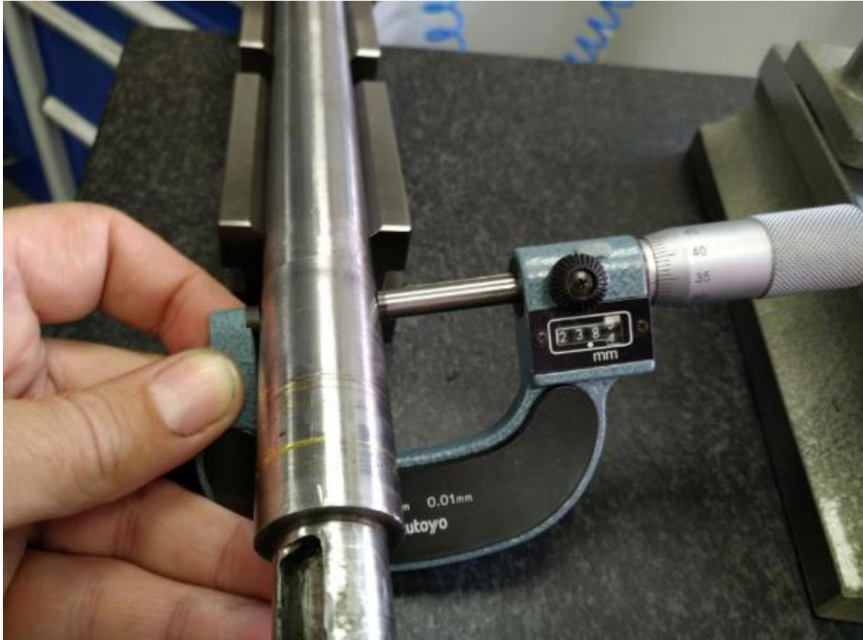
**Abbildung 79: vorne und hinten gemessen, ist diese Lagerfläche etwa 50µm zylindrisch- sogar zu schlecht für eine Standard H7-Toleranz!**
