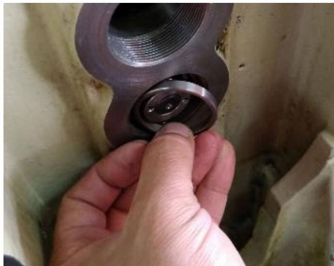
Abbildung 171: auch hier ein Distanzring zur korrekten Längs-Positionierung der Welle
