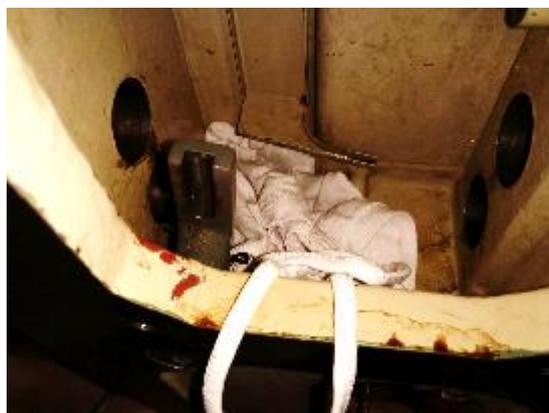
**Abbildung 182: zum Gegenhalten bietet sich ein alter Putzlappen an, mit dem man die Welle blockiert**
