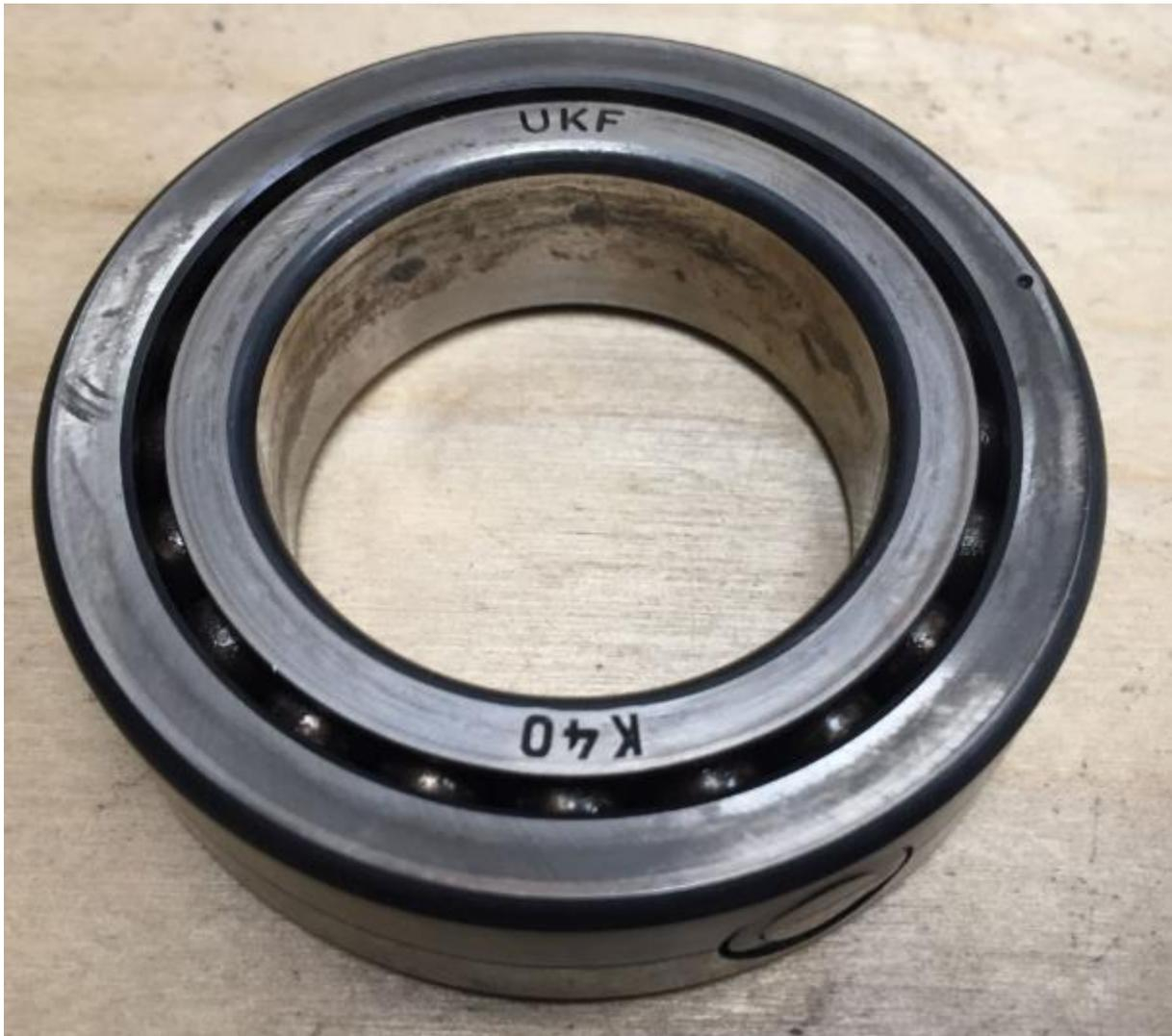
**Abbildung 66: das macht Probleme: die beiden oberen Spindellager!**
