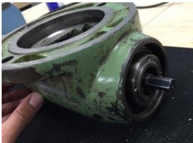
**Abbildung 31: jetzt nur noch hinten draufhauen und die Zugstange fällt nach unten heraus**
