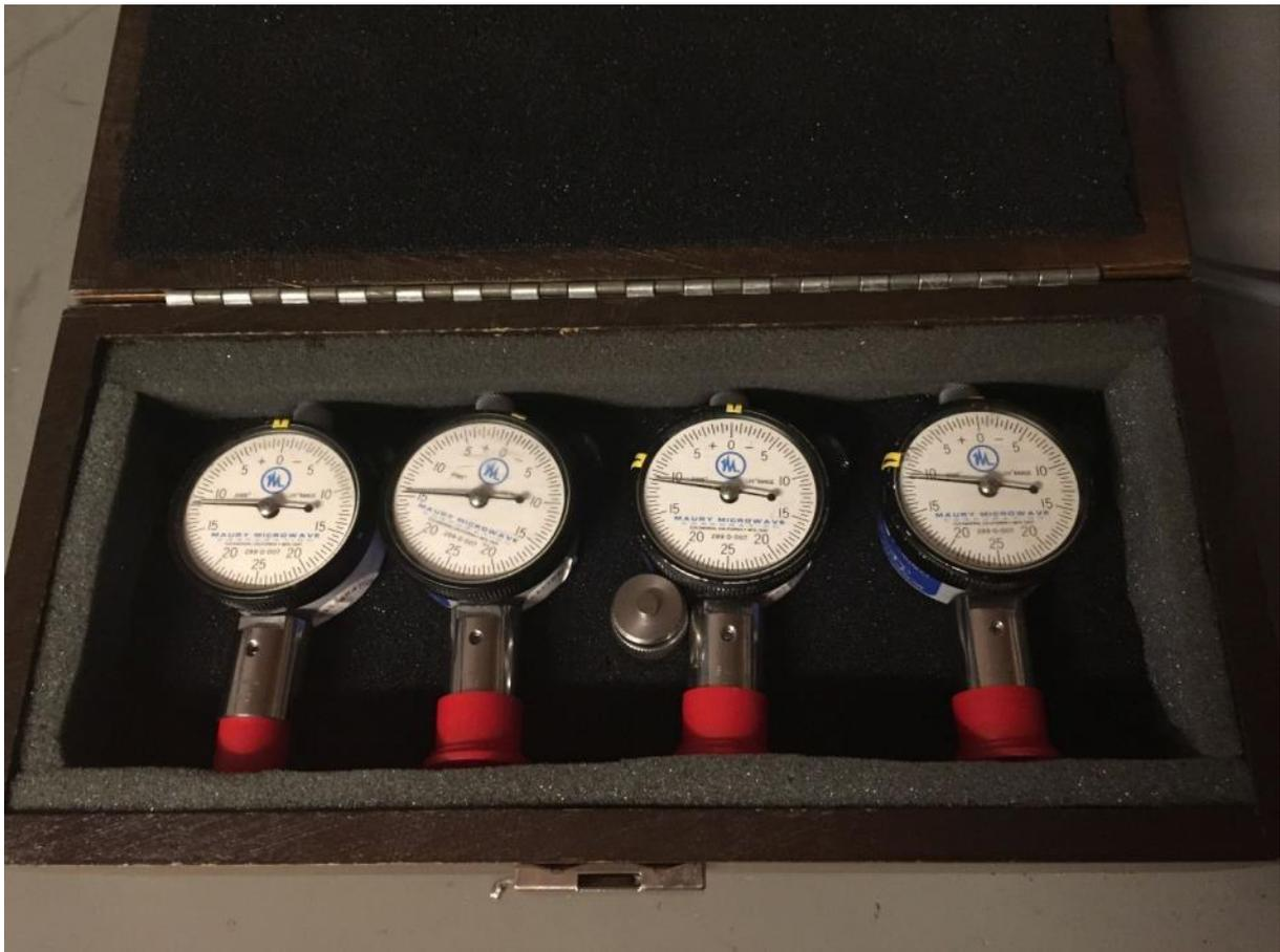
Abbildung 47: Pin Depth Measurement Gauge Set
