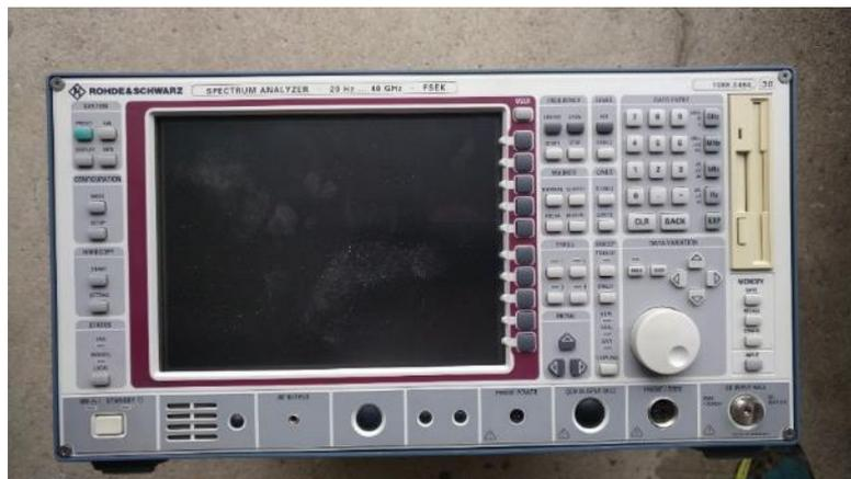
Ich werd' verrückt!! In dem Karton liegt ein Rohde&Schwarz FSEK30- also das damalige Spektrumanalyzer Top-Modell aus dem Hause R&S mit einem Frequenzbereich von 20Hz bis 40GHz!!
