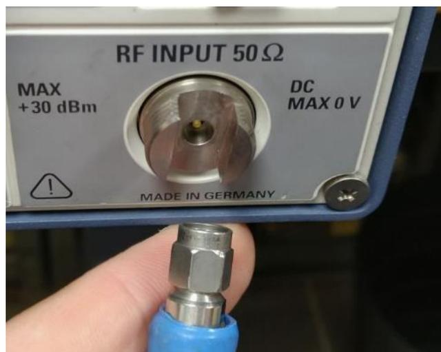
**Abbildung 4: Planar-Adaptersystem von R&S an einem FSEK30**
