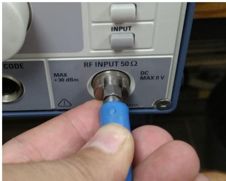
Abbildung 6: nicht kontaktiert, aber drangehalten: PC2,92mm an Planar-Buchse
