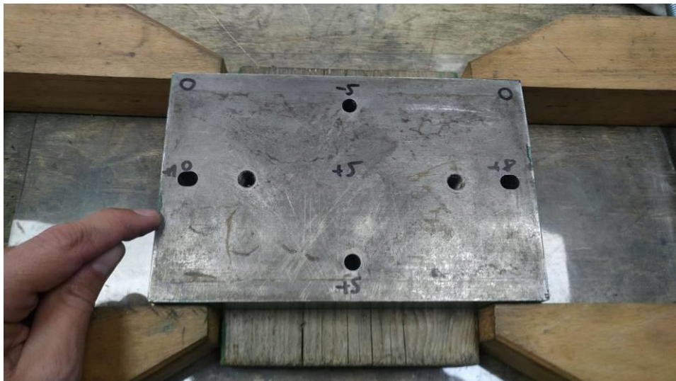
Abbildung 153: die Zwischenplatte ist so krumm, dass man von der Tuschiefarbe kaum was sieht! (Finger)
