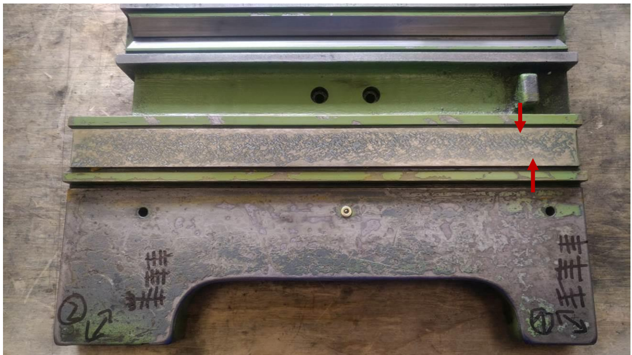
Abbildung 63: an den Rändern habe ich definitiv zu stark entgratet!
