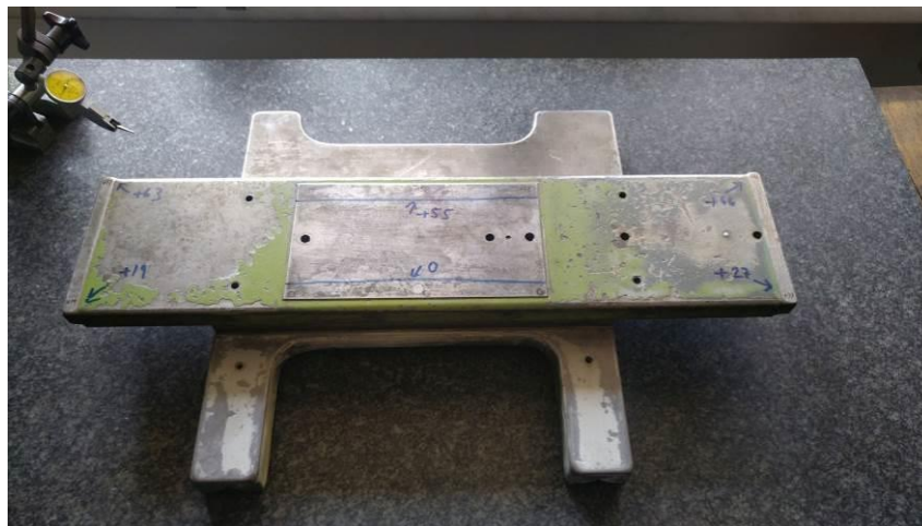
Abbildung 72: über einen halben Millimeter steigt der Schwingtisch in Z-Achse an!
