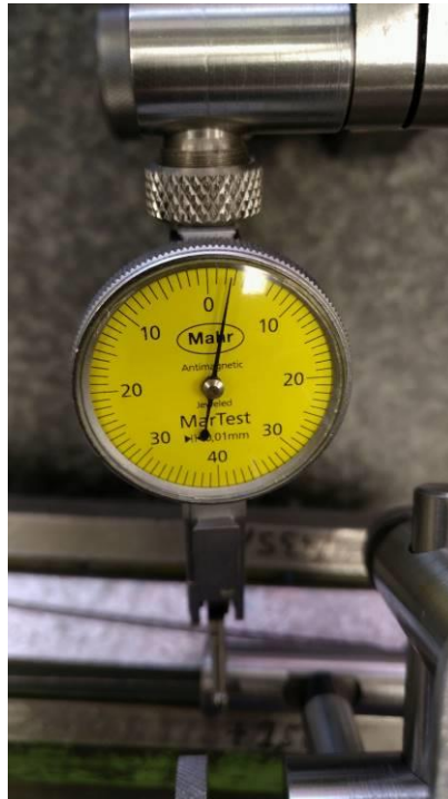
Abbildung 125: Beweis 2: etwa 25 \mu m auf der Messuhr- gemessen auf Richard's Sohle
