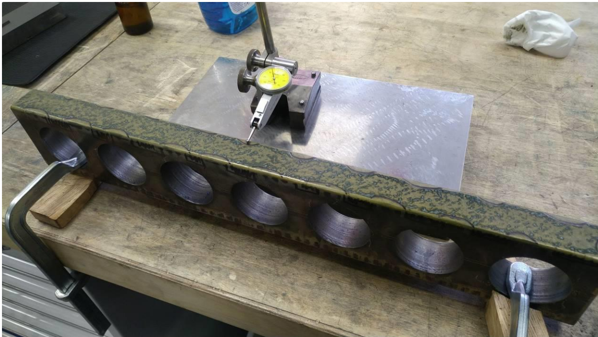
Abbildung 120: merkwürdig: in regelmäßigen Abständen gibt es Tiefpunkte entlang des Rands
