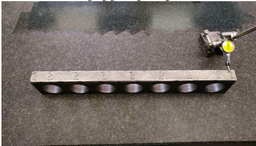
Abbildung 118: Geometrie mit der Messuhr ermitteln
