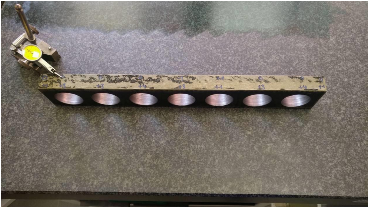
Abbildung 119: zusätzliches Einfärben hilft, die potenziellen Hoch- und Tiefpunkte mit der Messuhr zu finden und zu vermessen
