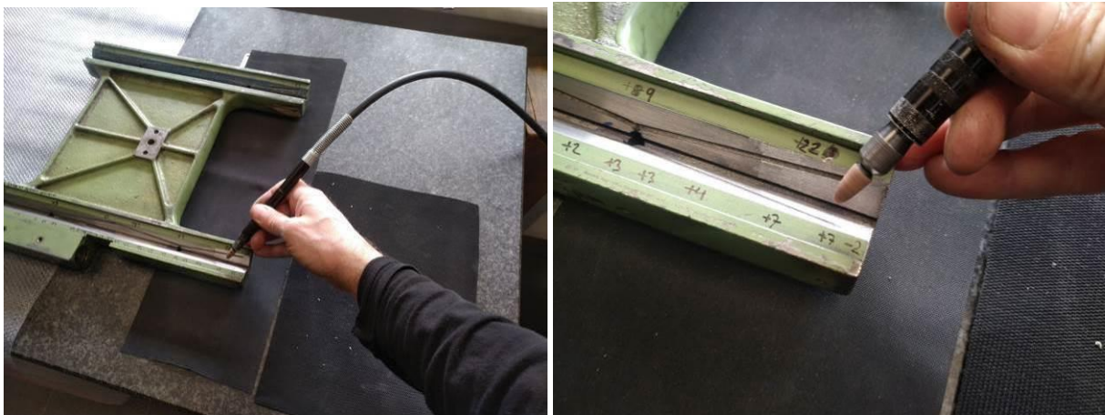
Abbildung 29: Versuch des "Dremel-Scrapens"- hier muss man echt aufpassen, nicht zu viel Material abzuehmen! Daher nehme ich kurz darauf lieber wieder den normalen Schaber zur Hand!
