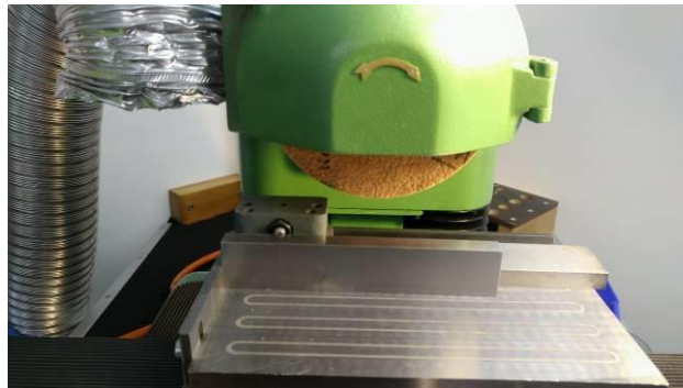
Abbildung 203: Setup für das Schleifen der Z-Spindelmutter
