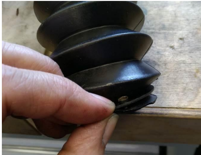
Abbildung 53: Riss im Faltenbalg
