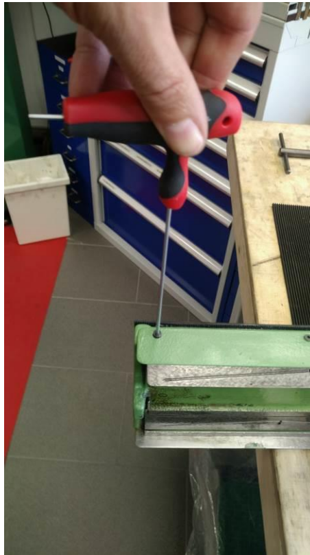
Abbildung 213: Eindrehen der neuen Schraubchen
