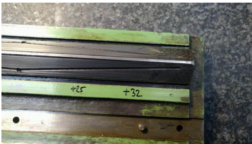
Abbildung 76: "+32" bedeutet: hier sind 320µm herunterzuschaben!!
