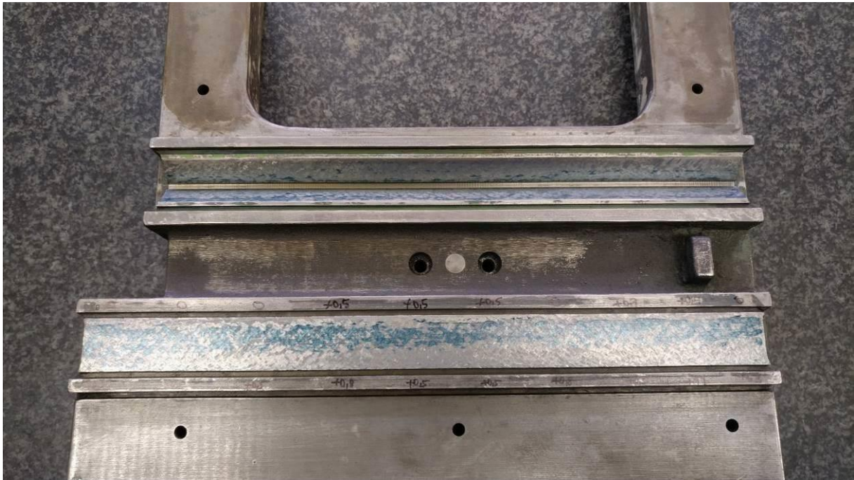
Abbildung 137: Vorsicht, Falle! Vorne blau, aber geschabt wird HINTEN!
