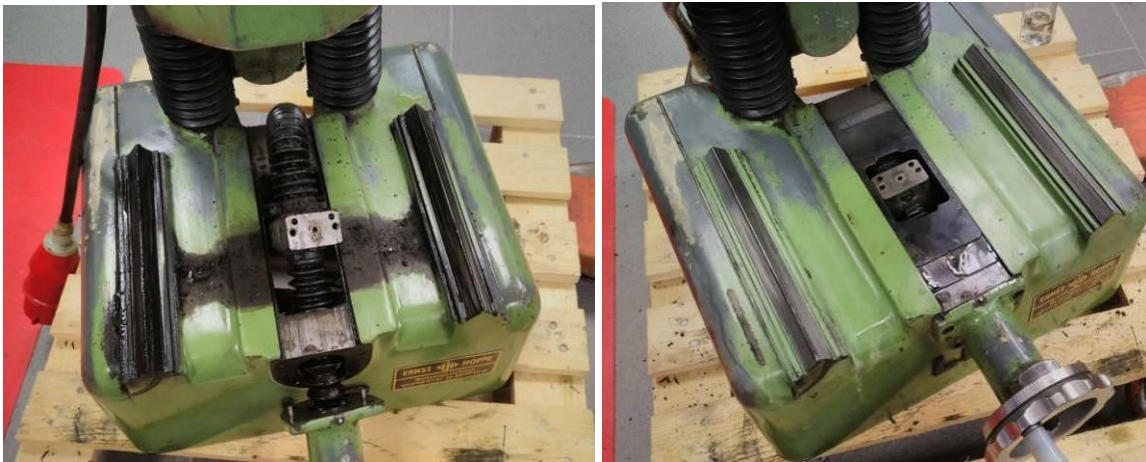
Abbildung 4: Führungsbahnen vor und nach dem ersten Putzen
