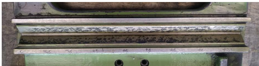
Abbildung 65: V-Nut nach dem ersten Schaben
