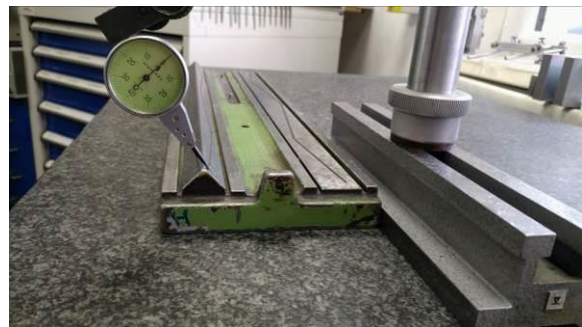
Abbildung 97: diese Seite der V-Führung ist ohne Tadel
