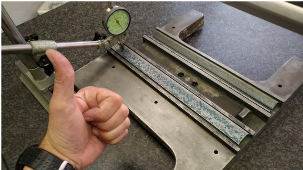
Abbildung 138: es wird! Mit Messuhr und Hirn habe ich die Flachführung erstmal parallel zur Grundfläche geschabt- DANN erst wurde an den Schwingtisch angepasst
