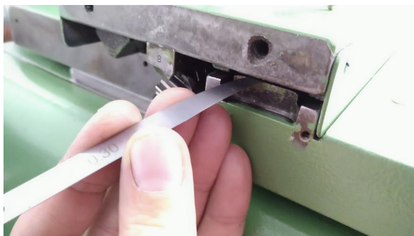
Abbildung 186: Kontrolle mit Fühlerblattlehre
