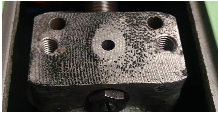
Abbildung 201: Tuschierbild der Z-Spindelmutter
