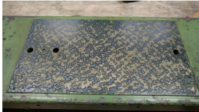
Abbildung 99: zuerst wird diese Fläche am Schwingtisch zur neuen Referenzfläche. Dort wird später die Magnetspannplatte draufsitzen
