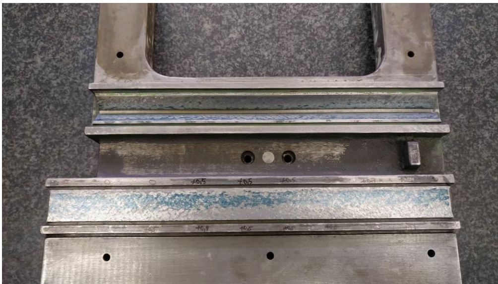
Abbildung 92: erstes Tuschieren der beiden Teile gegeneinander
