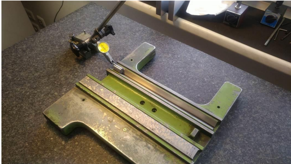
Abbildung 64: Messung der V-Nut
