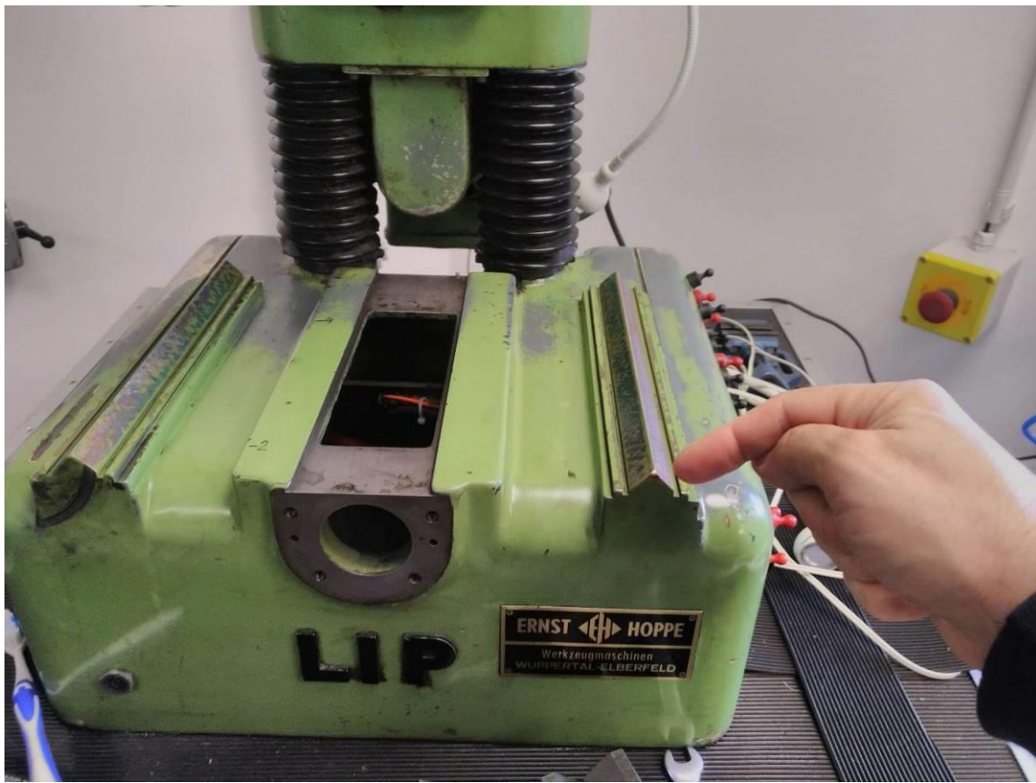
Abbildung 45: so langsam werden die Kontaktpunkte zwischen Grundgestell und Support besser!
