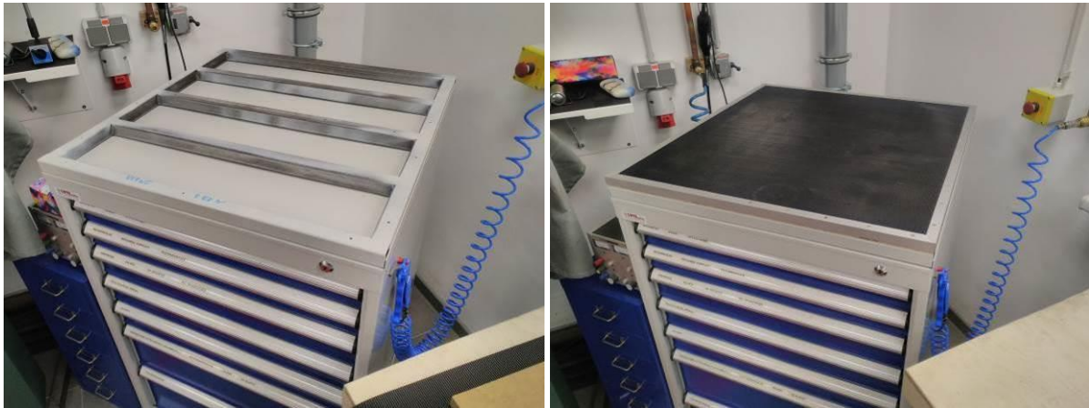
Abbildung 7: Zuerst muss jedoch mein Werkzeugschrank mit Metallverstrebungen und Multiplexplatte mit Rillengummiauflage verstärkt werden. Später werde ich ihn noch an der Wand anschrauben müssen, damit er während des Schleifens nicht hin- und herschaukelt (siehe nächstes Bild).
