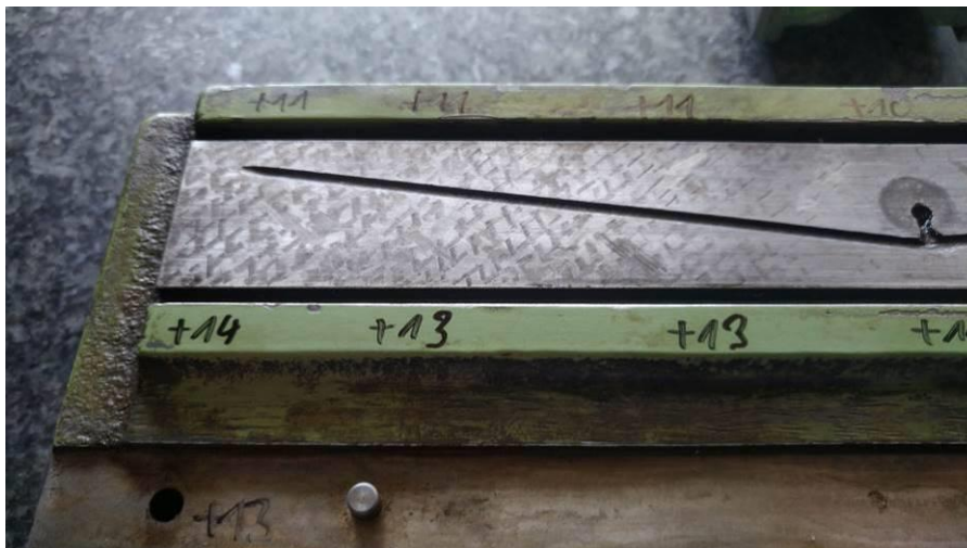
Abbildung 78: originale Schabemuster- nur noch an den beiden Enden zu sehen
