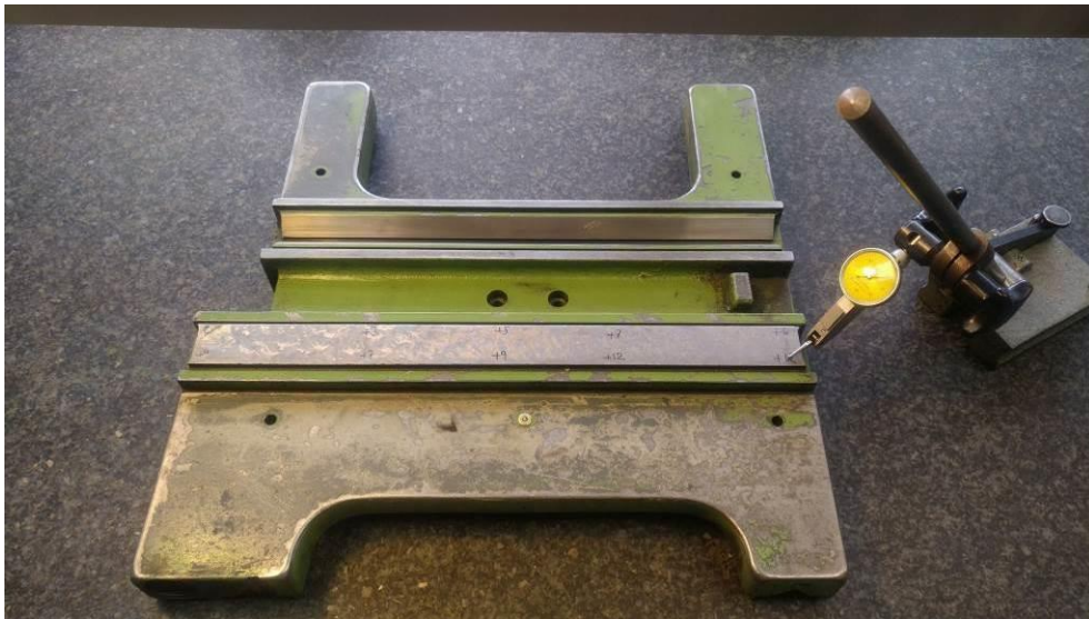
Abbildung 62: hier ist Stufenschaben erforderlich!
