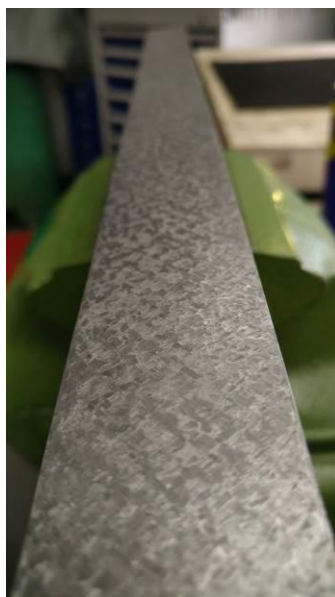
Abbildung 117: so wird das Tuschierlineal bald aussehen
