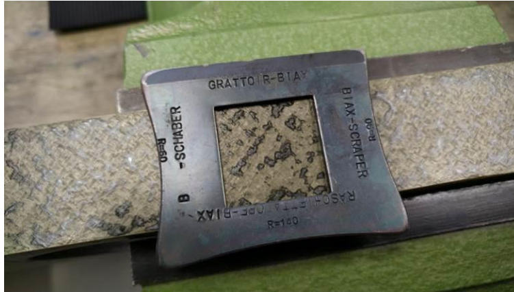
Abbildung 112: klar- besser geht immer noch. Und auch den spiegelnden Super-Highspot links neben der 1Zoll-Gauge habe ich natürlich als Kandidat für „Dive-Bomb“ erkannt. Aber so reicht es mir!
