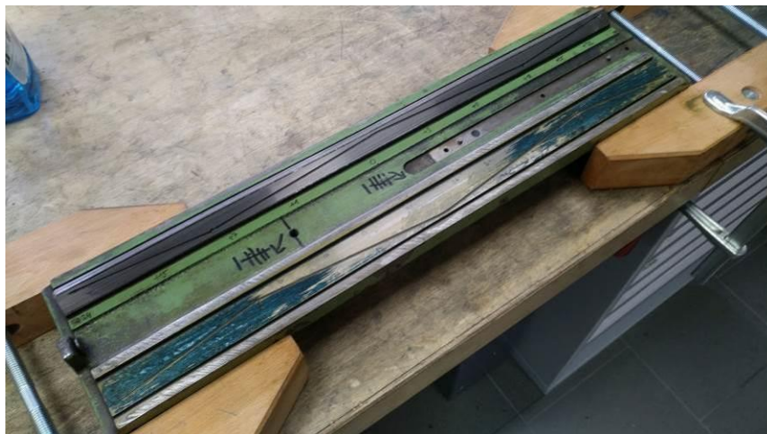
Abbildung 87: der Schwingtisch ist definitiv hohl!
