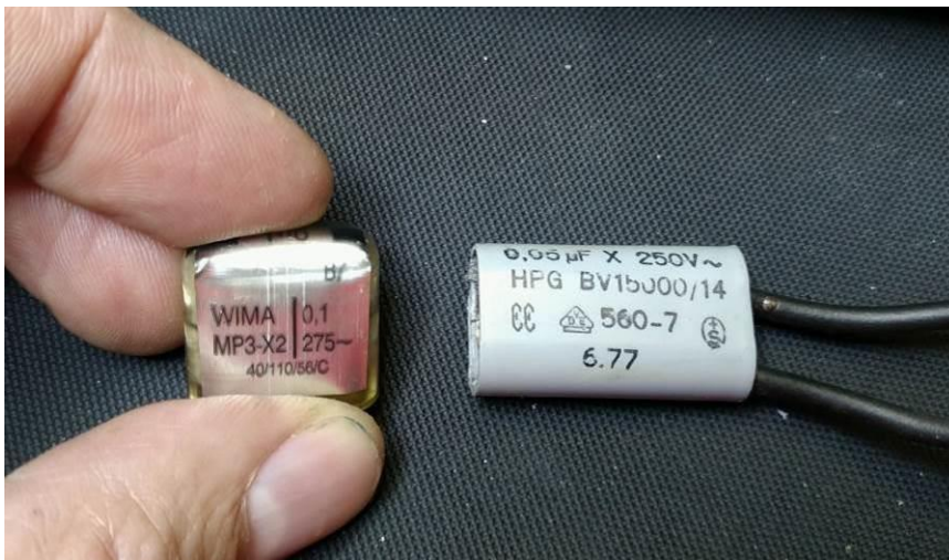
Abbildung 148: qualitativ hochwertiges Ersatzteil: WIMA 100nF X2-Typ
