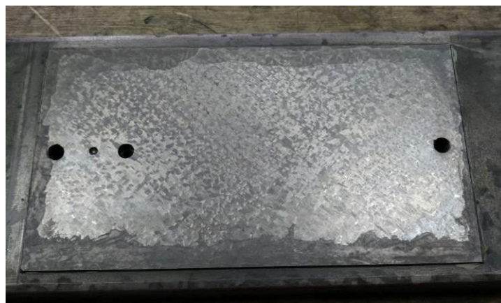
Abbildung 142: Verflixt! Hässliche ÄtZRänder vom Abbeizmittel!
