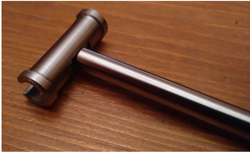
Abbildung 32: erste Versuche, mir ein Richard-King Alignment-Tool selber nachzubauen- das wird mir später bei der Lösung helfen!
