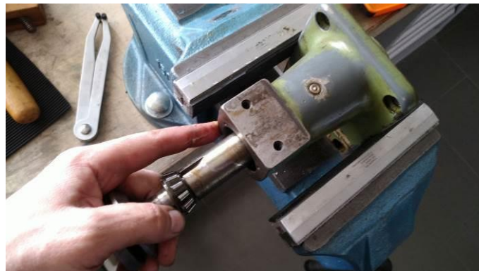
Abbildung 59: die Schleifspindel kommt heraus!
