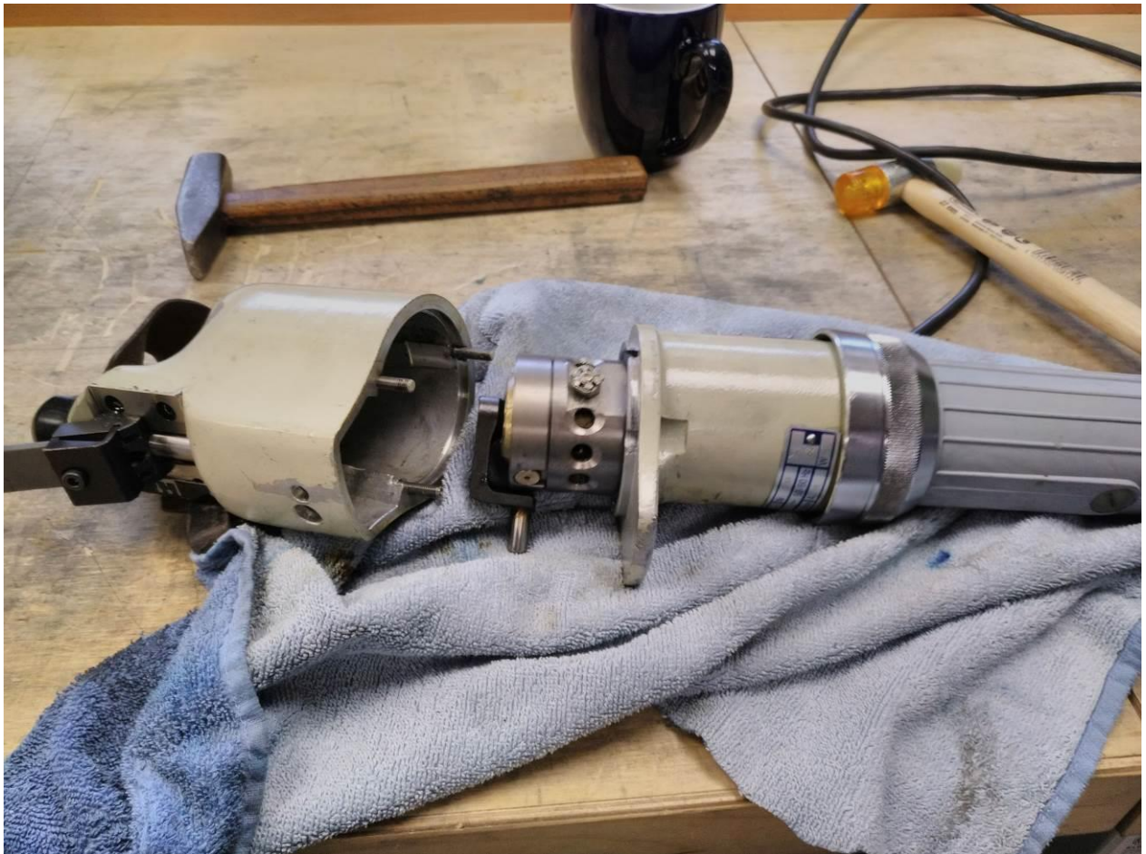
Abbildung 33: mein Biax 7EL - hier zu Wartungsarbeiten (Reinigung/Ölung) zerlegt
