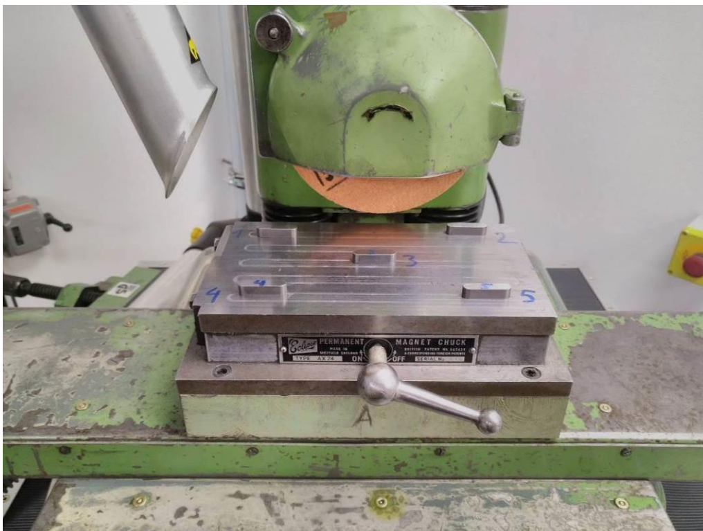
Abbildung 6: Gängiger Test für Flachsleifmaschinen: der 5-Punkte-Test. Doch wenn man schon die Magnetplatte entsprechend vorher „rund“ abgezogen hat, bemerkt man die abgenutzten Führungen bei dieser Prüfmethode nicht!
