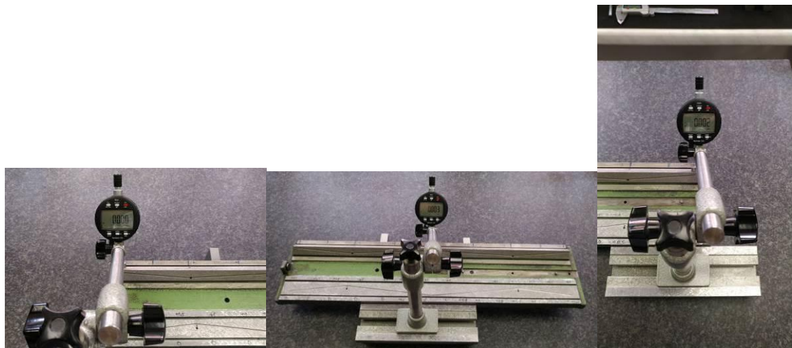
Abbildung 133: Abfahren der V-Führung mit der Messuhr; nur noch maximal 3µm Unebenheit!
