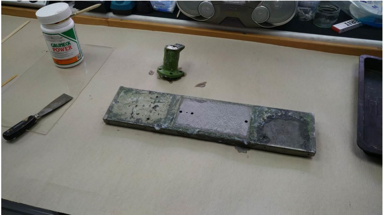
Abbildung 141: Abbeizen des alten Lacks. Dass das Mittel leider auch den Graugruss angreift, wusste ich da noch nicht...
