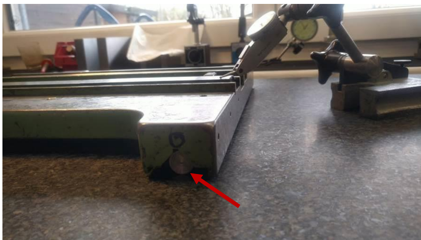
Abbildung 61: Lagerung des Supports auf Präzisionsrollen
