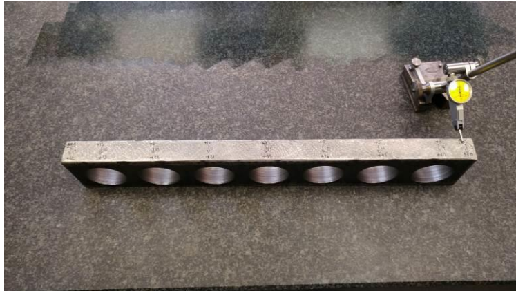
Abbildung 114: die Oberseite wird nun auch nochmal neu geschabt
