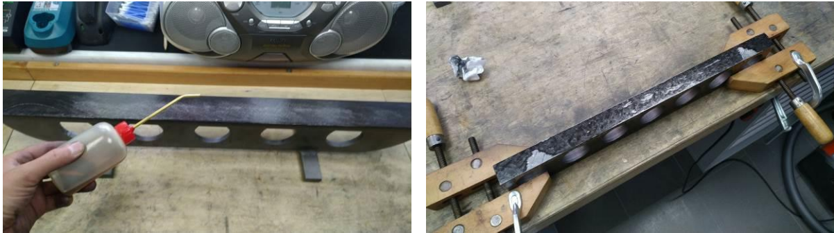
Abbildung 110: Trick: Tuschiefarbe mit Öl verdünnt - so sieht man die wirklich tiefen Löcher
