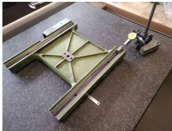
Abbildung 16: Messung der V-Föhrungen an der Support-Unterseite (mit Präzisionsröhlchen und Messuhr)
