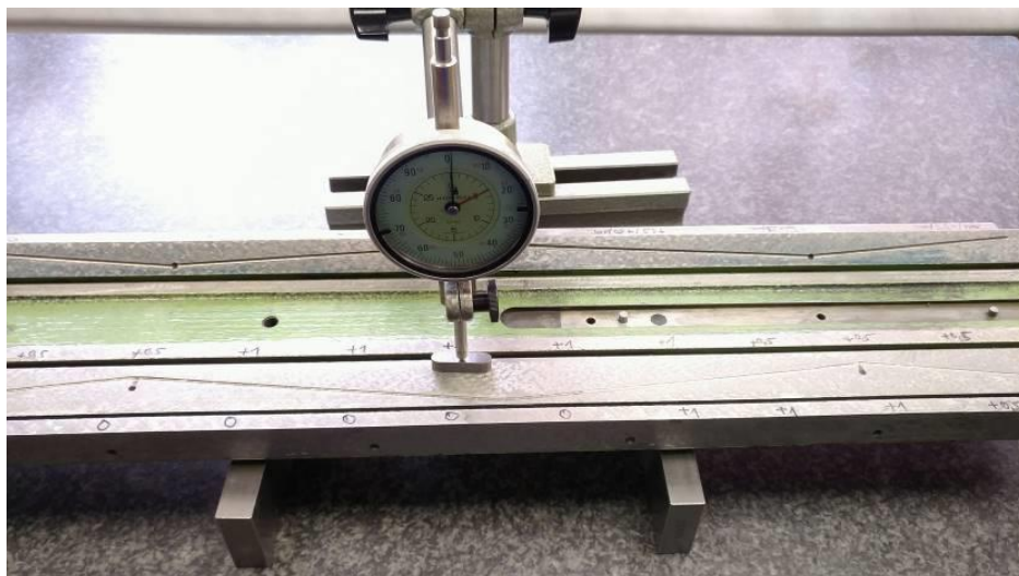
Abbildung 122: eine geschliffene Passfeder dient als Messunterlage
