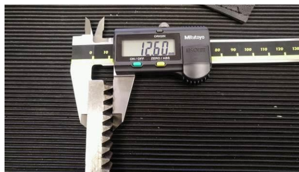
Abbildung 194: die ersten 400 \mu m sind runter!
