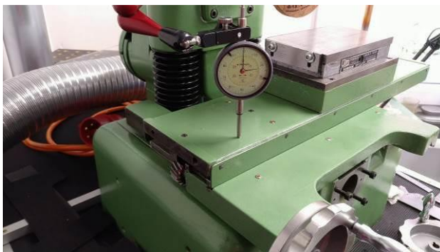
Abbildung 185: links: Tisch sitzt auf dem Zahnrad auf; rechts: Tisch liegt auf der Führung
