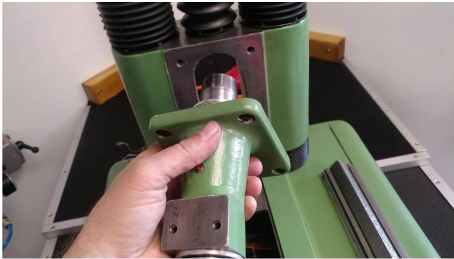
Abbildung 47: Mit nur vier Schrauben ist die Spindel zu lösen. (Hier gezeigt an der schon neu lackierten Maschine)
