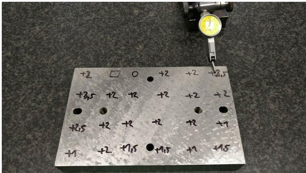
Abbildung 158: Ermittlung der Geometrie. Alle Werte in [10 \mu m]
