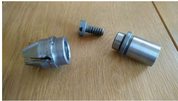
Abbildung 84: geschrottetes RAPID Bohrfutter
