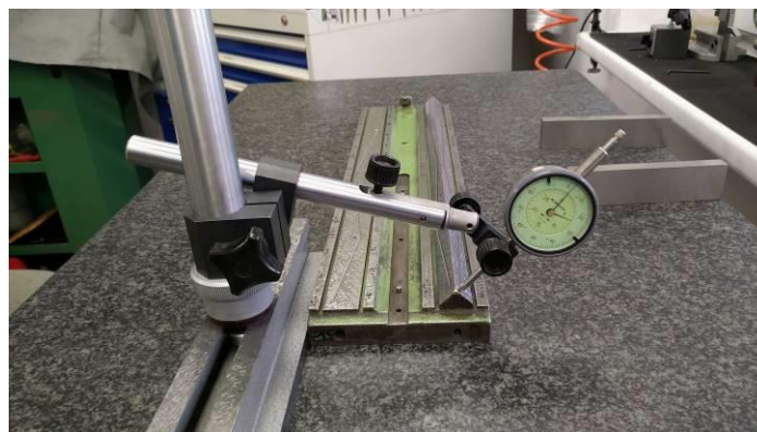
Abbildung 126: Beweis 3: Messung mit Messuhr entlang Referenzfläche
