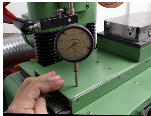
Abbildung 185: links: Tisch sitzt auf dem Zahnrad auf; rechts: Tisch liegt auf der Führung
