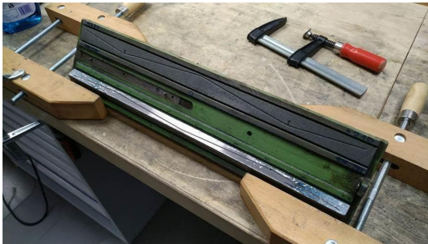
Abbildung 89: Auch die V-Führung ist anfangs hohl...
