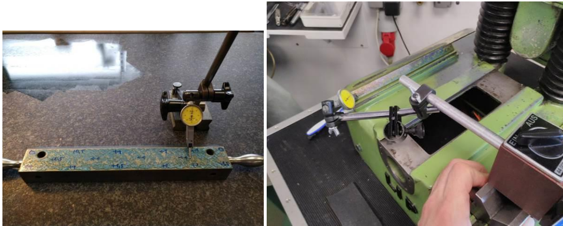
Abbildung 13: immer erstmal messen- DANN erst schaben! Manchmal braucht man für die Messaufbauten aber etwas Phantasie! (rechts)
