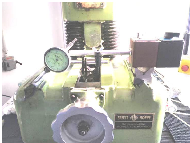
Abbildung 35: Messaufbau zur Messung der Parallelität der V-Führungen
