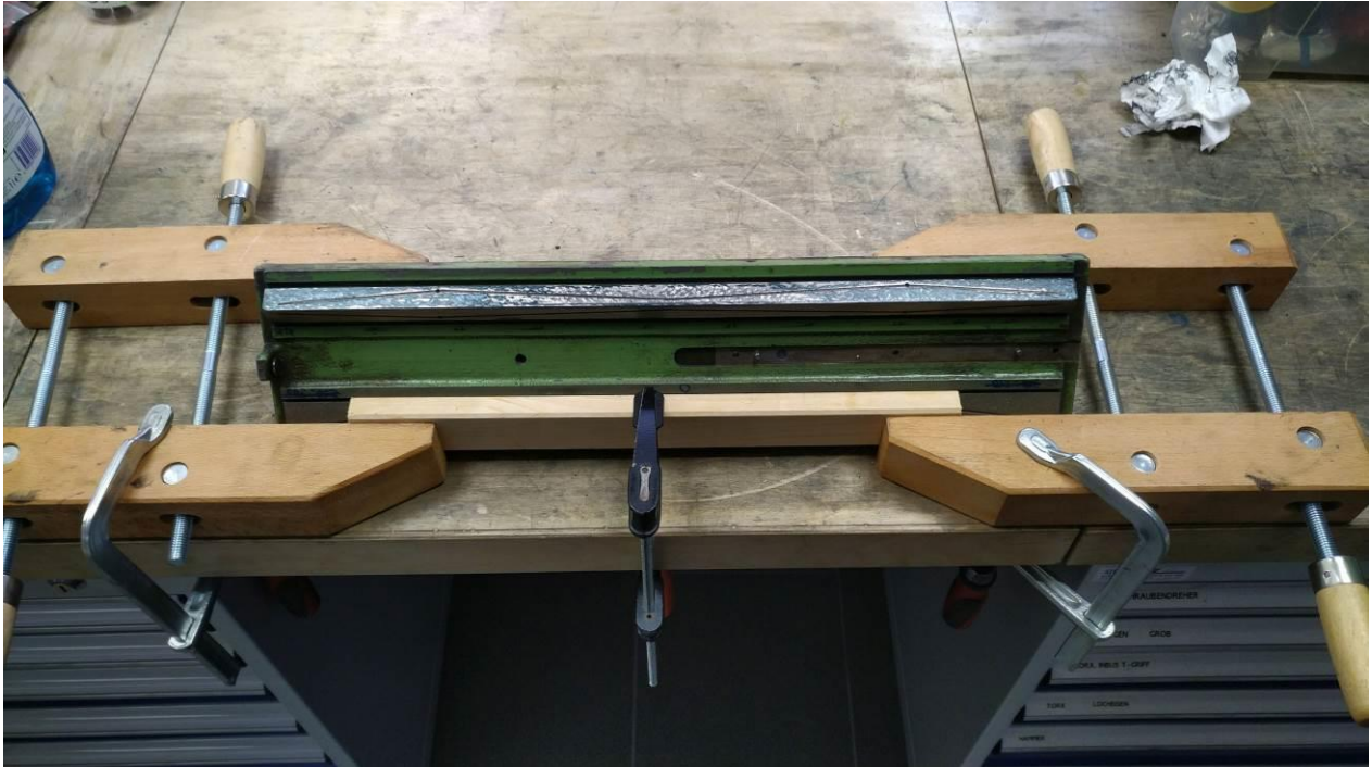
Abbildung 27: Aufspannung mit den Parallelklemmen- eine feine Sache! (hier am Beispiel des Schwingtisches)
