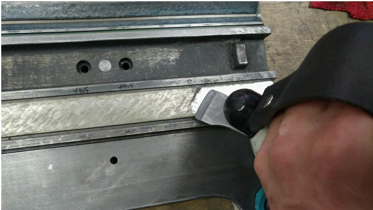
Abbildung 139: Schruppen mit dem Biax und kurzer Klinge (Radius 90mm, Klingenbreite 30mm) an der Flachführung
