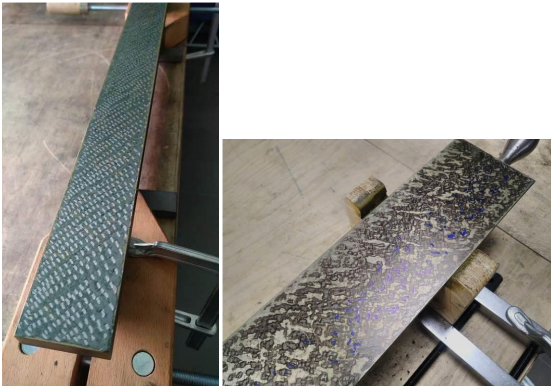
Abbildung 11: einige meiner Tuschieerlineale werden nochmal übergeschabt
