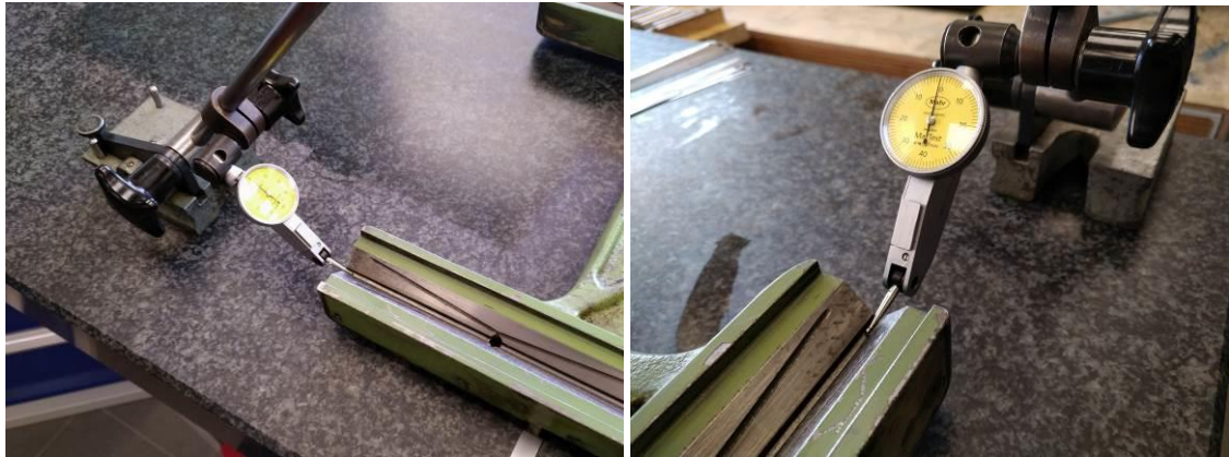
Abbildung 17: Ausrichtung anhand der Nut (Freistich)
