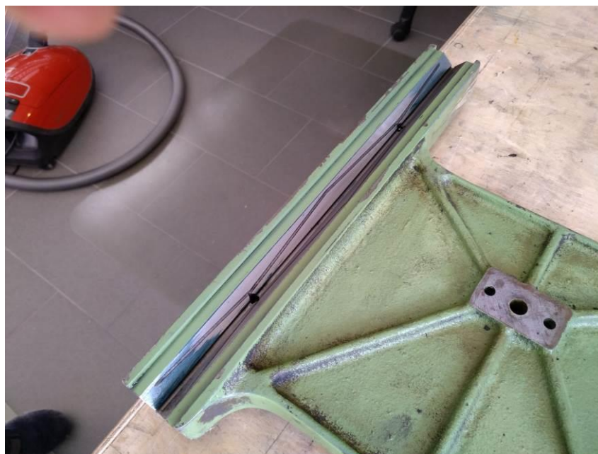
Abbildung 14: der Support von unten: das Blau breitet sich langsam aus
