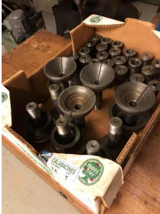
Abbildung 29: wie ich später lernen werde, sind das –sehr seltene- „Glocken-Spannfutter“ für die Leinen!
