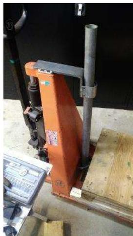
Abbildung 20: ein einsteckbares Rohr bietet einen guten Ankerpunkt für eine Winde
