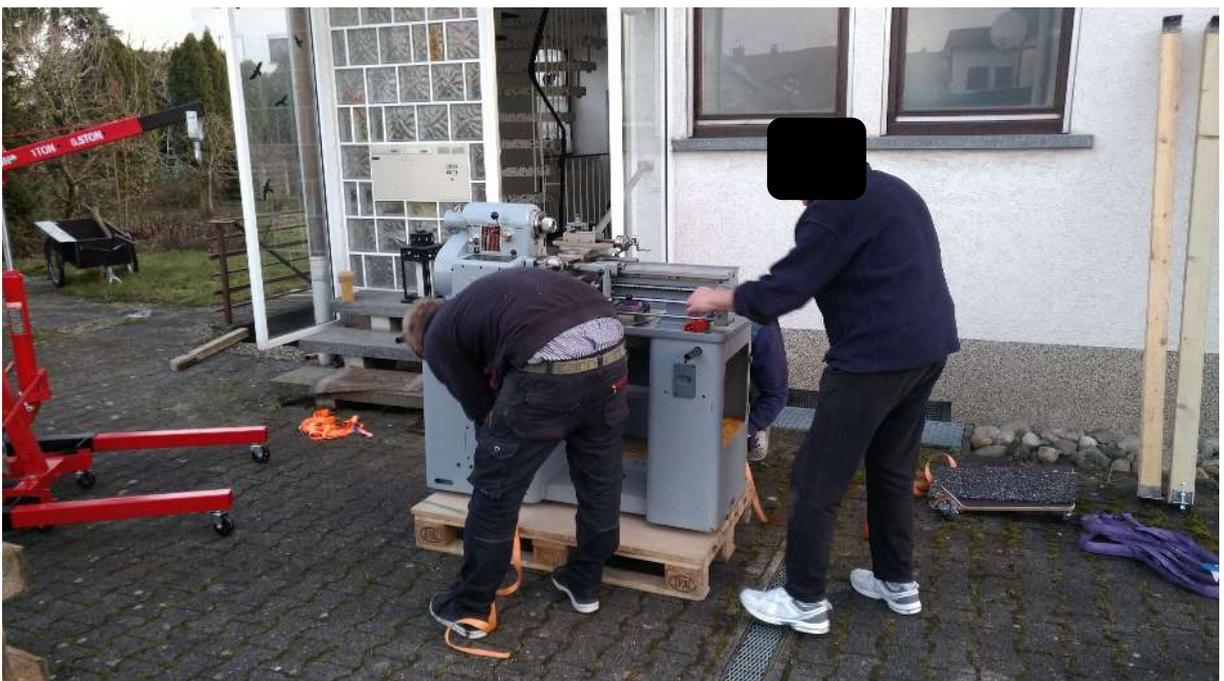
Abbildung 44: mit einer untergelegten Spanplatte steht die Maschine deutlich sicherer auf der Palette
