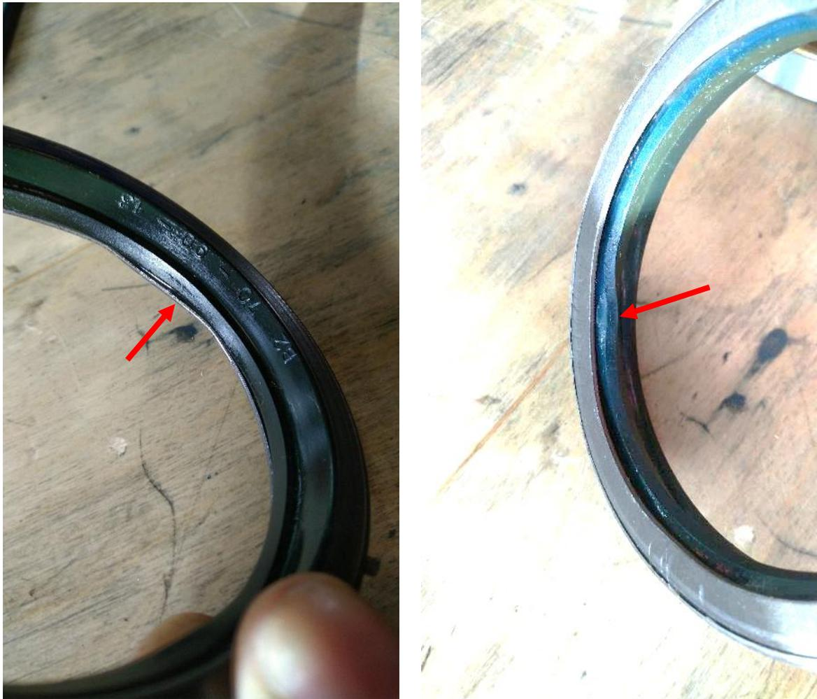
**Abbildung 57: beschädigter Wellendichtring!**
