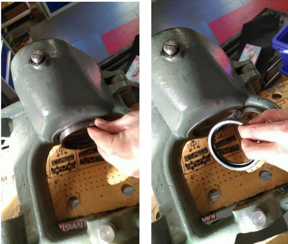
Abbildung 56: Herausschlagen des alten Wellendichtrings
