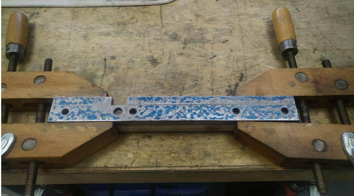
**Abbildung 118: So, die Gleitleiste ist erstmal ziemlich gerade. Jetzt kommt das Einpassen!**
