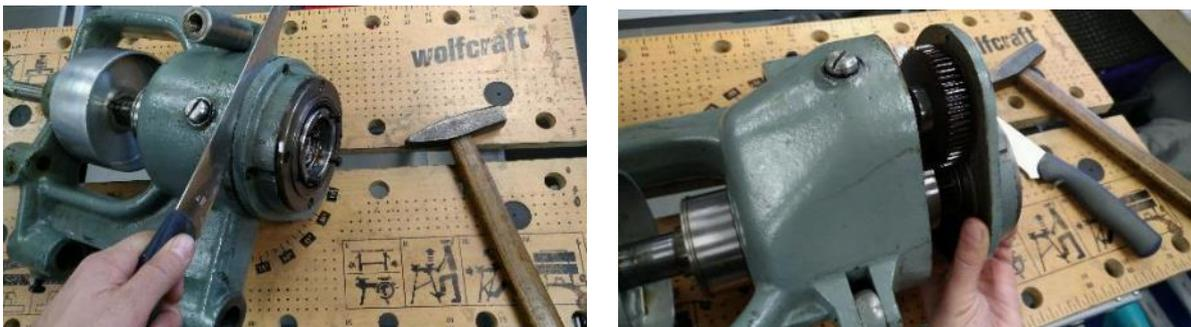
**Abbildung 49: mit einem Messer öffne ich die Dichtflächen**
