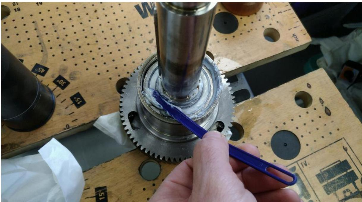
**Abbildung 66: Einbringen von Klüber Isoflex NBU 15 Spindelfett in die alten, aber gereinigten Lager**
