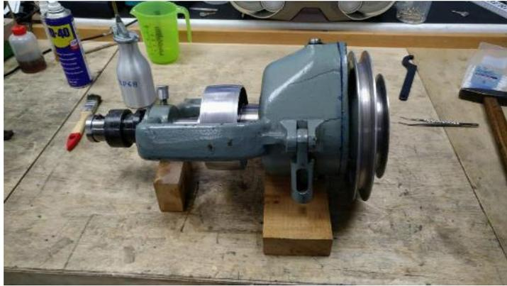
Abbildung 75: das aufgearbeitete und reparierte Getriebe e12- nun vollkommen dicht! 😊
