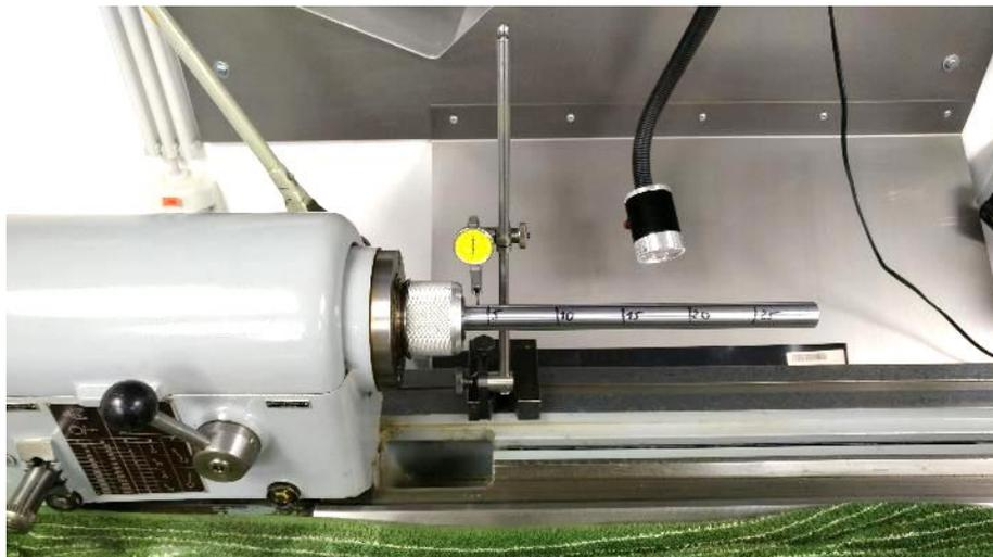
Abbildung 96: Prüfung der Spindelausrichtung in Z- und X-Achse
