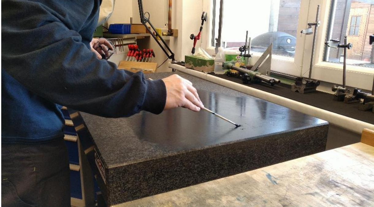
Abbildung 161: zuerst die Granitplatte vorbereiten: Tuschiefarbe aufpinseln
