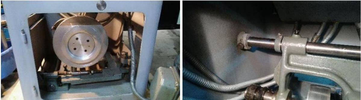
Abbildung 28: Getriebe hängt nun frei auf seiner Welle
