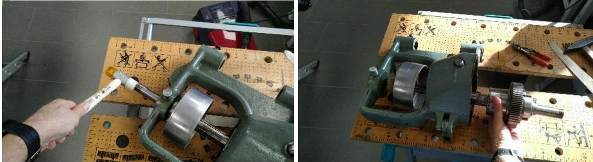
Abbildung 53: vorsichtiges Herausklopfen der Achse
