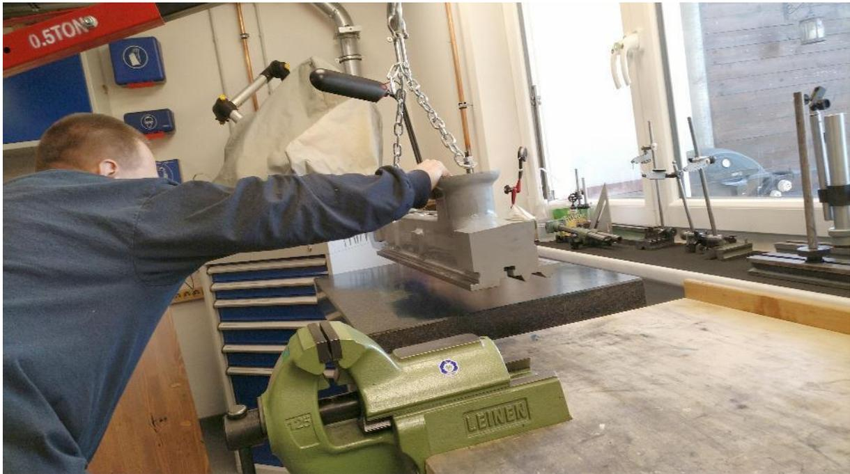
**Abbildung 175: dann die Platte nochmal kurz abwischen (Achtung: schwebende Last über den Händen!) und dann vorsichtig im Zeitlupentempo ablassen**
