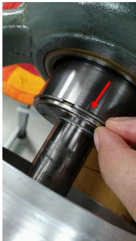
**Abbildung 59: ...und zwar mit genau diesem Klemmring, der die empfindliche Dichtlippe des WeDis beim gewaltsamen Durchschieben der Welle durch die Dichtfläche sofort zerstört!**
