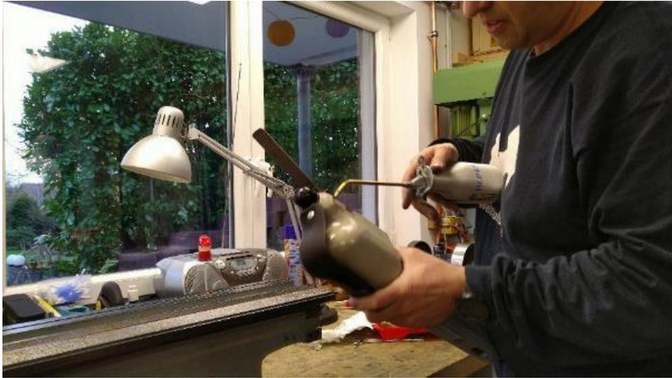
**Abbildung 156: der Biax wird scharf gemacht (Foto: Max Michalzik)**
