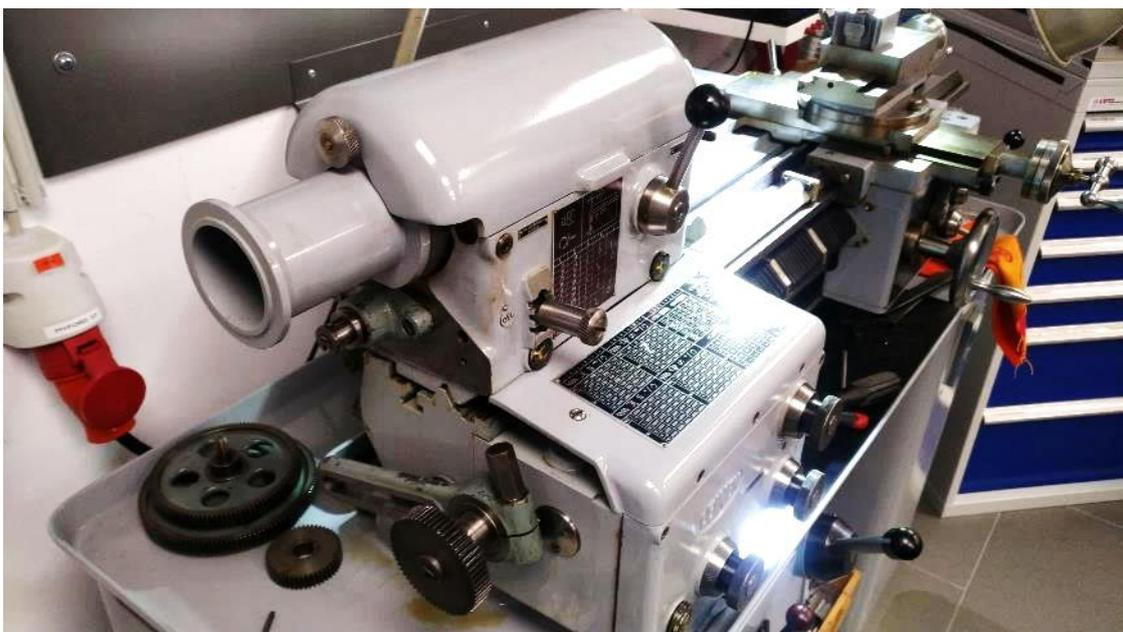
**Abbildung 78: linker Getriebekasten ist weg**
