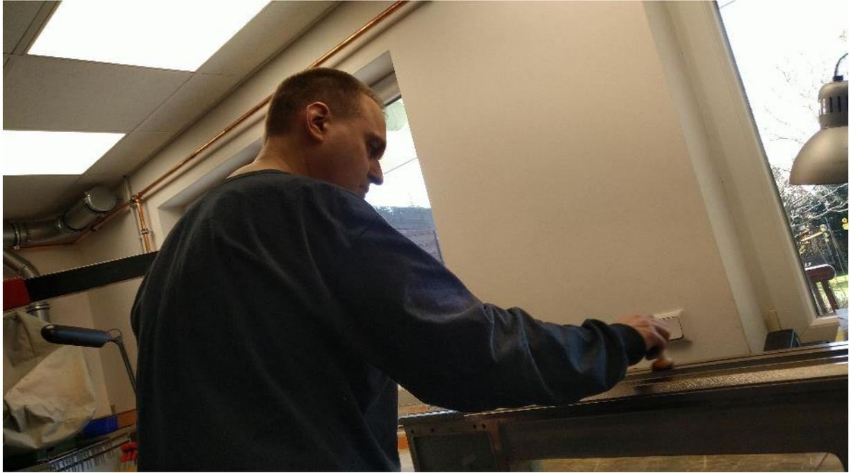
**Abbildung 165: jetzt den Hi-lighter auf die zu tuschierende Fläche auftragen**
