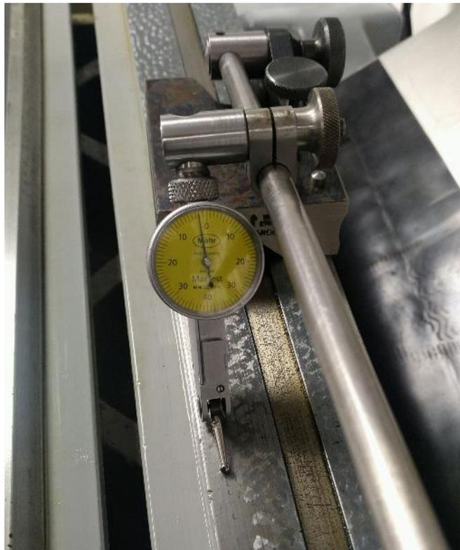
**Abbildung 91: immernoch gute  $20\mu\text{m}$  zu holen**
