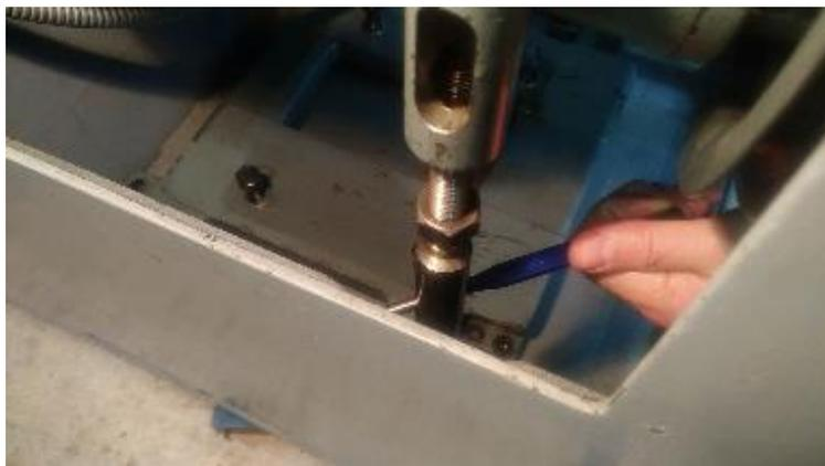
**Abbildung 26: Spannelement lösen**
