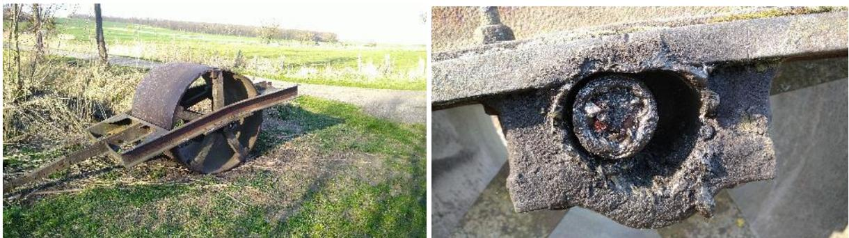
**Abbildung 155: Beispiel für eine gelungene Lagerpassung an einer Feldwalze**
