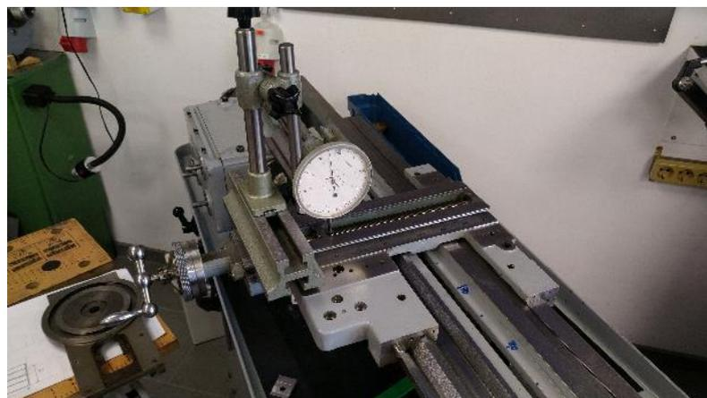
Abbildung 141: ...aber auch hier fällt die Messuhr um  $150\mu\text{m}$ !
