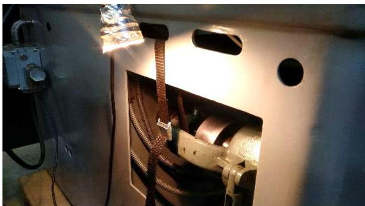
**Abbildung 27: Getriebe mit Spanngurt sichern, damit es beim Herunterschwingen nicht herunterkracht**
