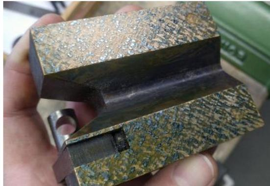
Abbildung 1: Schabemuster auf der Unterseite eines Messuhrhalters
