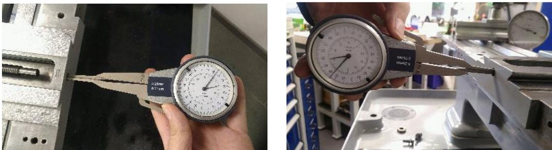
Abbildung 145: Messung mit dem Schnelltaster
