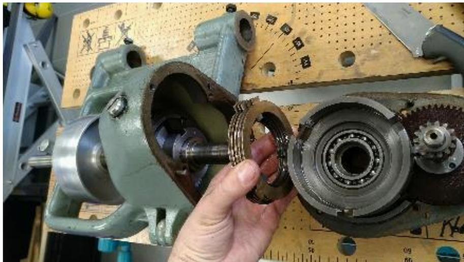
Abbildung 51: das hier ist ein Lamellenpaket der Kupplung
