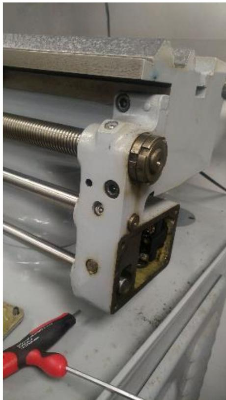
**Abbildung 106: rechtes Spindellager und der Schaltkasten**
