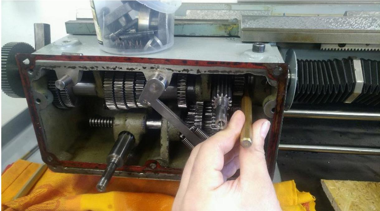
**Abbildung 102: da hinten sind die beiden Zylinderstifte für die Leitspindel versteckt!**
