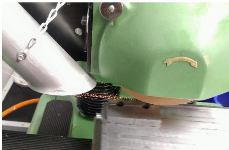
**Abbildung 137: Funkenflug beim Schleifen der Gleitstücke**
