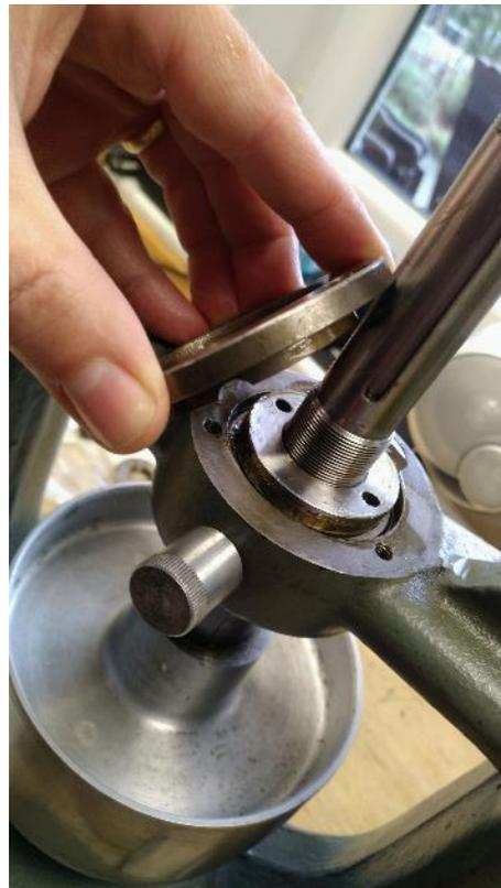
**Abbildung 41: Schrauben lösen und Schild abnehmen...**
