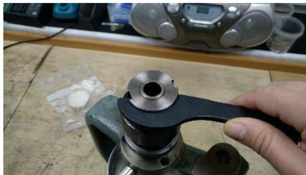
Abbildung 32: erste Mutter lösen
