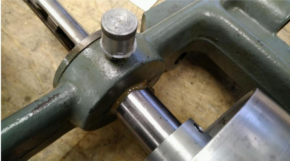
**Abbildung 73: ...und auch hier NBU15. Der Druck des neuen presst noch das alte Fett aus der Lager-
