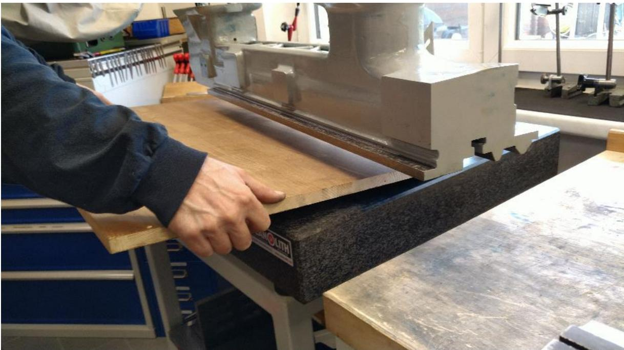
**Abbildung 174: erst wenn das Bett direkt über der Platte ist und nicht mehr schwankt oder schaukelt, nehme ich die Schutzplatte herunter**
