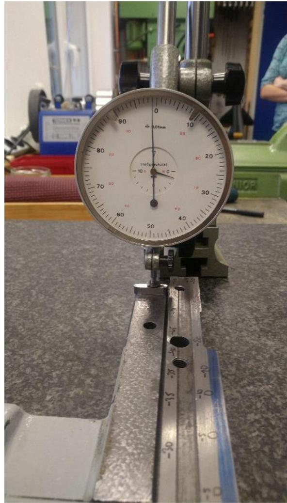
Abbildung 125: Messen der Höhenlage links und rechts am Sattel
