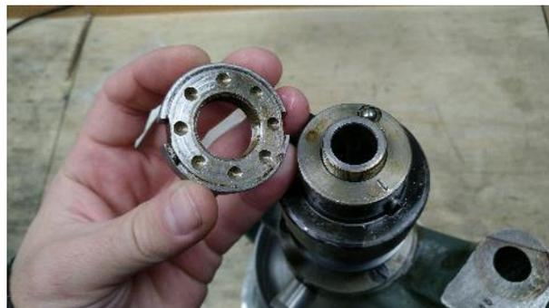
Abbildung 33: siehe da- darunter ist eine Kugel-Rastmechanik!
