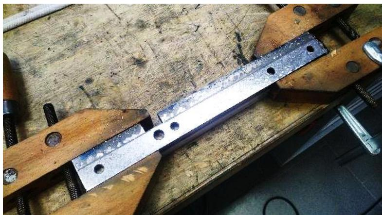
**Abbildung 117: die Gleitleiste wird erstmal gerade gemacht**
