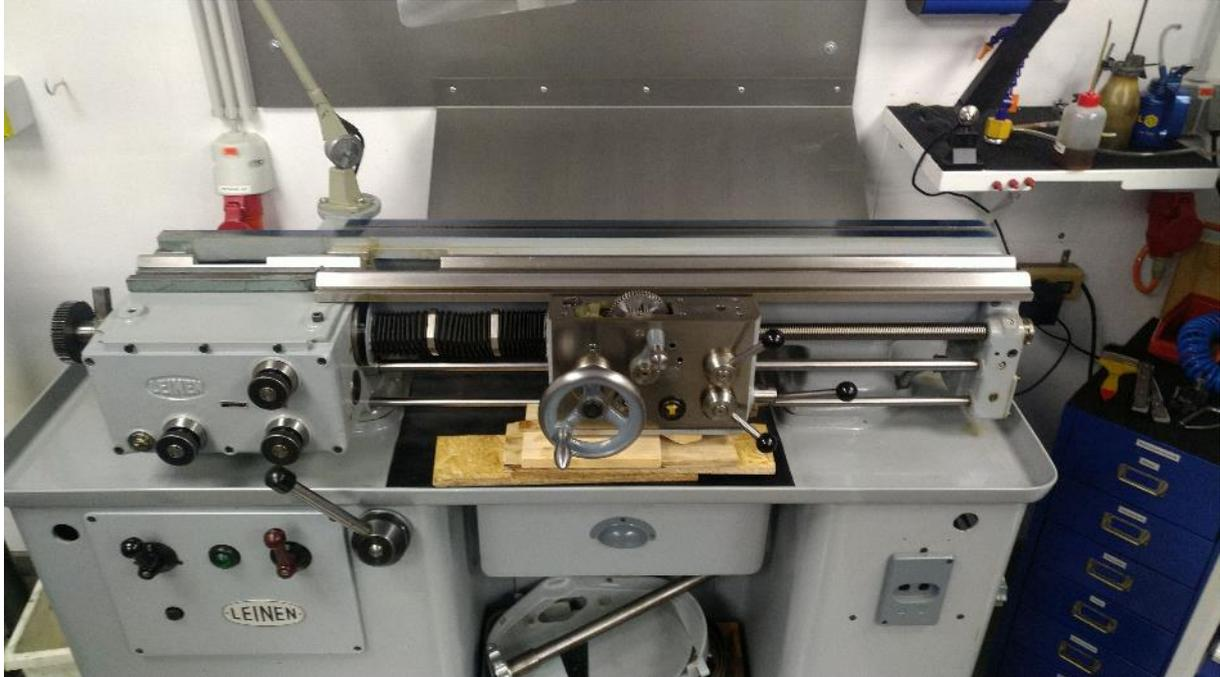
**Abbildung 84: der Oberschlitten ist abgebaut**
