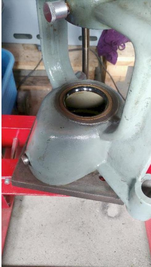
**Abbildung 64: aber es klappt! Der WeDi ist bündig und sauber eingepresst**
