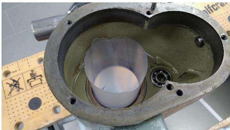
**Abbildung 65: ein Schnellhefter hilft als Gleithilfe und schützt den WeDi**
