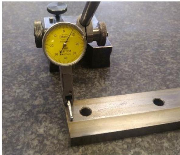
**Abbildung 116: Abfahren mit der Messuhr**
