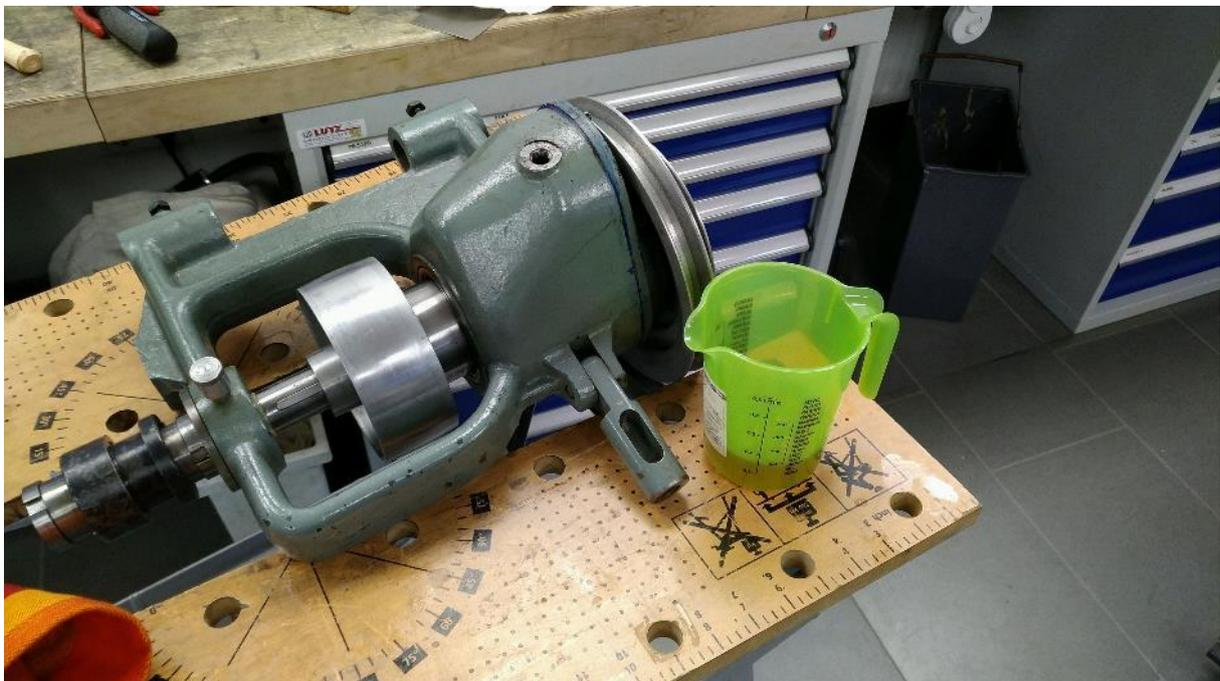
**Abbildung 74: hinein mit dem neuen Getriebeöl (HLP46, 100mL)**
