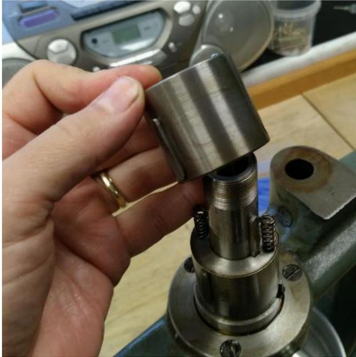
**Abbildung 38: jetzt kann diese Hülse runter...**
