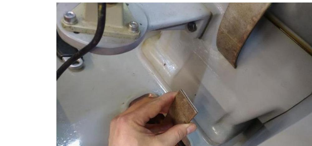
**Abbildung 23: dieser Schnitt wird verhängnisvoll- denn damit startet nicht nur die Getriebereparatur, sondern auch eine komplette Bettschlitten-Einschabeorgie!**
