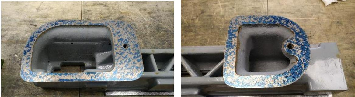
Abbildung 152: Tuschierbild der beiden Füße nach 2 Durchgängen
