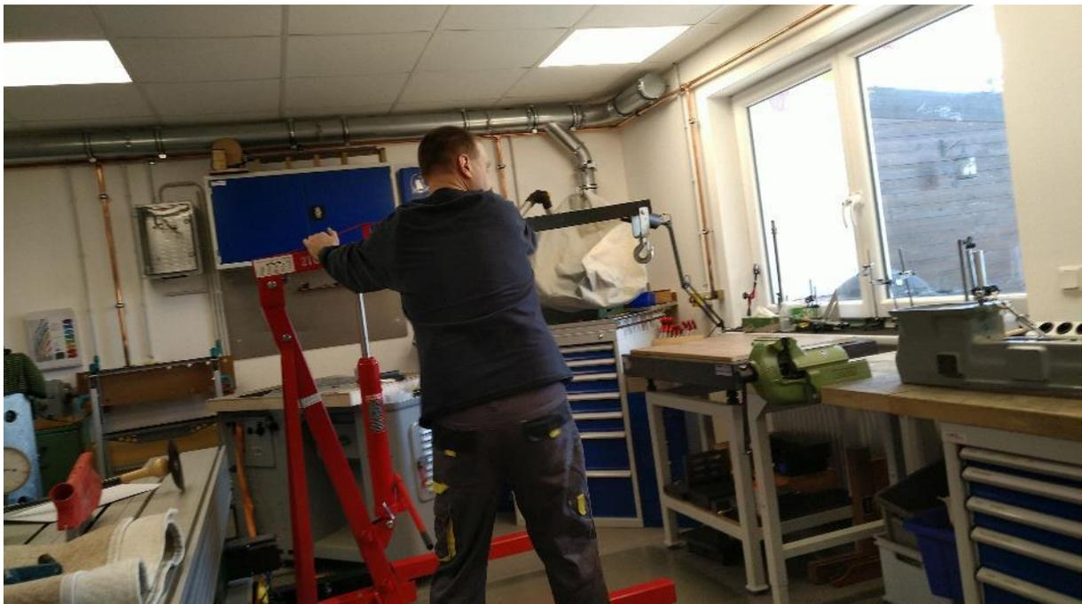
Abbildung 182: sobald das Bett wieder auf der Werkbank aufgesetzt ist, den Kran in seine Parkposition zurückschieben
