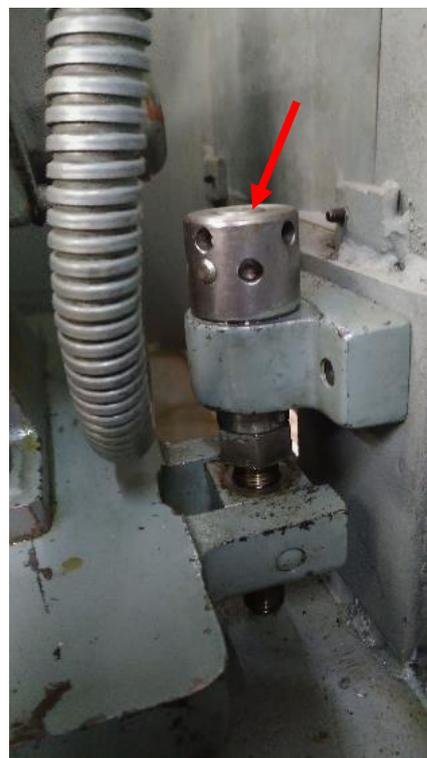
**Abbildung 20: ... kann man durch Drehen dieses Bolzens hoch- und herunterkurbeln**
