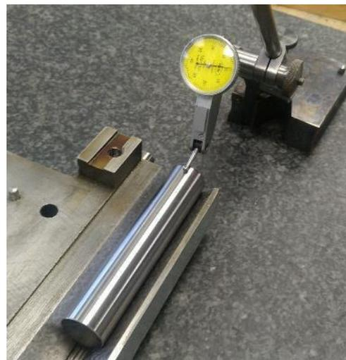
Abbildung 126: dasselbe Ergebnis auch bei der Prismenführung
