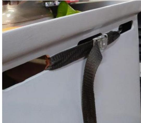
**Abbildung 30: die Welle wird herausgeklopft- vorher natürlich das Getriebe mittels Spanngurt wieder sichern!**
