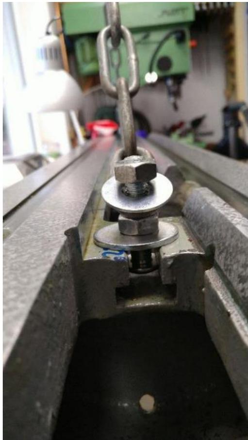
**Abbildung 151: Bolzen in der T-Nut als Aufhängepunkt**
