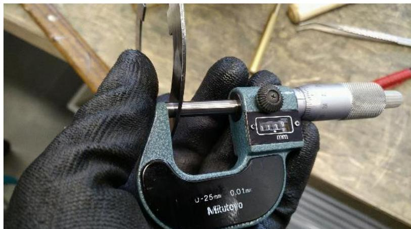
Abbildung 52: links: so sieht es im Innern aus; rechts: Dicke einer Lamelle der Kupplung
