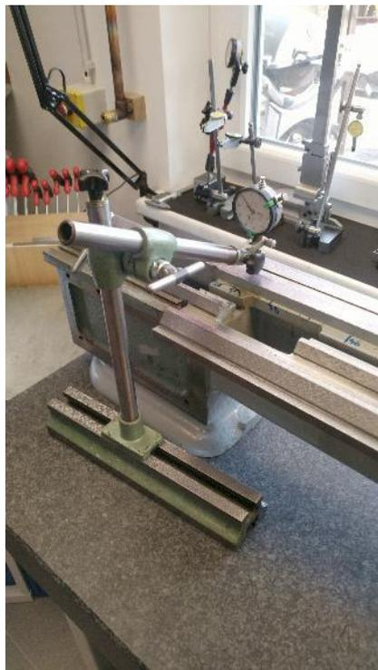
Abbildung 189: Kontrolle der Parallelität
