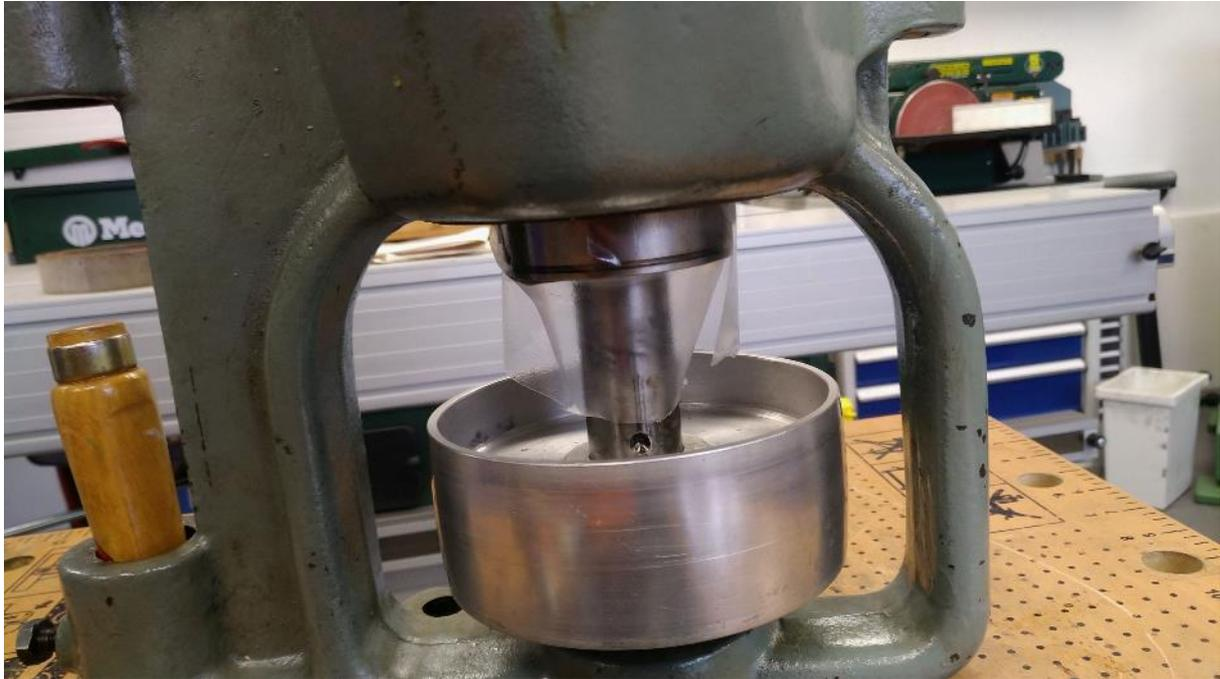
**Abbildung 58: Vorgucker: wer beim Zusammenbau hier nicht aufpasst, zerstört beim Durchstecken der Achse den neuen Wellendichtring gleich wieder!**
