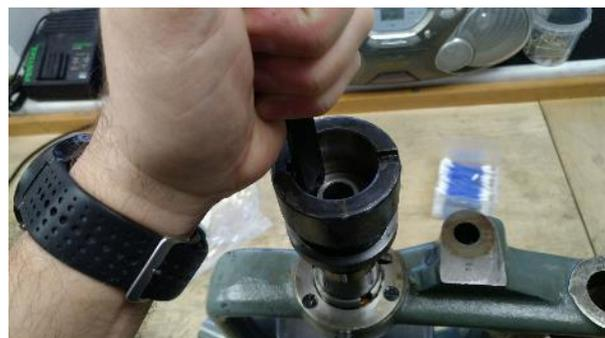
Abbildung 34: Schiebehülse abnehmen- dazu den Nippel mit einem Werkzeug runterdrücken
