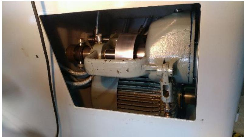
Abbildung 76: das Getriebe e12 sitzt - und schnurrt wie ein Kätzchen!
