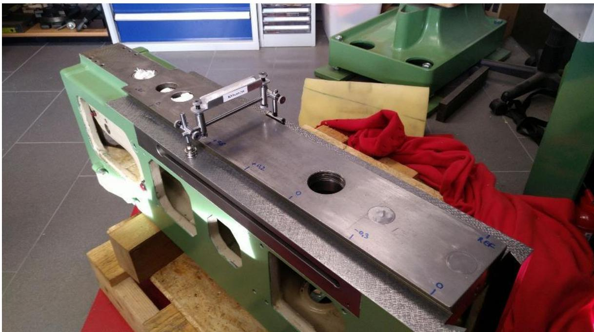
Abbildung 93: mein selbstgebauter "Mini-Richard" beim Einsatz an der Fräse
