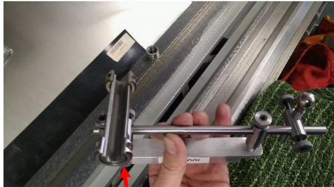
Abbildung 97: neue ● Abtasterröhre von unten gesehen
