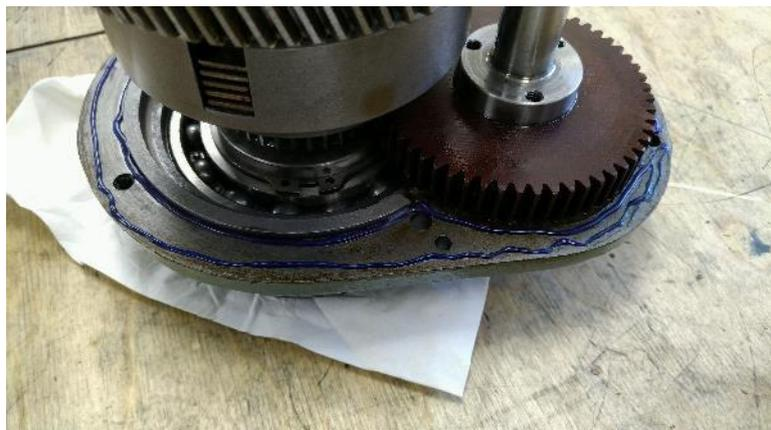
**Abbildung 70:** mit normalem Hylomar aus dem Autobau dichte ich das Getriebe ab
