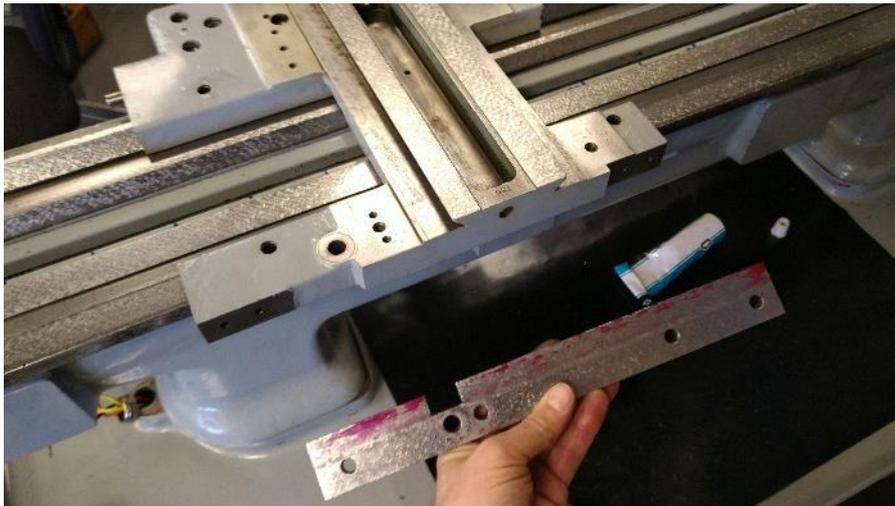
Abbildung 129: die hintere Gleitleiste wird langsam "frei"!
