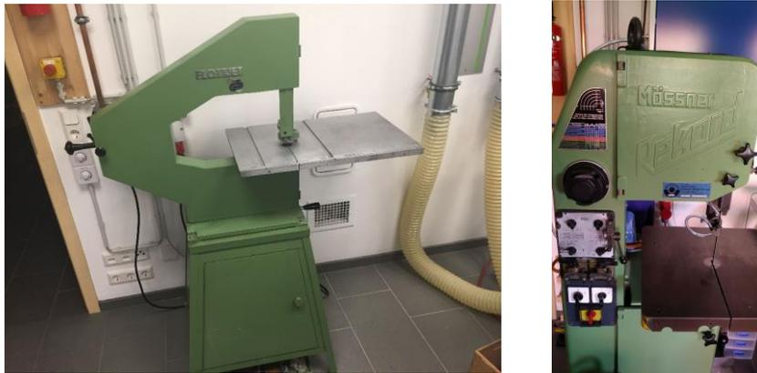
**Abbildung 1: beides gute Sägen: Flottjet (links) und Mössner Rekord SM320 (rechts)- aber das fehlende Getriebe bei der Flottjet schränkt deren Verwendungsmöglichkeit für Stahl leider deutlich ein!**
