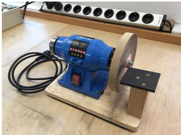
**Abbildung 2: umgebauter "Ghetto-Schleifer" mit Diamantscheibe**
