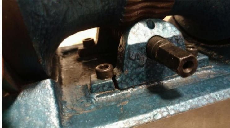
**Abbildung 10: gebrochene Halterung am bestellten Winkeltisch**
