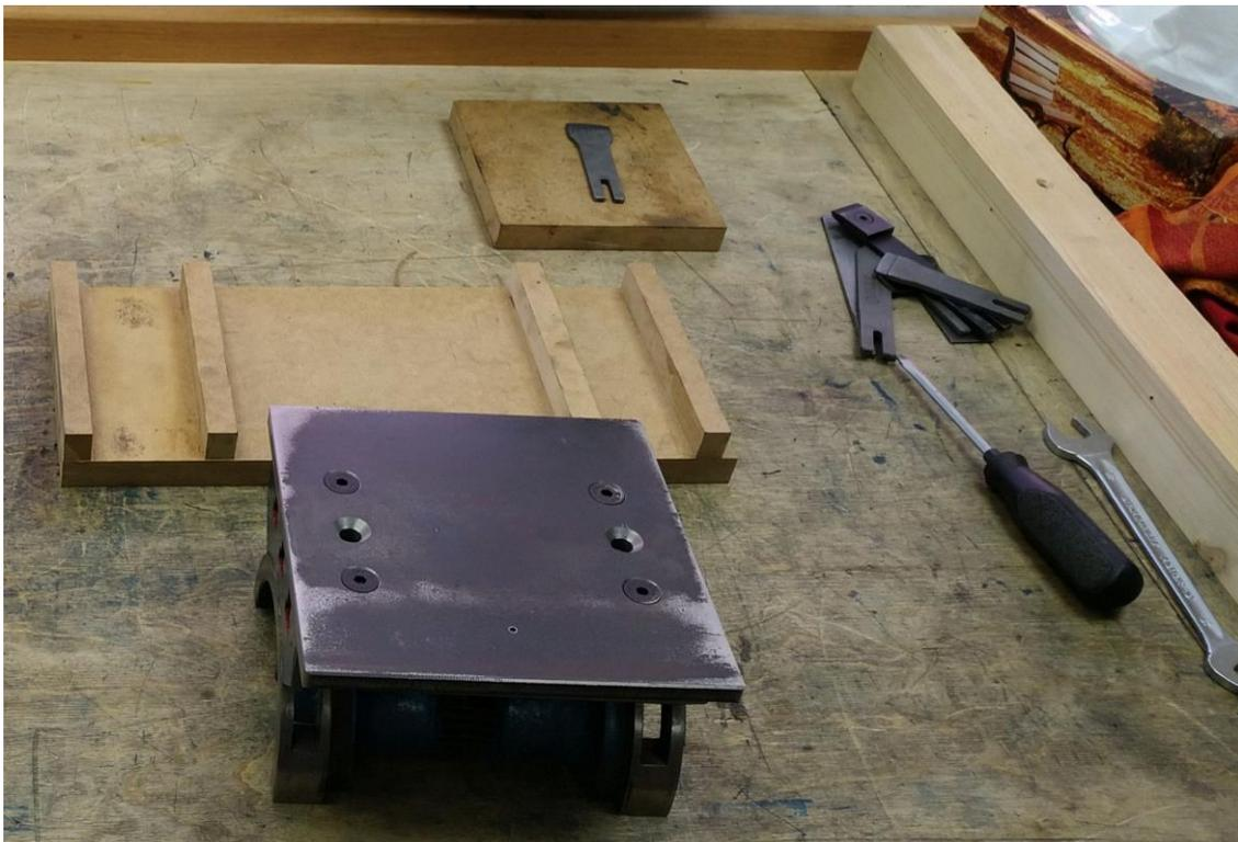
**Abbildung 19: Schwenktisch mit Stahlplatte und Holzbrett**
