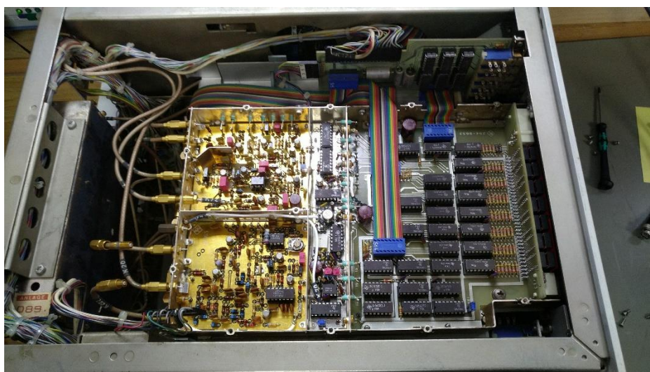
Abbildung 51: auch in der SYNC-Einheit baue ich neue Elkos ein
