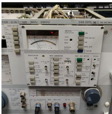
Abbildung 15: Y8 lässt sich sehr gut nach vorne ausbauen!
