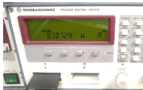
Abbildung 109: 300mW Anzeige - 307mW gemessen
