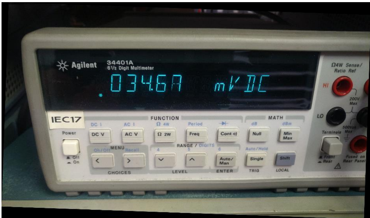
Abbildung 114: und siehe da: an Pin6/B20 stehen jetzt etwa 35mV an - und nicht die 90mV aus dem Manual!
