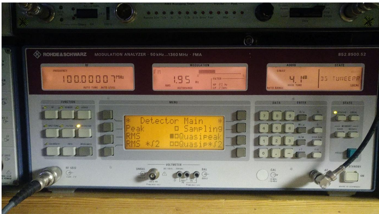
Abbildung 117: finales Endergebnis! FM Störhub 2Hz RMS sind für einen SMDU sicher nicht schlecht!
