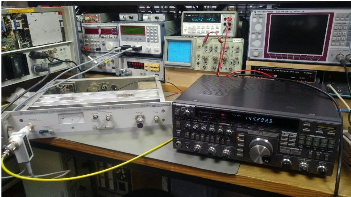
Abbildung 108: Messaufbau mit Yaesu FT-736R als HF-Quelle
