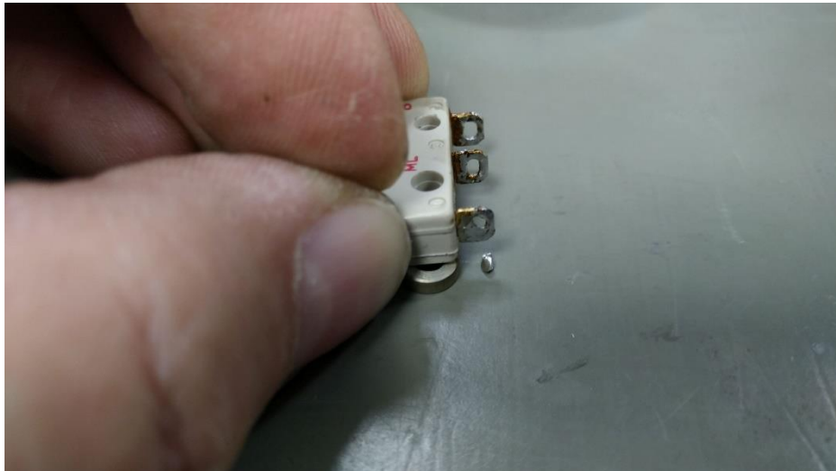
Abbildung 92: nachgestellte Szene: das Lötzinnkügelchen rollt unter die Kontakte des Mikroschalters und schließt so die dort anliegenden +15V gegen Masse kurz!
