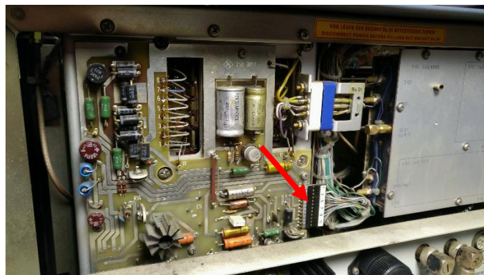
Abbildung 14: SMDU Netzteil mit Steckerleiste
