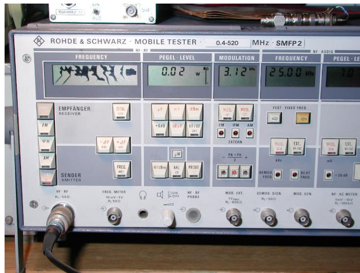
Abbildung 8: R&S SMFP2: die Displays und das Netzteil sind häufige Schwachpunkte bei diesem Modell
