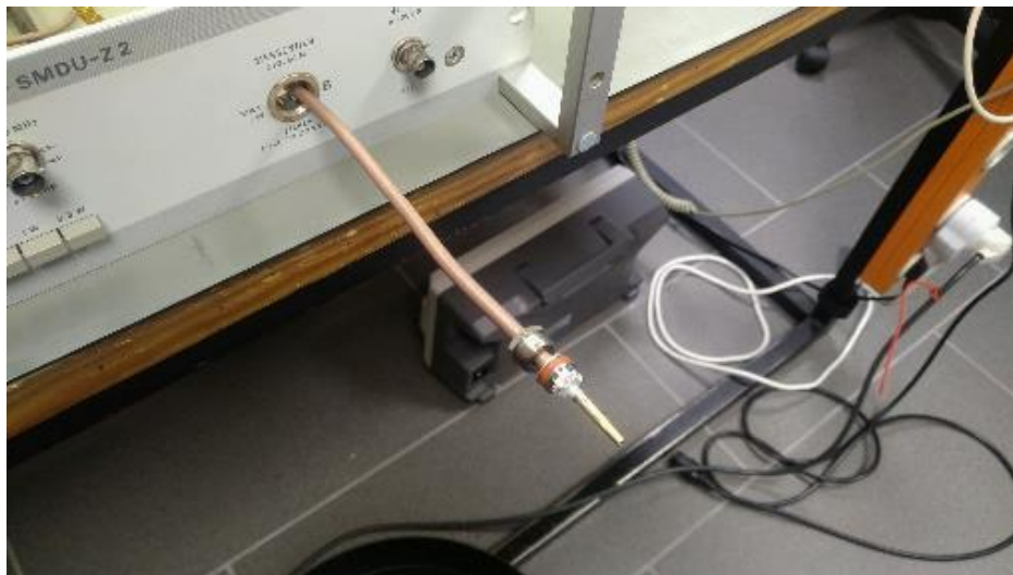
Abbildung 107: alten Stecker weg, hochwertige N-Buchse einbauen (Radiall Typ 161 256)
