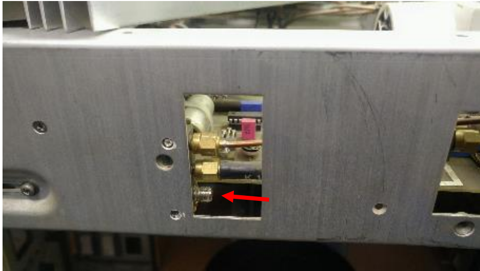
Abbildung 96: untere Leitung am HF-Relais abschrauben
