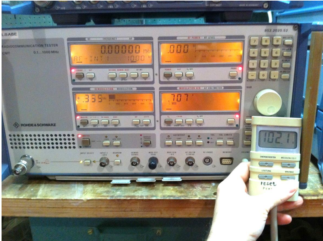
Abbildung 10: R&S CMT52- hier beim Messen seiner Stromaufnahme
