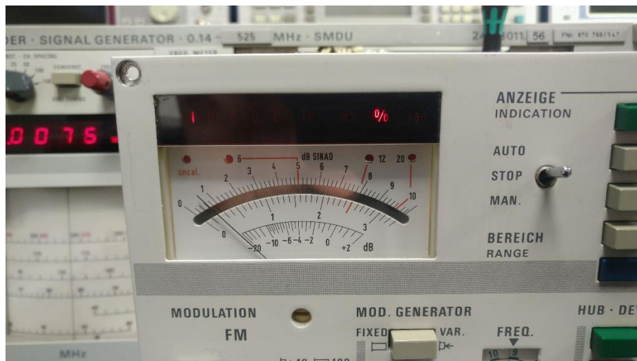
Abbildung 24: Noisefloor des Klirrfaktormessers liegt unter 0,1% THD
