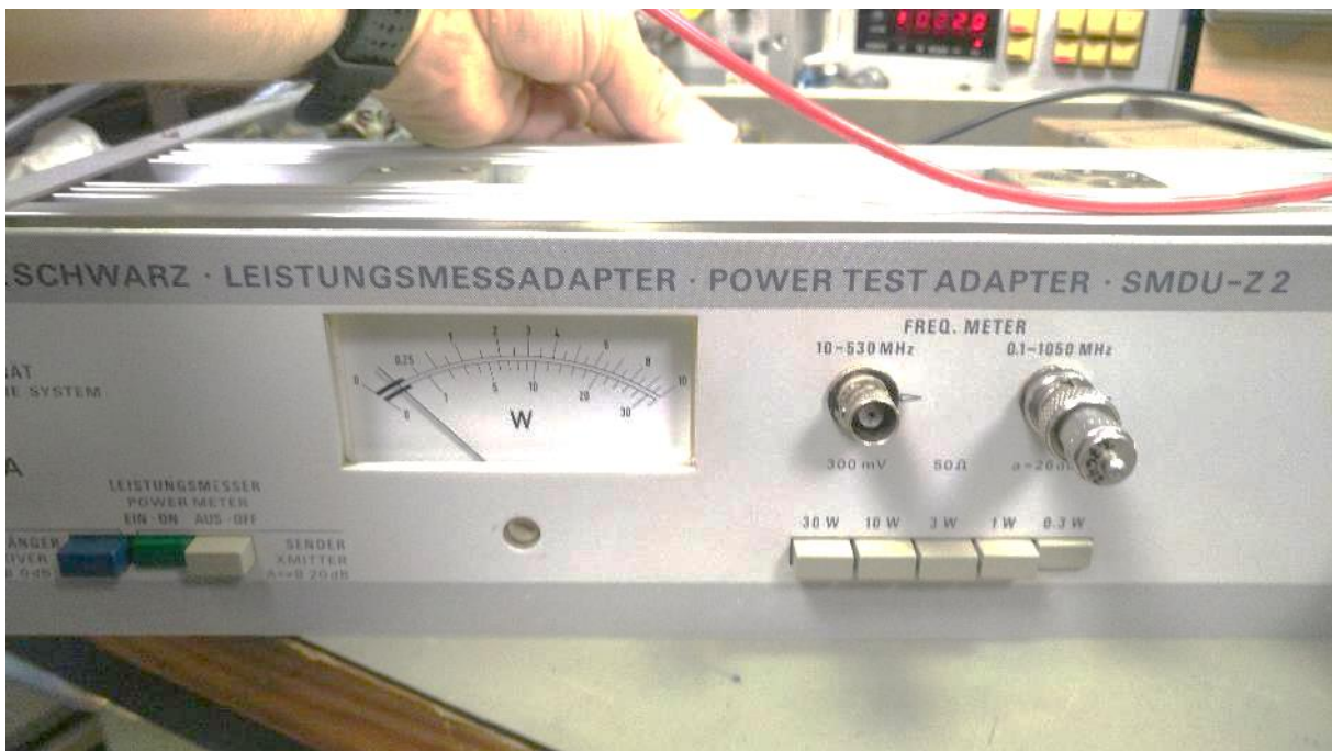
Abbildung 113: der nach der Justierung sich bei mir ergebende Offset der Zeigernadel im Anzeigebereich „0,3W“- sieht für mich für einen SMDU-Z1/Z2 absolut „gesund“ aus!
