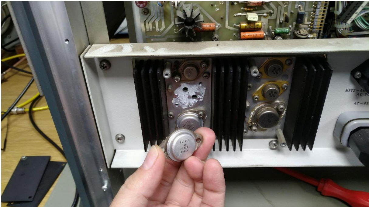
Abbildung 29: im SMDU werden Spannungsregler im TO3-Gehäuse verwendet
