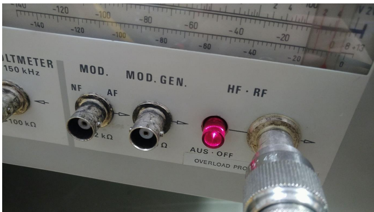
Abbildung 74: leuchtende Lampe: die HF-Protection hat ausgelöst!
