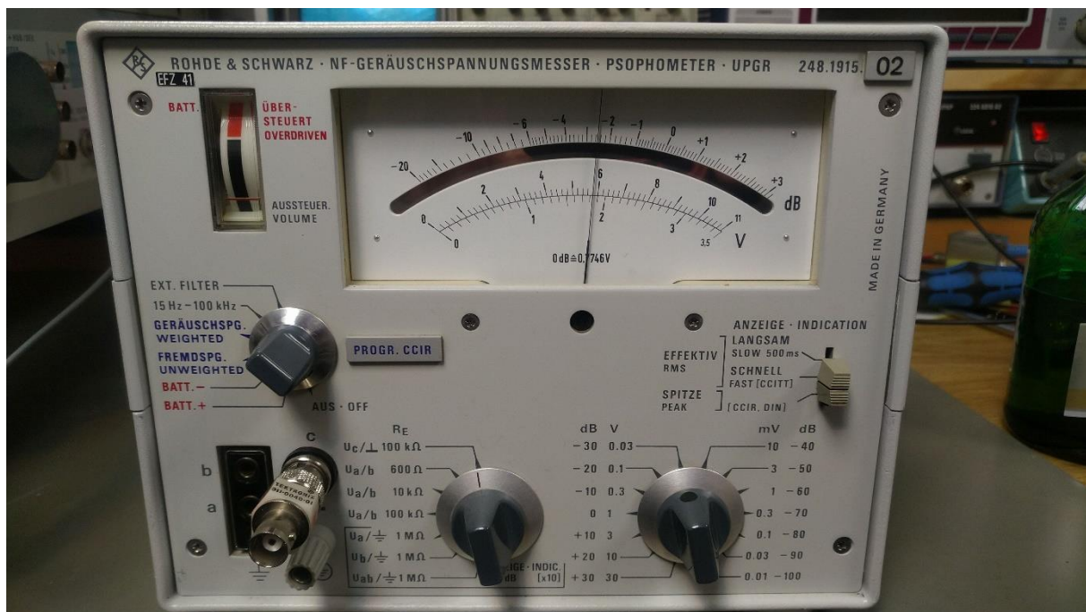
Abbildung 56: Noisefloor des R&S UPRG: 5,8 \mu Veff @100kHz Bandbreite bei 500Ohm Abschluss
