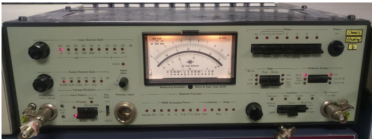
Abbildung 57: das Brüel&Kjaer 2636 schafft in der Realität sogar nur 3,2\mu\text{Veff} @200kHz Bandbreite und 0,8\mu\text{Veff} @22,4kHz Bandbreite!
