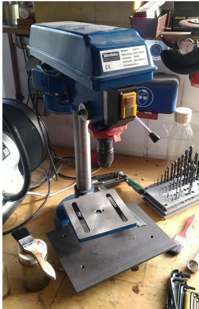
Abbildung 2: meine alte Garagenbohrmaschine. Eine Westfalia ZJ4113. Nicht richtig schlecht, aber auch nicht wirklich "gut"...
