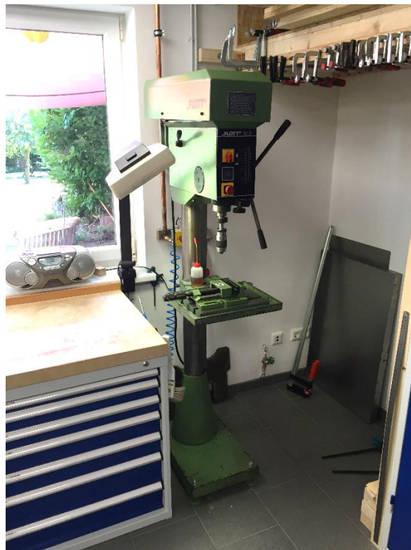
Abbildung 4: hat weniger ein Problem mit 10mm-Löchern in Stahl: unsere Flott M3 in der Werkstatt (mit 1,5kW Asynchronmotor)
