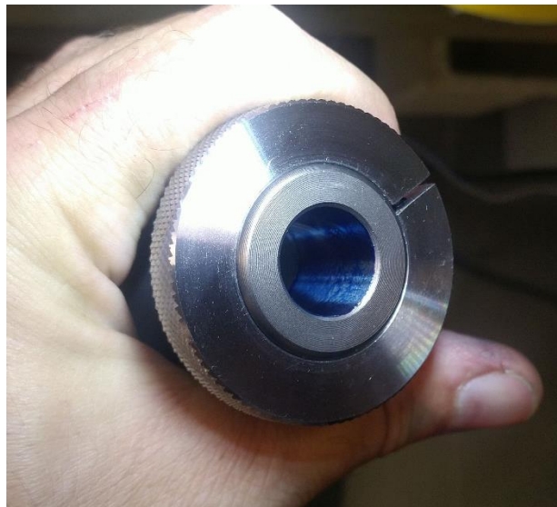
Abbildung 36: das Tuschierbild ist ohne Tadel- überall blau; d.h. überall Kontakt zwischen Spindel und Aufnahme!
