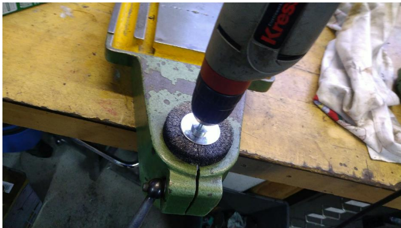
Abbildung 15: zum Entrosten des Inneren habe ich eine genau passende Rundbürste
