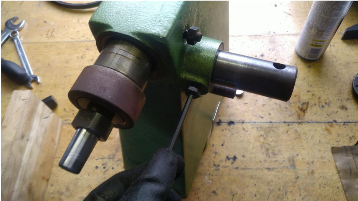
Abbildung 10: diese Madenschraube muss raus, dann kann die Zahnwelle auch raus
