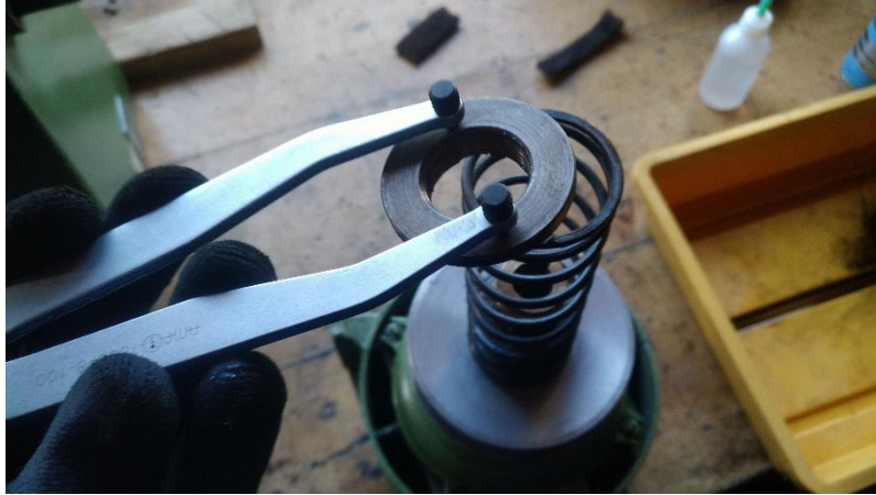
Abbildung 17: zum Auseinanderbau des Variators reicht ein normales Werkzeug für Stirnlochmuttern
