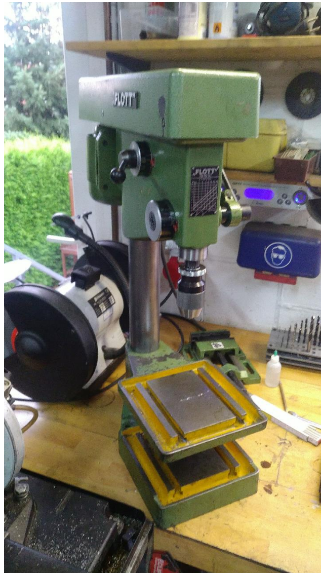
Abbildung 39: die aufgearbeitete Flott TB10St mit dem neuen Albrecht Bohrfutter
