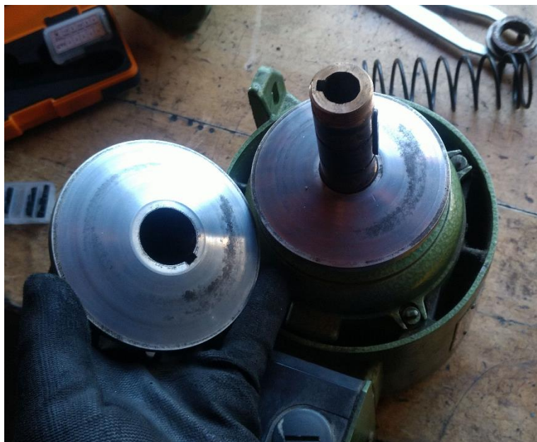
Abbildung 18: die Kegelflächen werden von mir mit Scotch-Brite gesäubert
