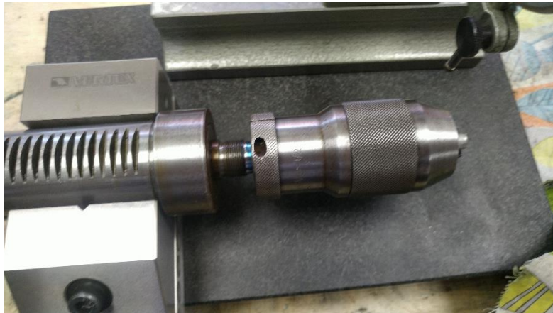
Abbildung 32: der Sitz des alten Bohrfutter scheint gut...
