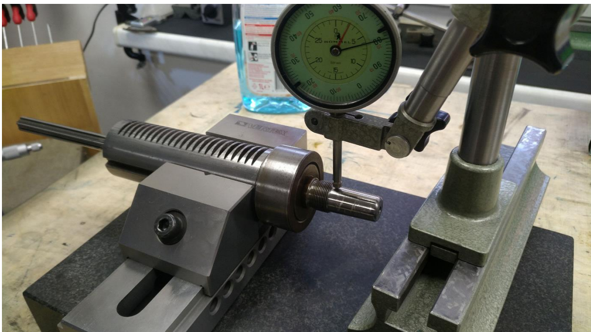
Abbildung 23: der Kegel ist zwar schön rund, aber selbst nach dem Polieren sind noch deutliche Riefen drin
