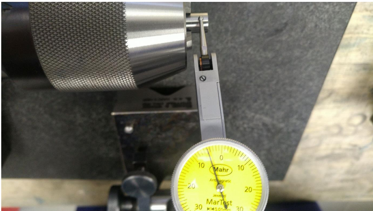
Abbildung 38: Rundlauf am Prüfstift: 50µm TIR!
