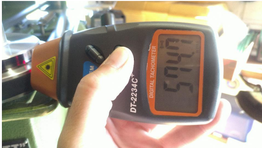
Abbildung 34: Messung der Spindeldrehzahlen mit einem einfachen Laser-Tachometer
