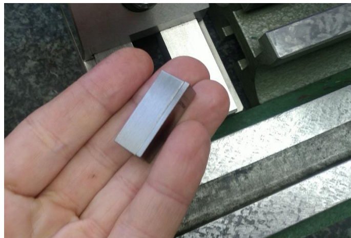
Abbildung 26: ein auf exakt 12,00mm eingestelltes Endmaß...
