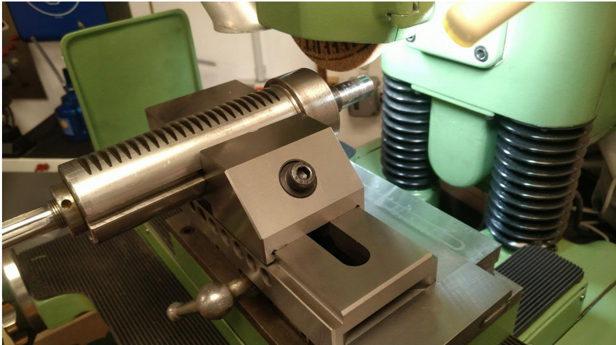
Abbildung 29: die Pinole fertig eingerichtet an der Flachsleifmaschine
