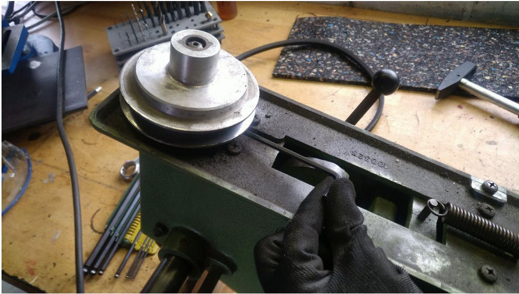
Abbildung 8: Abnehmen der Riemenscheibe für die Pinole
