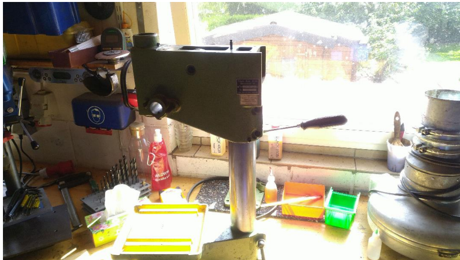
Abbildung 21: wenn man den Spalt mit einem Schraubendreher etwas weitet, kann man das Oberteil viel besser auf die Maschinensäule stecken
