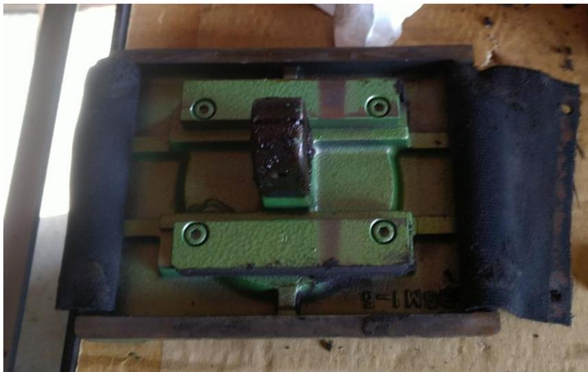
**Abbildung 18: das eine Tischchen mit seinen Schmutzabweisern und der Spindelmutter**
