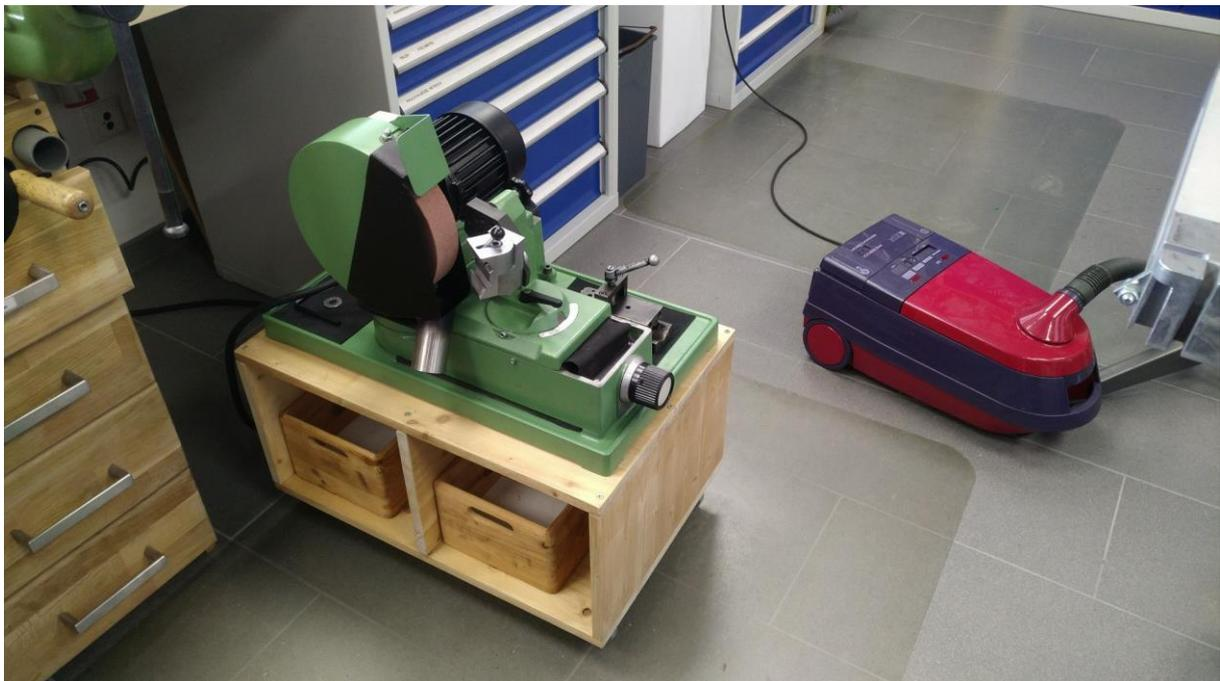
**Abbildung 58: die BSG60 mit selbstgebauter Absaughaube und Unterstand**
