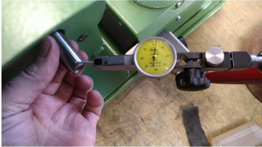
**Abbildung 53: der Rundlauffehler ist bei mir maximal 25µm TIR**
