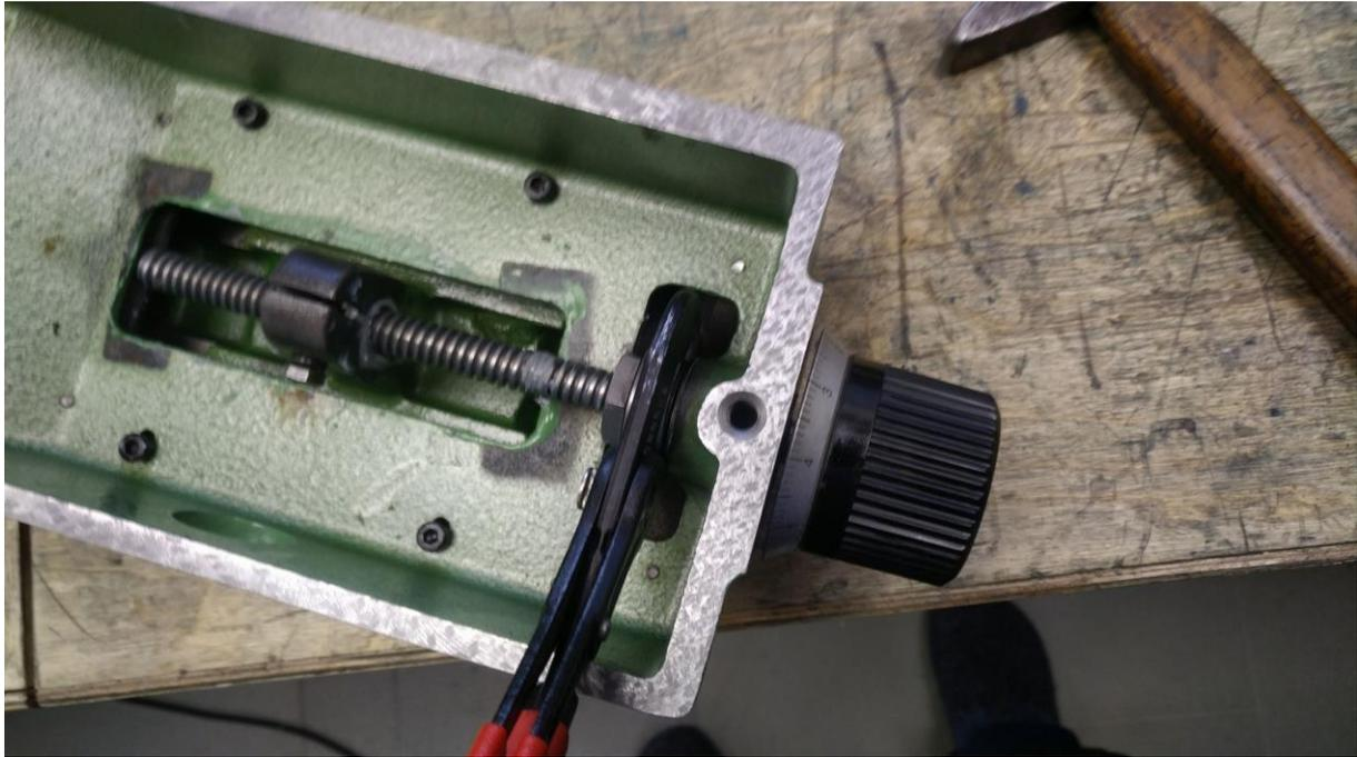
**Abbildung 43: Mutter anziehen und kontern**
