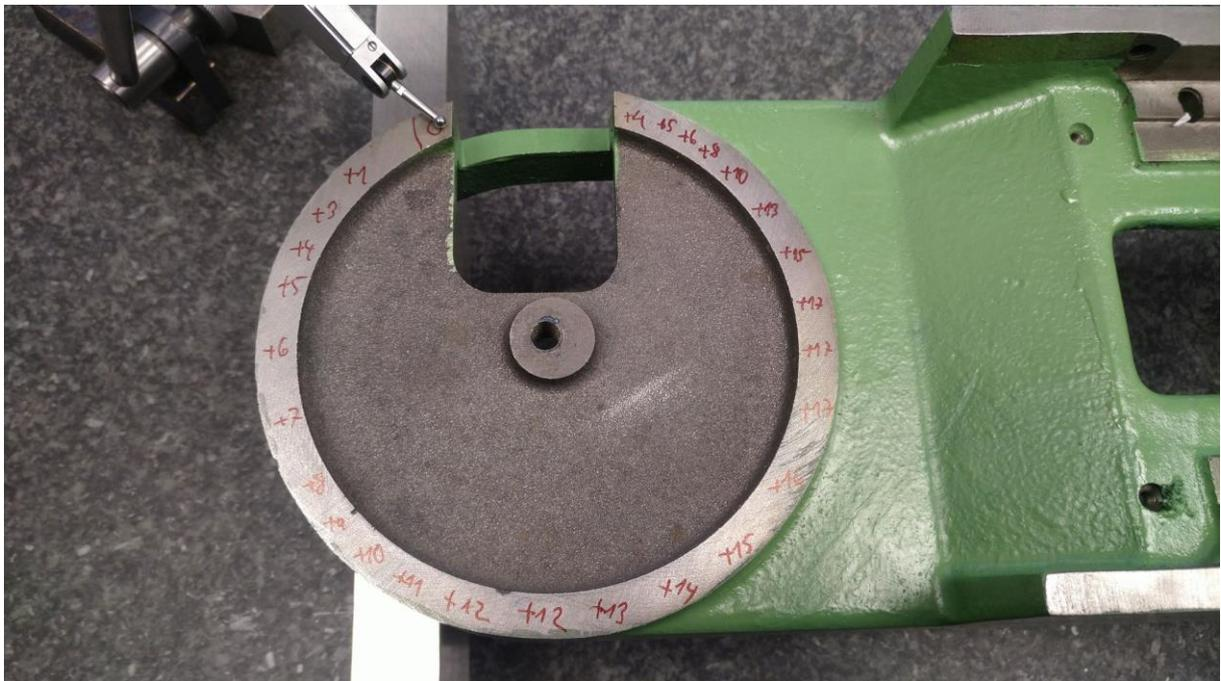
Abbildung 27: Niveau auf dem Flansch; alle Messwerte in [10 µm]
