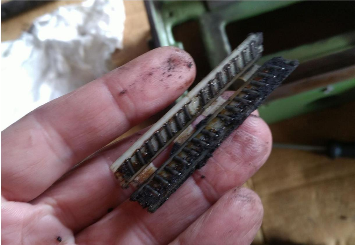
**Abbildung 15: Nadellager in einer Bohrerschleifmaschine! - wenn auch (noch!) total verdreckt ;-)**
