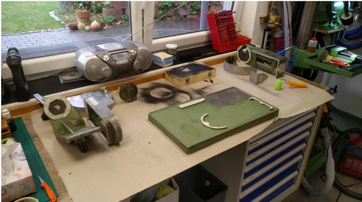
**Abbildung 19: Teile abgeklebt und fertig zum Lackieren**
