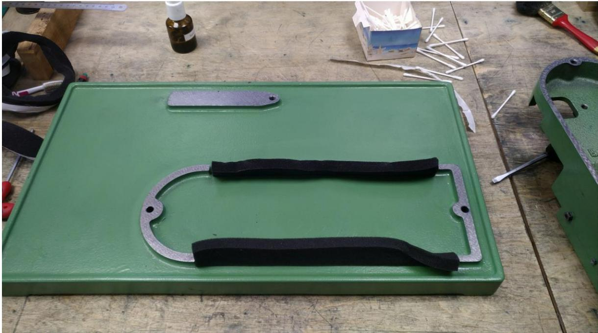
Abbildung 36: aufgeklebtes Kompriband als Dichtung
