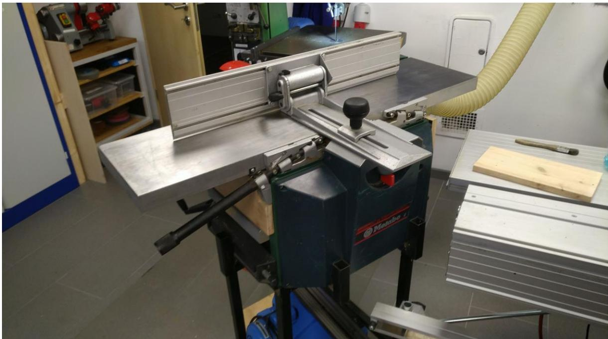
**Abbildung 3: auch so ein Problemfall: geometrisch korrektes Einstellen der Tische beim Elektrohobel. Nicht so einfach, wie man erst denkt!**
