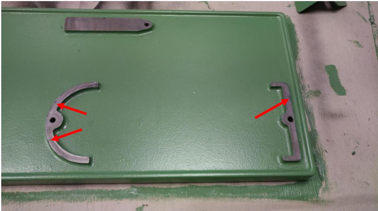
Abbildung 21: das erste Tuschiebild...quasi fast NICHTS an Kontaktpunkten sichtbar...
