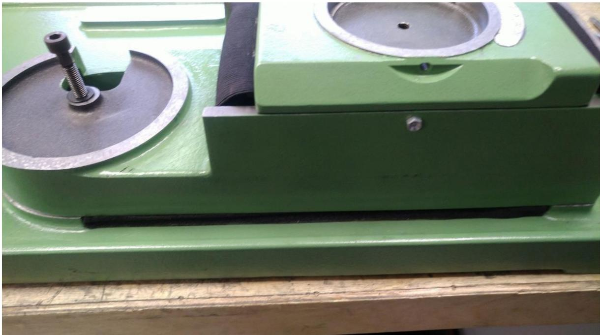
**Abbildung 44: das Kompriband dichtet offene Ritzen ab, damit kein Schleifstaub eindringen und sich auf die gefettete Spindel legen kann**
