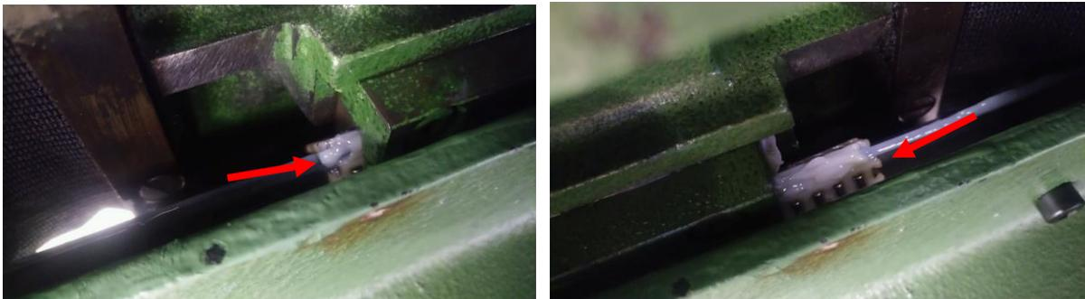
Abbildung 39: links guckt das Lager etwas kürzer heraus als rechts => also liegt es noch nicht mittig!
