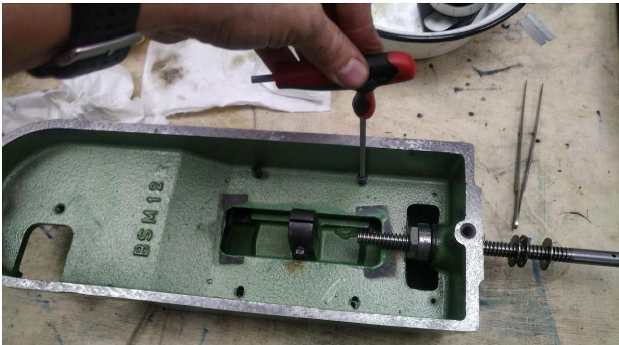
Abbildung 41: Festschrauben der Laufschienen, nachdem die Position der Linearlager noch einmal mittig ausgerichtet wurde
