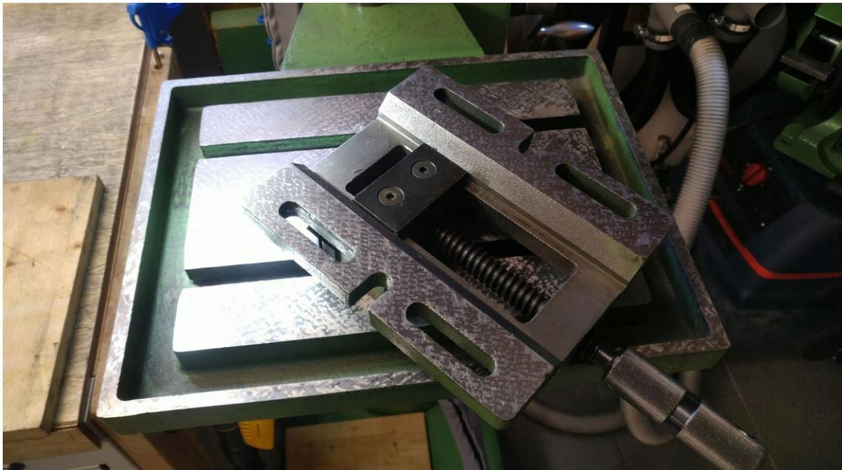
**Abbildung 62: Faszinierendes Hobby "Schaben": eingeschabter Bohrtisch an meiner Flott M3 und passend dazu die Unterseite des dort verwendeten Bohr-Schraubstocks**
