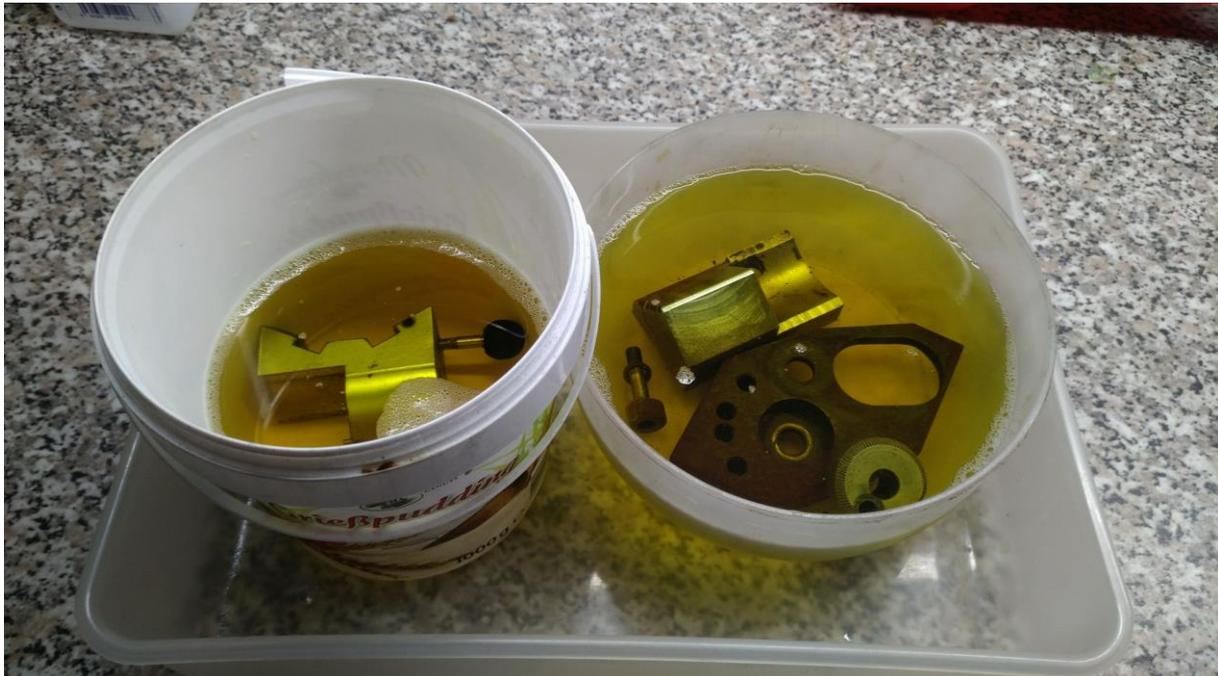
Abbildung 10: wahrscheinlich wäre es auch mit Essig gegangen- aber Evaporust funktioniert bei mir wirklich sehr gut
