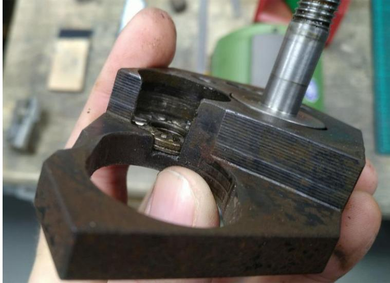
Abbildung 9: der angerostete Schwenkhalter
