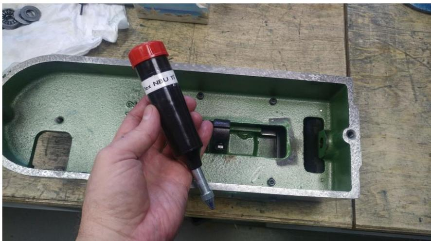
Abbildung 37: Klüber Isoflex NBU15 zum Fetten der Spindeln
