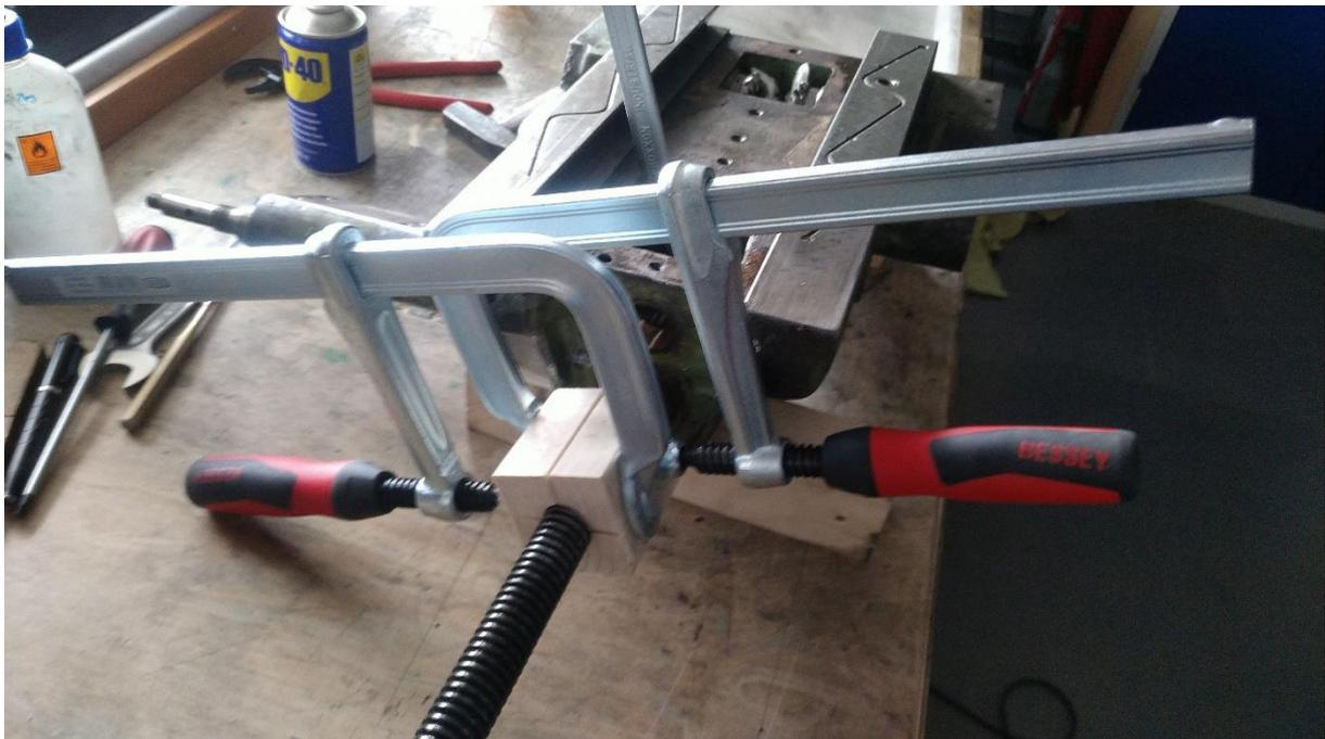
**Abbildung 190: erster Versuch: Fichtenholzbacken versagen!**
