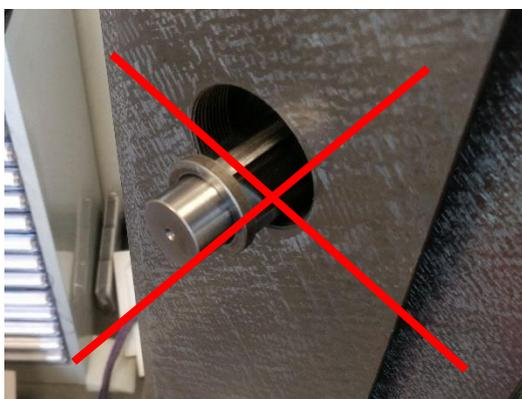
**Abbildung 133: links: falsch! Die Welle darf bei der Montage von Ronny nicht herausgucken!**
