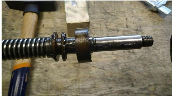
**Abbildung 196: die Z-Spindel ist auch ziemlich verpekt**
