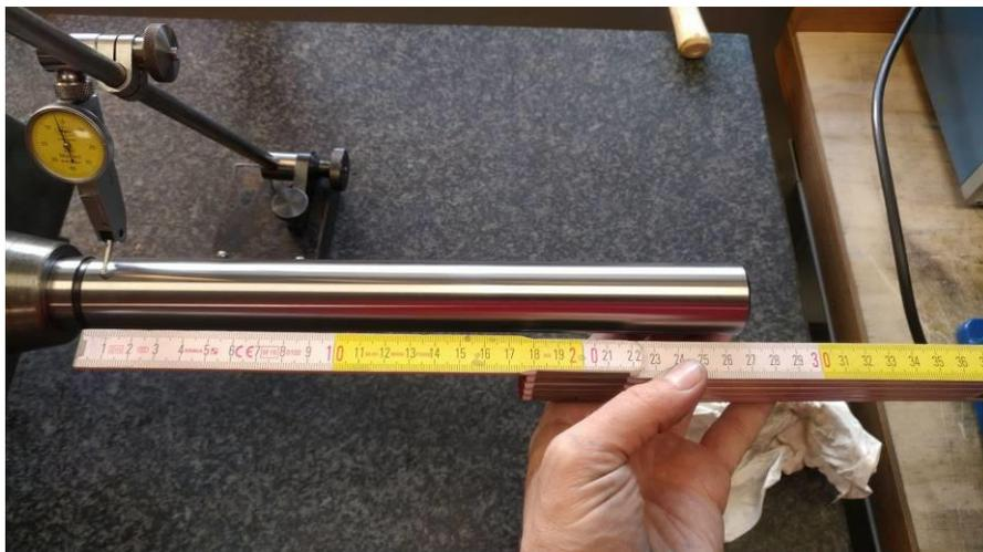
**Abbildung 53: die Prüffläche des Dorns ist etwa 27cm lang**
