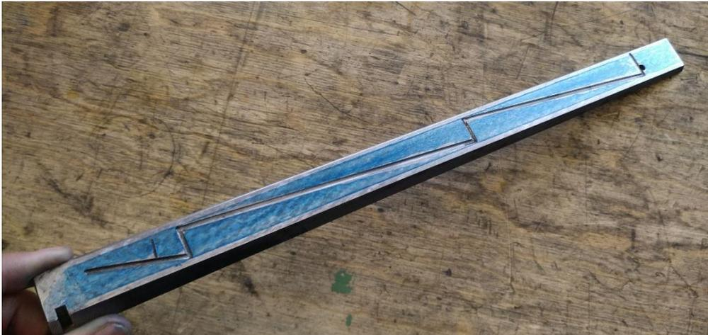
**Abbildung 233: Tuschierbild im SSW der Fräse**
