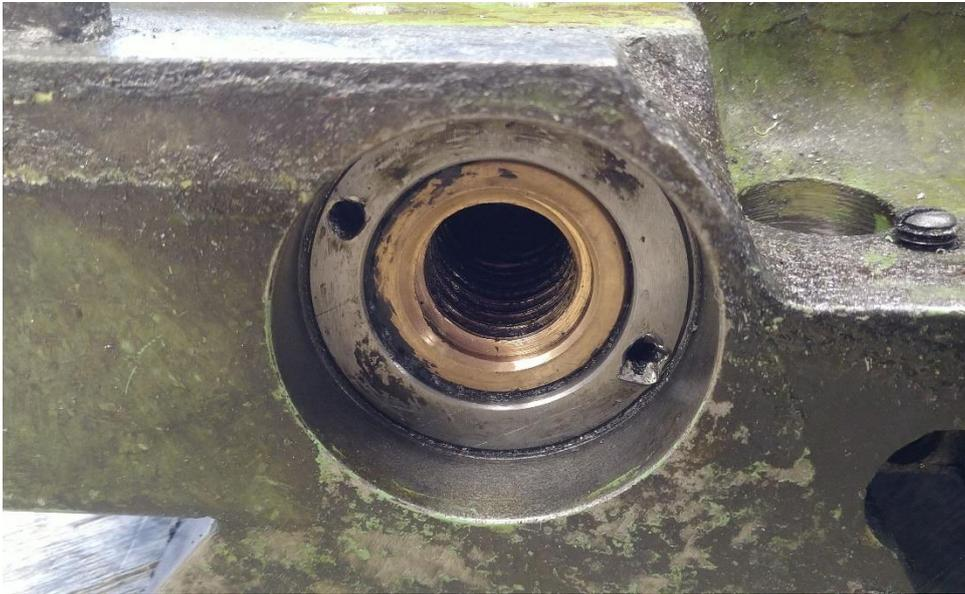
Abbildung 172: die X-Spindelmutter
