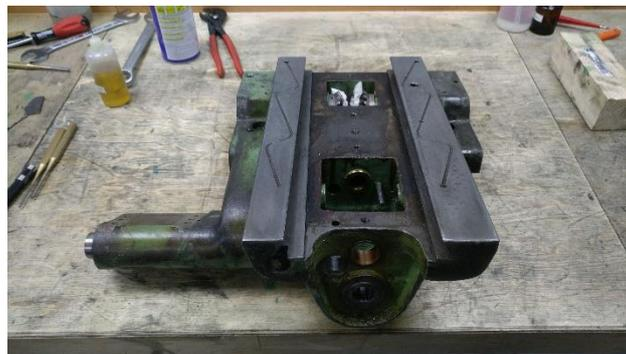
**Abbildung 198: Konsolenschlitten- endlich fertig ausgebaut!**
