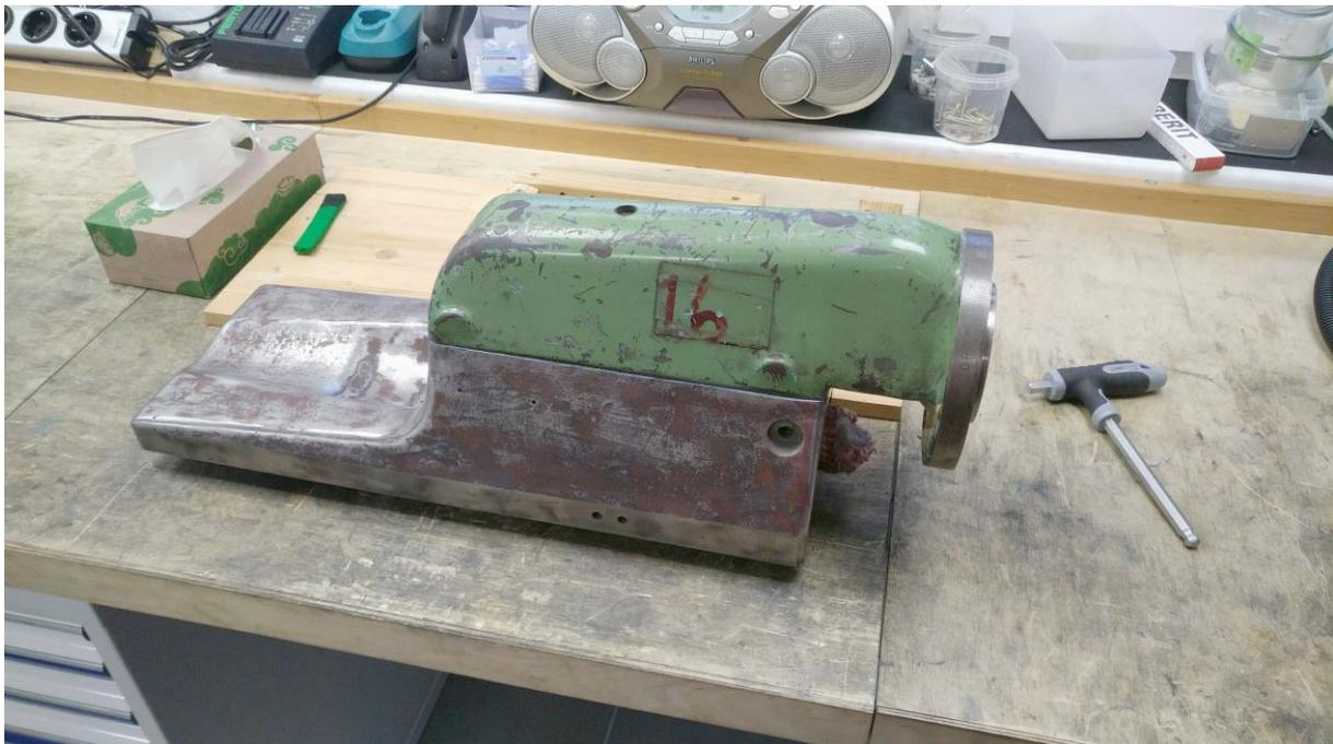
**Abbildung 49: Fräsbock bereits entlackt; Fräskopf noch nicht**
