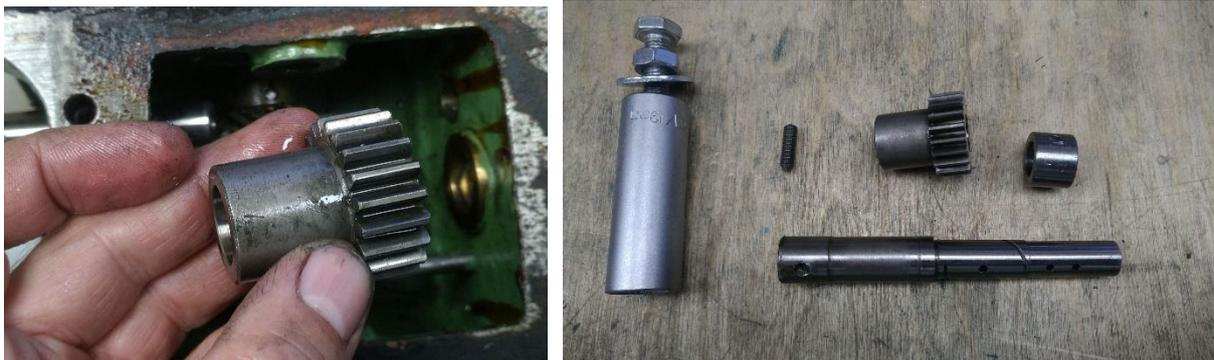
**Abbildung 189: links: das Zahnrad; rechts: alle Teile der Nebelwelle und das Ausziehwerkzeug**
