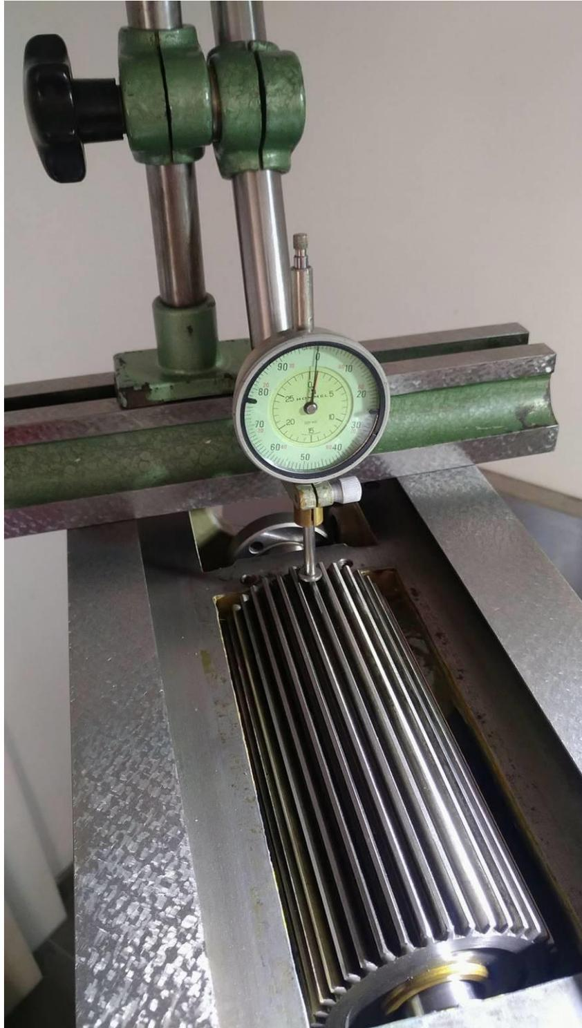
**Abbildung 58: Messung der Walzenzähne**
