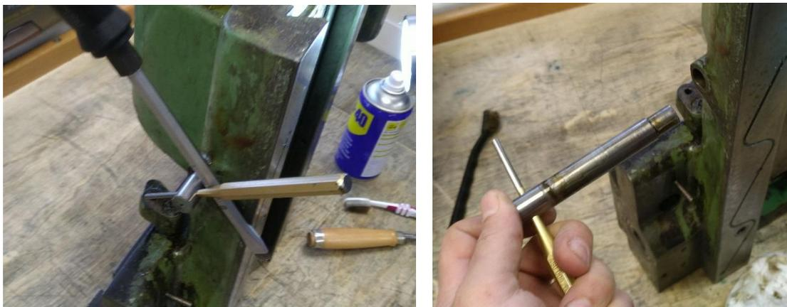
Abbildung 157: Heraushebeln der Achse
