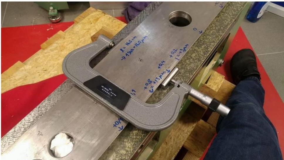
Abbildung 19: Messung des Schwalbenschwanzes
