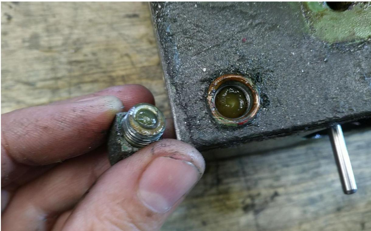
**Abbildung 203: Bereits während der Reinigung fiel mir schon was auf: hier gehört Öl hinein- kein Fett!
