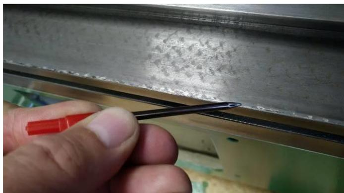
Abbildung 9: Detektivarbeit: ein Streifen noch "jungfräulicher" Führungsbahn!
