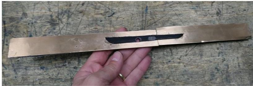
**Abbildung 86: frisch aufgedickte Keilleiste**
