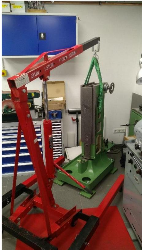
Abbildung 208: Schritt 1: Säule anheben
