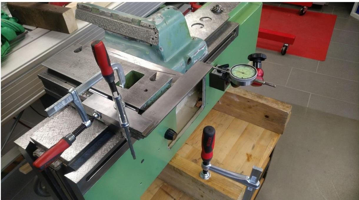
**Abbildung 217: Messaufbau zur Kontrolle des Winkels zwischen Z und X**
