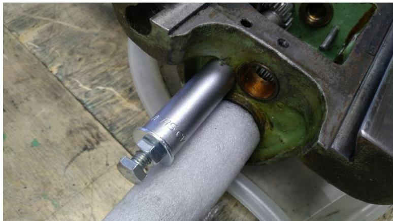
Abbildung 187: improvisiertes Ausziehwerkzeug
