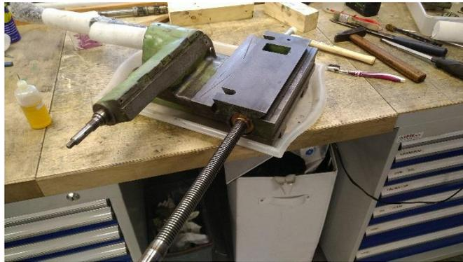
**Abbildung 175: die X-Spindel einschrauben...**
