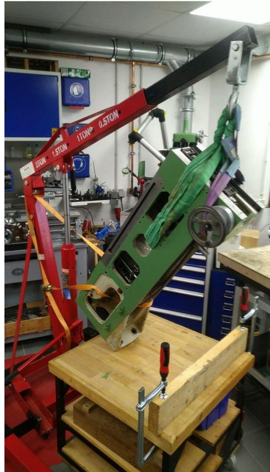
**Abbildung 211: Schritt 4: langsam abkippen (Vorsicht, Rutschgefahr!)**
