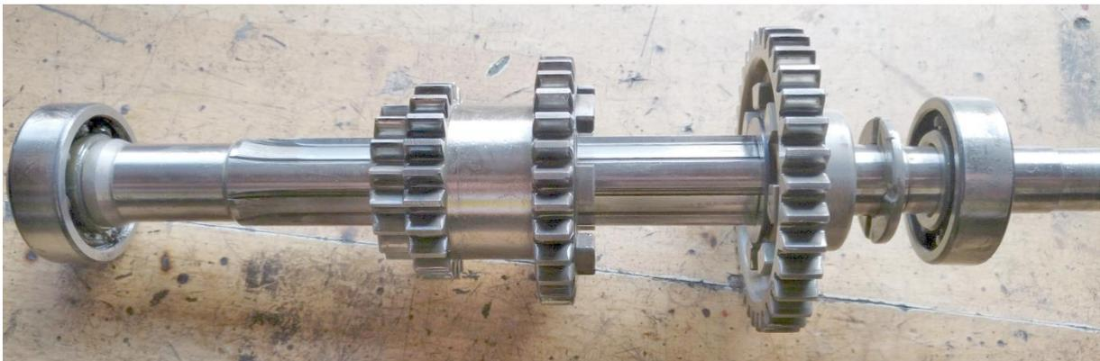
Abbildung 104: Welle ausgebaut
