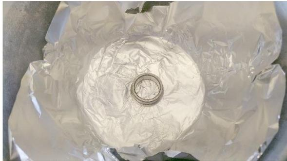
Abbildung 129: der Innenring von Xavier wird im Heizplattentopf aufgeheizt
