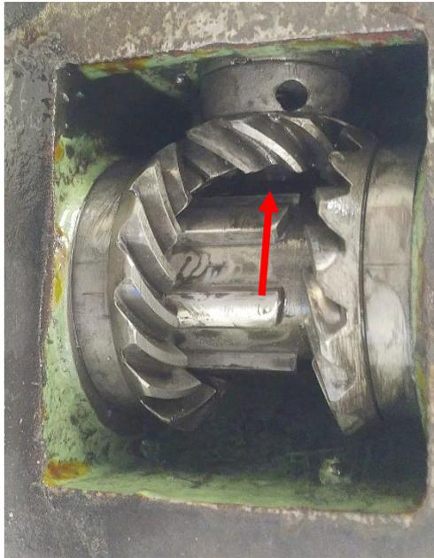
**Abbildung 170: Selbst mit ausgebohrtem Stift ist kein Platz, um die Welle mit einem Hammer nach oben austreiben zu können!**
