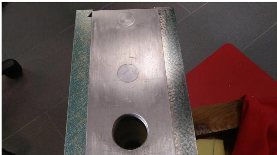
**Abbildung 14: Führungsbahn links: bereits grob geschabt; rechts: noch unbehandelt**
