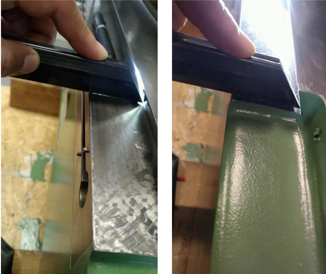
**Abbildung 10: Prüfung mit Haarlineal an abgenutzter Stelle (links) und Vergleich ganz am Ende (rechts) der Führungsbahn**
