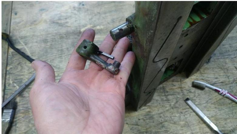
Abbildung 156: das Hebelchen ist ab- aber nur mit Ausbohren!
