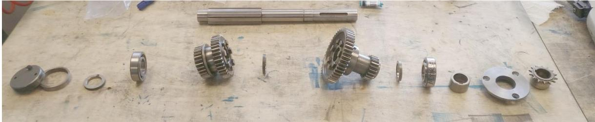
Abbildung 120: alle Teile von Welle 2 ausgebreitet.
