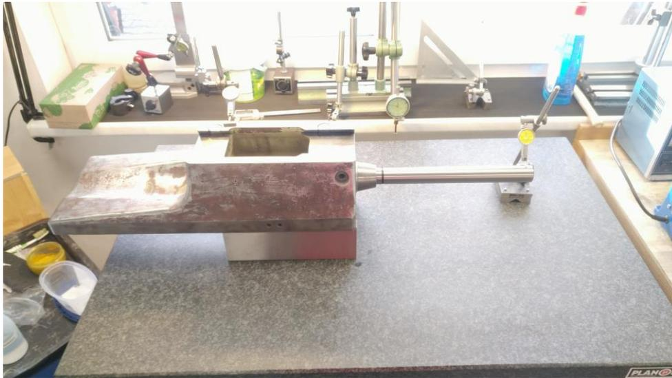
Abbildung 51: Messaufbau mit Prüfdorn
