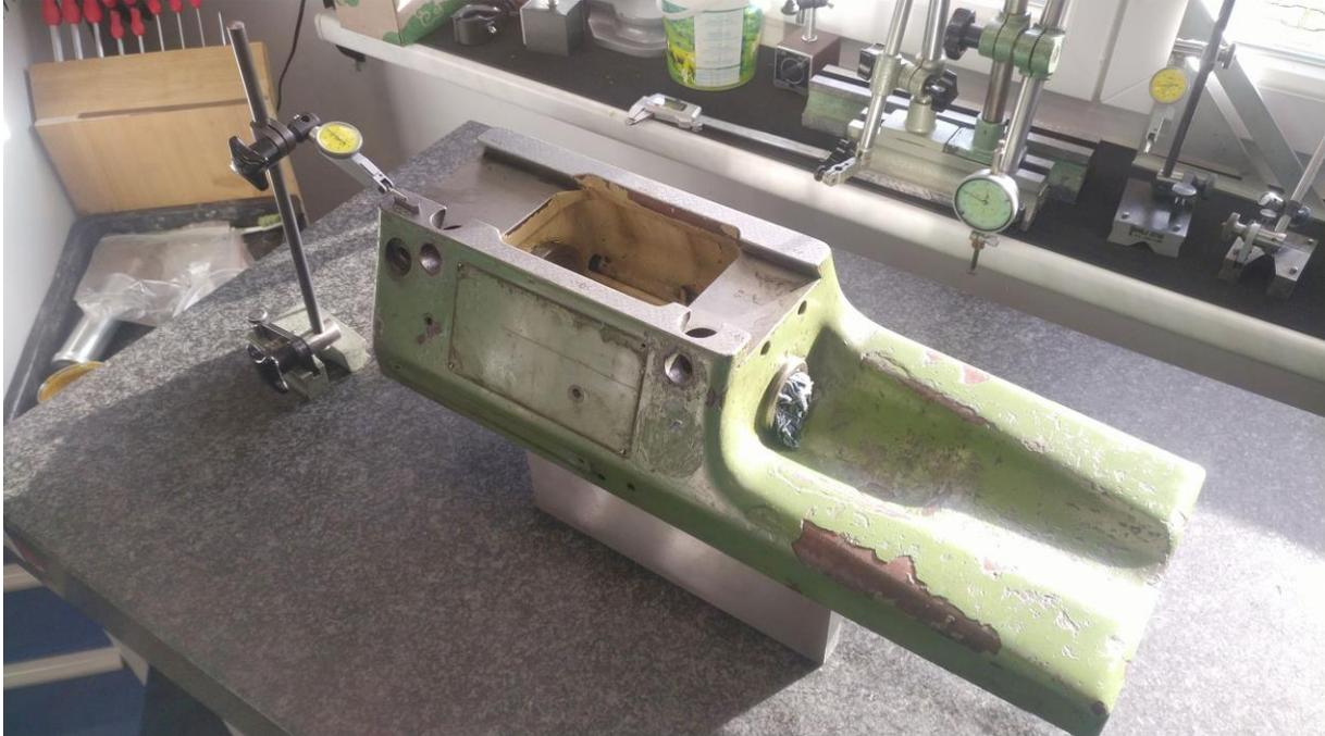
**Abbildung 47: Messung der Parallelität zwischen unteren und oberen Führungsflächen**
