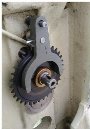
Abbildung 108: Trenngabel eingebaut
