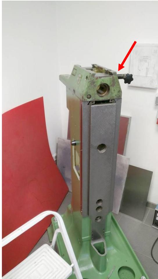
Abbildung 46: der Fräsbock (Pfeil) ist das nächste zu schabende Bauteil
