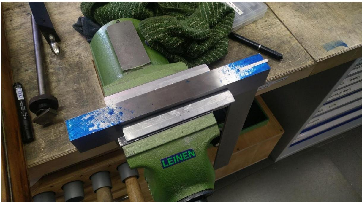
Abbildung 243: kein gutes Tuschiebild für einen Präzisionswinkel!
