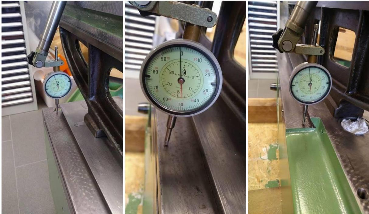
**Abbildung 12: links/rechts: Messuhr auf Null. Mitte: die Abnutzung beträgt an dieser Stelle offensichtlich nur(!) etwa 10µm!**
