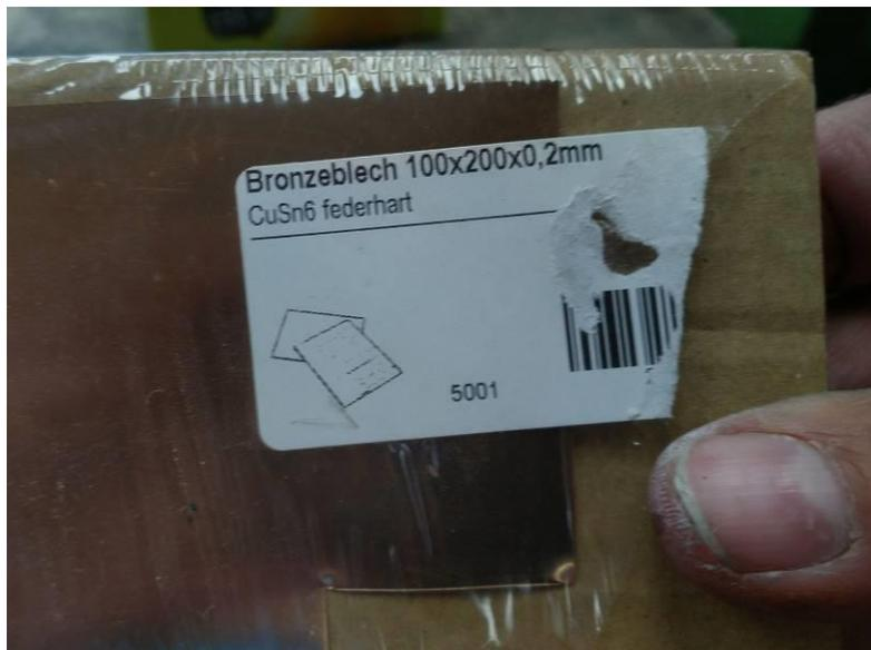
**Abbildung 77: Bronzeblech zum Aufdicken der Keilleiste**
