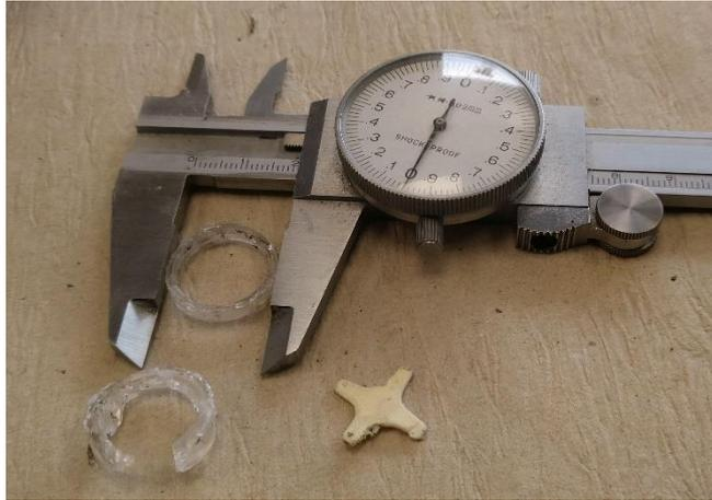
**Abbildung 152: das Öläuge ist hin- aber Singer hat das passende Ersatzteil!**
