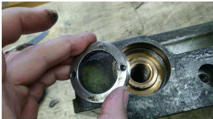
**Abbildung 174: die Stirnlochmutter ist wenigstens runter**
