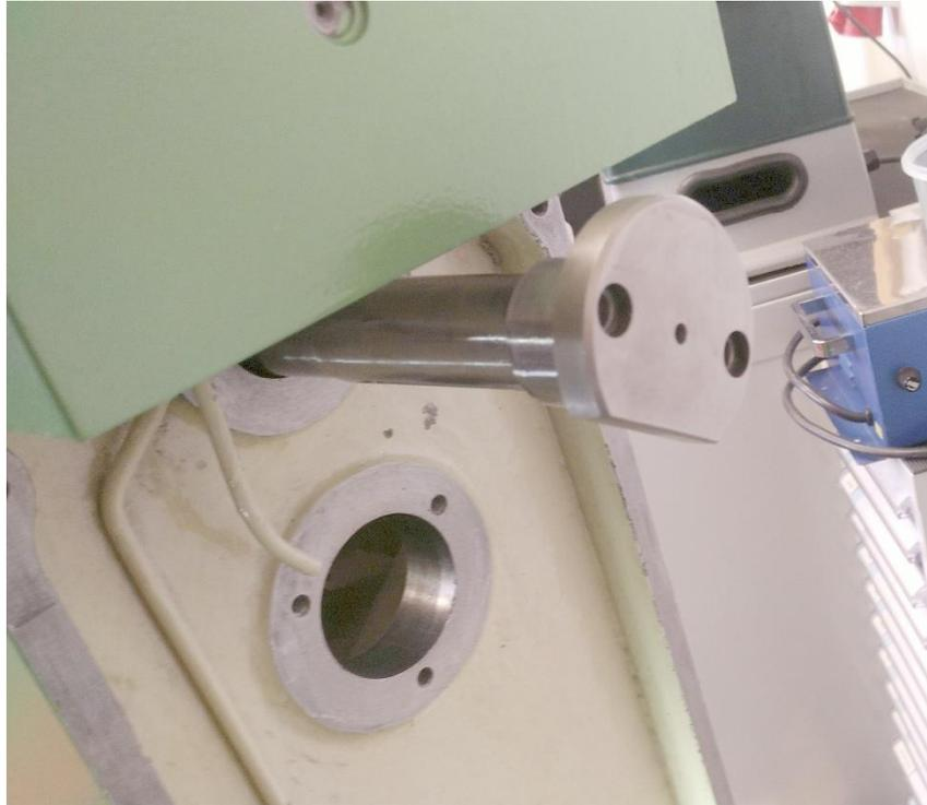
**Abbildung 117: Welle 1 wird eingeschoben. Zuletzt geht es sehr stramm, aber man sollte den Gummihammer trotzdem in der Schublade lassen! Warum- sehe Text!**
