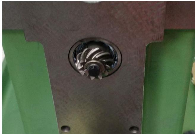
Abbildung 95: das Kegelrad sitzt
