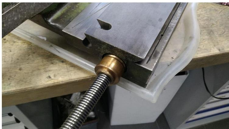
**Abbildung 177: leichte Hammerschläge reichen aus, um die Spindelmutter auszutreiben**
