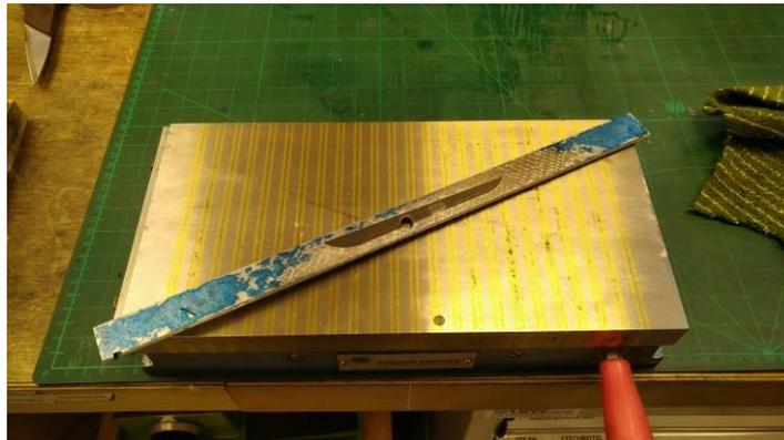
**Abbildung 74: dieselbe Keilleiste nach dem Biegen und etwas Schaben**
