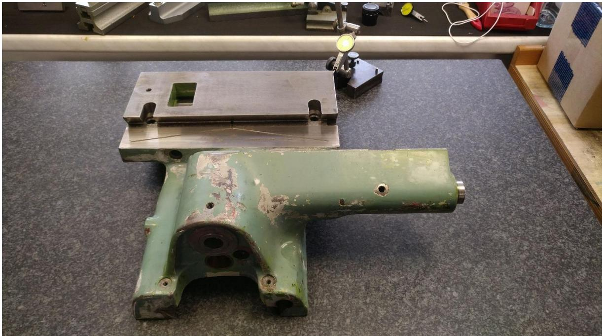
**Abbildung 204: erste Vermessung des Konsolenschlittens**
