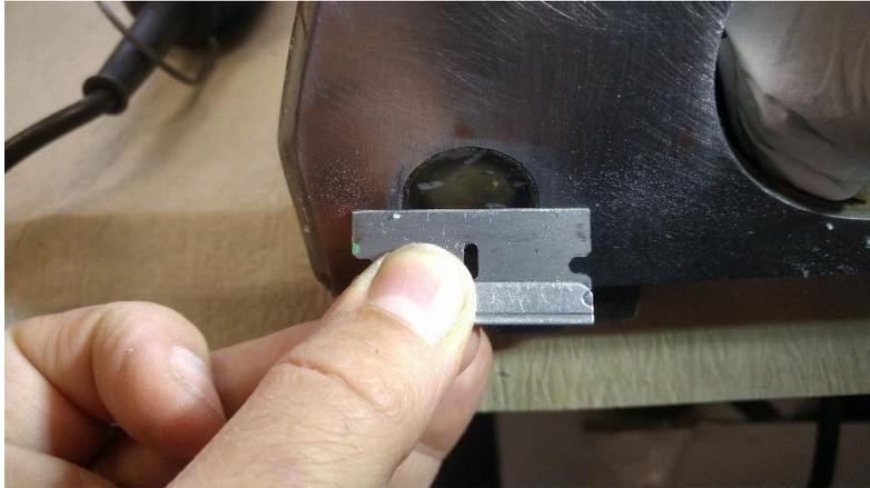
**Abbildung 146: zuerst ziehe ich die Oberfläche mit einer Rasierklinge ab**
