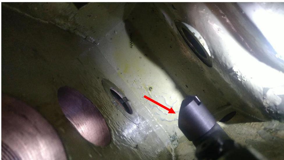
**Abbildung 91: Zielgebiet für Welle 5 mit dem Umwerfer. Die lange Schräge (Pfeil) muss dann später nach unten zeigen und in Bernds großes Zahnrad greifen!**
