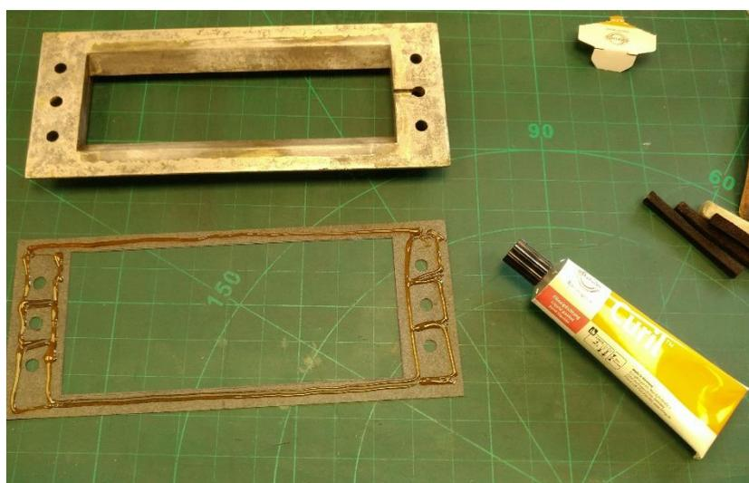
Abbildung 143: Flüssigdichtung auftragen (Curil)
