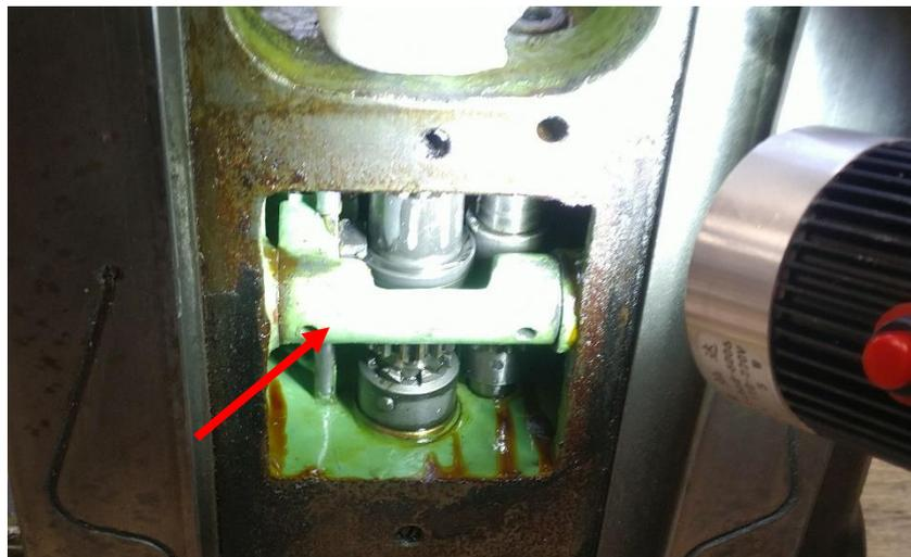
**Abbildung 159: die Brücke, die beide Achsen miteinander verbindet**
