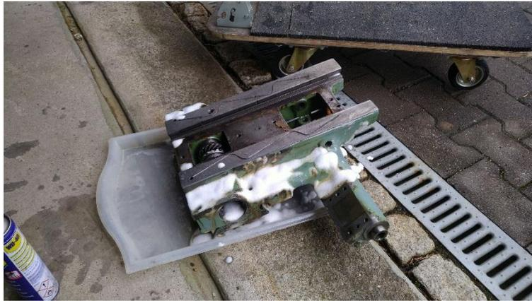
Abbildung 199: Backofenreiniger und Wasserschlauch
