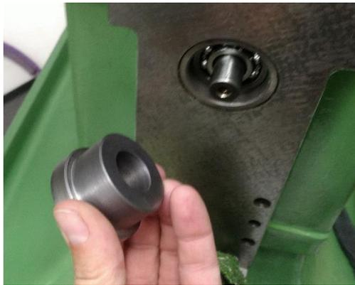
**Abbildung 93: selbstgedrehtes Schlagstück aus Gusseisen**
