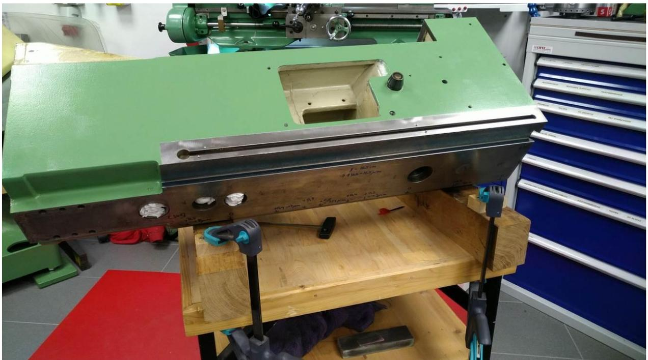
**Abbildung 21: Setup zum Schaben des Schwalbenschwanzes**
