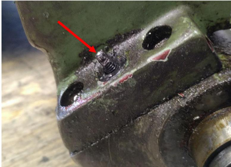
**Abbildung 166: ein Gewindestift verhindert den einfachen Ausbau der Achse**
