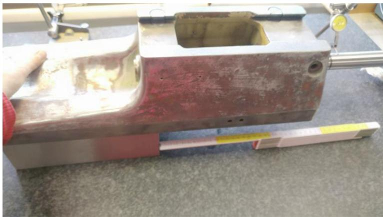
**Abbildung 54: alternative Messmethode: anstatt entlang des Prüfstabs zu messen verschiebe ich den Auflagepunkt des Fräskopfes – damit schließe ich Fehlmessungen durch den Prüfdorn aus**
