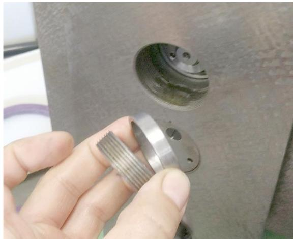
Abbildung 110: Schraubkappe mit Distanzring kurz vor dem Eindrehen an Welle 3
