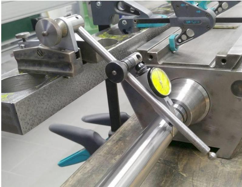
Abbildung 67: ... und den das Messuhrstativ als Messanschlag benutzt
