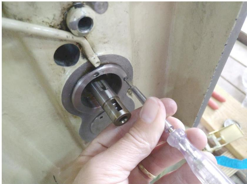
Abbildung 106: Philipp hat eine kleine Madenschraube. Bei mir kommt sie beim Einschrauben von Philipp ganz genau rechts auf exakt 90° zum Liegen!
