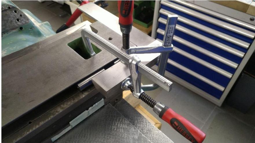
**Abbildung 218: rechter Winkel angespannt**
