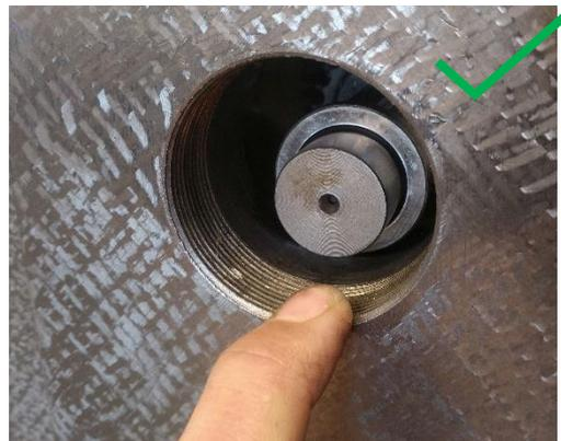
**Abbildung 134: rechts: richtig! Die Welle ist eingeschoben, nun kann Ronny aufgesetzt werden**
