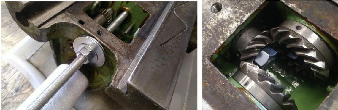
**Abbildung 179: Lagerbuchse zurückziehen mit M12 Gewindestange**
