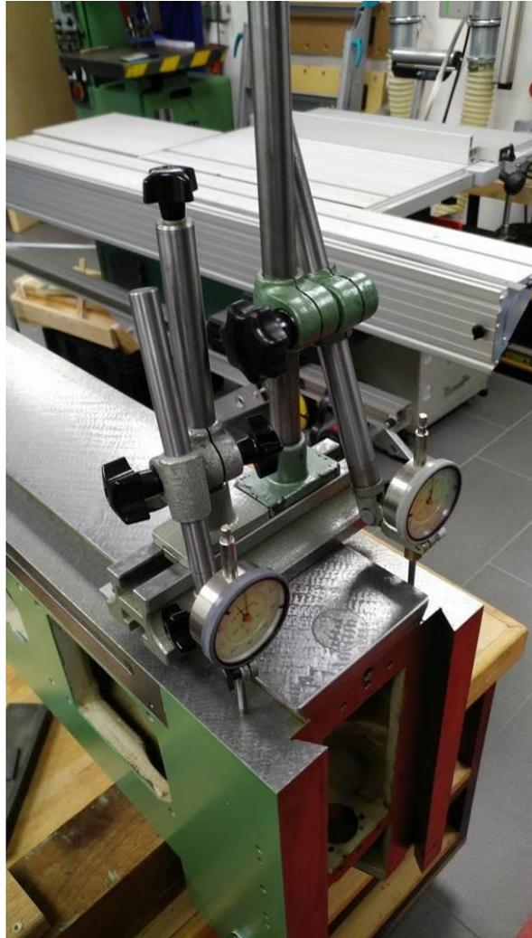
**Abbildung 31: mein Messbalken als alternative Prüfmethode**
