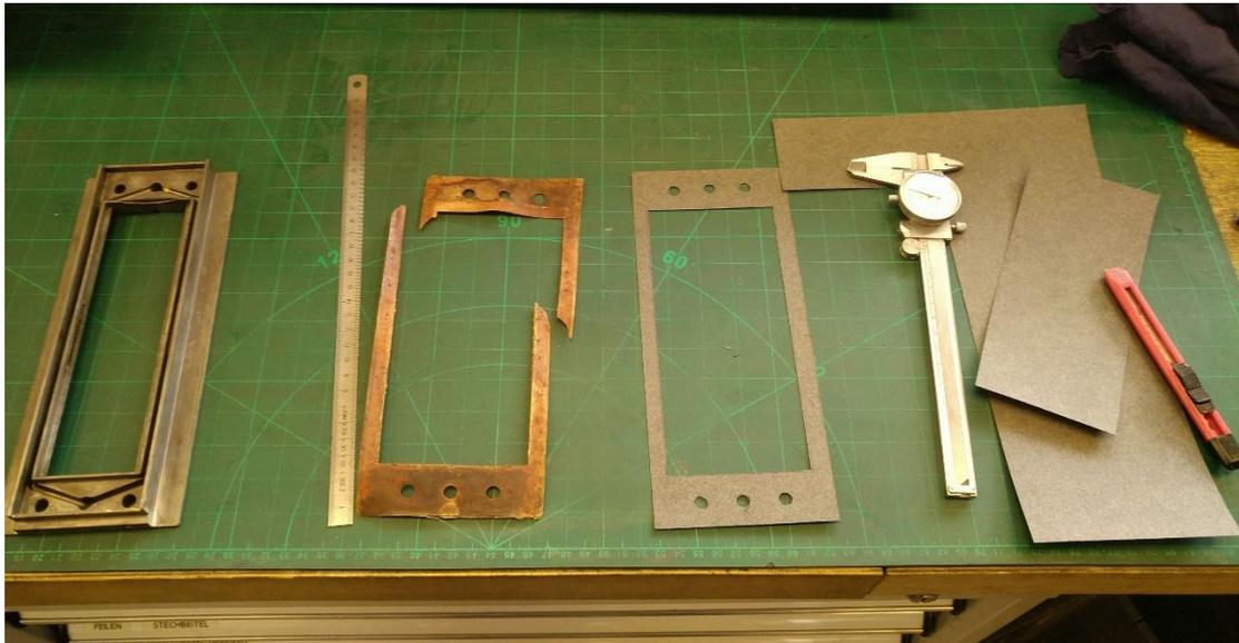
Abbildung 142: Nachfertigen der Papierdichtung
