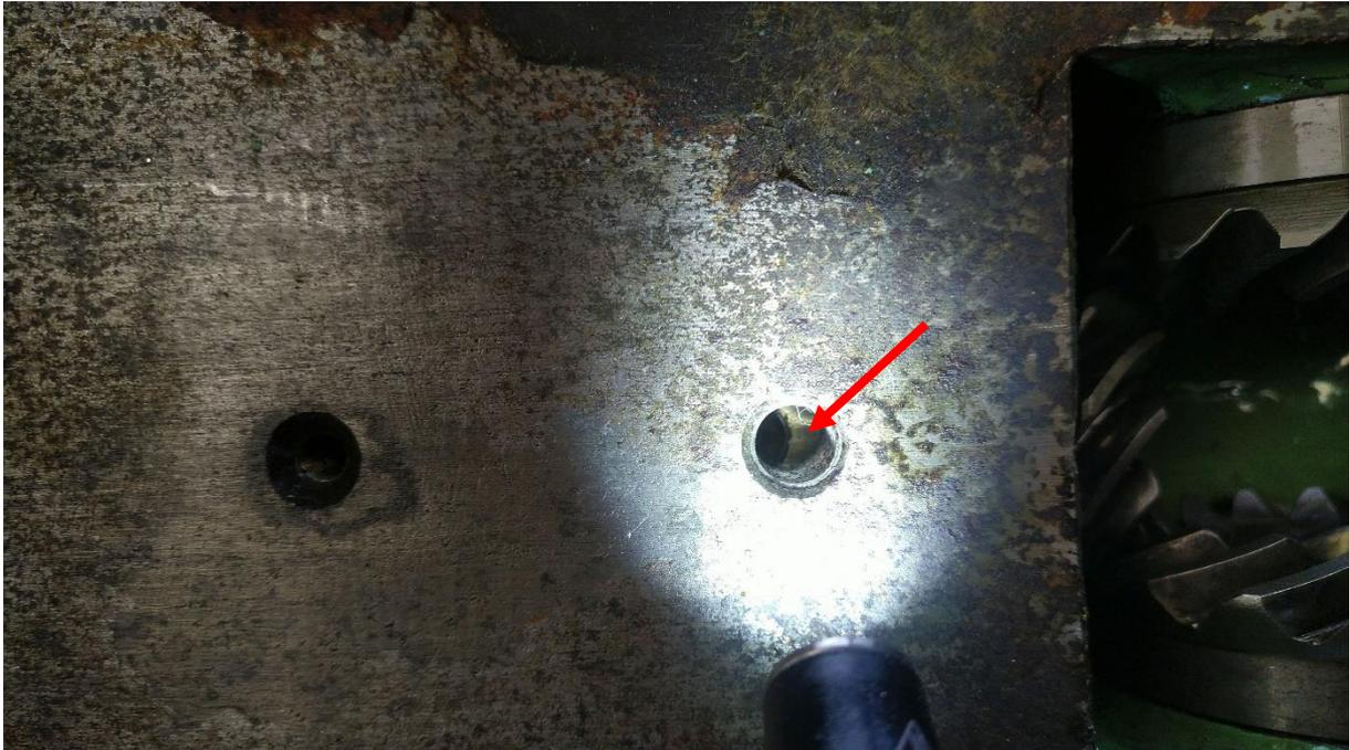
**Abbildung 180: die Buchse muss nur um die halbe Lochbreite seiner Halteschraube zurückgezogen werden, das reicht schon!**
