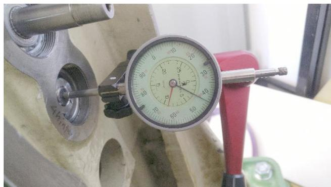
**Abbildung 112: Axialspielkontrolle mit Messuhr**
