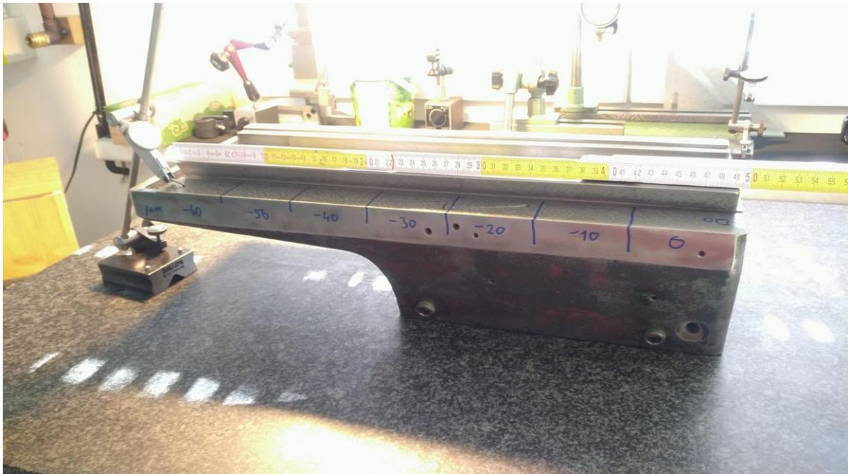
Abbildung 59: Vorbereitung zum Stufenschaben
