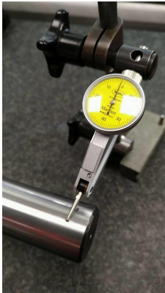
**Abbildung 62: es wird schon besser: nur noch  $20\mu\text{m}$ !**
