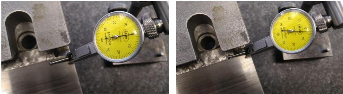
**Abbildung 206: die Abnutzung scheint maximal 30 $\mu$ m gewesen zu sein**
