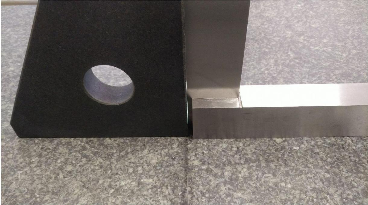
**Abbildung 239: Dieser Winkel allerdings ist Schrott: nicht nur die Messuhr, sondern auch der Lichtspalt verrät den schlechten Winkel (rechts)!**
