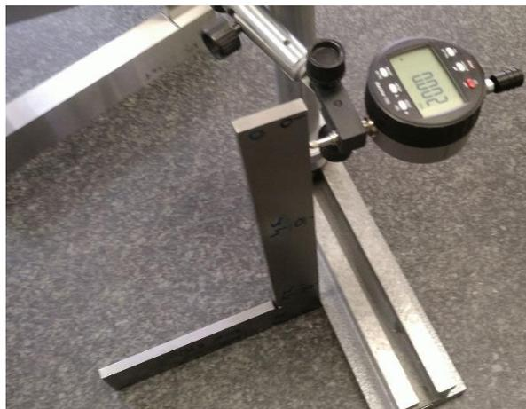
**Abbildung 240: einer der wenigen Winkel, die hinreichend genau für eine FP1-Vermessung zu sein scheinen!**
