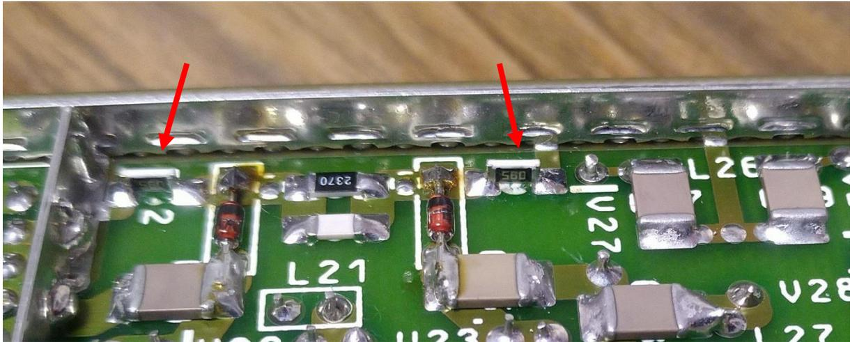
Abbildung 117: zwei erst einmal provisorisch eingelötete 56Ohm-Widerstände
