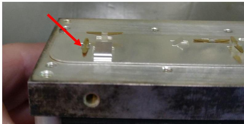
**Abbildung 153: die goldenen Brücken dürfen nur gerade so weit V-förmig gebogen werden, dass sie beim Schließen des Kontakts genug Vorspannung für eine ausreichende Federkraft erzeugen. Diese hier (Pfeil) hab ich schon fast zu stark hochgebogen!**
