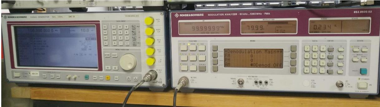
Abbildung 27: Einpegeln des Quellgenerators SME03 auf 80% Modulationsgrad
