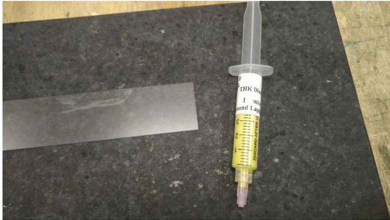
**Abbildung 186: Diamant-Läpppaste 1 $\mu$ m**
