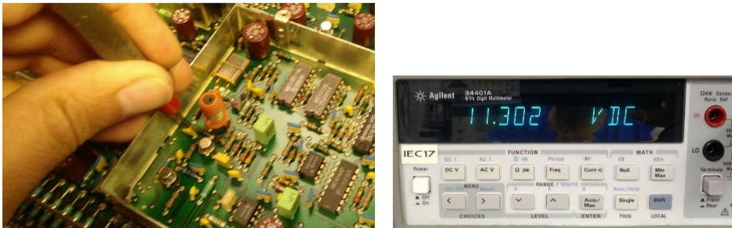
Abbildung 66: Messung der Abstimmspannung an L500
