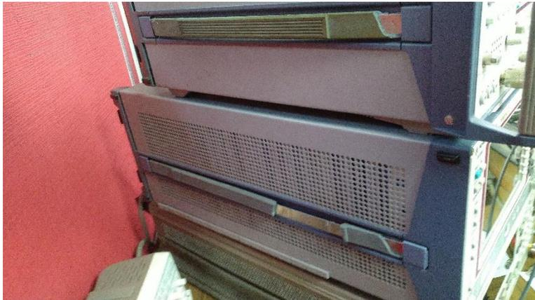
Abbildung 61: bekanntes Bild bei wohl allen R&S-Geräten dieser Generation: die Tragegriffe verlieren ihre Ummantelung! (bei HP gibt es das Problem auch: dann allerdings reißt der Griff- weil nicht immer eine Stahlseele eingelassen ist!!)
