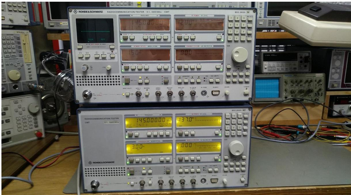
**Abbildung 241: Siegerfoto Maja und Willi! Über den LED-Umbau und die Farbwahl bei Willi kann man geschmacklich sicher geteilter Meinung sein. Aber spätestens mit diesem Foto wird sehr deutlich, wie sich die Ablesbarkeit der Displays gegenüber der Originalbeleuchtung verbessert hat!**
