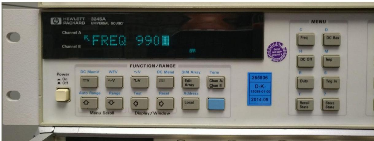
Abbildung 47: Signalquelle HP3245A
