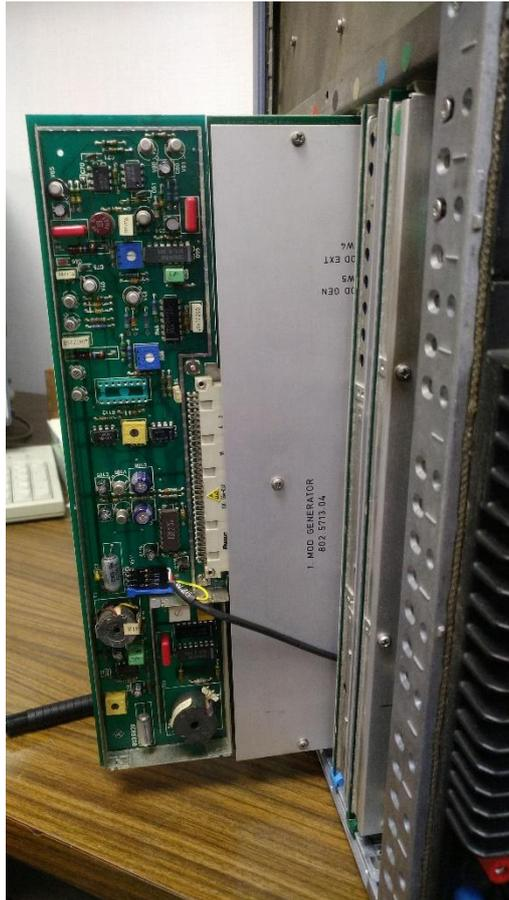
**Abbildung 63:** gut zu erkennen: der 1.Modulationsgenerator, darüber das optionale HF-Voltmeter. Gäbe es in Maja noch den 2.Modulationsgenerator, wäre der zwischen den beiden eingesteckt.
