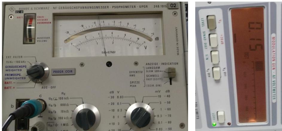
Abbildung 52: Noisefloormessung
