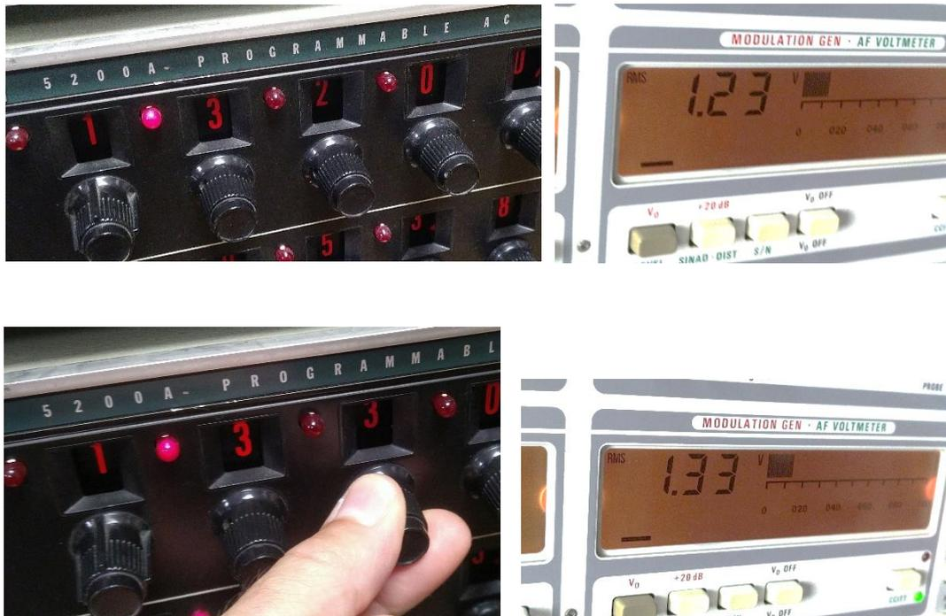
Abbildung 18: hier stimmt was nicht: mit nur 10mV mehr Amplitude gibt's gleich 100mV mehr Anzeige!
