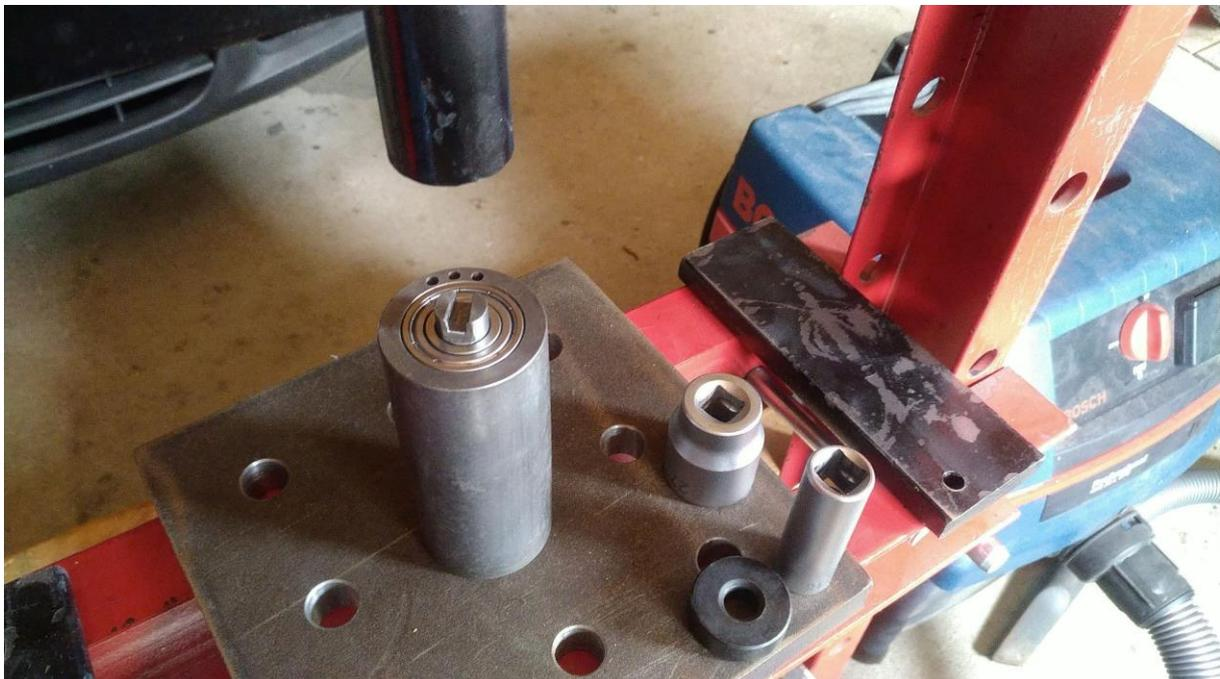
Abbildung 24: Einbau der Kugellager mit der Werkstattpresse
