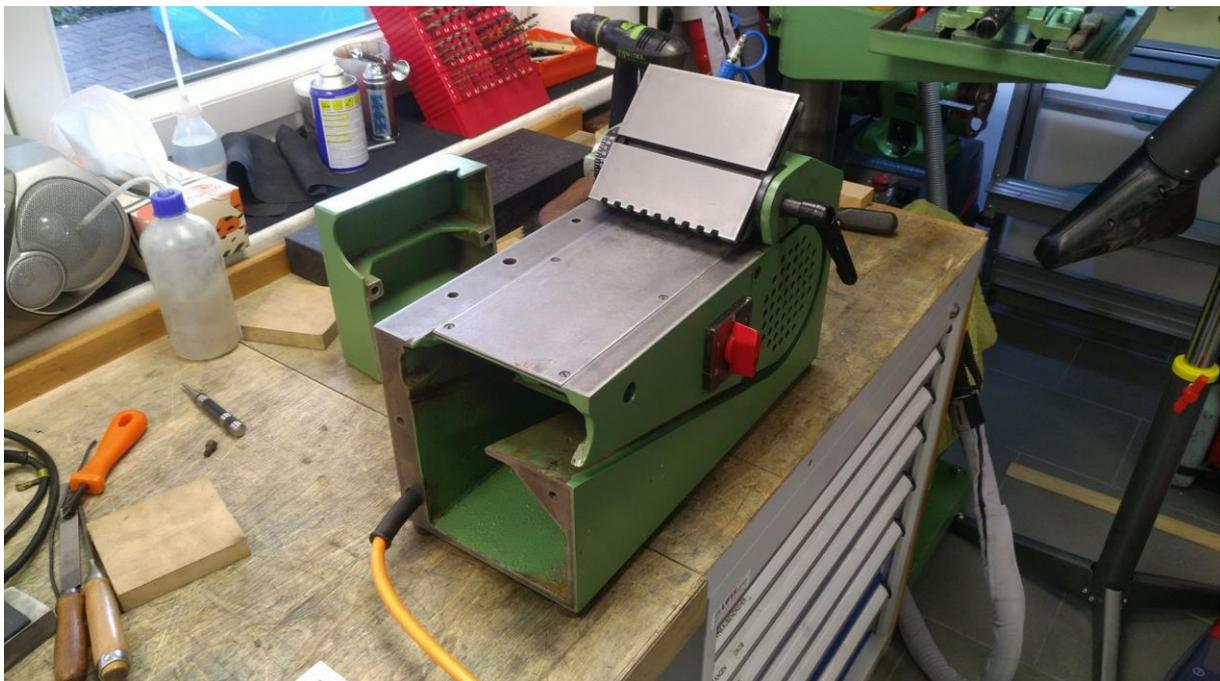
Abbildung 21: erster Probelauf - noch ohne Schleifband
