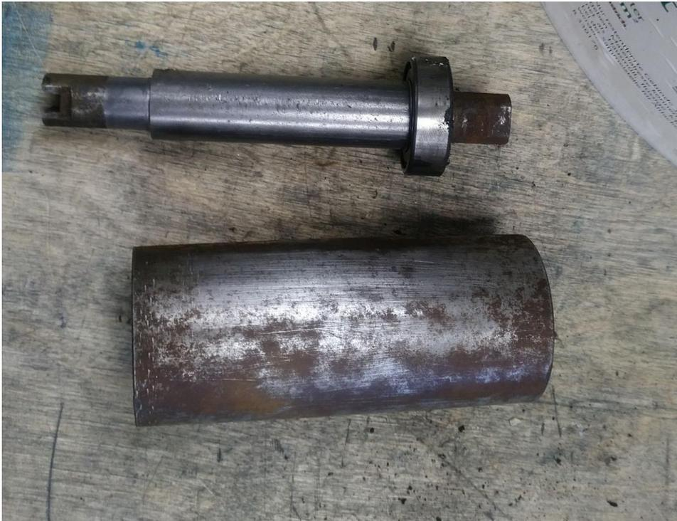
**Abbildung 14: Vorderwalze und Welle mit Lager 6202 (hier noch im Originalzustand)**
