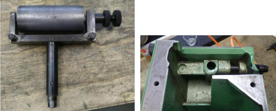
Abbildung 25: Einbau der neu gelagerten Vorderwalze
