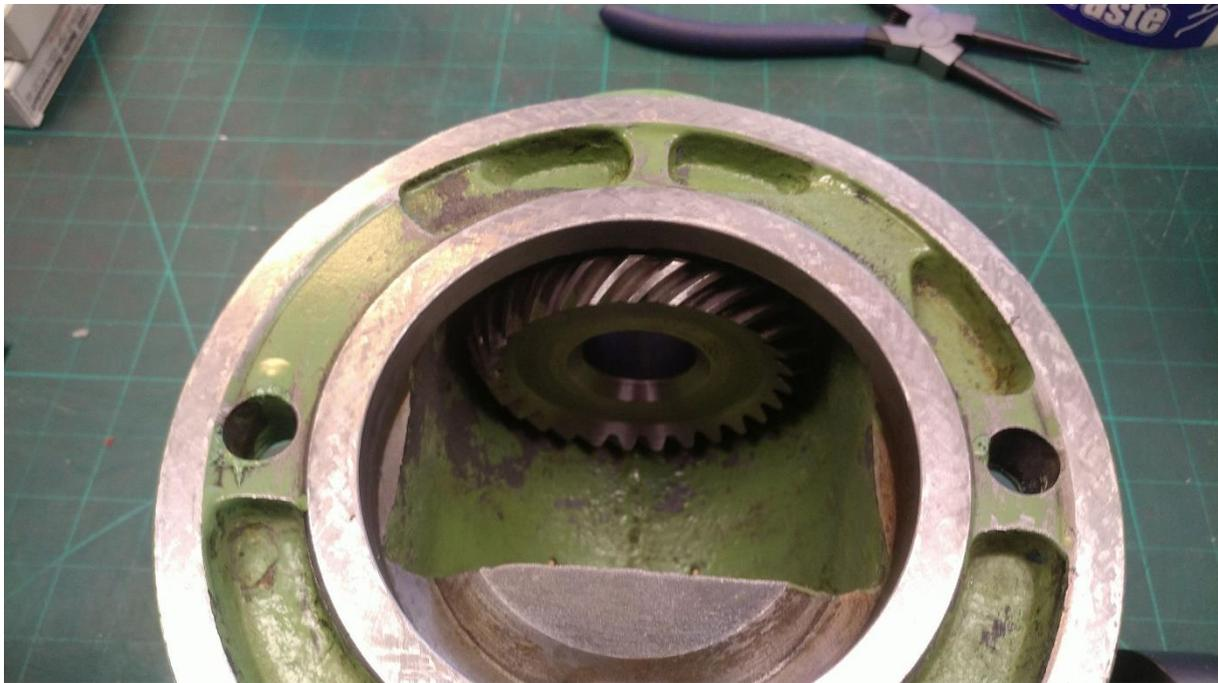
**Abbildung 123: die Kegelradeinheit ist montiert**
