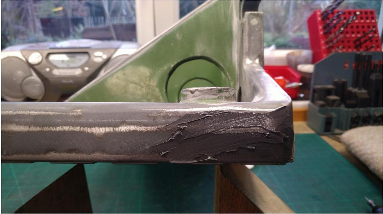
**Abbildung 14: JB Weld aufgestrichen**
