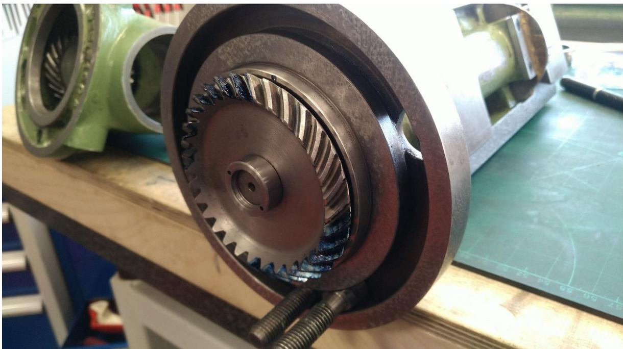
**Abbildung 132: Versuch des Tuschierens eines Kegelzahnrades ;-)**
