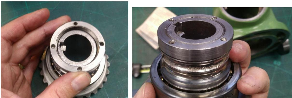
**Abbildung 115: die Stirnlochmutter wird aufgeschraubt und verklemmt die Bauteile nun zu einer Einheit. Bei genau diesem Arbeitsschritt hat mein Vorgänger leider das Spindellager beschädigt, weil beim Zusammenschrauben die Scheibe (Abbildung 113) dazwischen fehlte!**
