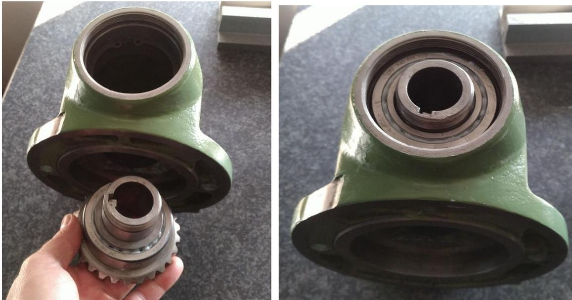
**Abbildung 152: Kegelradeinheit einbauen**
