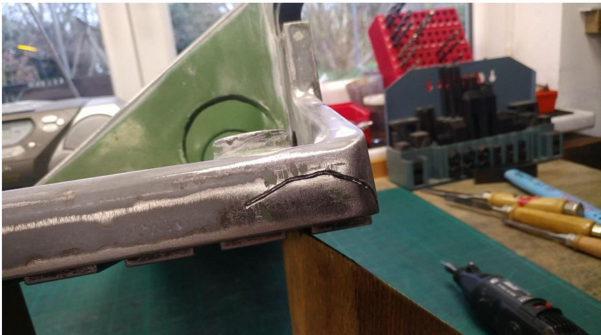
**Abbildung 12: wir schleifen/fräsen dem Riss hinterher**
