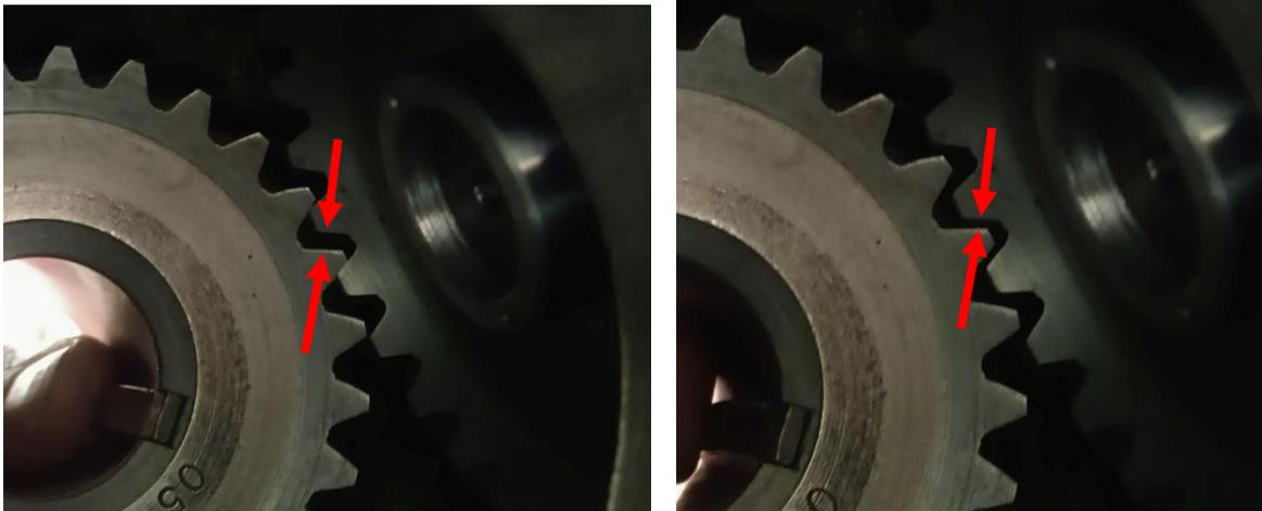
**Abbildung 126: deutlich stärkeres Flankenspiel mit der dünneren 3,65mm Unterlegscheibe! => die dickere war besser! (links: nach unten gedrückt; rechts: nach oben gedrückt)**
