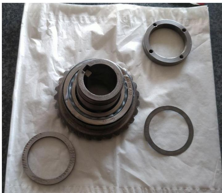
Abbildung 151: das erste K40-Lager wird montiert
