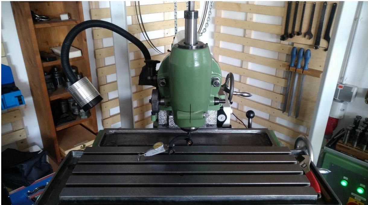
**Abbildung 163: Fräskopf parallel zur Tischfläche ausrichten**
