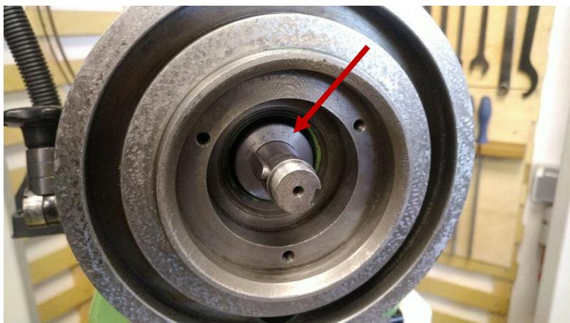
Abbildung 137: 4,7mm-Scheibe (Pfeil). Hier bereits montiert: die Passfeder
