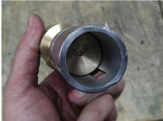
**Abbildung 61: die neue Lagerbronze wird eingesetzt**
