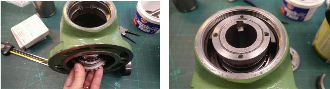
**Abbildung 120: die Kegelradeinheit einführen und hochschieben (im linken Bild fehlt noch der halbe Lagerring)**
