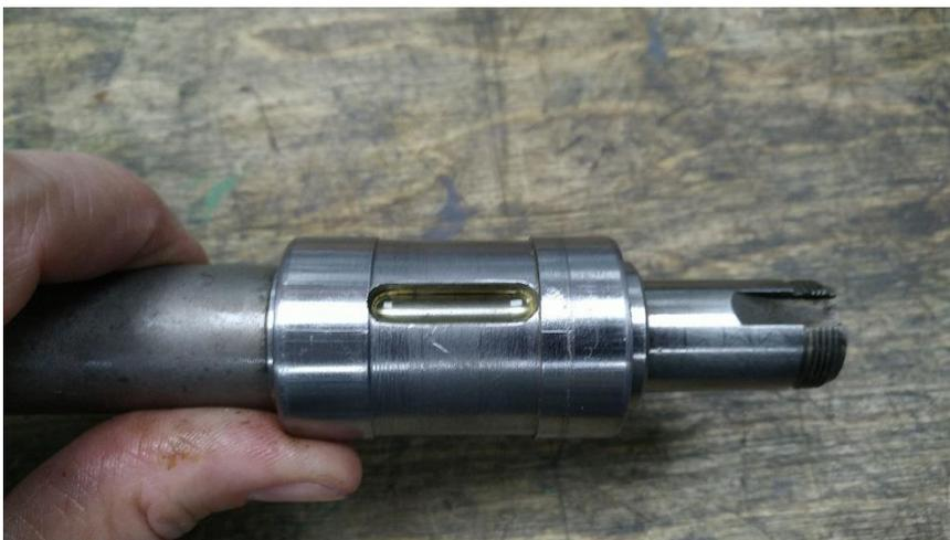
**Abbildung 75: wir probieren das Lager von Hand mal aus**
