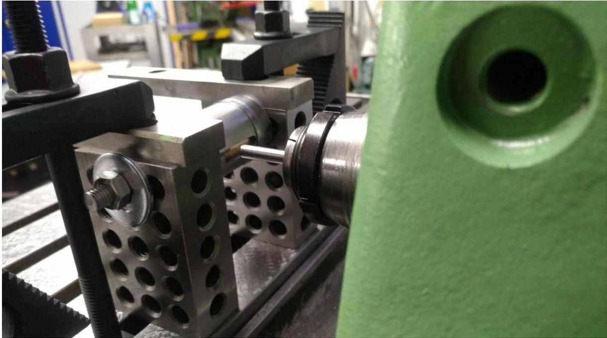
**Abbildung 72: eine eingespannte 6mm-Welle benutze ich zum Anpeilen der Schmiernut**
