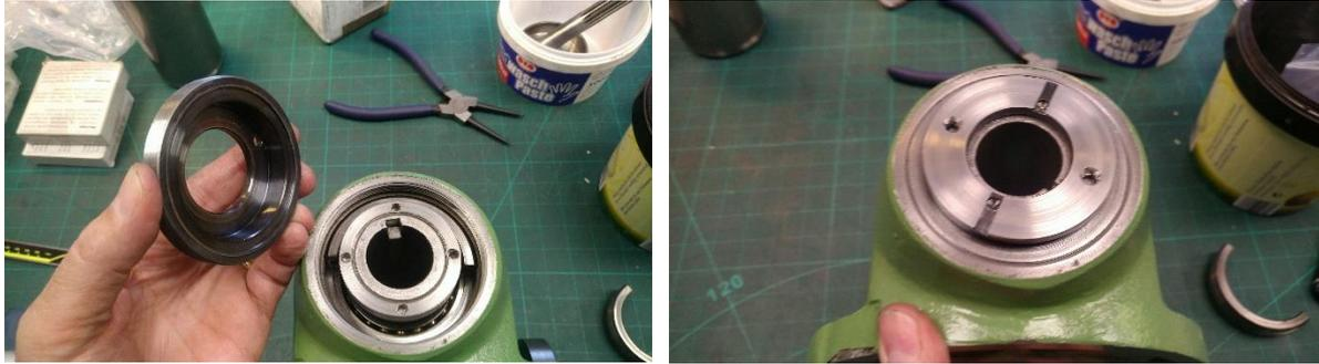
**Abbildung 122: die Deckelkappe kommt drauf**
