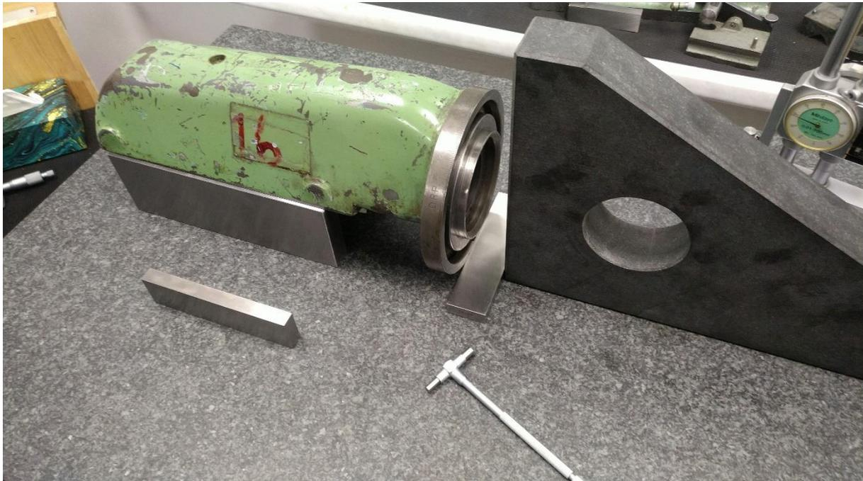
**Abbildung 24:** ein weiterer Versuch, die Geometrie des Flansches zu ergründen. Es geht so zwar "irgendwie", aber nicht wirklich gut und auch nicht sehr präzise. Wir werden bessere Ansätze finden!
