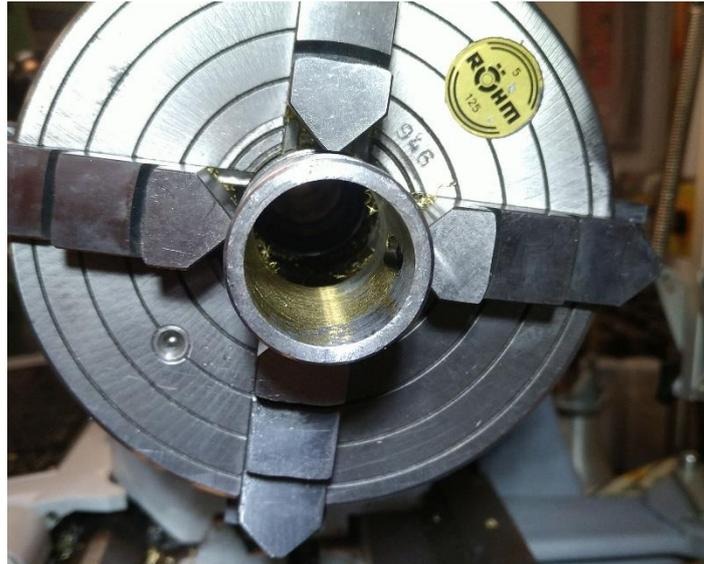
Abbildung 56: anhand der ziemlich gleichmäßig verteilten Bronze-Rückstände bin ich sehr zuversichtlich, dass die von mir eingestellte Drehachse ziemlich gut im Hülsenzentrum liegt!
