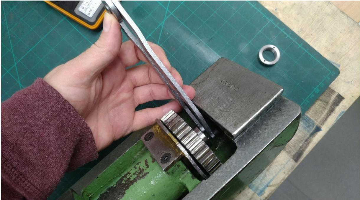
Abbildung 91: Mit Stirnlochschlüssel anziehen
