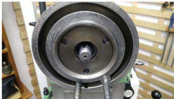
Abbildung 101: Tellerscheibe montiert
