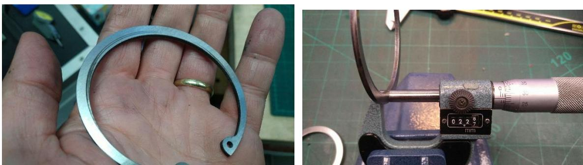
**Abbildung 117: es wird nach dem Schleifen besser, aber leider wird das Bauteil dadurch natürlich auch dünner!**
