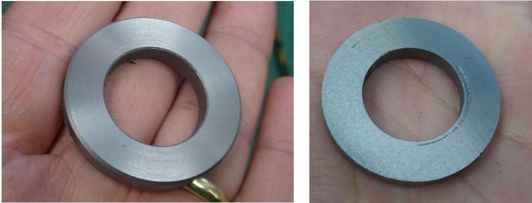
Abbildung 96: Vorderseite (gedreht) und Rückseite (geschliffen)
