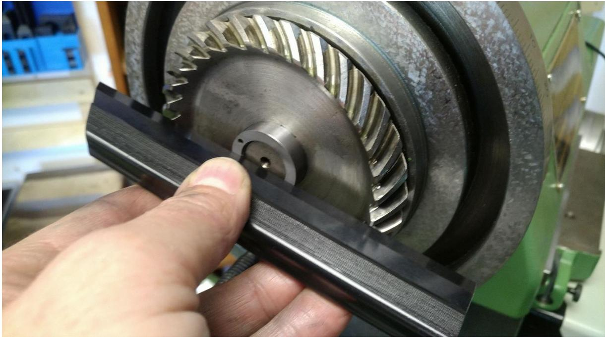
**Abbildung 161: Überprüfung mit dem Haarlineal: nein, jetzt steht nichts mehr vor!**
