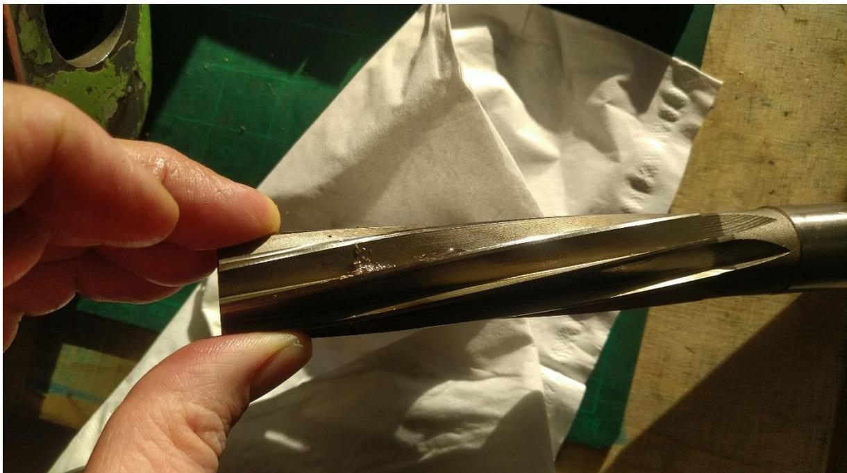
**Abbildung 89: man sieht, dass die Reibahle leichte Späne abnimmt**
