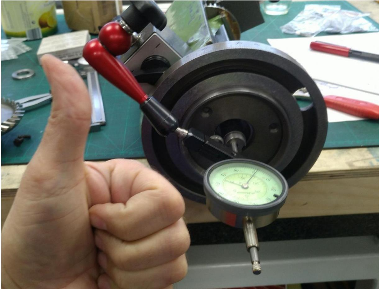
**Abbildung 130: jetzt schlackert da so gut wie nichts mehr- zumindest axial!**
