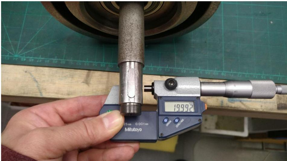
**Abbildung 94: der Innendurchmesser der benötigten Scheibe lässt sich schnell herausfinden- nur wie ist es mit seiner Dicke?**
