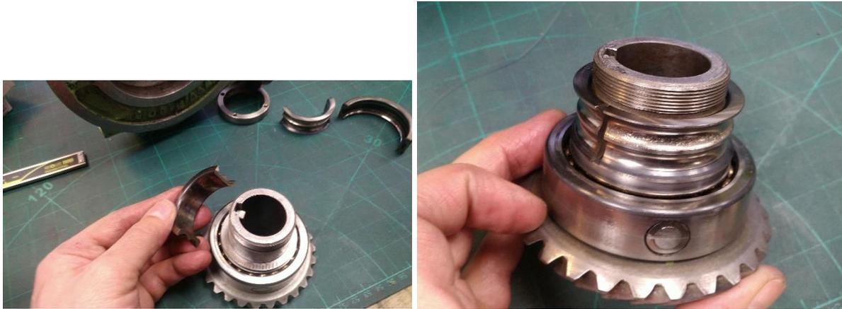
**Abbildung 114: das zweite K40-Lager wird "symbolisch" in Teilen aufgelegt**
