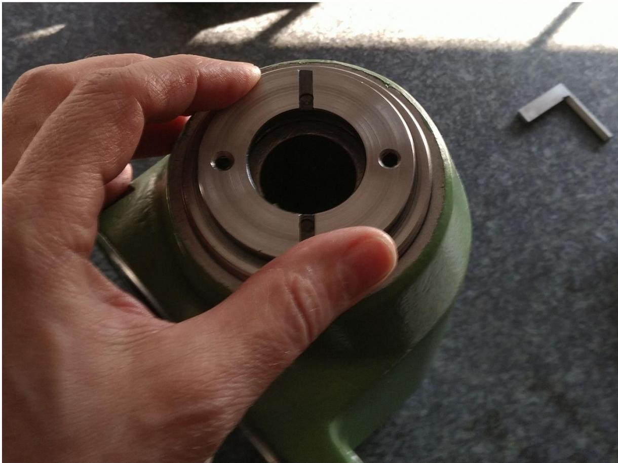
**Abbildung 154: erst mit Aufschrauben der Stirnlochmutter wird die Lage der Kegelradeinheit im Innern vertikal fixiert**
