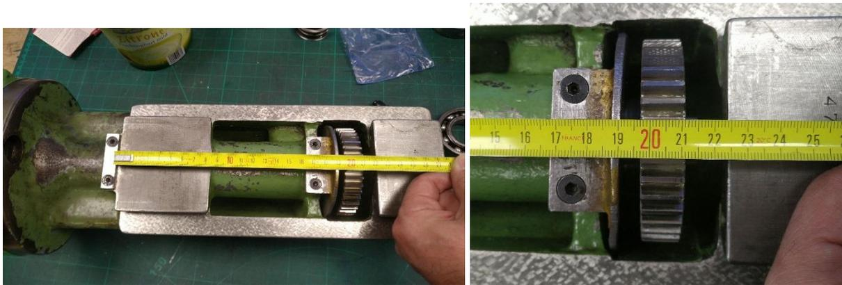
Abbildung 145: und Lage am Vertikalausleger. Das passt gut zusammen, die Zahnräder werden gut ineinander greifen!
