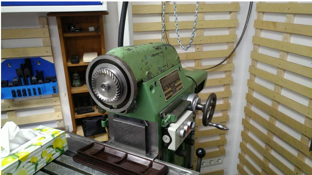
**Abbildung 104: der Vertikal-Ausleger ist vorbereitet**
