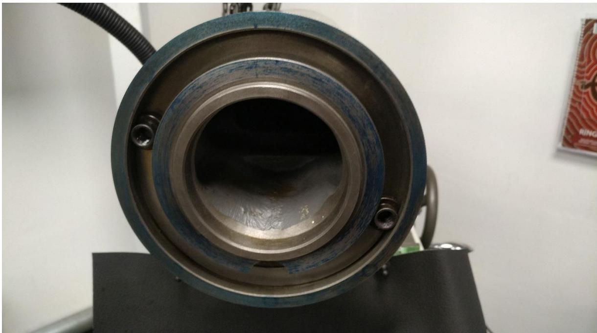
**Abbildung 41: Flanschfläche des Schnellläufers: deutlich besser! Hier kippelt ja auch nichts!**
