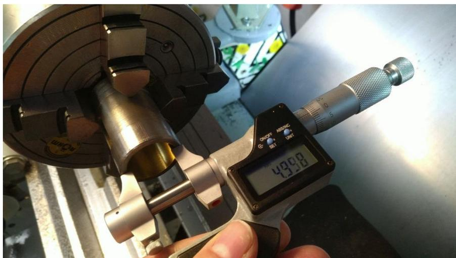
**Abbildung 55: nun zahlt sich der ganze Aufwand für das Aufarbeiten meiner Leinen MLZ4S Drehmaschine aus: sogar ich als Anfänger treffe damit nun Zielmaße in erstaunlicher Präzision und Wiederholbarkeit!**
