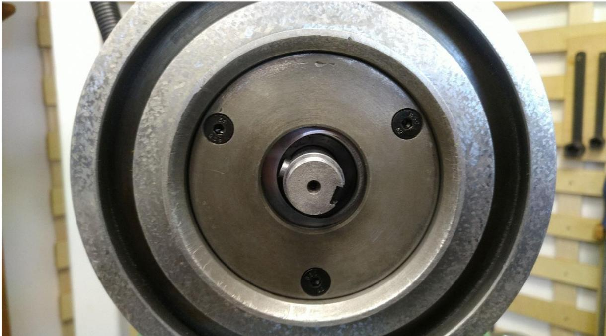
**Abbildung 141: so sieht das dann aus. Die mit Öl "festgeklebte" Passscheibe schieben wir nachher noch mit einem Holzstäbchen mittig hin, damit am Ende das Kegelrad draufgesteckt werden kann**
