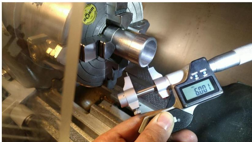
Abbildung 57: ich spindele die Lagerhülse auf genau 26mm Innendurchmesser aus
