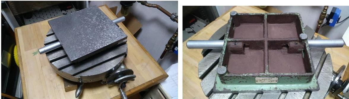
**Abbildung 33: eine Massi Tuschierplatte aus Grauguss**
