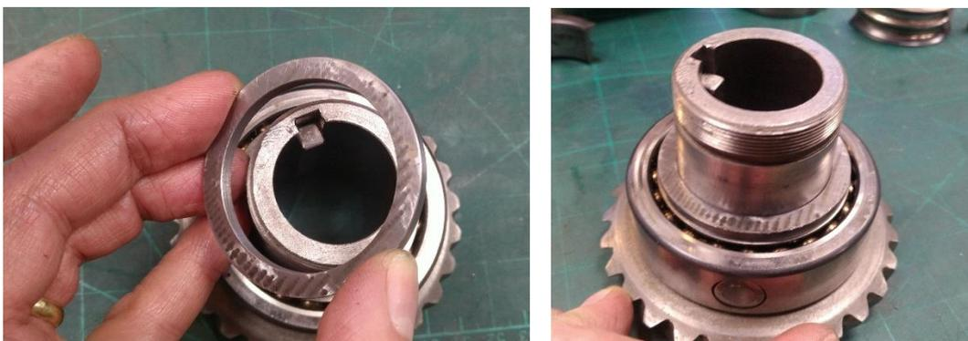
Abbildung 113: die selbstgedrehte 5,00mm-Scheibe kommt drauf
