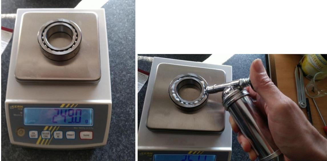
Abbildung 148: Einbringen des Lagerfetts
