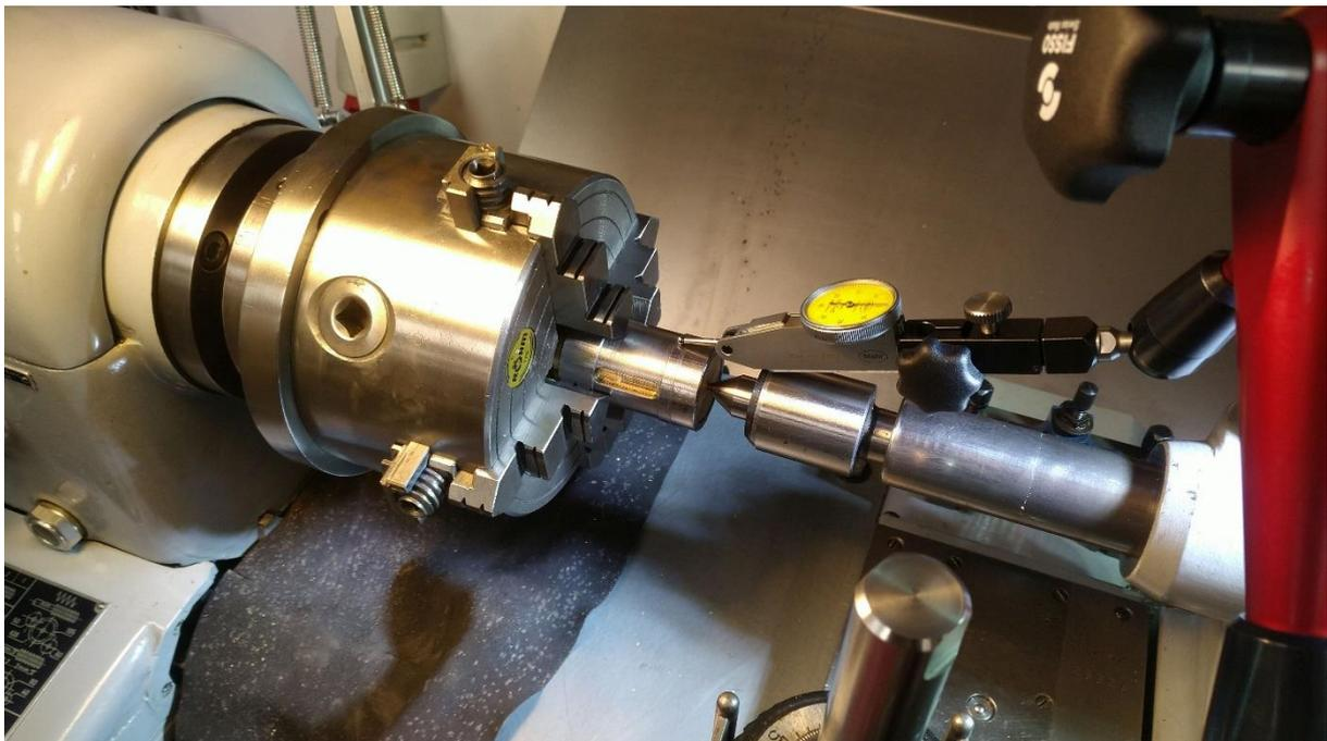
**Abbildung 64: die Hülse erneut ausrichten**
