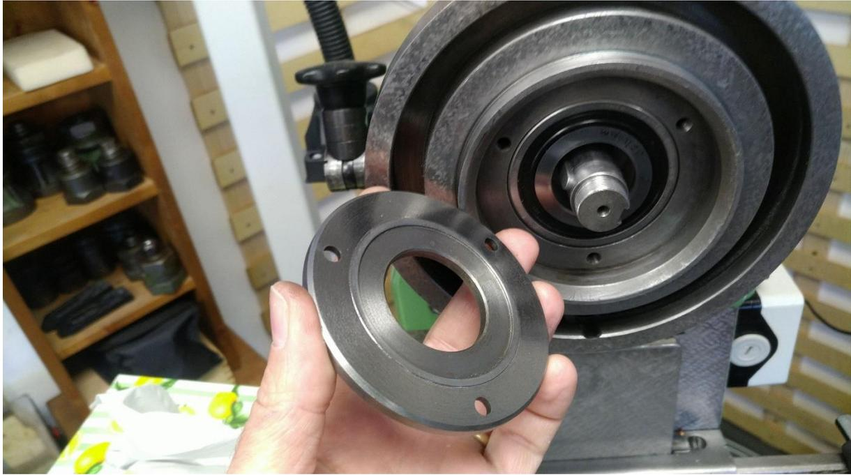
**Abbildung 140: Aufsetzen der Deckelplatte**
