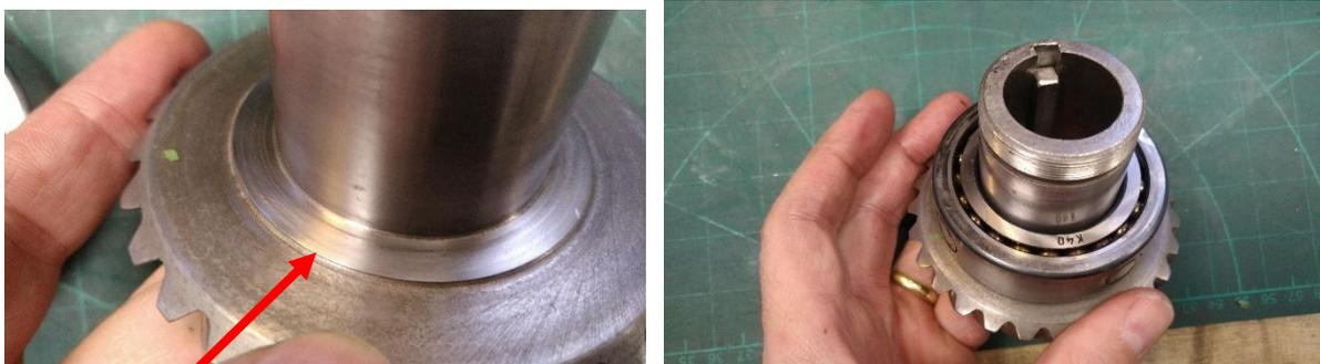
Abbildung 112: Kegelrad mit dem ersten K40-Lager
