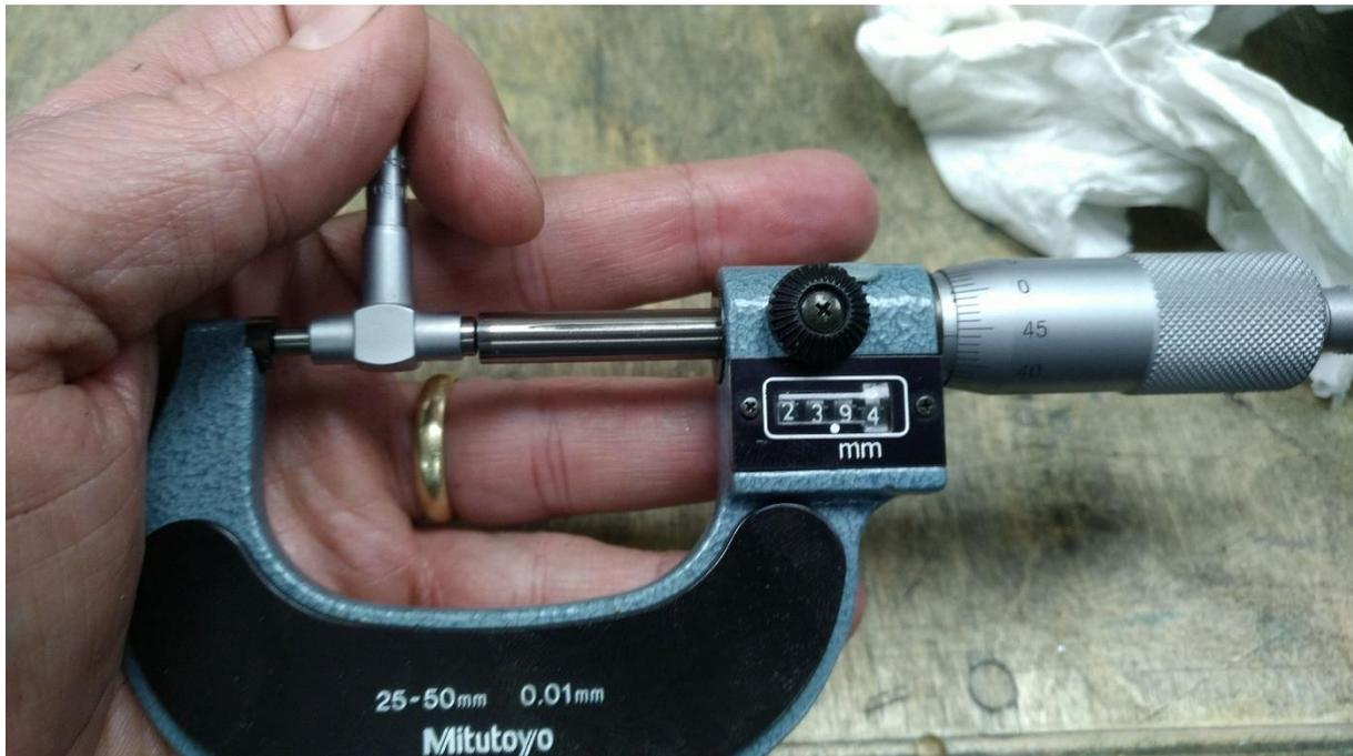
Abbildung 83: Der Innendurchmesser ist um 60µm verkleinert worden!
