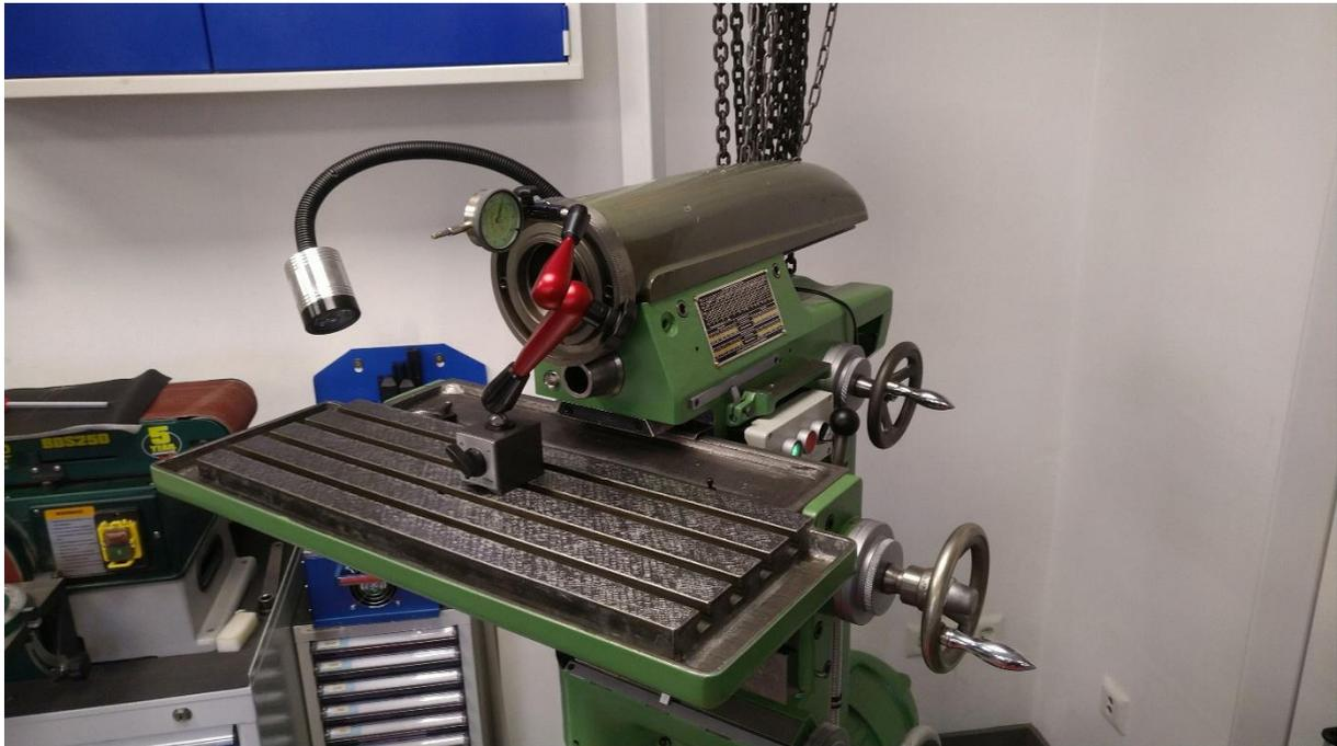
**Abbildung 25: Mit dieser Methode wird die Messung schon deutlich genauer- und ist auch praxisgerechter, denn ich benutze die originalen Führungen der Maschine zum Abfahren. Nun noch den roten Arm durch einen robusten, starren Messuhrhalter ersetzen, und die Messung klappt!**
