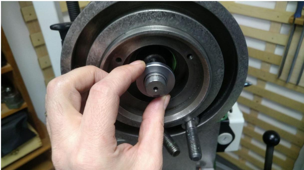
**Abbildung 99: die Unterlegscheibe aufstecken**
