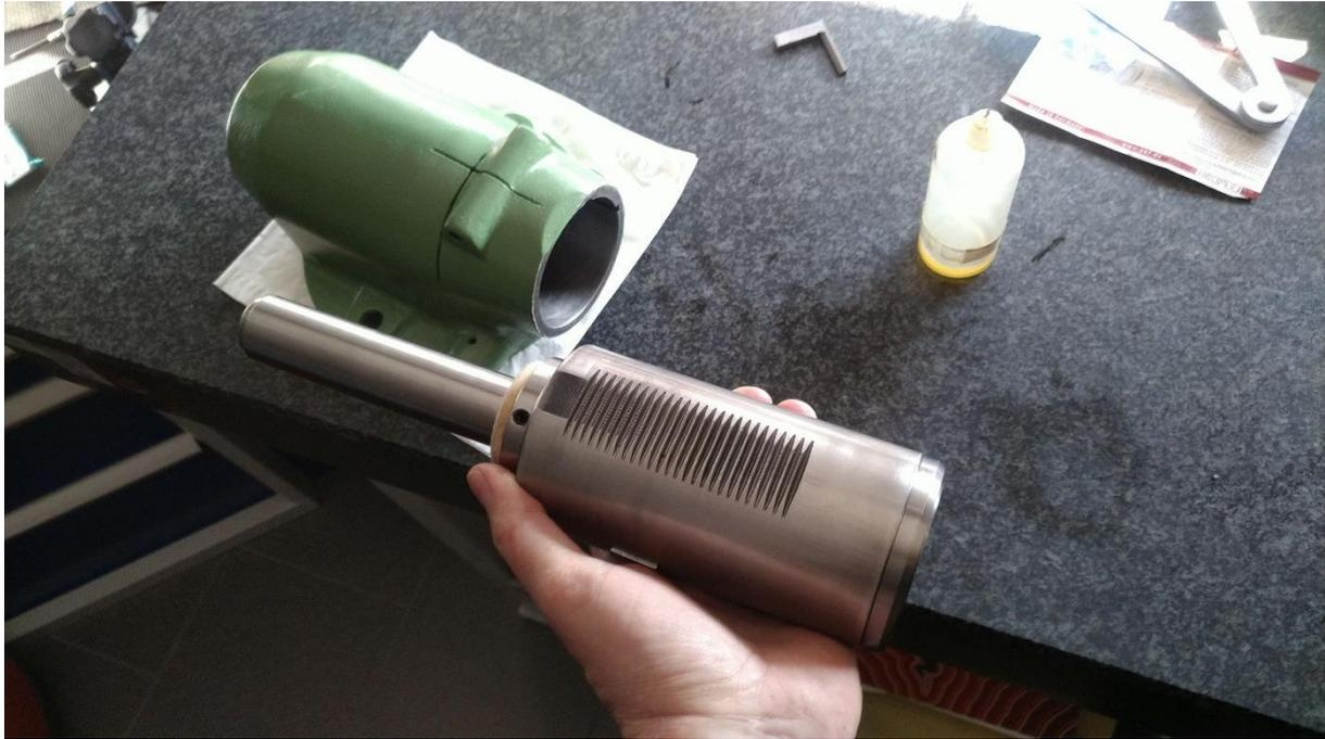
Abbildung 155: Spindelbüchse einsetzen
