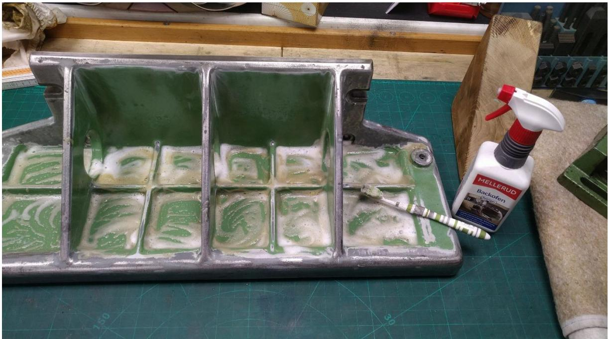
**Abbildung 15: Unterseite säubern - Schutzbrille und Einmalhandschuhe tragen!**
