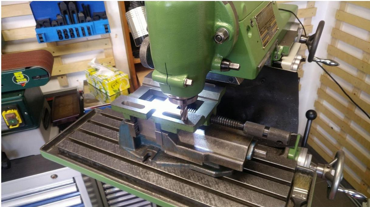
**Abbildung 165: und schon der erste Einsatz: die Langlöcher meines Bohrschraubstocks warten schon ewig auf eine geometrisch korrekte und saubere Ausfräsung**
