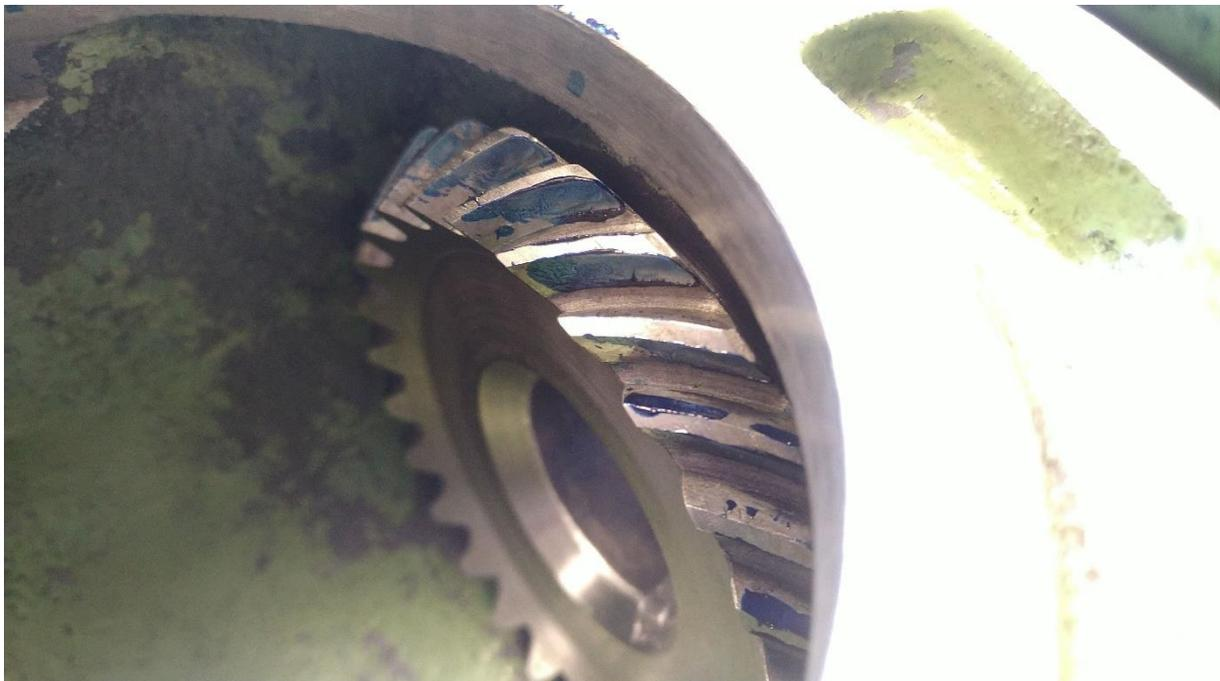
**Abbildung 133: so hat das Kegelrad der Singer-Welle die Tuschiefarbe auf seinen Kontaktpartner übertragen**
