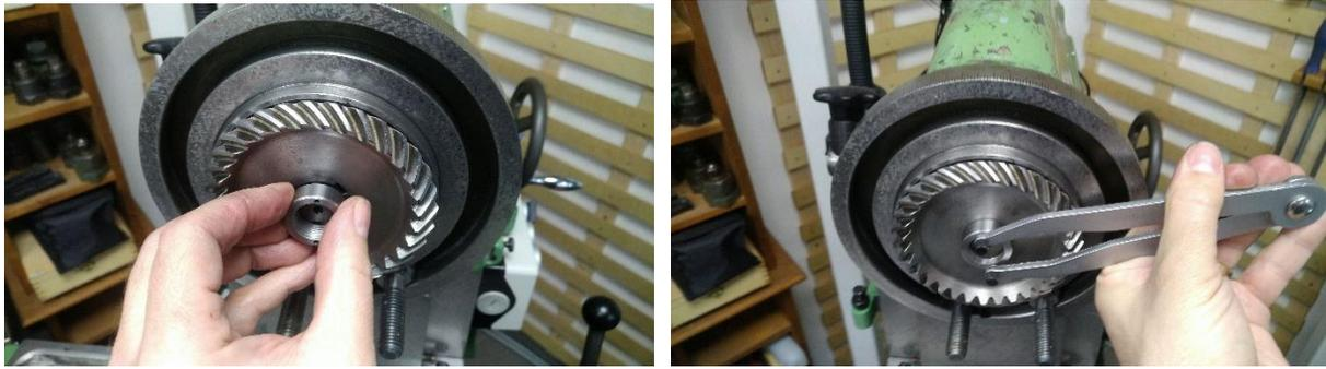
**Abbildung 103: Stirnlochmutter anschrauben**
