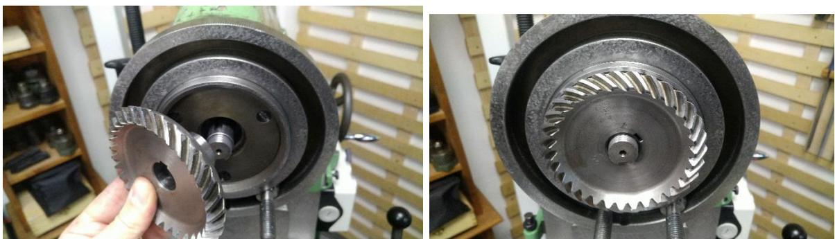
Abbildung 102: Kegelrad aufstecken
