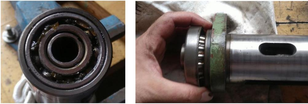
**Abbildung 58: Spindel aus der Pinole klopfen**
