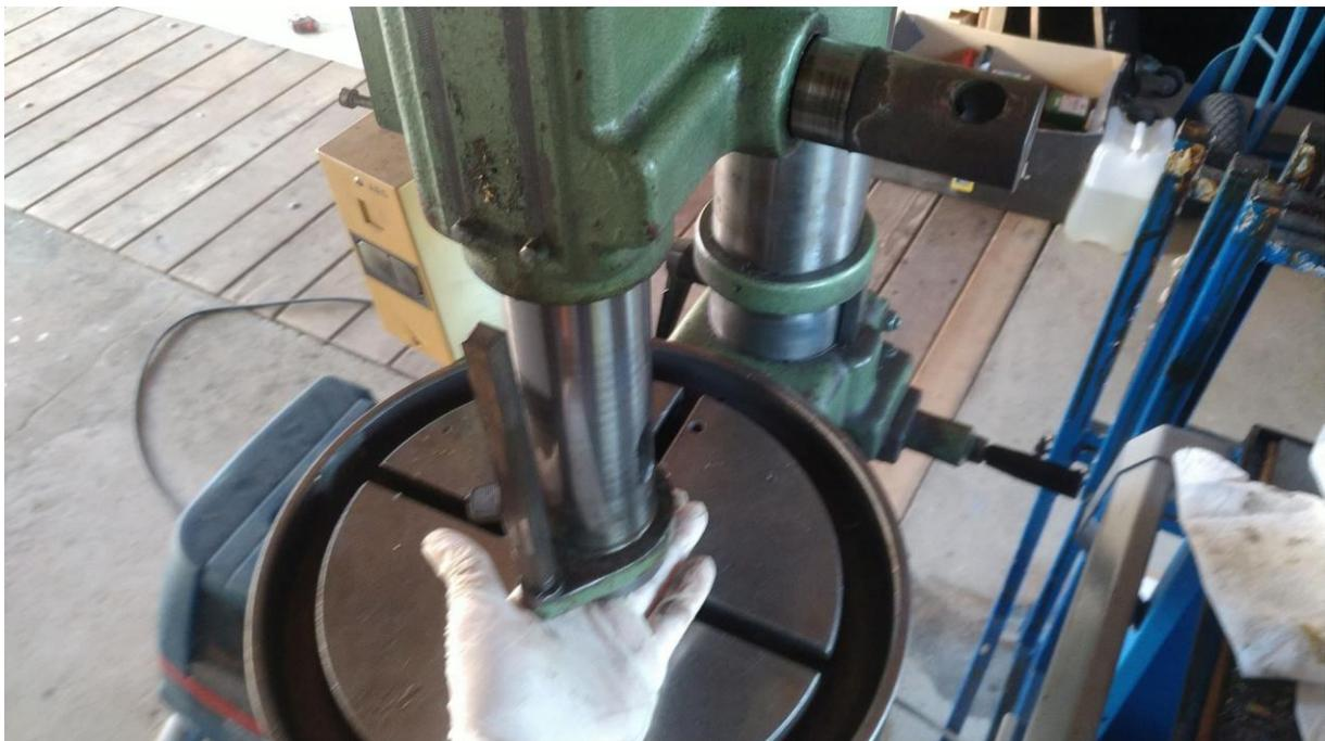
**Abbildung 34: Pinolenantrieb (Zahnwelle) leicht nach rechts herausziehen- dann gleitet die Pinole sanft nach unten und kann herausgenommen werden**
