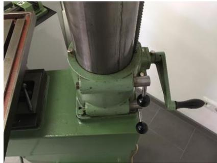
**Abbildung 5: Höhenverstellung beim U-Modell: Kopf und(!) Säule müssen aus dem Unterstand hochgekurbelt werden. Das ist zwar robust, aber kostet Kraft!**
