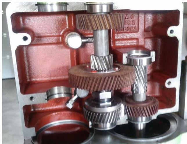
**Abbildung 80: Zwischenwelle provisorisch eingebaut**
