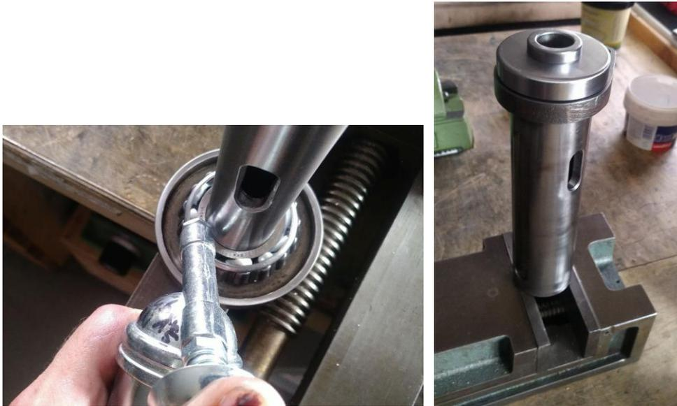
**Abbildung 90: Fetten und Probe-Zusammenbau**
