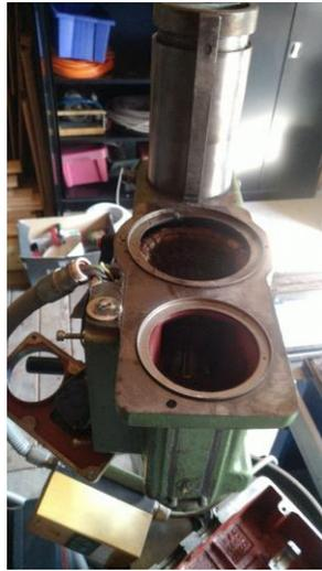
**Abbildung 42: Getriebekopf abgebaut**
