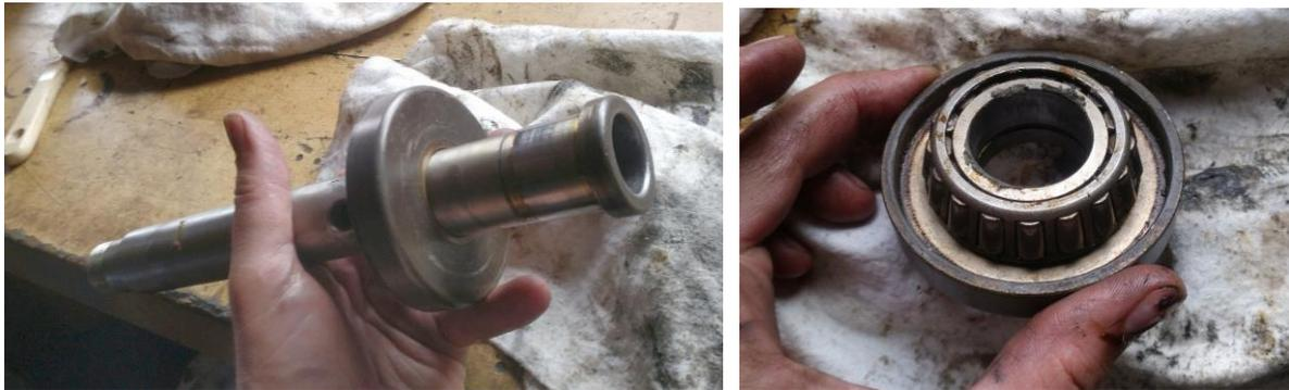
**Abbildung 61: Pinole mit abgedrücktem Pinolenschild; rechts das abgedrückte Teil**
