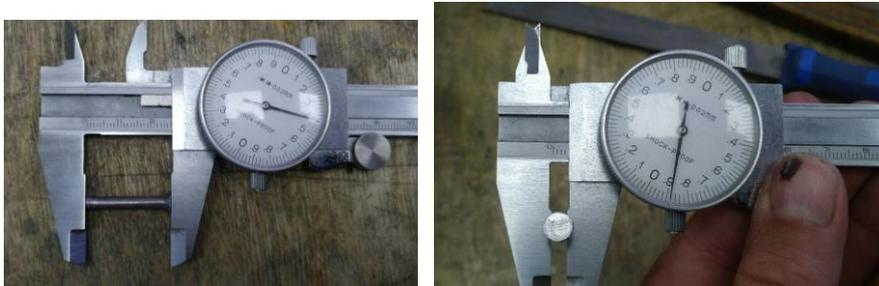
**Abbildung 51: Abmessungen aufnehmen**
