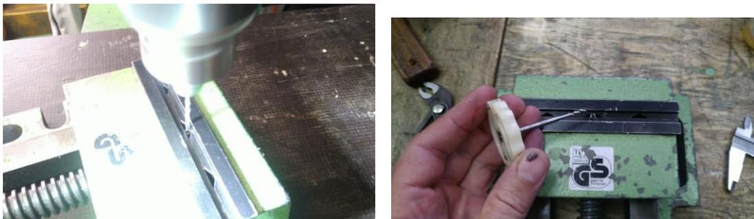
**Abbildung 52: Loch bohren und Gewinde bohren**
