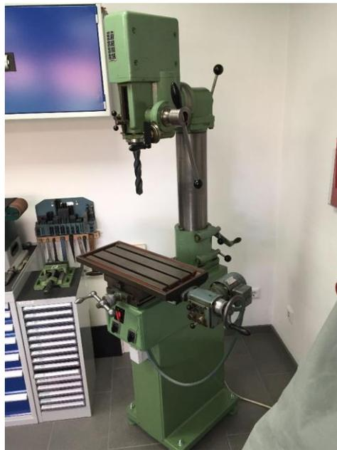
**Abbildung 4: Nachteil der U-Variante: um den Kopf so weit hochzukurbeln, braucht man schon eine Menge Kraft an der Kurbel hinter der Maschine- das ist zum Bohren leider sehr umständlich!**
