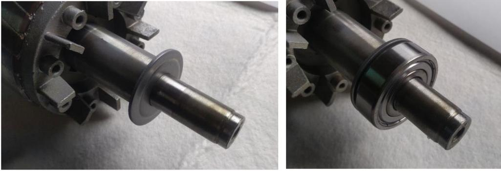
**Abbildung 67:** links: die "gedellte Scheibe" 4F06203; rechts: Lager aufgespresst
