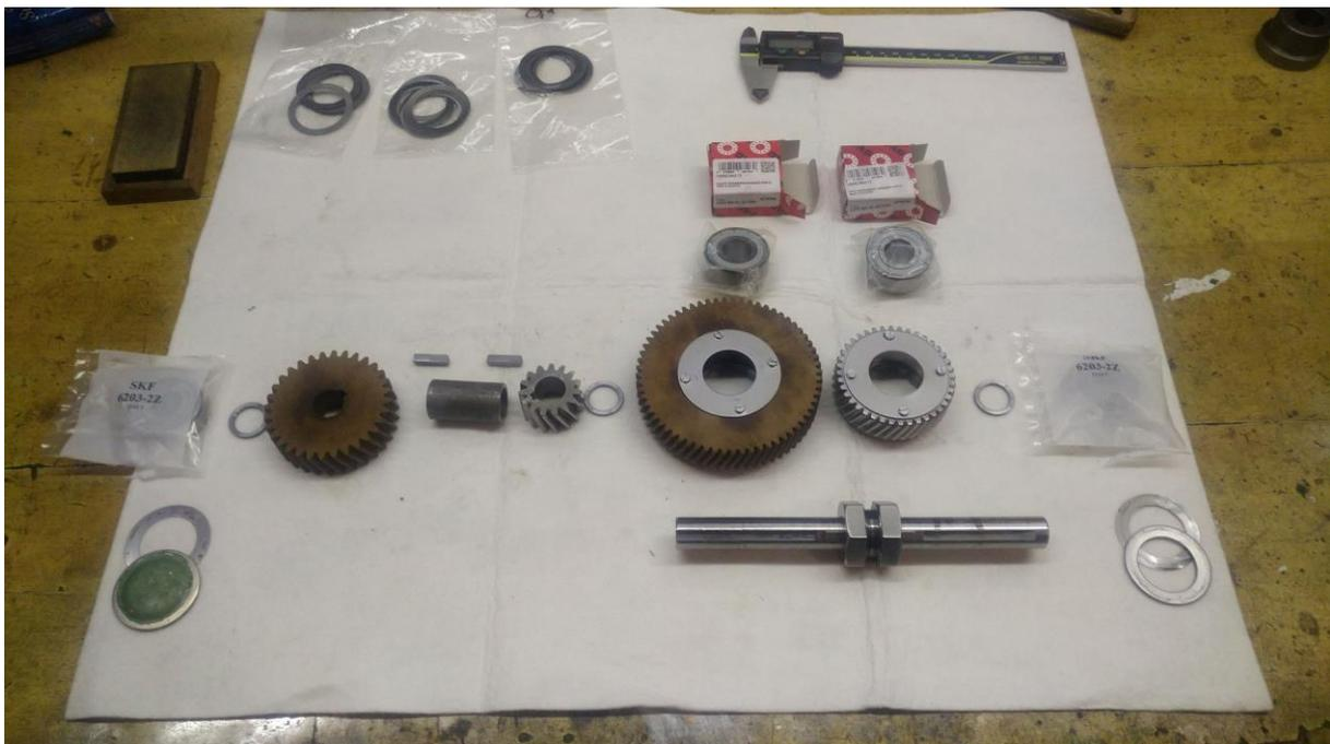
Abbildung 75: Elemente der Zwischenwelle
