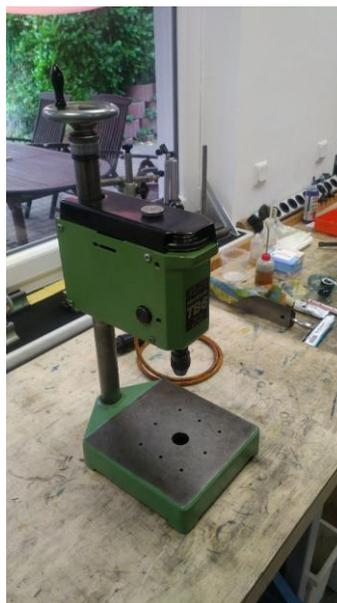
**Abbildung 12:** die Genko TB6 ist eine sehr schön schnell drehende Präzisionsbohrmaschine, mit der man sogar 0,3mm Löcher bohren kann! ( $U_{max}=20\ 000U/min!$ )
