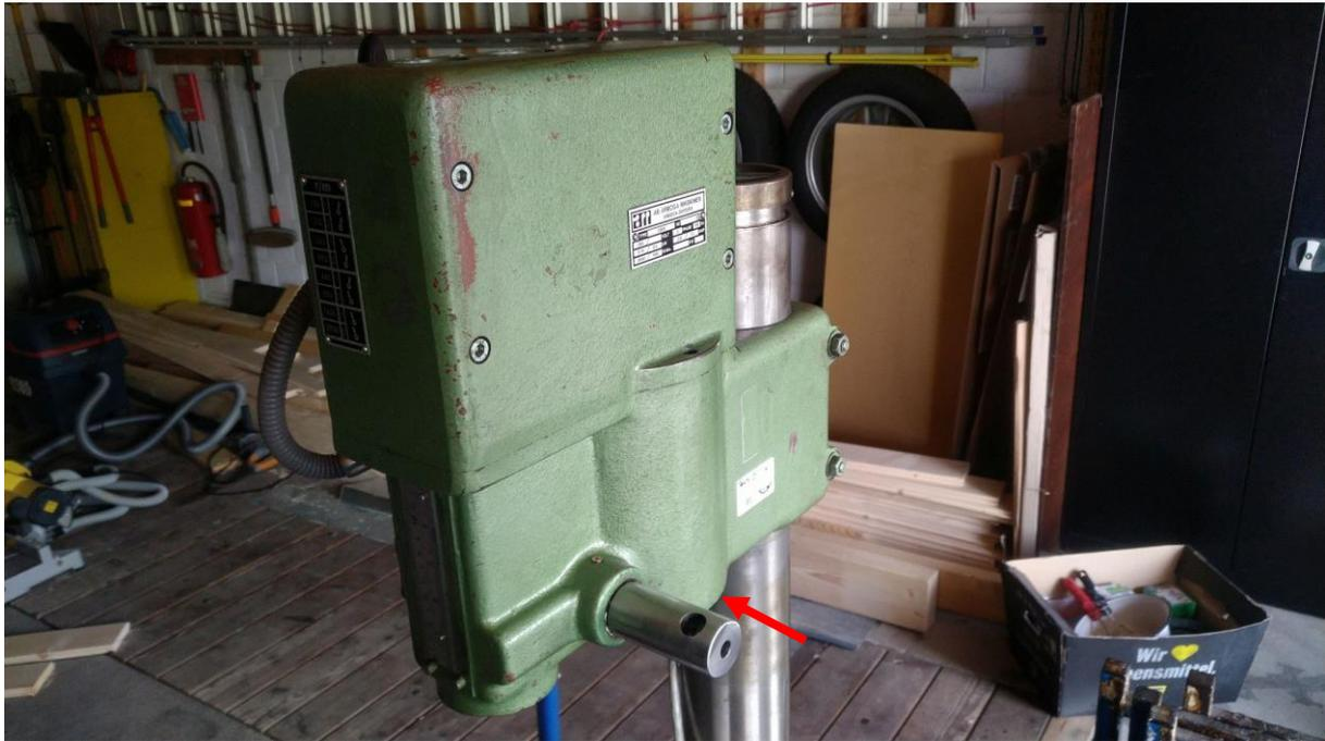
**Abbildung 108: Getriebekopf aufsetzen**
