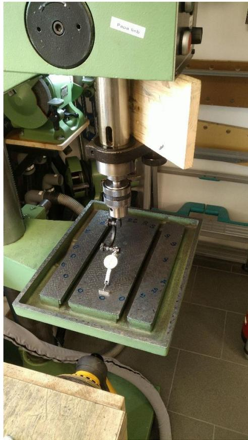
**Abbildung 10: hoffnungslos übertrieben: eingeschabter Tisch und Überprüfung der Rechtwinkeligkeit bei meiner Flott M3 Bohrmaschine!**
