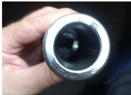
Abbildung 7: Blick in die ausgebaute Spindel: eine G2508 hat typischerweise einen MK3-Morsekonus
