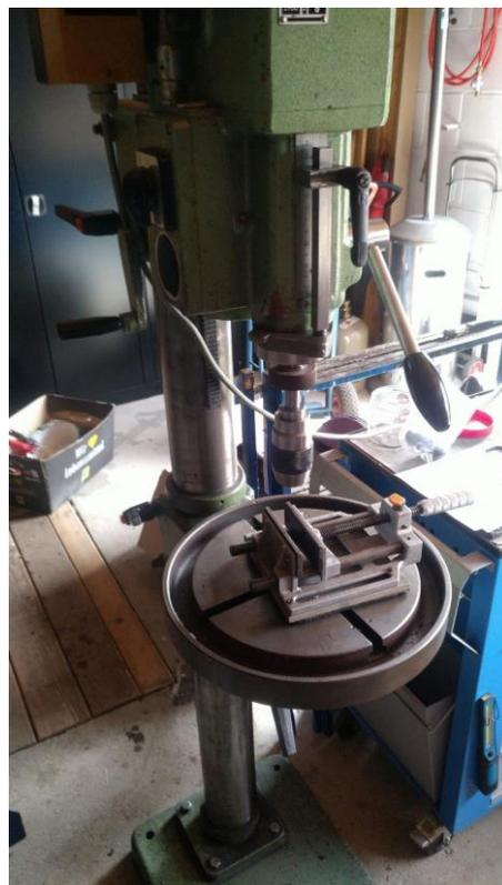
**Abbildung 112: Pinole wird sauber hochgezogen, die Federspannung stimmt**
