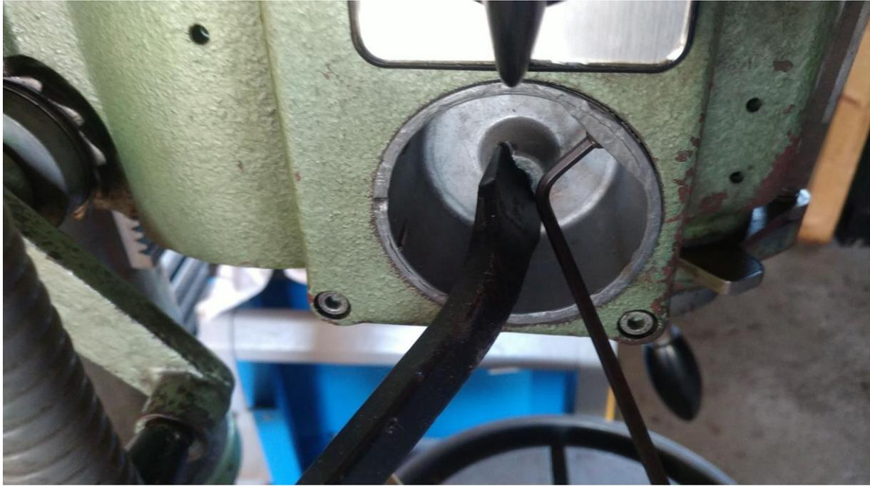
**Abbildung 33: Ausbau der Pinolenfeder- einfacher als gedacht!**
