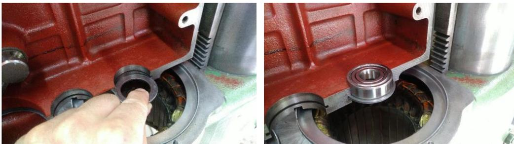
**Abbildung 68:** links: die Unterlegscheibe; rechts: das darauf abgestützte Lager
