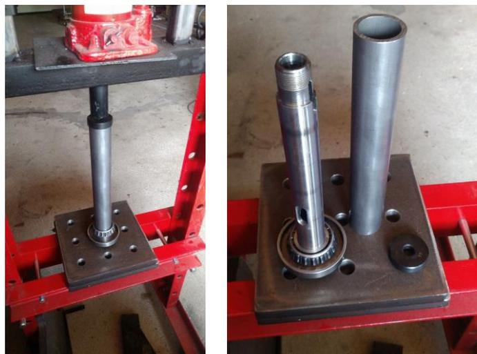
Abbildung 87: das Rohr als Hilfe zum Aufpressen des Spindellagers
