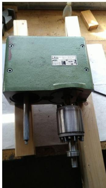
Abbildung 107: Deckel aufsetzen und nur locker festziehen
