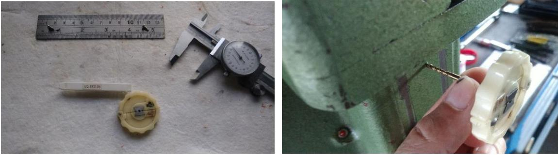
**Abbildung 96: Skala vorbereiten und M2,5-Gewinde bohren**
