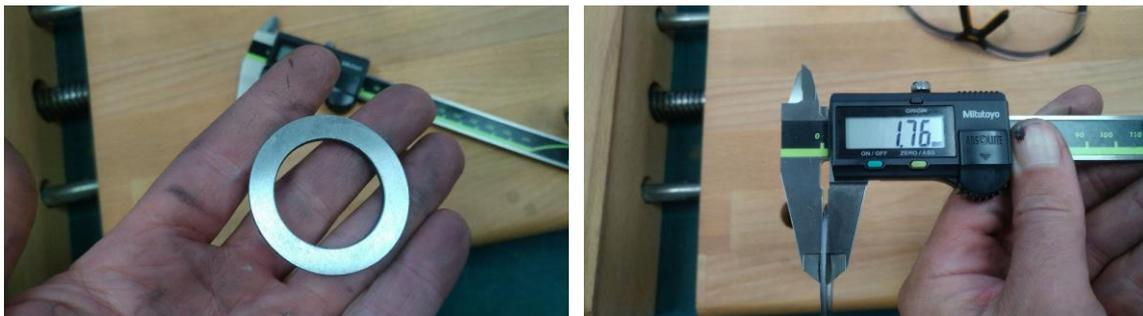
**Abbildung 72: Dünnerschleifen der Scheibe**
