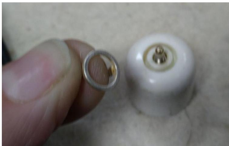
**Abbildung 63:** doppelte Kontaktierung: entweder über den Mittelpin (via 50pF) oder über den Außenring (=direkte Verbindung)
