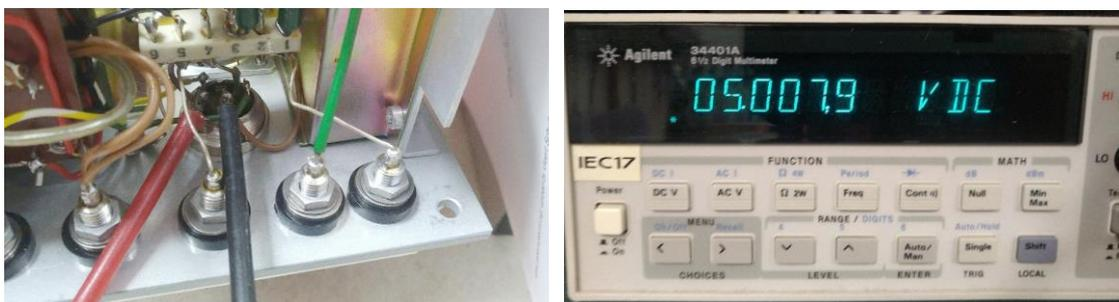
Abbildung 61: Prüfen der 5V Heizspannung für den URU-Tastkopf
