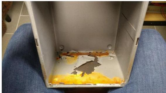
**Abbildung 2: exzellente Verpackung (sogar mit selbst gebasteltem Holzrahmen als Schutz!)- nur leider hält das den Rost im Gehäuse auch nicht auf :-)**
