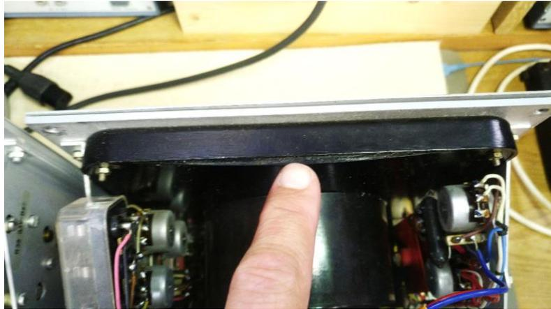
**Abbildung 3: leicht verzogenes Gehäuse des Messinstruments beim "gekauften URU"**
