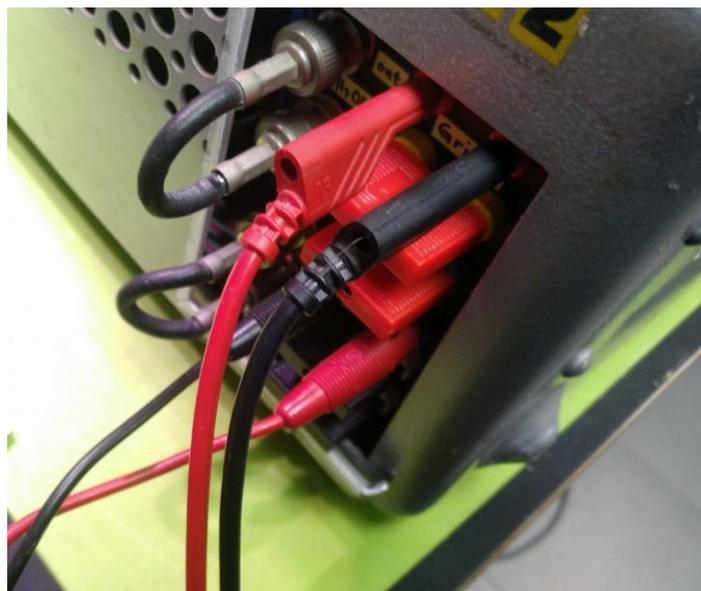
**Abbildung 40:** bei Rörotnik habe ich Auftrennmöglichkeiten für jedes Signal eingebaut. Damit kann ich jederzeit externe Widerstände (z.B. Kathodenwiderstände) oder auch Amperemeter (z.B. zum Anodenstrom messen) einschleifen!
