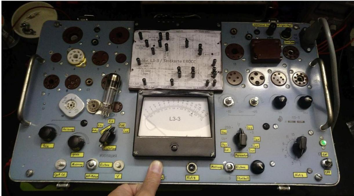
Abbildung 44: Testen des Prüfkarten-Prototyps für die E80CC
