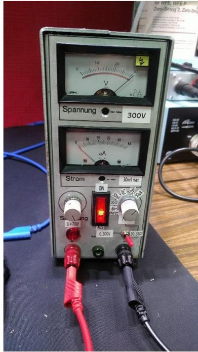
**Abbildung 28: mit diesem selbstgebastelten Leckstromtester kann ich Kondensatoren auf Isolation testen**
