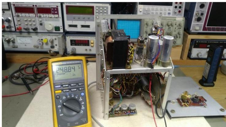
**Abbildung 16: die Glimmstabis im "Gekauften" sorgen für exakte 249V Anodenspannung- so wie es soll!**
