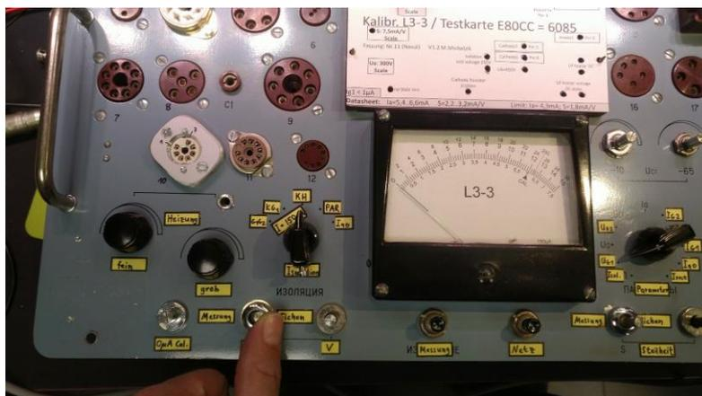
Abbildung 53: dieser Schalter des  $\mu\text{A}$ -Meters legt das Gitter während der "Eichung" bewusst auf Masse- es war also gar kein Fehler, sondern eine Fehlbedienung!
