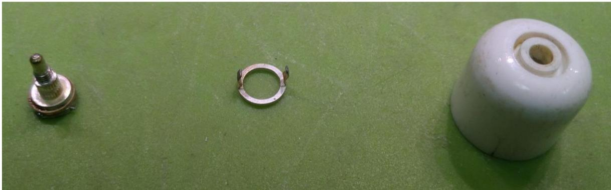
Abbildung 65: links der Mittelpin mit 50pF-Scheibenkondensator, dann der Ring (mitte), rechts die weiße Isolierkappe, wo das alles hinein gehört
