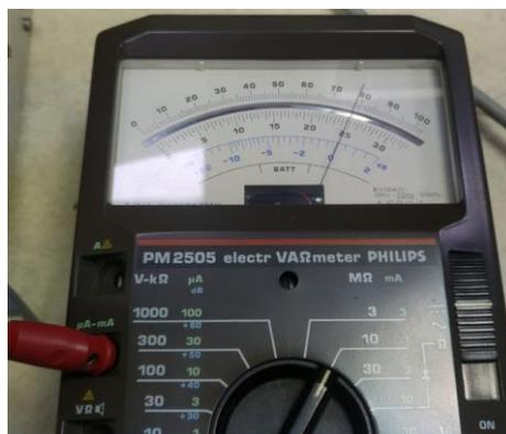
**Abbildung 8: mehr als knappe 800 $\mu$ A konnte ich am Messwerk nicht messen- selbst bei exzessiver Fehlbedienung des URU (Überspannung)**
