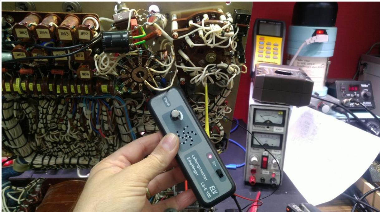
**Abbildung 49: mit einem kapazitiven Leitungsfinder musste ich teilweise die Signale in den dicken Kabelbäumen verfolgen!**
