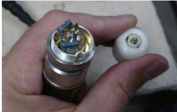
**Abbildung 62:** die weiße Isolierkappe kann man abschrauben; dann sieht man den Eingangspin der im Kopf versteckten Miniaturröhre!
