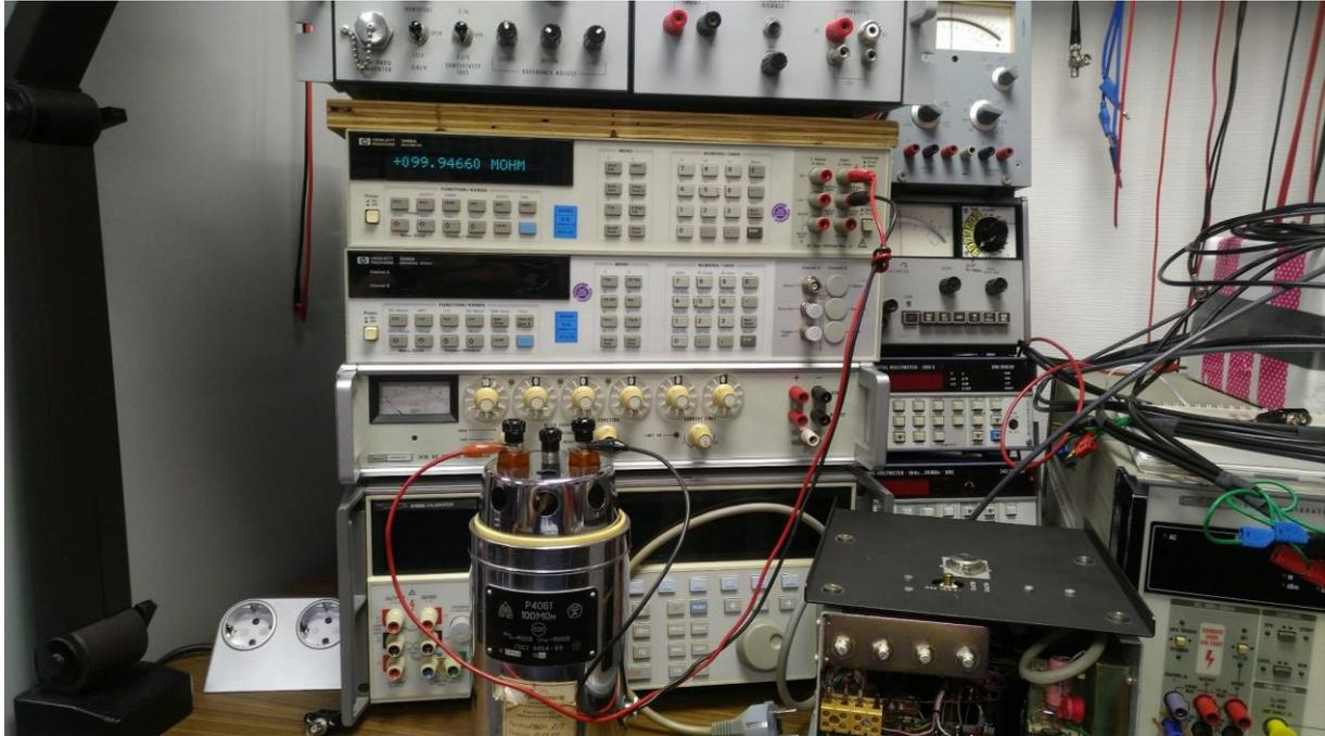
**Abbildung 22: Vergleichsmessung an meinem 100MOhm Widerstandsnormale**
