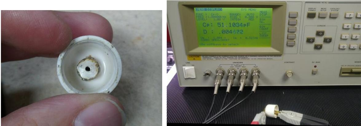
Abbildung 64: dieser Scheibenkondensator hat etwa 50pF
