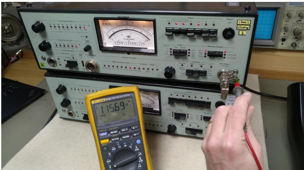
**Abbildung 12: bekanntes Problem: nicht geerdete Geräte können an berührbaren Metallteilen schnell Potenziale gegenüber Schutz Erde bis weit über 100Volt aufbauen- da kribbelt es in den Fingern! (Trotzdem besteht dieses Gerät die Berührstrommessung, da er unterhalb des Grenzwertes von 0,25mA bleibt!)**
