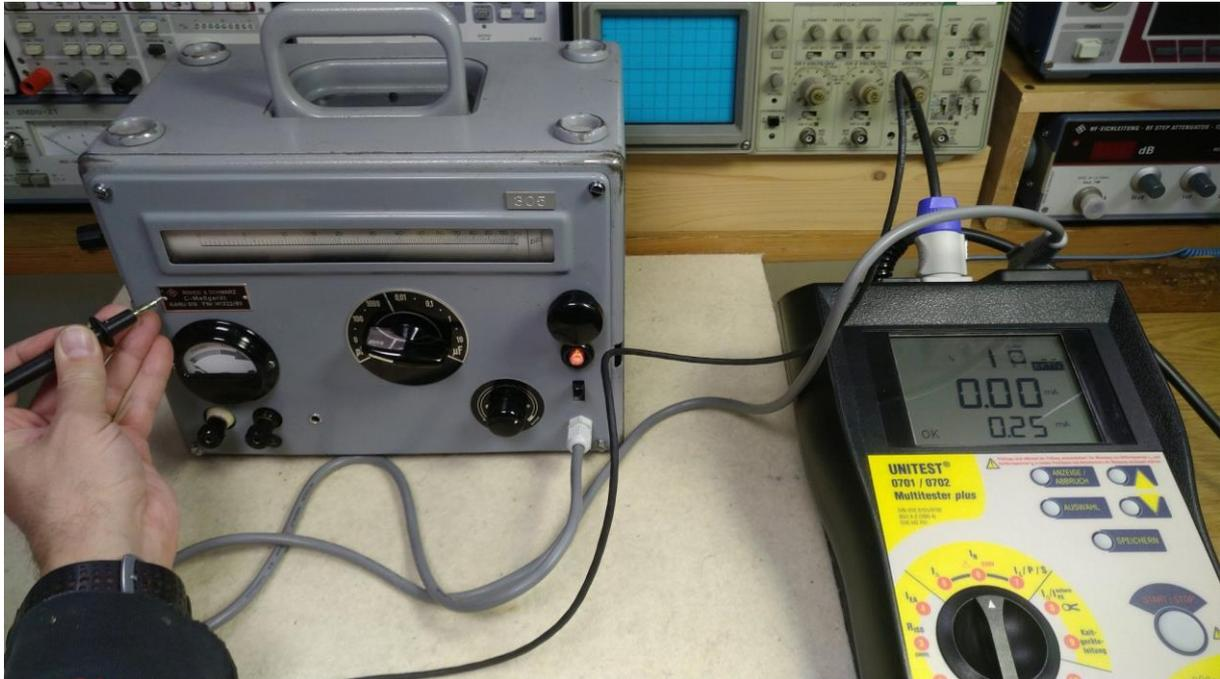
**Abbildung 26: wenn Typenschilder aus Blech keinen Kontakt zur Schutz Erde haben, müssen sie zwingend auf Berührungsstrom geprüft werden!**
