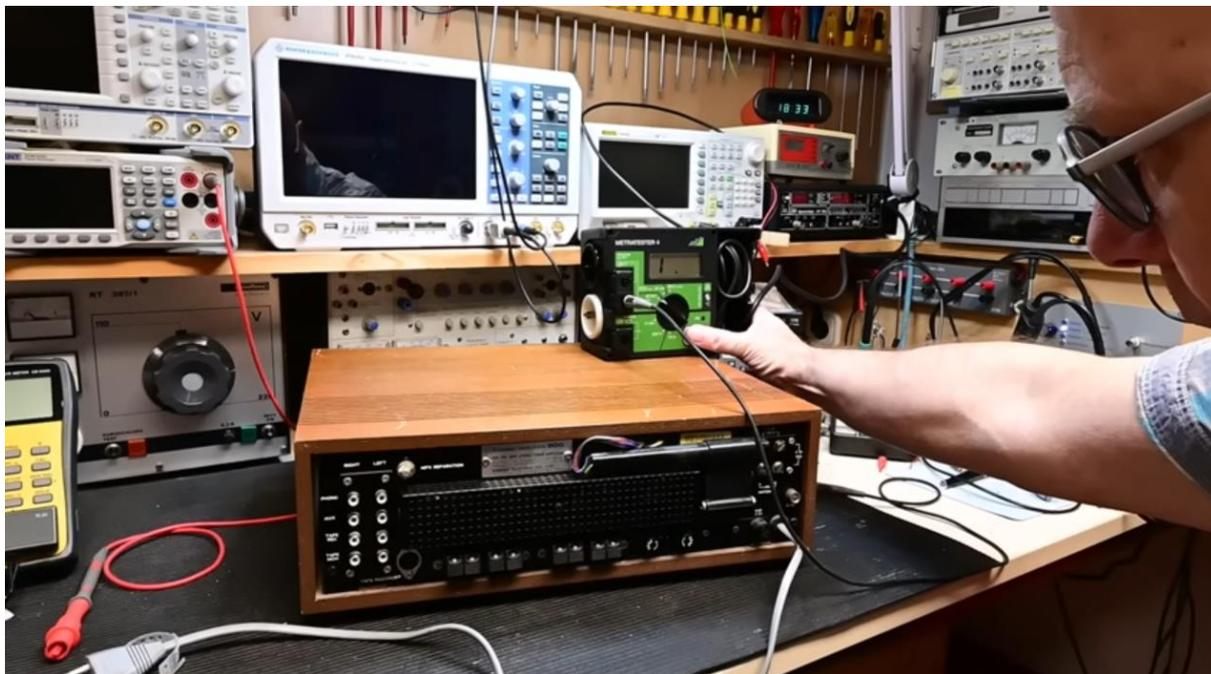
Abbildung 3: Jörg Haase bei der elektrischen Sicherheitsüberprüfung eines neues Bastelprojekts (Quelle: youtube, Kanal ve99 Online, Video "Sicherheitscheck nach erfolgter Reparatur an einem Beispiel.", Zeitstempel 02:33)
