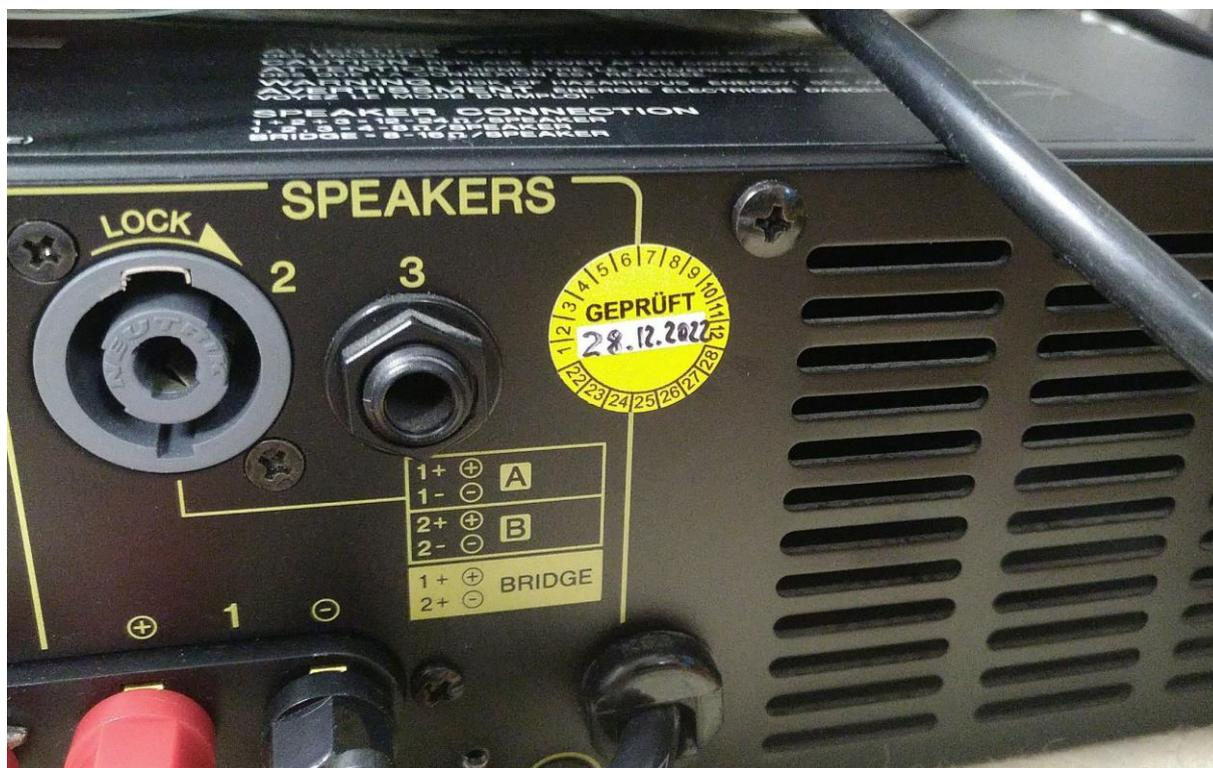
**Abbildung 29:** ein Aufkleber allein schafft noch keine Sicherheit, aber schadet nicht- auch hier von mir aufgebracht auf der getesteten Yamaha P2500S Bühnenendstufe
