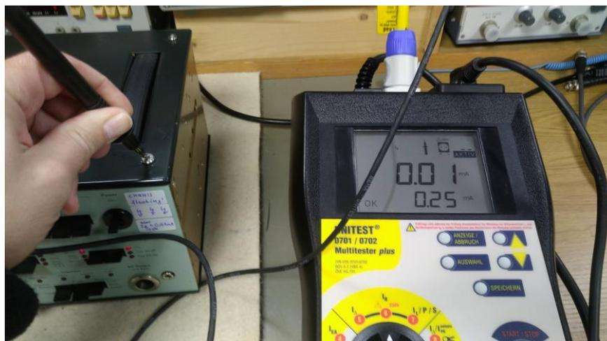
Abbildung 30: Berührungsstrommessung an einem absichtlich nicht geerdeten NF-Voltmeter
