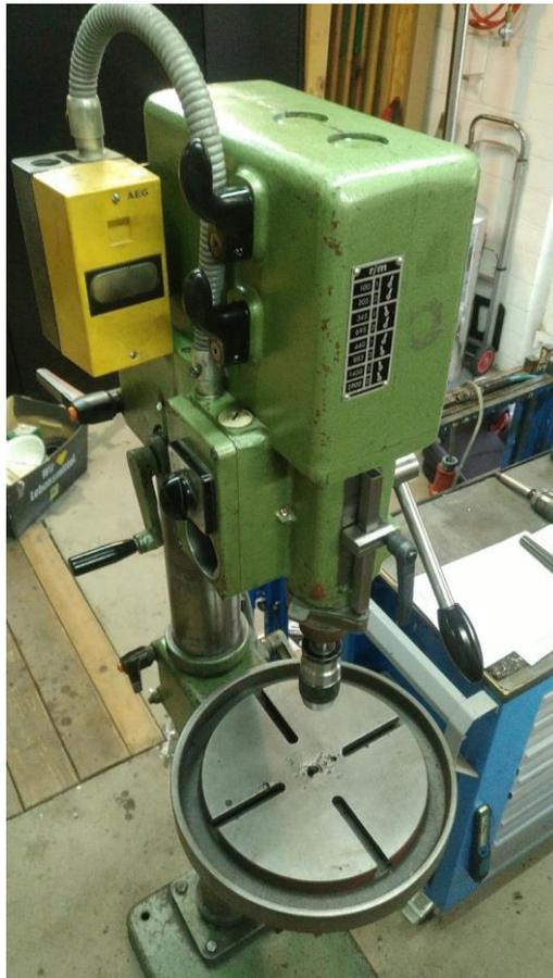
**Abbildung 6: eine super Standbohrmaschine: die Arboga G2508 (jetzt mit von mir nachgerüsteten Aderendhülsen im Netzschalter ;-)**
