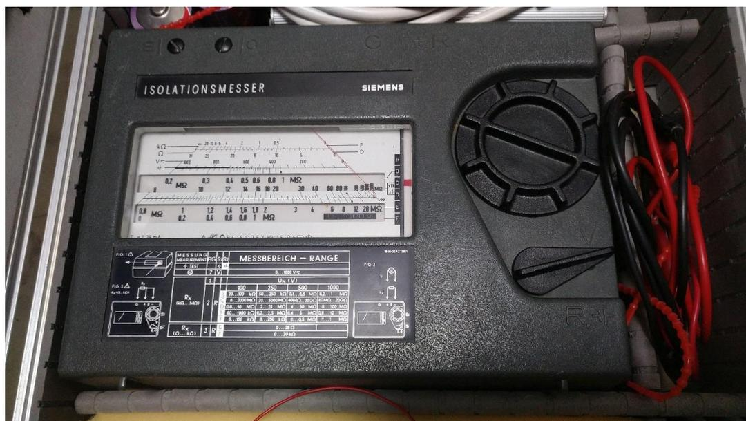
Abbildung 22: Siemens Isolationstester- auch eine gute Alternative und gebraucht oft gar nicht teuer zu erstehen!
