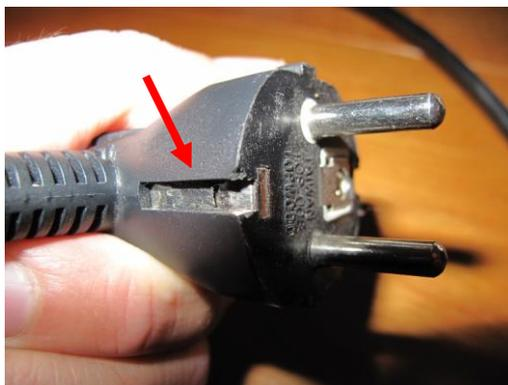
**Abbildung 20:** Beispiel "Produktionsfehler": die Kontaktfläche des Erdungskontaktes an diesem Schuko-Stecker ist von einer Kunststoffhaut teilweise abgedeckt!
