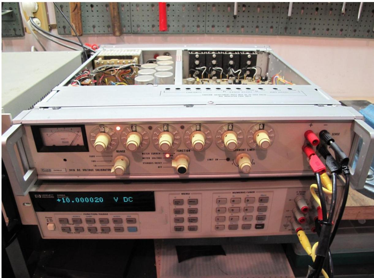
**Abbildung 23:** ganz so präzise brauchen wir die "10V" für den Isolationstest nicht, aber der hier gezeigte Fluke341A Kalibrator liefert ebenfalls bis zu 1100V- mehr als genug für einen Isolationstest!
