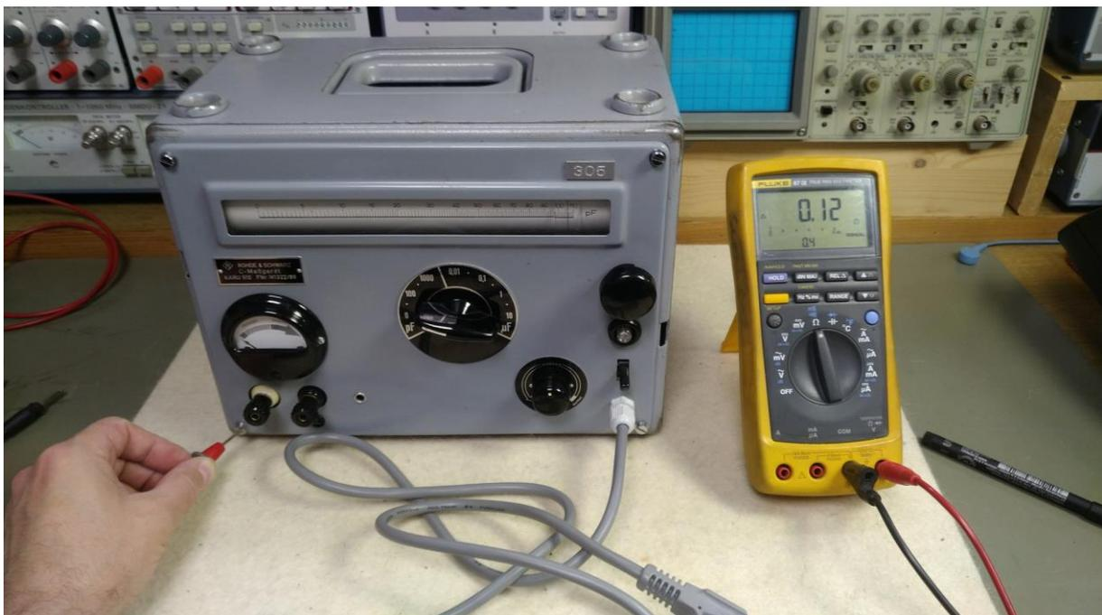
**Abbildung 18: nicht optimal, aber besser als gar nicht gemessen: Überprüfung des Erdungswiderstands mit dem Multimeter (hier zeigt an einem R&S KARU)**
