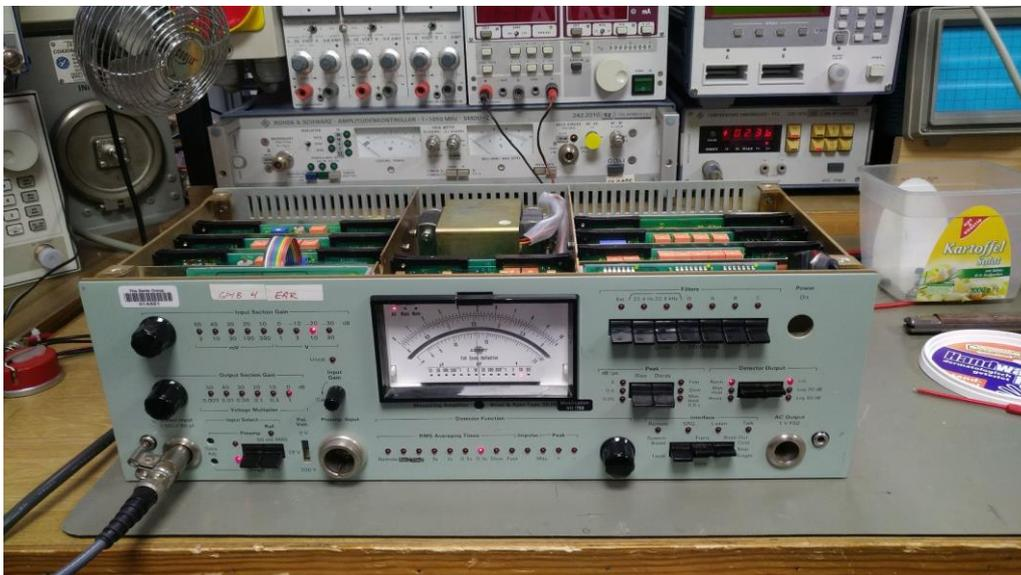
**Abbildung 10: knifflige Sache: der Brüel&Kjaer 2636 ist meiner Ansicht nach eines der besten NF-Voltmeter, die es zu kaufen gibt. Trotz Metallgehäuse hat er aber bewusst keinen Erdkontakt, um an Endstufen erdfrei messen zu können. Wenn ich sein Metallgehäuse berühre und gleichzeitig ein PE-geerdetes Gerät, kribbelt es in den Fingern!!! Würde ich das durch PE-Erden ändern, könnte ich damit aber keine Endstufen mehr messen oder müsste zwingend einen Trenntrafo verwenden!**
