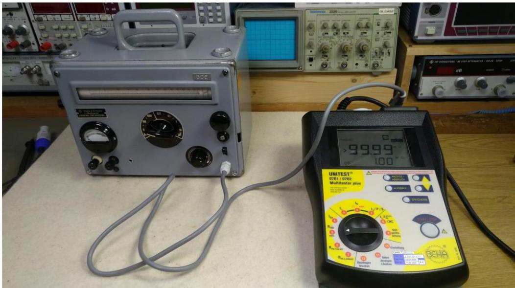
Abbildung 7: Beta Unitest im Einsatz (hier an einem R&S KARU)
