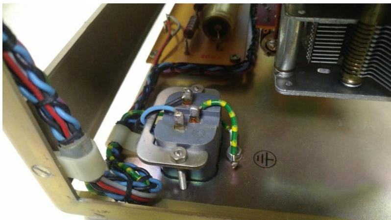
**Abbildung 17: Beispiel2 R&S LRT: auch dies dürfte heute nicht mehr so gebaut werden (fehlender Berührungsschutz)- trotzdem bedeutet das nicht automatisch immer gleich eine Gefahr für uns!**
