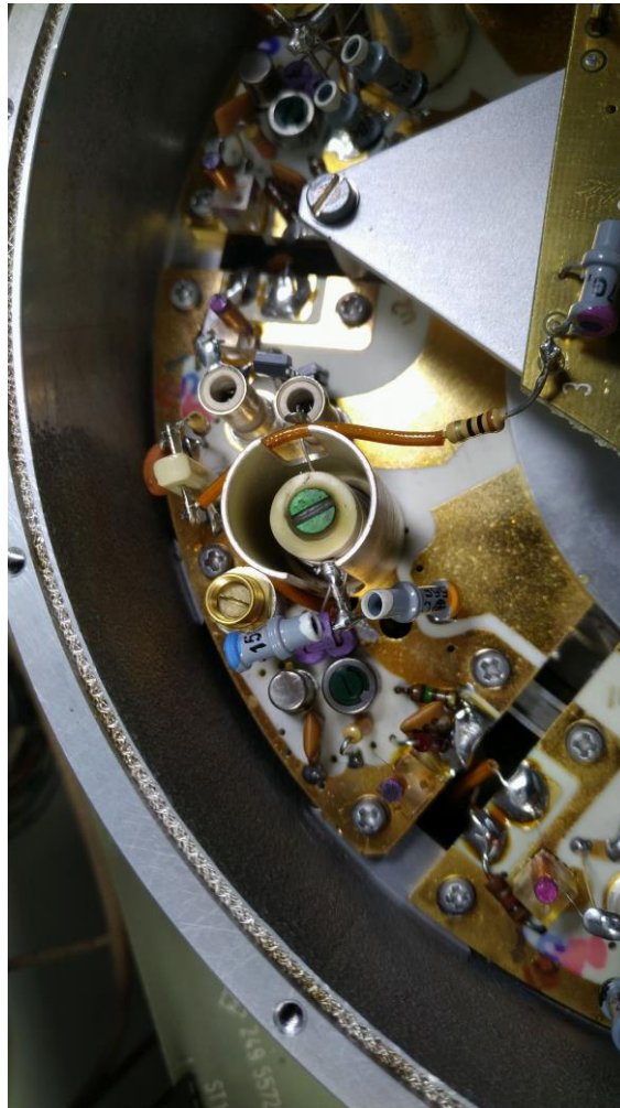
Abbildung 2: Oszillatorsegment aus R&S SMDU (Foto: Michalzik)
