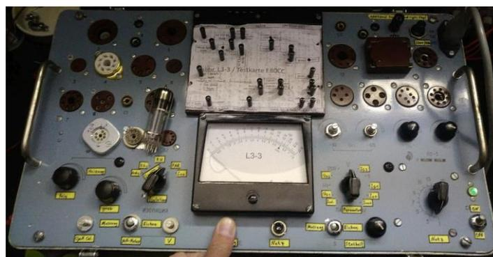
**Abbildung 20: Kalibr L3-3 Röhrenprüfgerät- so ein Teil zu heute gültigen Sicherheitsstandards konform zu machen, wäre alleine wegen der ganzen freiliegenden Röhrenfassungen in der Frontplatte vermutlich ziemlich aussichtslos!**
