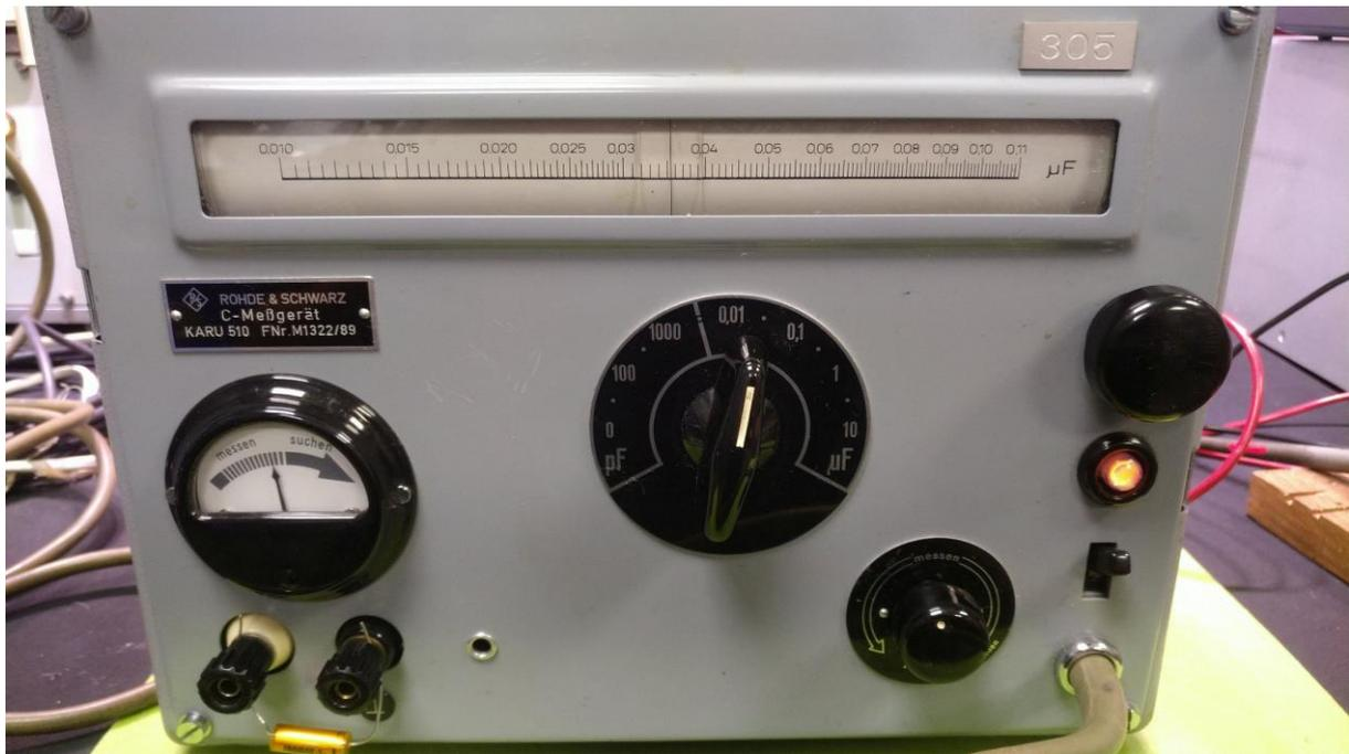
**Abbildung 44:** alle Spulenkernne neu abgeglichen und verklebt; die Trimmer justiert- einer ernsthaften Benutzung steht nichts mehr im Weg!
