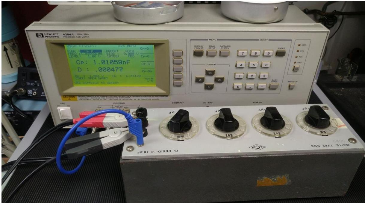
Abbildung 28: Verifikation meiner Boite CD3 Kapazitätsdekade mit einem HP4284A
