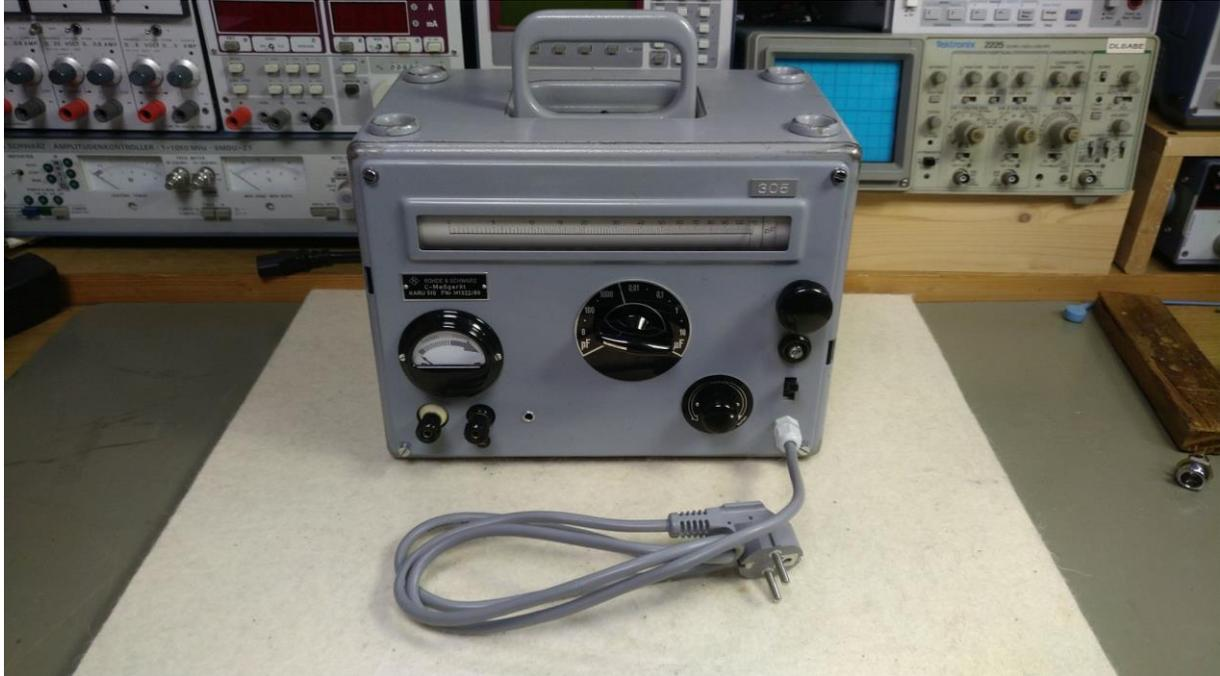
Abbildung 1: Rohde&Schwarz KARU 510 - röhrenbestücktes Kapazitätsmessgerät!
