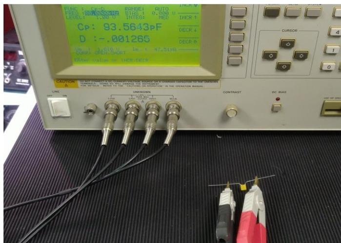
Abbildung 41: 100pF-Kondensator als Kalibrierhilfe
