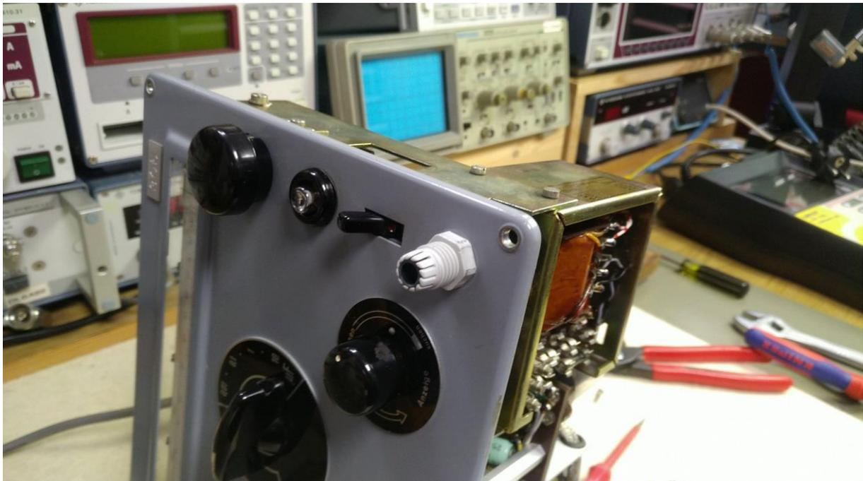
**Abbildung 17: bei der Zugentlastung und dem Knickschutz muss ich -mangels Verfügbarkeit von Originalteilen- leider improvisieren**
