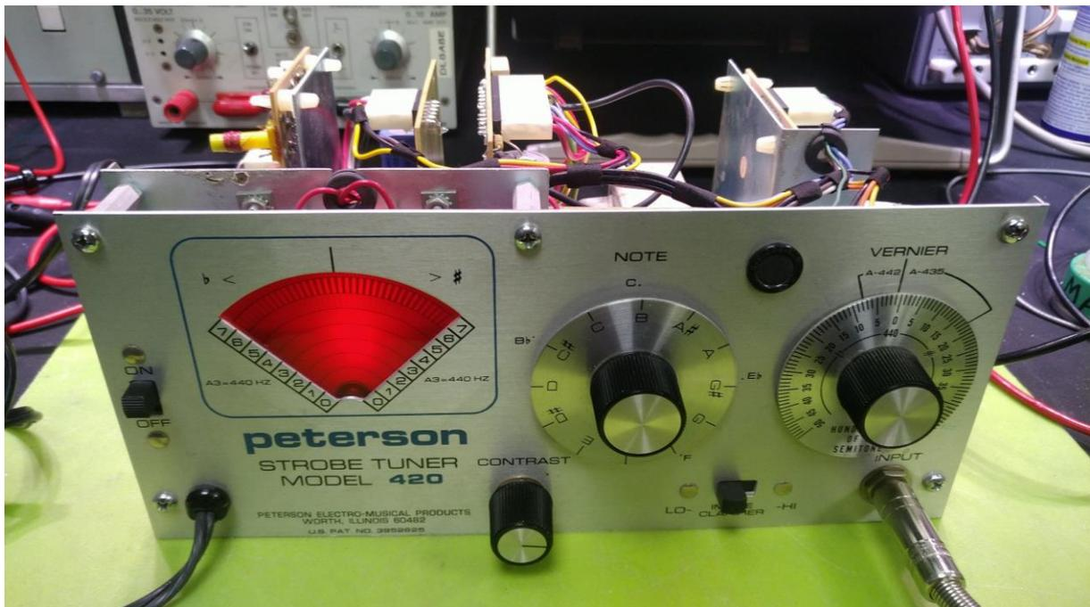
Abbildung 8: apropos "Geld versenken": ein Peterson 420 Stimmgerät mit rotierender Stroboskop-Scheibe- uralte Technik, aufwändig und kostenintensiv aus USA importiert. Es ist nicht so, dass ich nicht schon ein Stimmgerät hätte, das dem Peterson mindestens ebenbürtig wäre....
