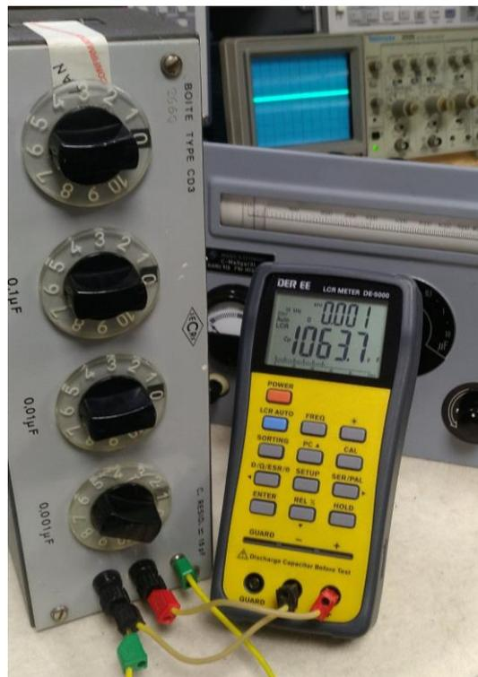
Abbildung 35: weitere Testmöglichkeit: das DE-5000, hier bei einer Messung von ca. 1nF
