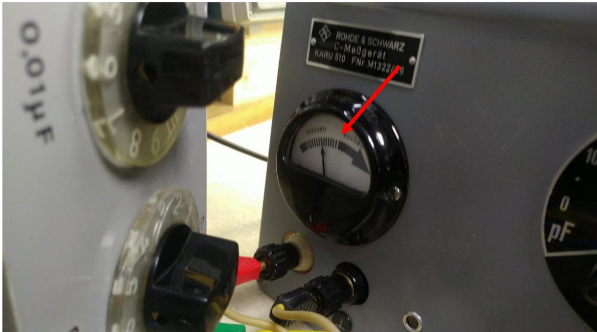
Abbildung 39: diese kleine Anzeige hilft uns beim Abgleich auf Maximum
