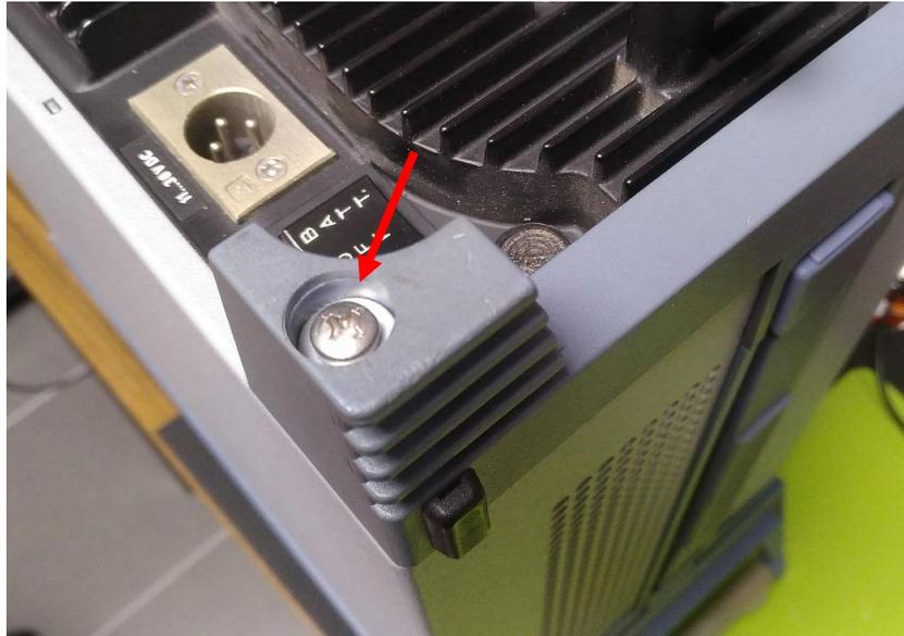
Abbildung 116: Fuß neu angeschraubt- diesmal mit Kraftfluss durch den kompletten Fuß (ist stabiler!)
