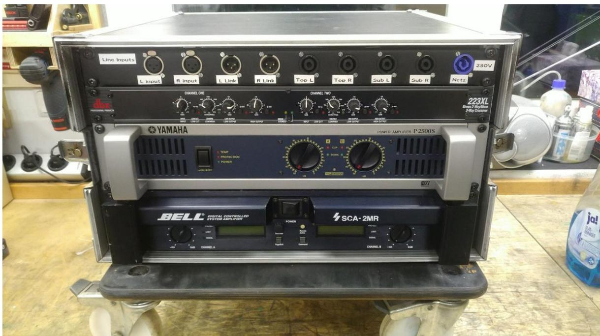
Abbildung 84: Endstufen-Rack fertig!
