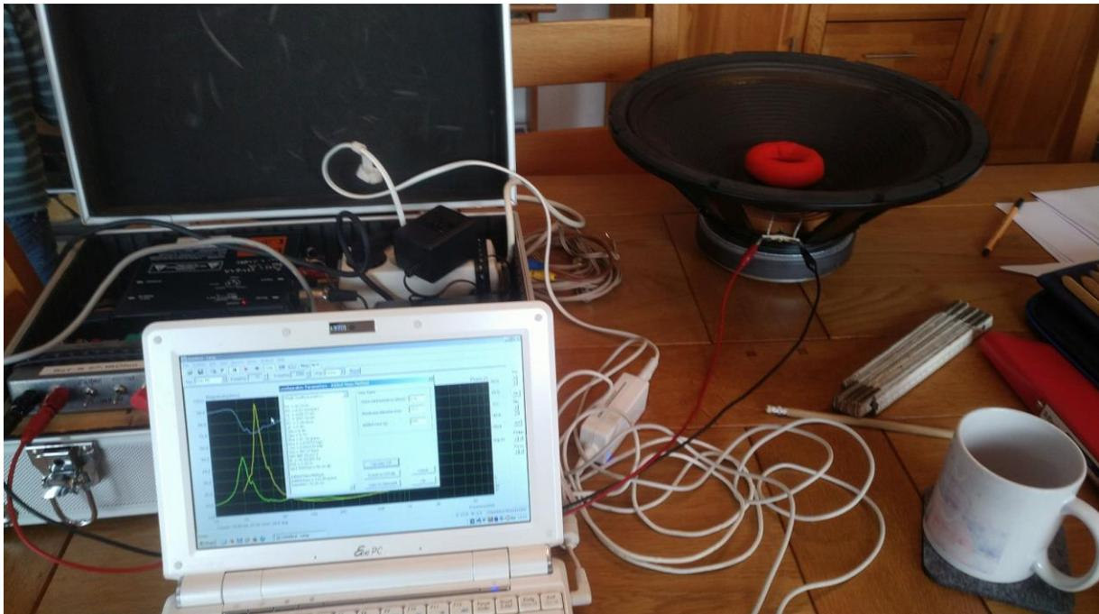
Abbildung 37: Bestimmung der Thiele-Small-Parameter nach der Masse-Methode
