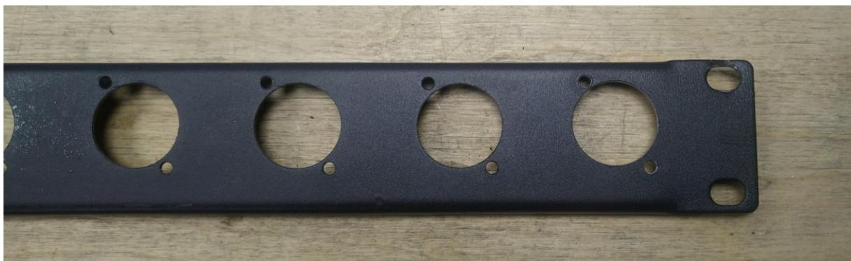
Abbildung 82: dass die ganz rechte Buchse nachträglich von mir in das Blech hineingespindelt wurde, kann man sicher nur auf den zweiten Blick erkennen, oder?
