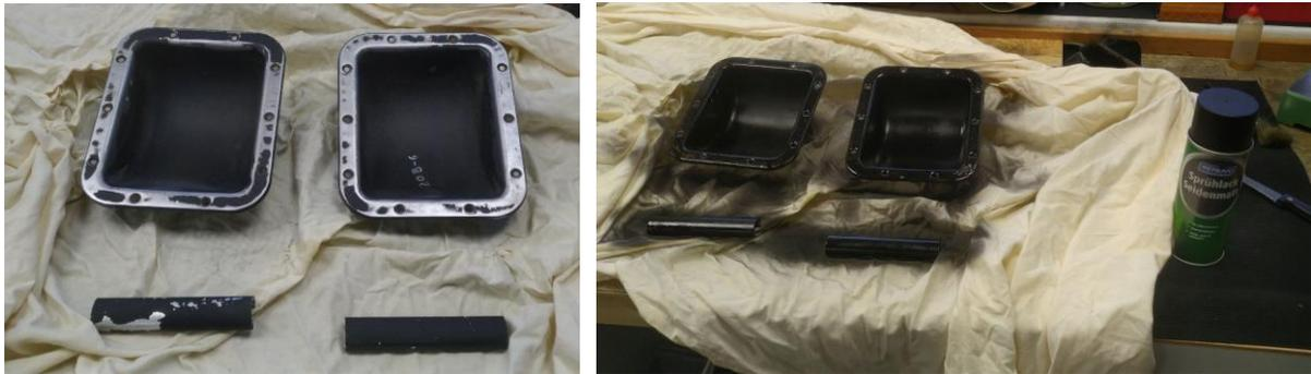
Abbildung 47: nach dem Abschleifen und Neu-Lackieren...
