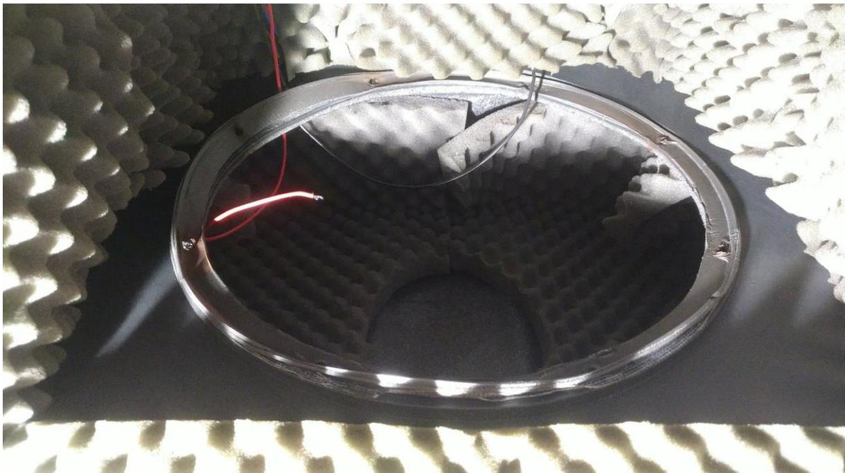
**Abbildung 39: Resonanzkammer des Treibers**
