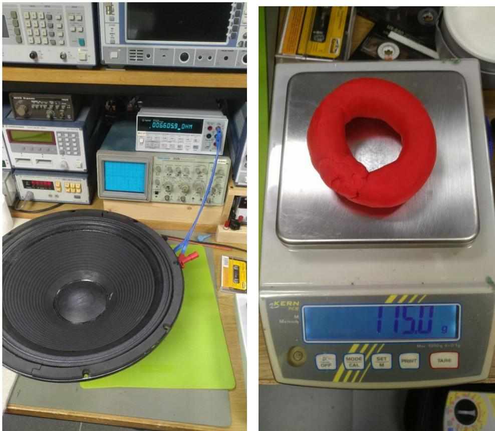
Abbildung 36: links Gleichstromwiderstand messen, rechts Zusatzmasse bestimmen (Knetring)
