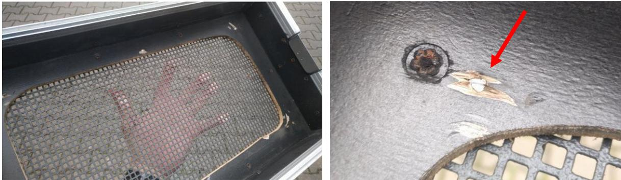
**Abbildung 79:** etwas mehr Zielwasser wäre beim Anfertigen des Ausschnittes gut gewesen, aber viel schlimmer finde ich, dass ich erstmal alle Schrauben abschleifen musste (=Pfeil)
