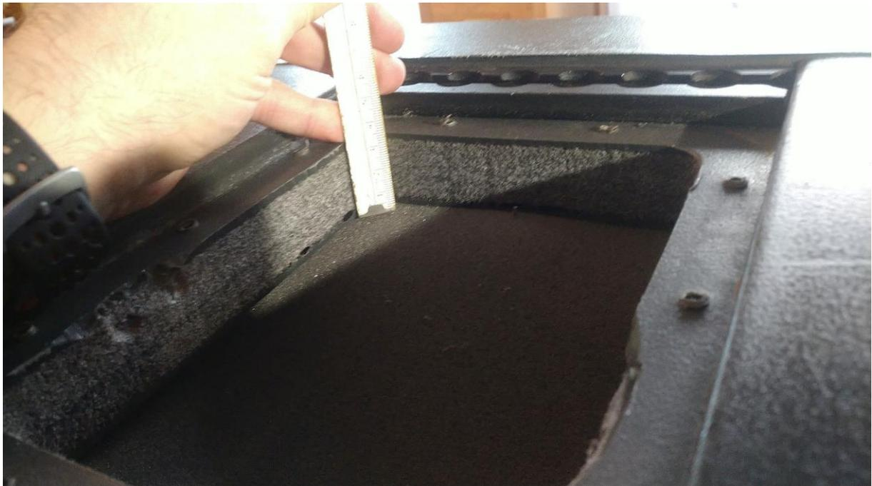
**Abbildung 45: nach dem Ausbau der Griffschale hier sehen wir den Aufbau der Gehäusewand**
