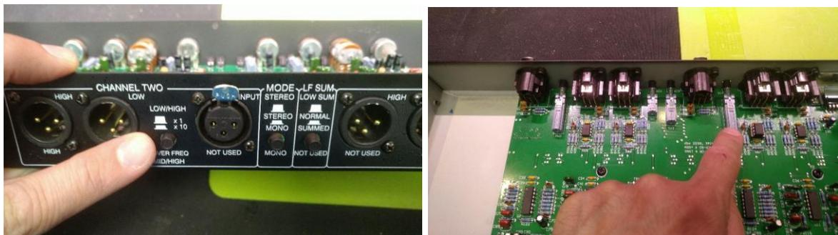
Abbildung 97: der defekte Umschalter von außen und von innen
