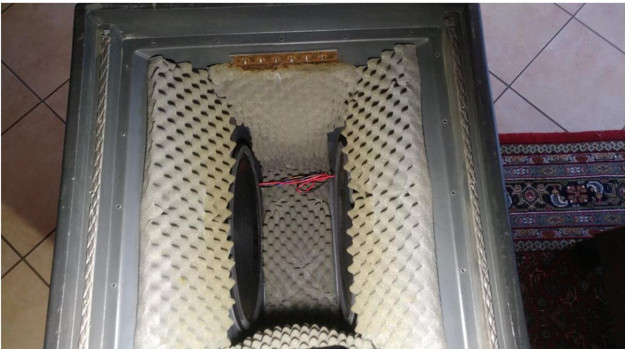
**Abbildung 31: die beiden Lautsprecher liegen sich bei diesem Design direkt gegenüber und "befeuern" die -zusammen mit der Schallwand gebildete- Resonanzkammer**
