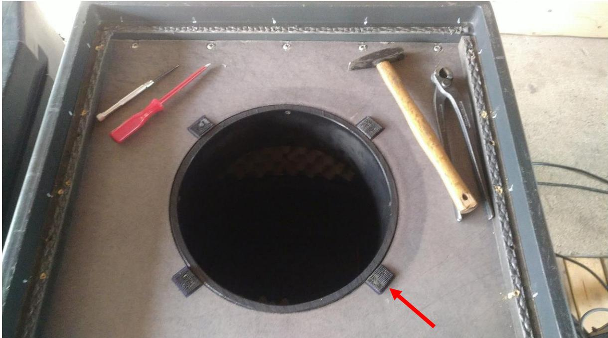
Abbildung 102: Klettband-Befestigung
