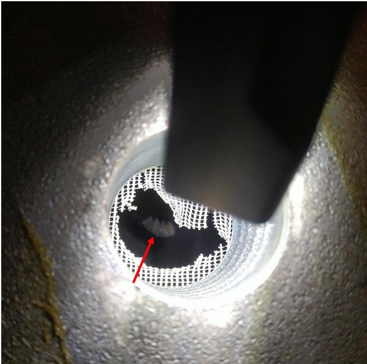
**Abbildung 62: dieses winzige Stück Plastik hinter der Membran erzeugte die Geräusche!**
