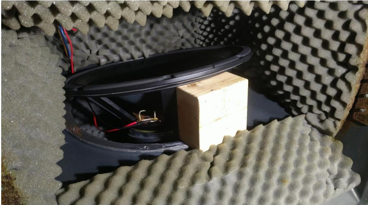
**Abbildung 63: Anlöten der Kabel beim Wiedereinbau**
