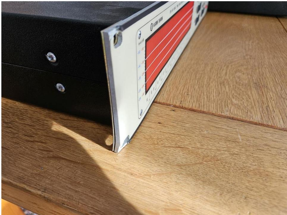
**Abbildung 3: eine Menge Gewalteinwirkung ist notwendig, um so eine massive Frontplatte zu verbiegen!**
