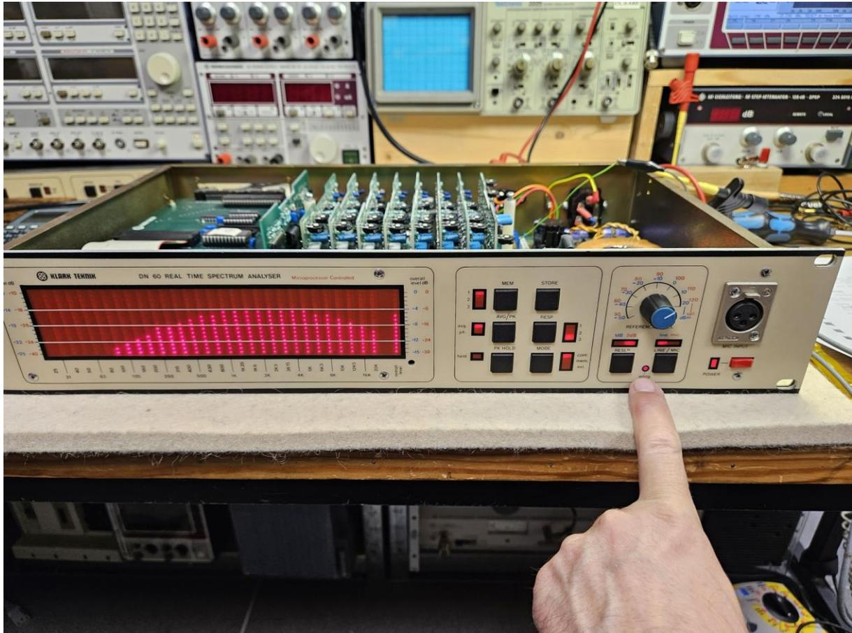
**Abbildung 13:** wenn man diese Taste länger drückt, aktiviert man das dB(A)-(Ohrkurven)Filter. Bei angelegtem rosa Rauschen kann man sehr schön sehen, wie das dB(A)-Filter in seinem Verlauf aussieht
