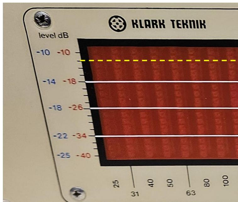
Abbildung 21: die -11dB sind genau dann erreicht, wenn die zweit oberste LED gerade aufflackert (gelbe Linie)
