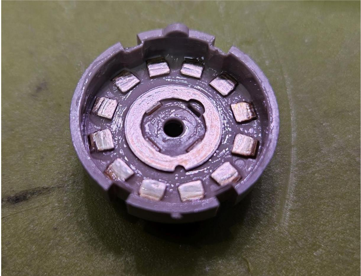
Bevor ich den Schalter wieder zusammensetzte, bog ich die Schleifkontakte noch etwas nach, damit sie etwas mehr Federkraft auf die Kontaktflächen bringen. Nach dem Zusammenbau reduzierte sich der gemessene Kontaktwiderstand auf unter 0,1Ohm- und zwar wackel- und ruckstabil! Der Wackelkontakt war beseitigt!
