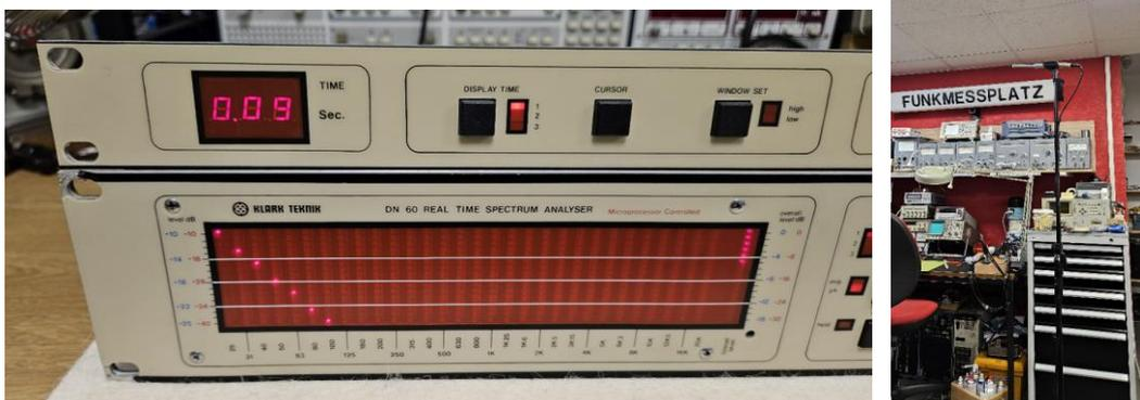
Abbildung 47: Messung der Nachhallzeit RT60: bei mir im Messplatzzimmer sind es trotz Fliesenbodens nur 90ms- die installierte Akustikdecke zeigt deutliche Wirkung 😊
