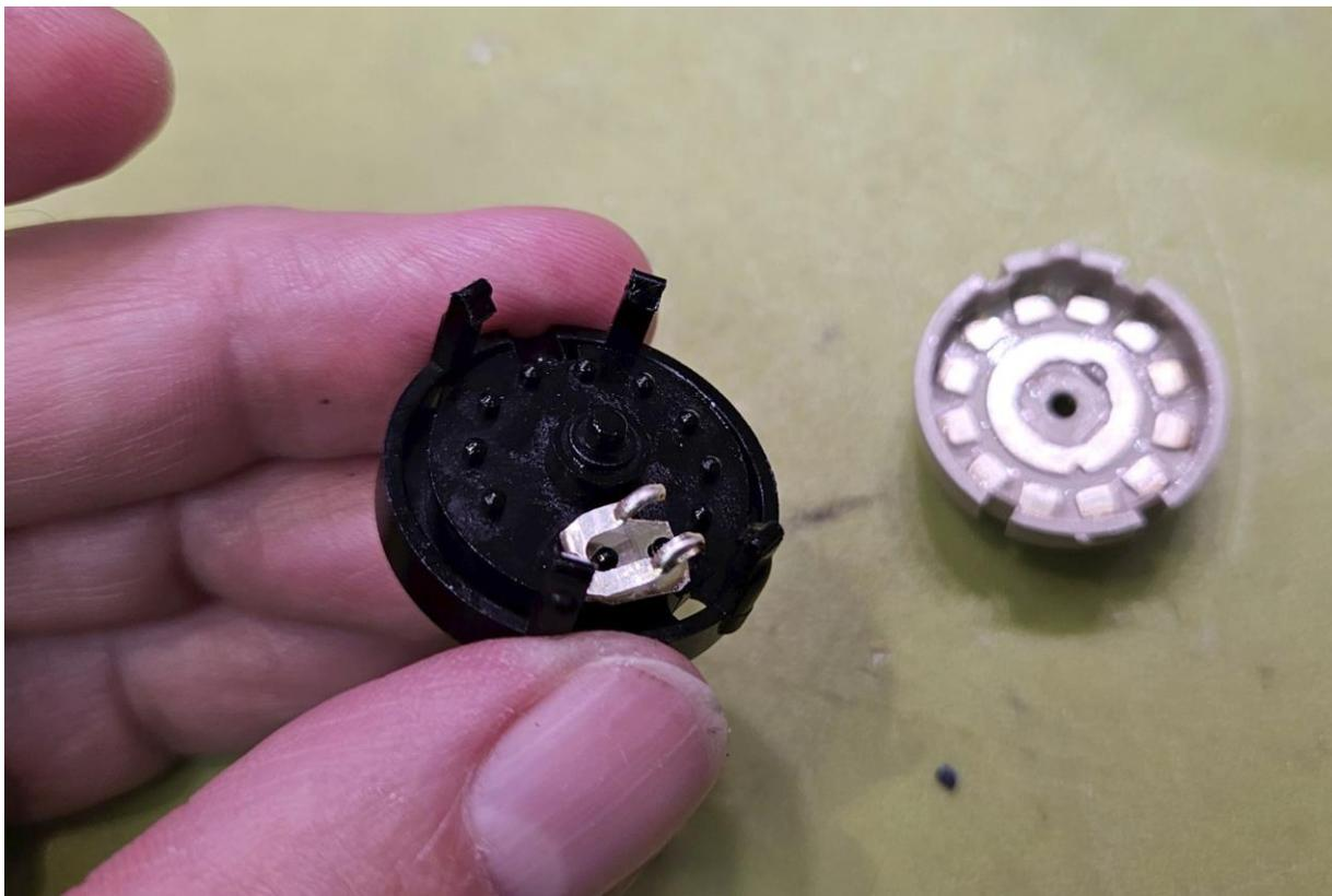
Und das hatten sie auch nötig, denn tatsächlich war hier eine Oxydschicht zu erkennen und die Schleifspuren der Kontaktmechanik. Eine Kur mit Kontakt60, Kontakt WL und anschließender Konservierung mit Siemens Wählerfett-Nachbau (weiße Vaseline + Petroleum) machte die Kontakte wieder schön:
